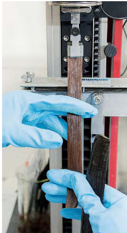
Kräftemessen. Eine mit Shampoo aus dem Test gewaschene Strähne wird für die Kämmkraft-Prüfung eingespannt.
