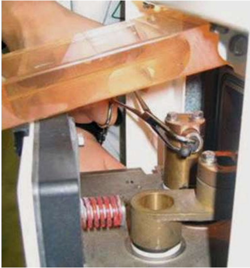
■ Abb. 17.4 Einsatz des Graphittiegels in die Schublade des Technegasgenerators
