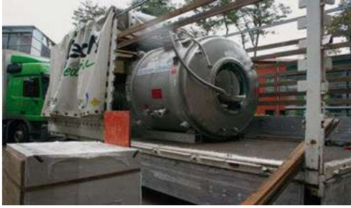
■ Abb. 6.18 Bild eines Kernspintomographen ohne Verkleidung
