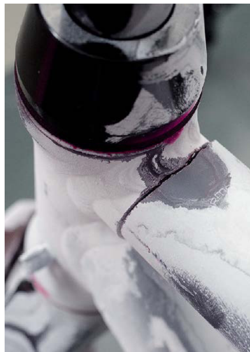
Rahmenbruch. Bei einer der Prüfungen handelten sich zwei Räder ihr Mangelhaft ein.
