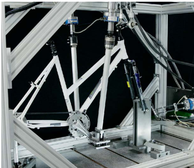
Der Prüfstand. Tretkurbel, Lenker, Sattelstütze und Gabel werden über 20 000 Kilometer Lasten ausgesetzt, wie sie in der Praxis vorkommen.
