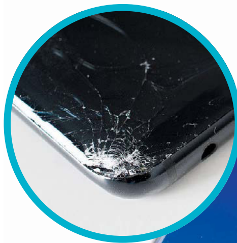
Kaputt. Das S8 (oben) und S8+ sowie die Ecke eines Exemplars nach unserem Falltest.
