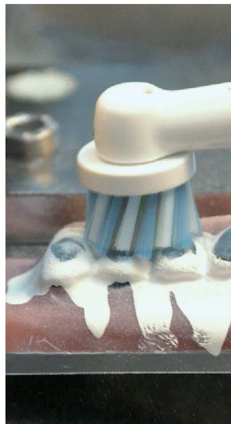
Wie flüssige Sahne. Mit Alkohol gemischtes Titandioxid ist bei Tests ein üblicher Plaque-Ersatz.
