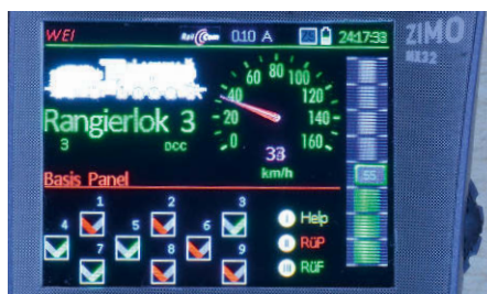
Weichen können während des Fahrbetriebs über den Softkey II geschaltet werden. Links ist die adressorientierte Anzeige zu sehen, rechts im WEI-Bildschirm die objektorientierte
