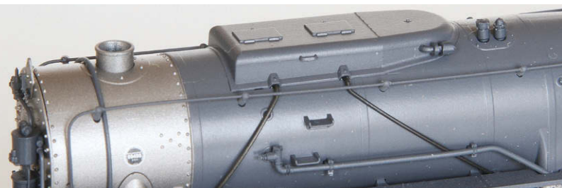
Roco HO: Der Dom am Modell ist auffällig lang, da sein Deckel im Original auch als Befestigung für den Krantransport diente
