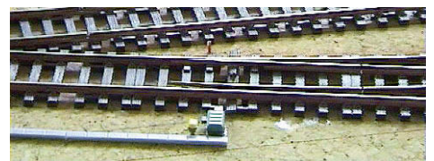
Signalanschlüsse, Kabelkanäle, Weichenantriebe und -grenzzeichen auf dieser Anlage entsprechen den Bundesbahn-Gegebenheiten wie beim Vorbild Ende der 1960er-Jahre
