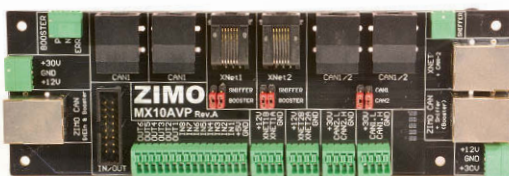
Anschlüsse an der Zimo-Erweiterungsplatine mit der Bezeichnung MX10AVP
