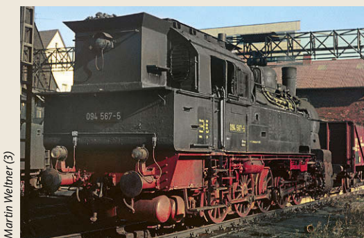
Unterschiede: Während die links abgebildete 094 567 einen geschweißten, hohen Kohlenkasten-aufbau besitzt, fehlt dieser bei 094 616 mit ihrem flachen, hölzernen Aufsatz
