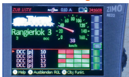
Weichen können während des Fahrbetriebs über den Softkey II geschaltet werden. Links ist die adressorientierte Anzeige zu sehen, rechts im WEI-Bildschirm die objektorientierte
