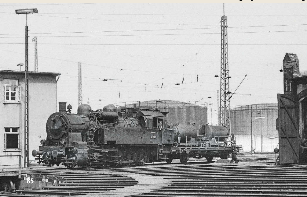
Im Bw-internen Vershub war am 19. Juli 1967 die Osnabrücker 94 1561 eingesetzt, die sich hier ohne Schornsteinaufsatz, aber mit Glocke und Rangierfunkantenne zeigt
