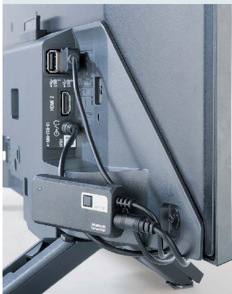
Beispiel 1. Die kleine Box am TV-Gerät funkt den Ton vom Kopfhörerausgang an Bluetooth-Geräte.
