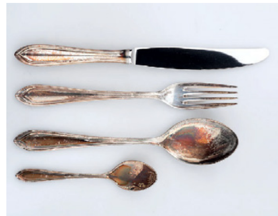
Verfärbt. Mit Fit, Finish-Pulver und Norma läuft das Silberbesteck an.
