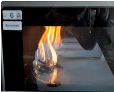
Sicherheitstest. Die Kartoffel brennt, Flammen ergreifen die Mikrowelle.
