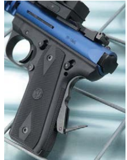
Das Mainspring Housing Assembly muss zum Auseinanderbau ausgeklappt und aus der Waffe gezogen werden.
