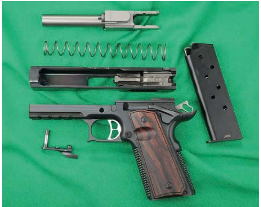
Die Korth PRS in ihre wesentlichen Bestandteile zerlegt. Alles ist passgenau gearbeitet, ohne jegliche Spuren von Werkzeugen oder ähnlichem.
