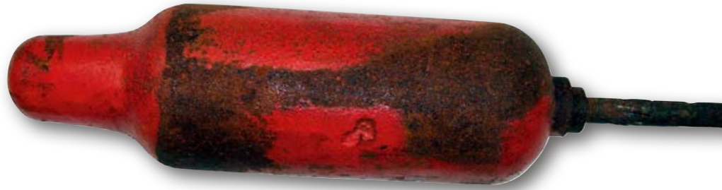
Übungsmodell der Gew.Gr.1914. Der hohle, dickwandige Stahlgusskörper war in Form und Gewicht einer entschulten Gewehrgranate nachempfunden.
