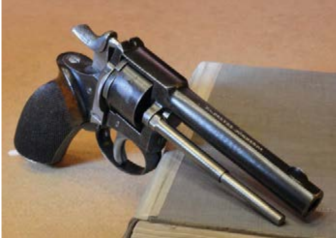
Der neu aufgetauchte Patronenrevolver prunkt mit feinen Holzgriffschalen und hat den von Dreyse entwickelten Ausstoßer, der hier allem Dafürhalten nach nachträglich angebracht worden ist.
