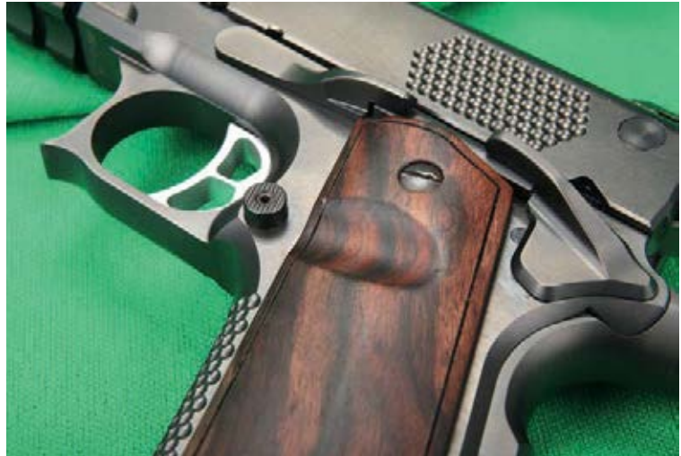
... der auch für diese Daumenmulde sorgt. Sie erlaubt es auch kleinen Händen, bequem an die Bedienelemente zu gelangen.
