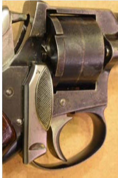
Charakteristisch für Dreyse's Unikat ist die nach unten verschiebbare Ladeklappe im Stil der US-Firma Merwin, Hulbert & Co.; oben auf der Klappe sitzt das Kontrollzeichen „K“.
