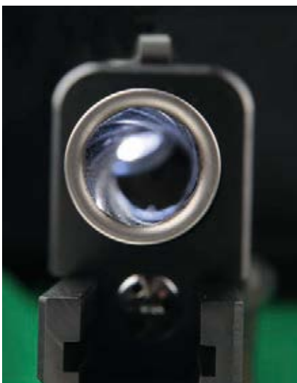
Blick in den Lauf der PRS. Sehr schön sind die Züge und Felder zu erkennen.
