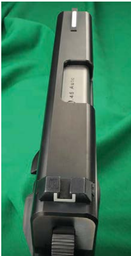
Blick auf die Visierung der PRS. Die Kimme stammt von Glock, das Korn aus der Fertigung von Korth.
