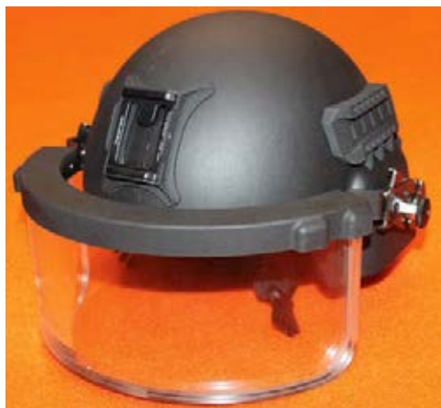
Der H15 von Mehler Vario System entspricht der Schutzklasse VPAM Level 3 (= Schutz vor Neun-Luger-Munition aus Maschinenpistolen verschossen). Das ballistische Visier aus dem Hause KRD lässt sich schnell ab- und anlegen. Der Helm wiegt nur 3400 Gramm.
