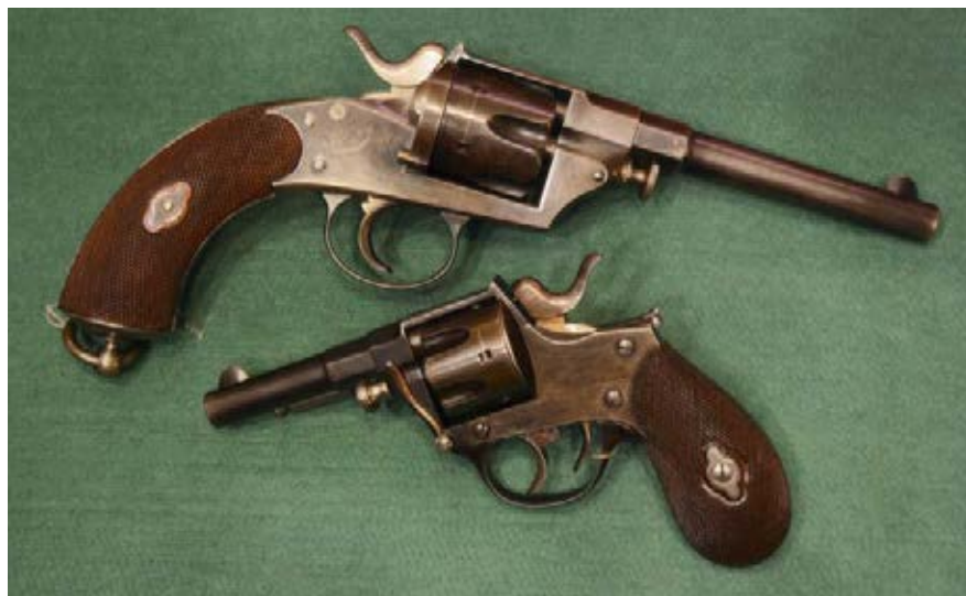
Die Masse der bei Dreyse gebauten Revolver entfiel auf die in der Kaiserzeit eingeführten deutschen Ordonnanzrevolver, hier ein M/79 in Offiziers-Ausführung. Unten Dreyse's verkleinerte Version, bei Sammlern bekannt als Baby-Reichsrevolver.
