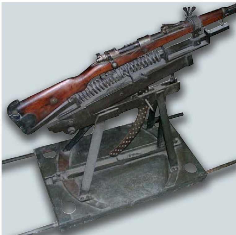
Verbessertes Schießgestell 1915 mit eingespanntem Gewehr 98. Vorn und hinten konnten je zwei Tragegestangen aus der Bodenplatte gezogen werden. Sie erleichterten den Stellungswechsel.
