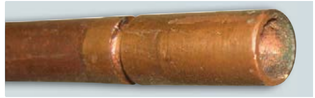
Das weiche Kupferstück am Führungsstock presste sich beim Abschuss in die Züge und wirkte so als Dichtung zwischen Stab und Laufwandung.
