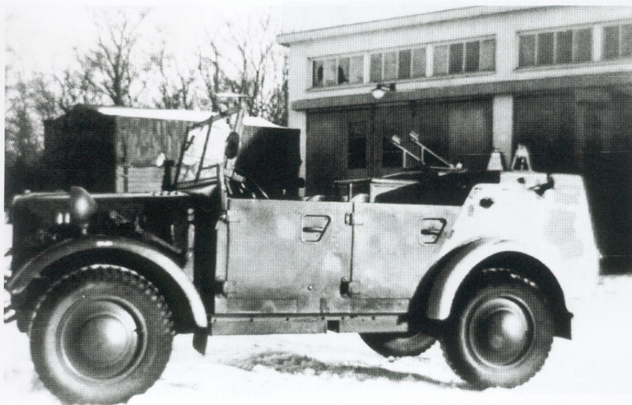
Der leichte geländegängige Einheits-Pkw (4x4) wurde von den Firmen Stoewer, Hanomag und BMW gebaut. Einzelne Baugruppen waren bedingt untereinander austauschbar.
