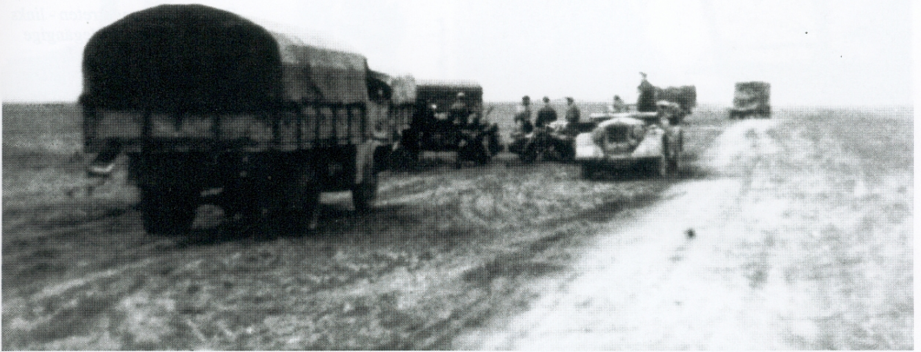
Auf dem Vormarsch im Osten, 1941. Der mittlere geländegängige Einheits-Pkw (4x4) führte einen Kraftstoffvorrat von 70 l unter dem Wagen und 40 l im Heck mit und hatte Reichweiten von 420 km (Straße) bzw. 300 km (Gelände).
