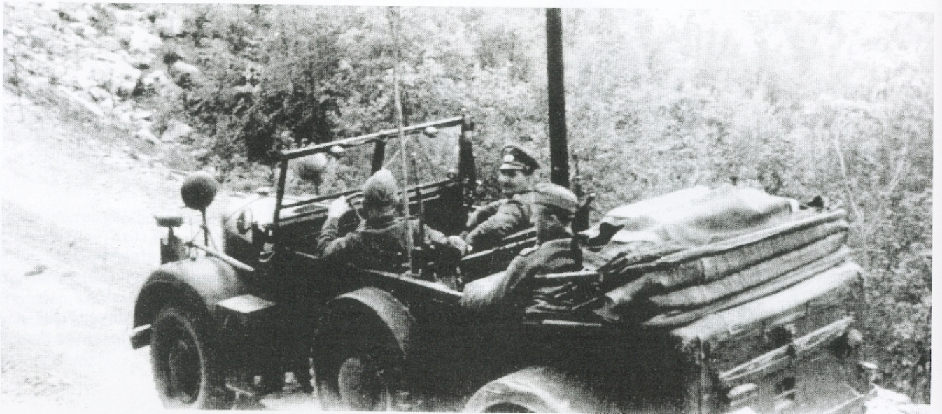
Der mittlere geländegängige Einheits-Pkw (4x4) war auch in Norwegen im Einsatz. Auf diesem Foto ist gut zu erkennen, wie das Gepäck hinter der Rückbank verstaut ist.
