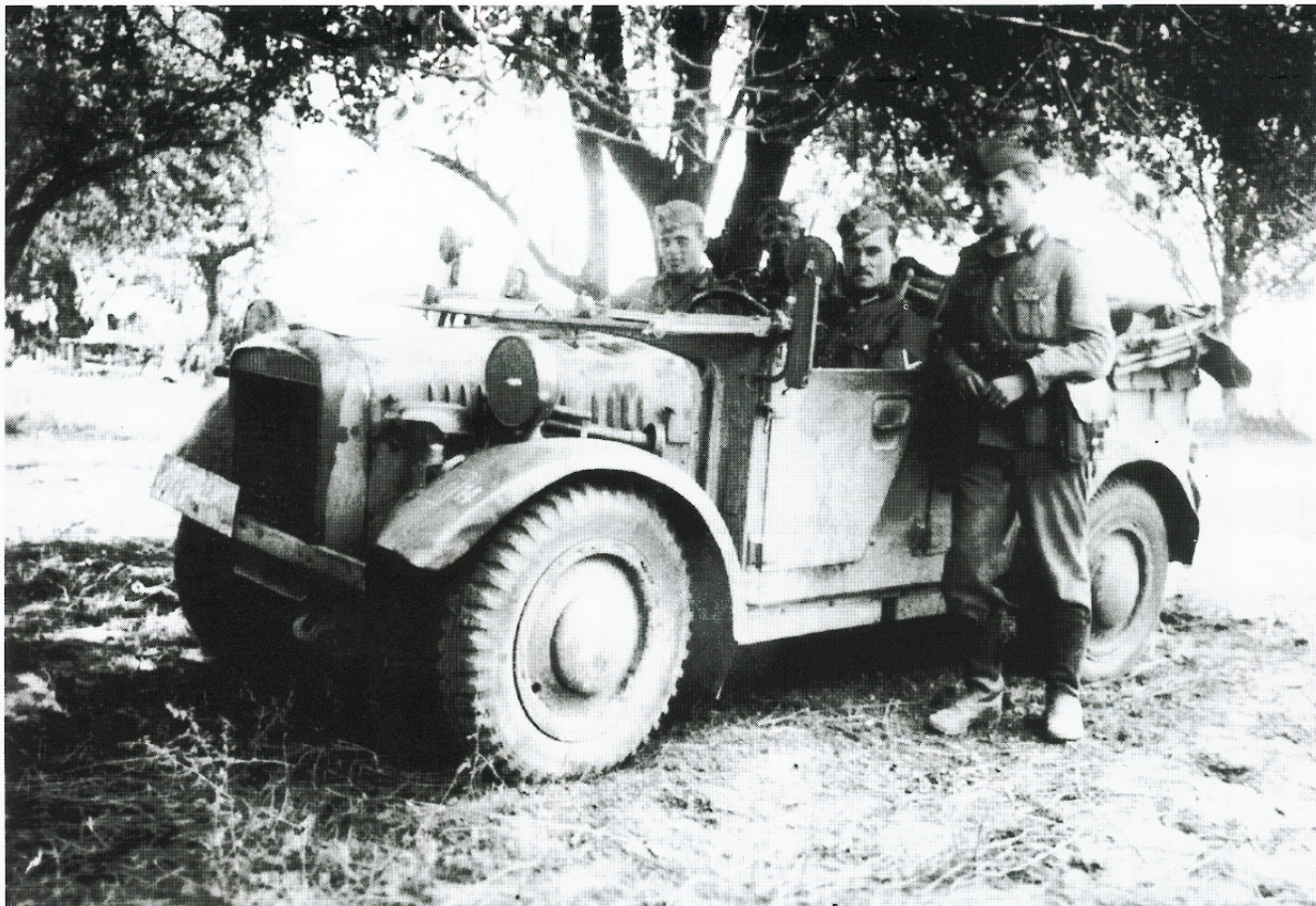
Trotz seine Anfälligkeit war der leichte geländegängige Einheits-Pkw (4x4) (Kfz 1) ein beliebtes Transportmittel wegen seiner Geländegängigkeit und Wendigkeit. Sein Wendekreis betrug 12,7 m, bei Einsatz der Vierradlenkung 6,5 m.
