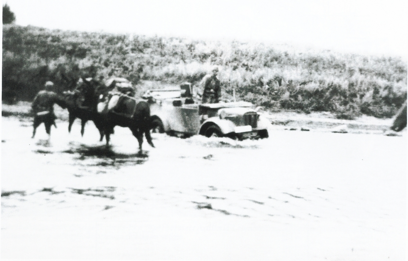
Dieses Fahrzeug, bei der Waffen-SS im Einsatz, überwindet den Wasserlauf ohne Probleme. Der leichte geländegängige Einheits-Pkw hatte eine Wadfähigkeit bis zu 500 mm, beim Stöwer Typ 40 sogar bis zu 700 mm.
