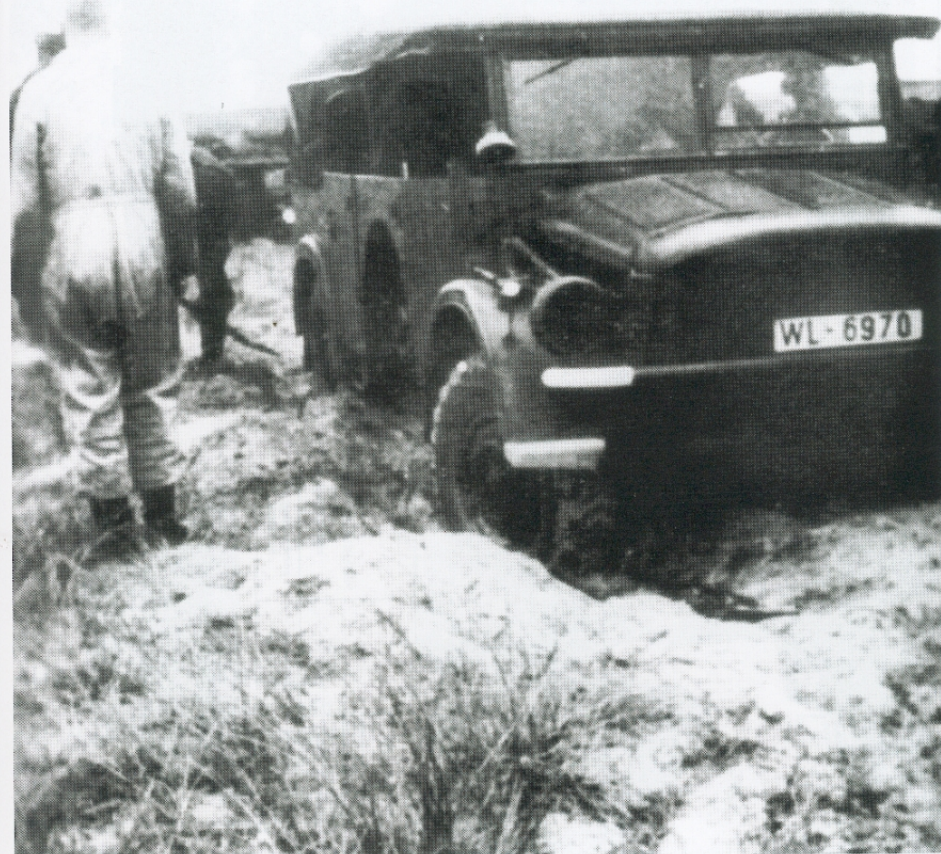
Der schwere geländegängige Einheits-Pkw (4x4) konnte als Mannschaftswagen auch kleinere Geschütze ziehen. Hier ist eine 4,5-cm-Panzerabwehrkanone II 81 (r) russ. 37 angehängt. Die Aufnahme entstand 1944 in den Karpaten.
