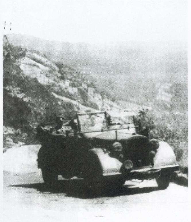
Auch in den Bergen war der mittlere geländegängige Einheits-Pkw ein zuverlässiges Fahrzeug. Die eingebauten Motoren (Stoewer R 180 W, Stoewer AW 2, BMW 325 und Hanomag 20B) waren zuverlässig und stark.
