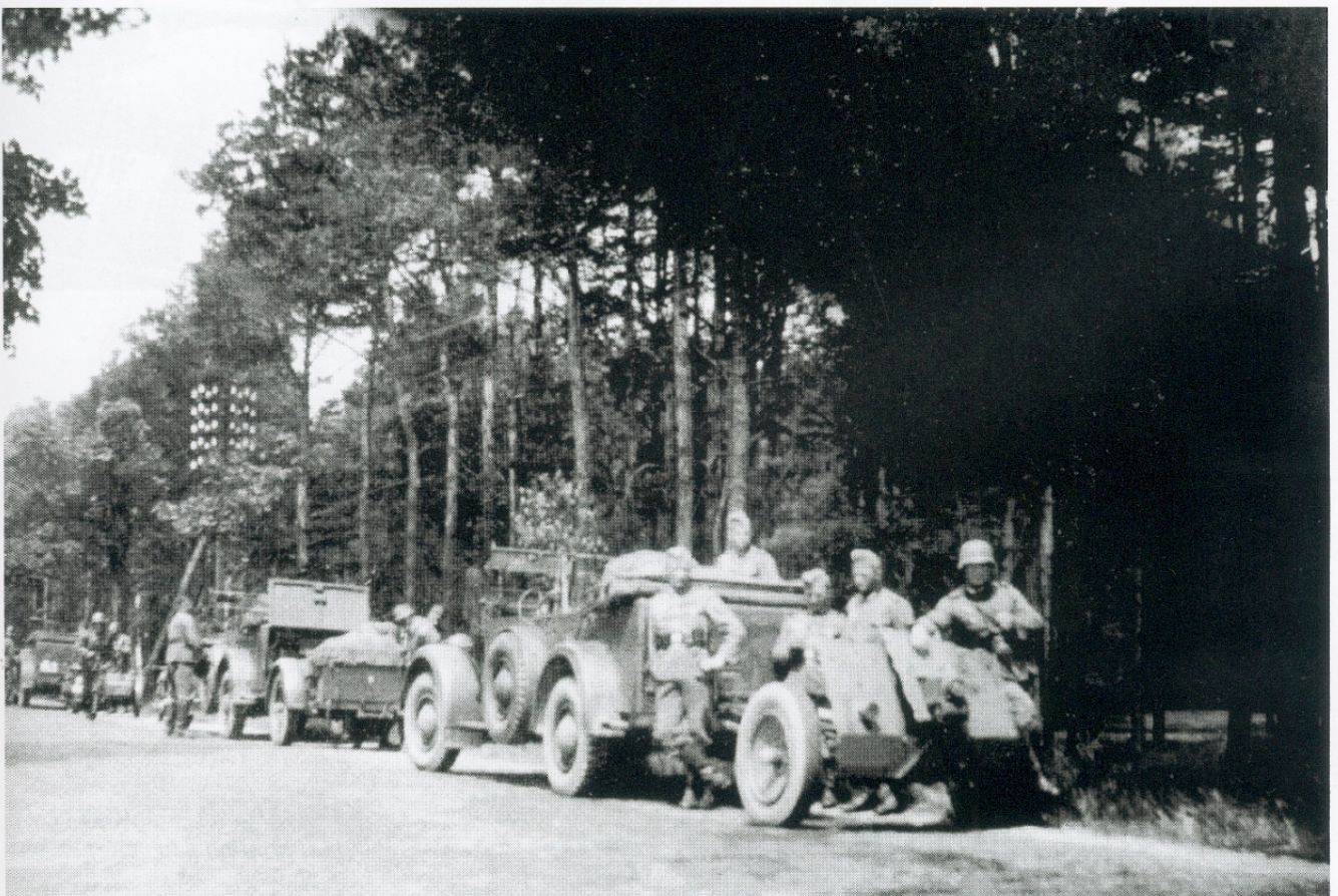
Bei dieser Infanteriegeschützkompanie dient der mittlere geländegängige Einheits-Pkw (4x4) als Zugmittel für das 7,5-cm-IIIG 18. Links das gleiche Fahrzeug, diesmal mit Anhänger (Sd. Ah. 32).
