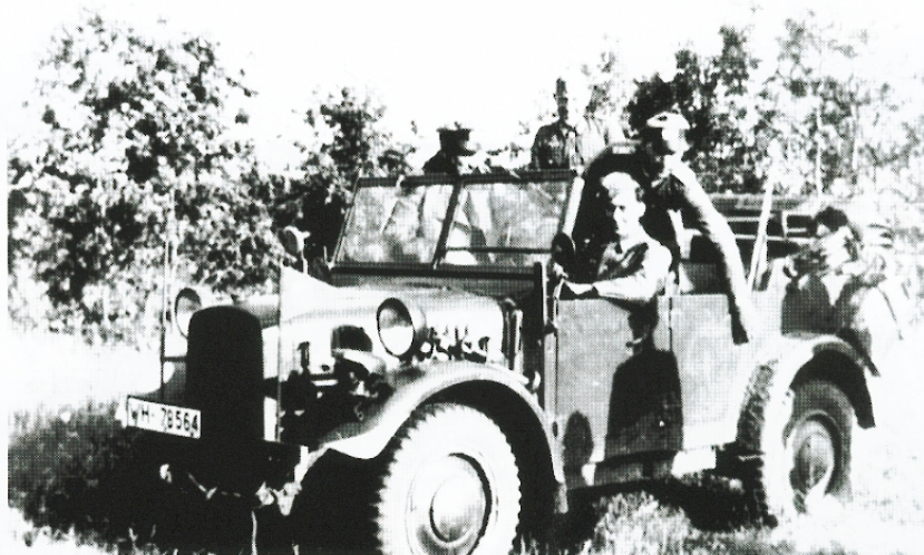
Ein Erinnerungsfoto mit dem leichten geländegängigen Einheits-Pkw (4x4). Hier ist der Notek-Tarnscheinwerfer auf dem vorderen Kotflügel gut zu erkennen.
