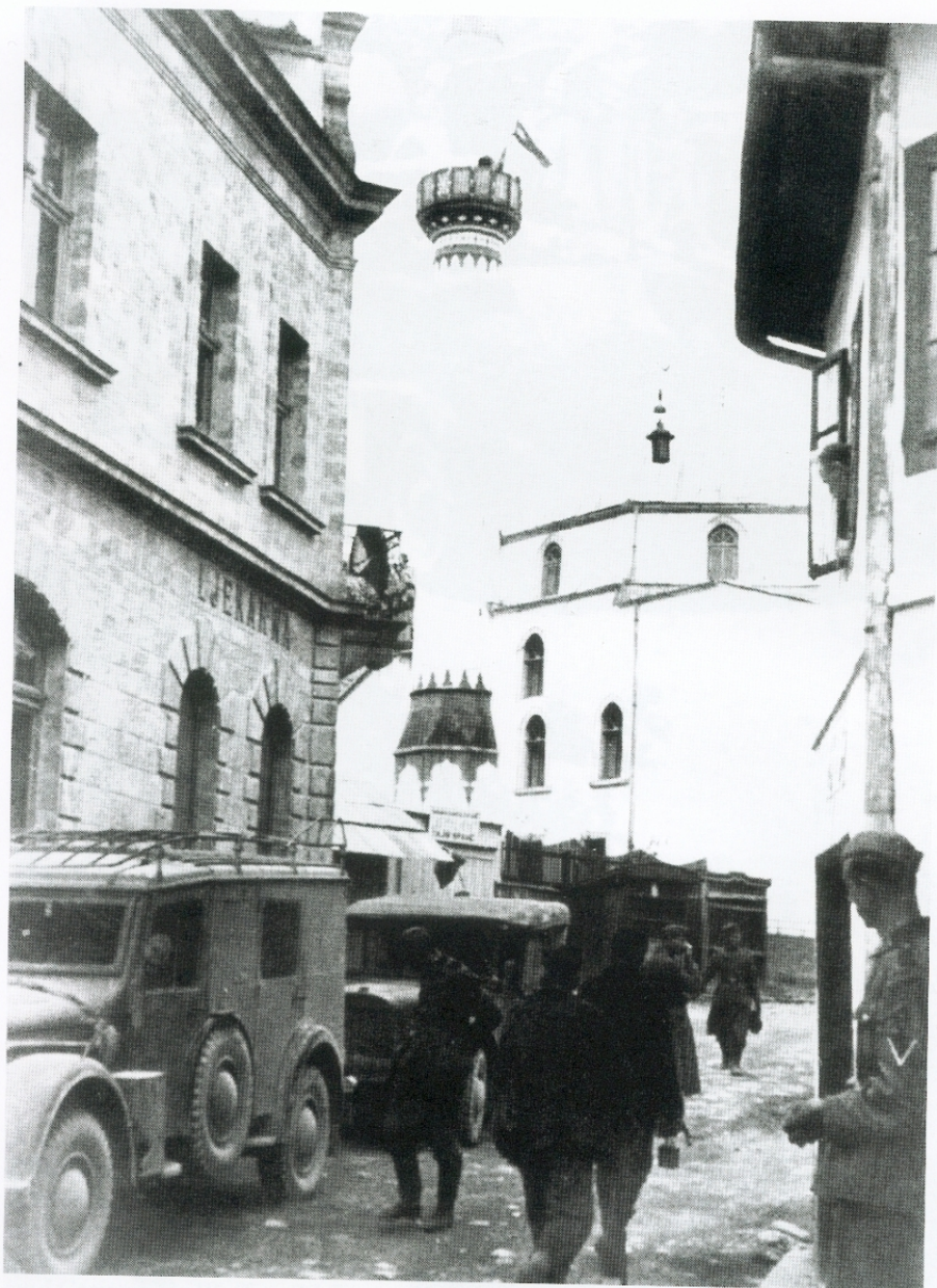
Dieses Foto vom Einsatz auf dem Balkan zeigt das Fahrzeug mit einer Rahmenantenne. Der größte Teil der Kfz. 17 war damit ausgerüstet.
