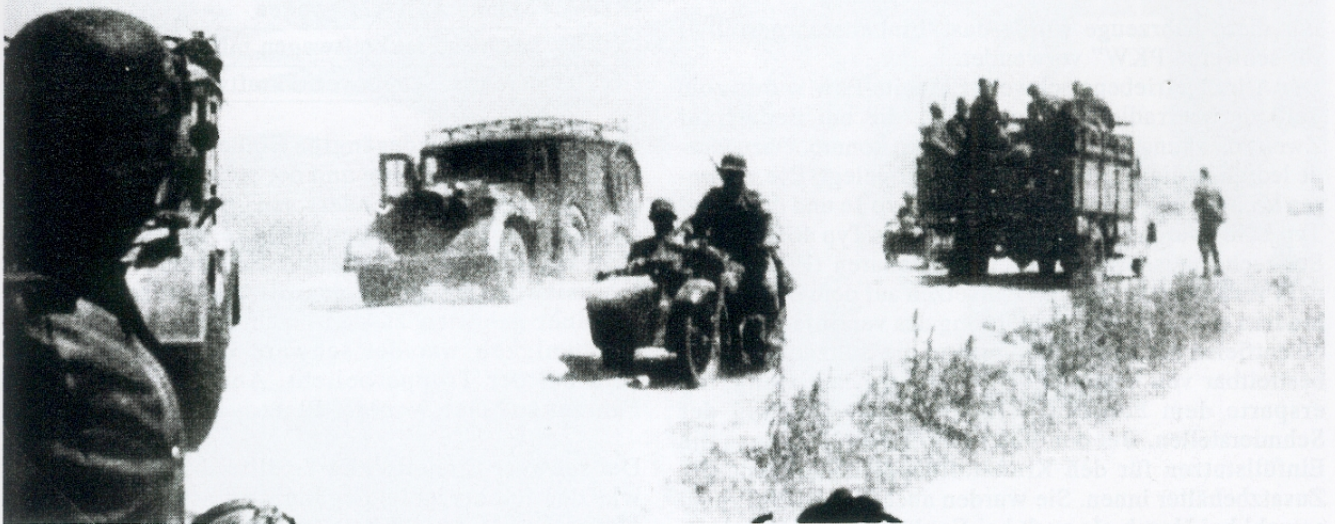
Unterwegs auf den Rollbahnen im Osten 1941. Der mittlere geländegängige Einheits-Pkw (4x4) (hier als Kfz. 17 mit Rahmenantenne) erreichte auf der Straße eine Höchstgeschwindigkeit von 90 km/h, im Gelände 50 km/h.
