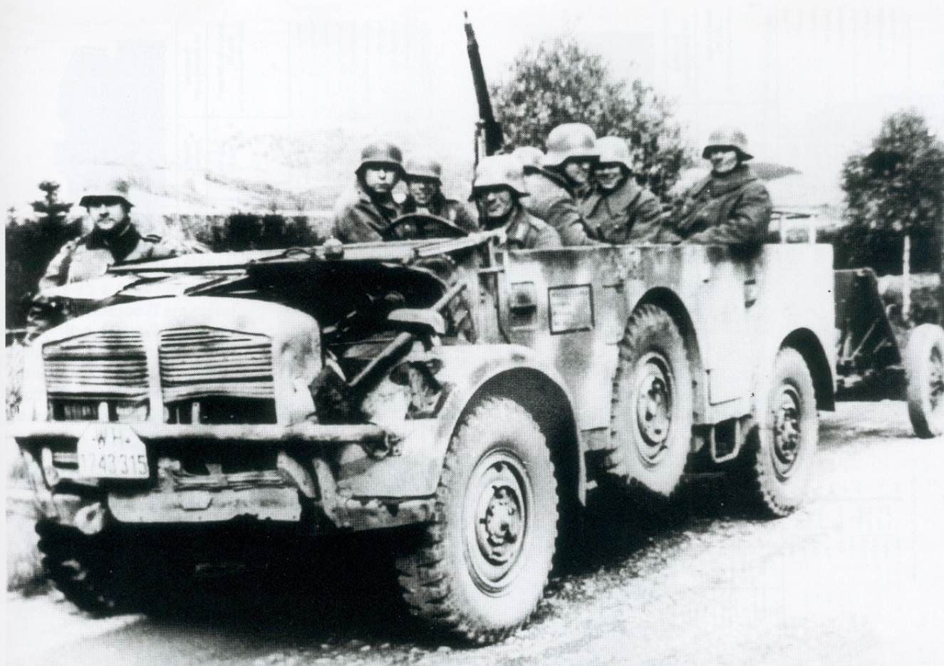
Der schwere geländegängige Einheits-Pkw (4x4) konnte als Mannschaftswagen auch kleinere Geschütze ziehen. Hier ist eine 4,5-cm-Panzerabwehrkanone II 81 (r) russ. 37 angehängt. Die Aufnahme entstand 1944 in den Karpaten.
