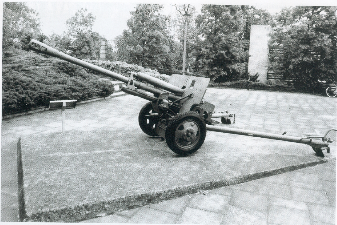
Die 7,62-cm-Divisionskanone zeichnete sich durch ihr geringes Gewicht, die hohe Beweglichkeit und Feuer- geschwindigkeit sowie durch eine einfache Konstruktion und leichte Bedienbarkeit aus.
