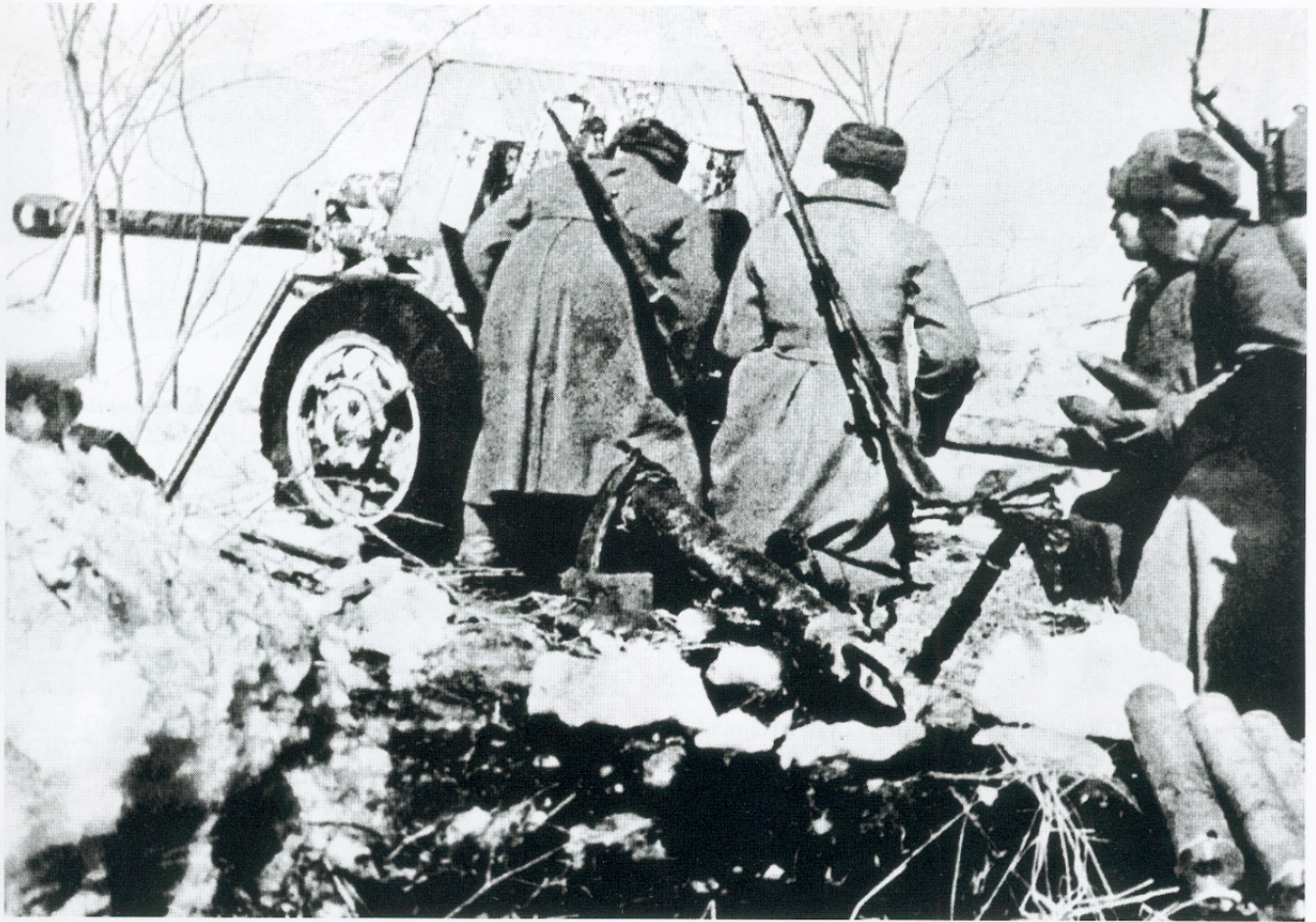
7,62-cm-Divisionskanone (ZIS-3) in Feuerstellung. Mit der Panzergranate konnten auf 500 m Entfernung 70 mm Panzerstahl durchschlagen werden (Auftreffwinkel 90 Grad), bei Verwendung der Unterkalibergranate ergab sich ein Wert, der bei 90 mm lag.
