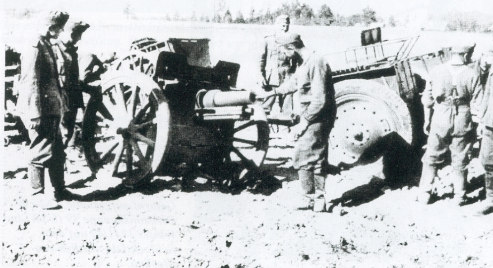
Als weiteres Geschütz mit einem Kaliber von 7,62-cm trat die Regimentskanone 27 in Erscheinung. Im Bild die Ausführung mit hartgummibereiften Holzspeichenrädern. Auch dieser Geschütztyp wurde von deutscher Seite in großer Zahl erbeutet und weiterverwendet.
