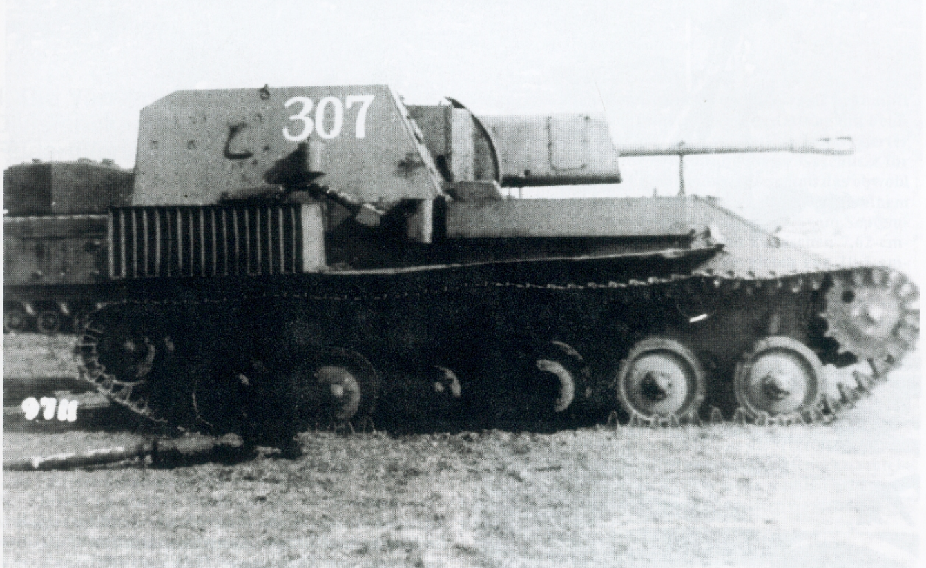
Die Abschlußausführung der Selbstfahrlafette mit der 7,62-cm-Divisionskanone 42 (ZIS-3) lief unter der Bezeichnung SU-76 M und war mit zwei auf der rechten Fahrzeugseite angeordneten 85-PS-Benzinmotoren ausgestattet. Das Gewicht lag bei über 10 t, die Panzerung war 10-35 mm stark.
