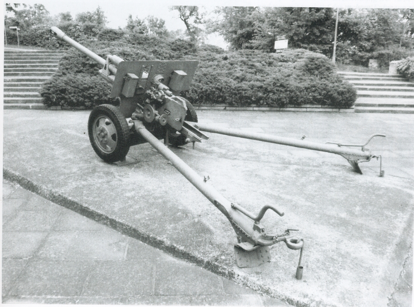
Die 7,62-cm-Divisionskanone zeichnete sich durch ihr geringes Gewicht, die hohe Beweglichkeit und Feuer- geschwindigkeit sowie durch eine einfache Konstruktion und leichte Bedienbarkeit aus.
