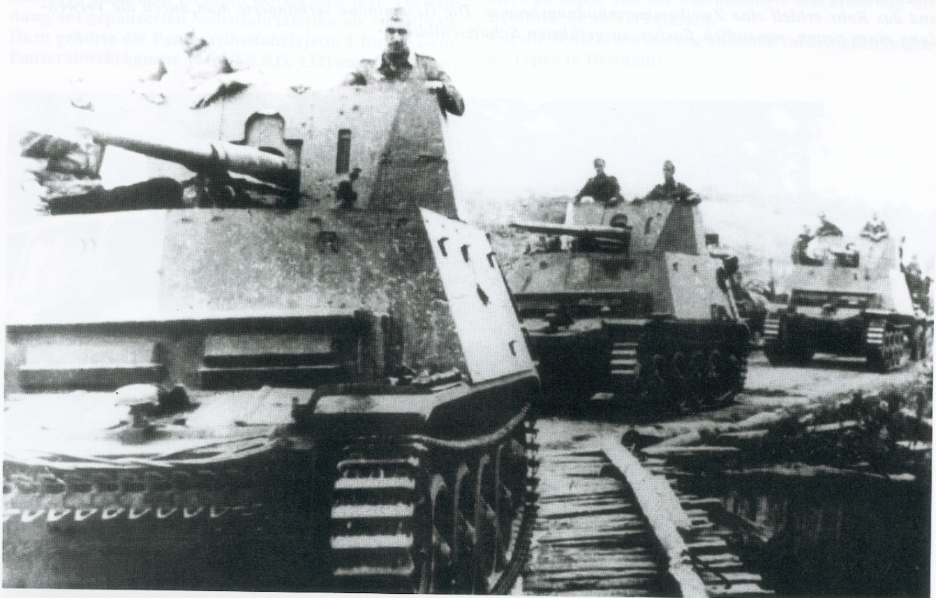
Von der Panzerselbstfahrlafette 1 für die 7,62-cm-Panzerabwehrkanone 36 auf dem Fahrgestell des Panzerkampfwagen II, Ausführung D (Sd.Kfz. 132) entstanden zwischen dem April 1942 und dem Juni 1943 201 Stück durch Umbau. Das hier gezeigte Bild ist 1942 im Südschnitt der Ostfront entstanden. Die Mündungsbremsen wurden zu dieser Zeit noch (aus Gründen der Zensur) retuschiert.
