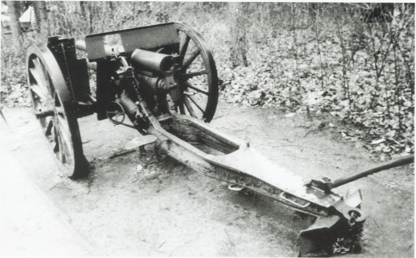
Eine 7,62-cm-Feldkanone 03 im Museumspark Overloon. Das Feldgeschütz war der Vorläufer der russischen Divisionskanonen im Zweiten Weltkrieg.
