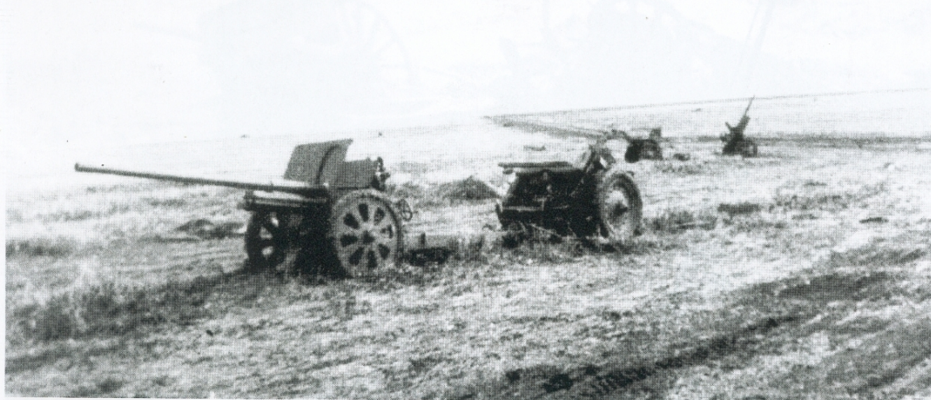
Von den deutschen Truppen erbeutete 7,62-cm-Divisionskanone 36 (F-22). Bemerkenswert: Das Geschütz ist mit geschweißten Stahlspeichenrädern versehen, die Protze mit gummibereiften Stahlscheibenrädern. Aufnahme aus dem Jahr 1941.
