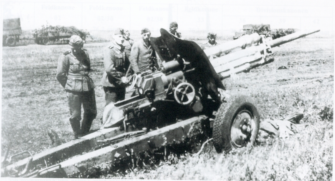
Eine erbeutete 7,62-cm-Divisionskanone 39. Charakteristisch ist die Spreizlafette mit Stahlscheibenrädern und schußsicherer Luftbereifung. Der Luftvorholer war nun über dem Rohr angeordnet.
