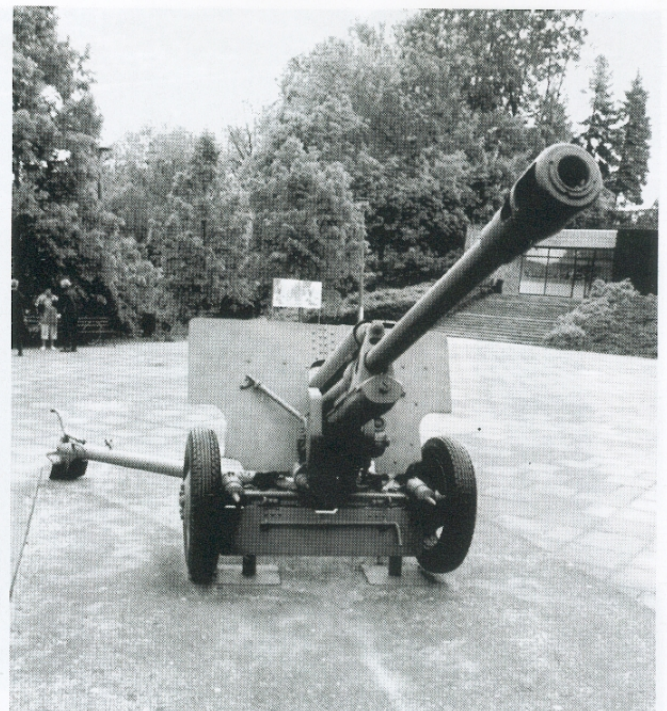
7,62-cm-Divisionskanone 42 (ZIS-3), Ausführung mit zweiteiligem Schutzschild.
