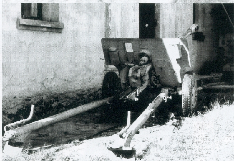
Diese Aufnahme zeigt anschaulich die leichte Bauweise der Geschützlafette.
