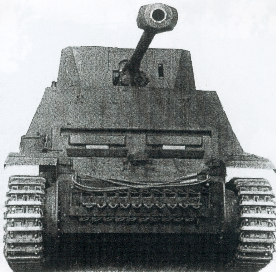
Frontansicht der Panzerselbstfahrlafette 1 (Fahrzeughöhe 2,60 m!) Laut Überblick Rüstungsstand des Heeres vom 1. November 1944 gab es zu diesem Zeitpunkt noch 55 Fahrzeuge des Typs.
