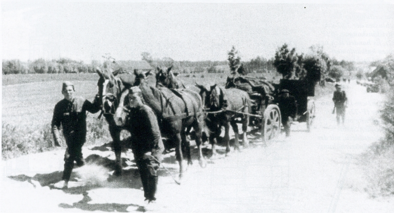
Die 7,62-cm-Divisionskanone 36 (F-22) mit geschweißten Stahlspeichenrädern. Das Geschütz wurde vierspännig hinter einer Protze gefahren, auf der neben dem Zubehör 24 Granatpatronen mitgeführt werden konnten.
