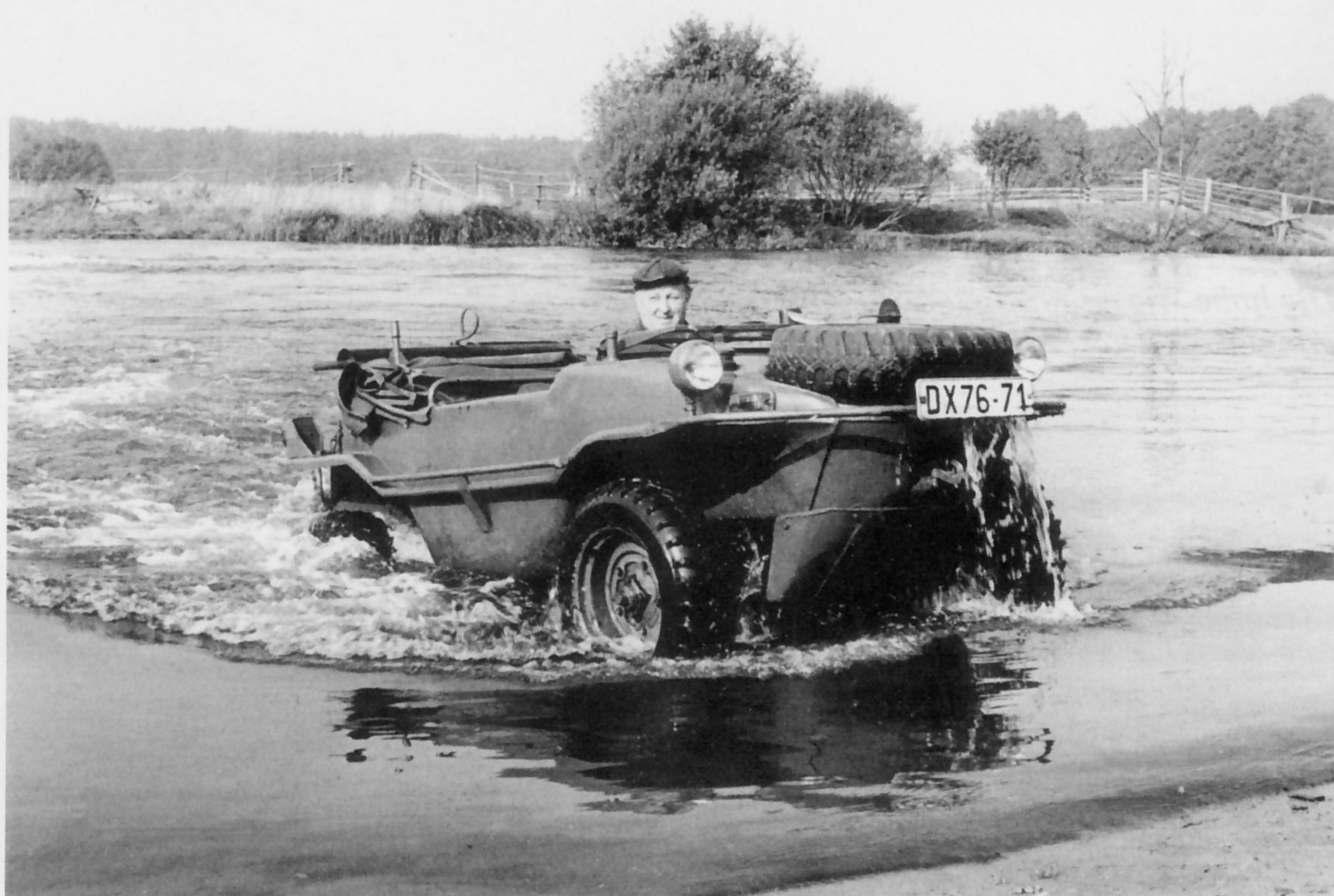
Zwischen den hinteren Sitzen ist ein Teil des Luftaustritts der Kühlung gut zu erkennen. Vorn deutlich zu sehen einer der beiden Tankeinfüllstutzen.
