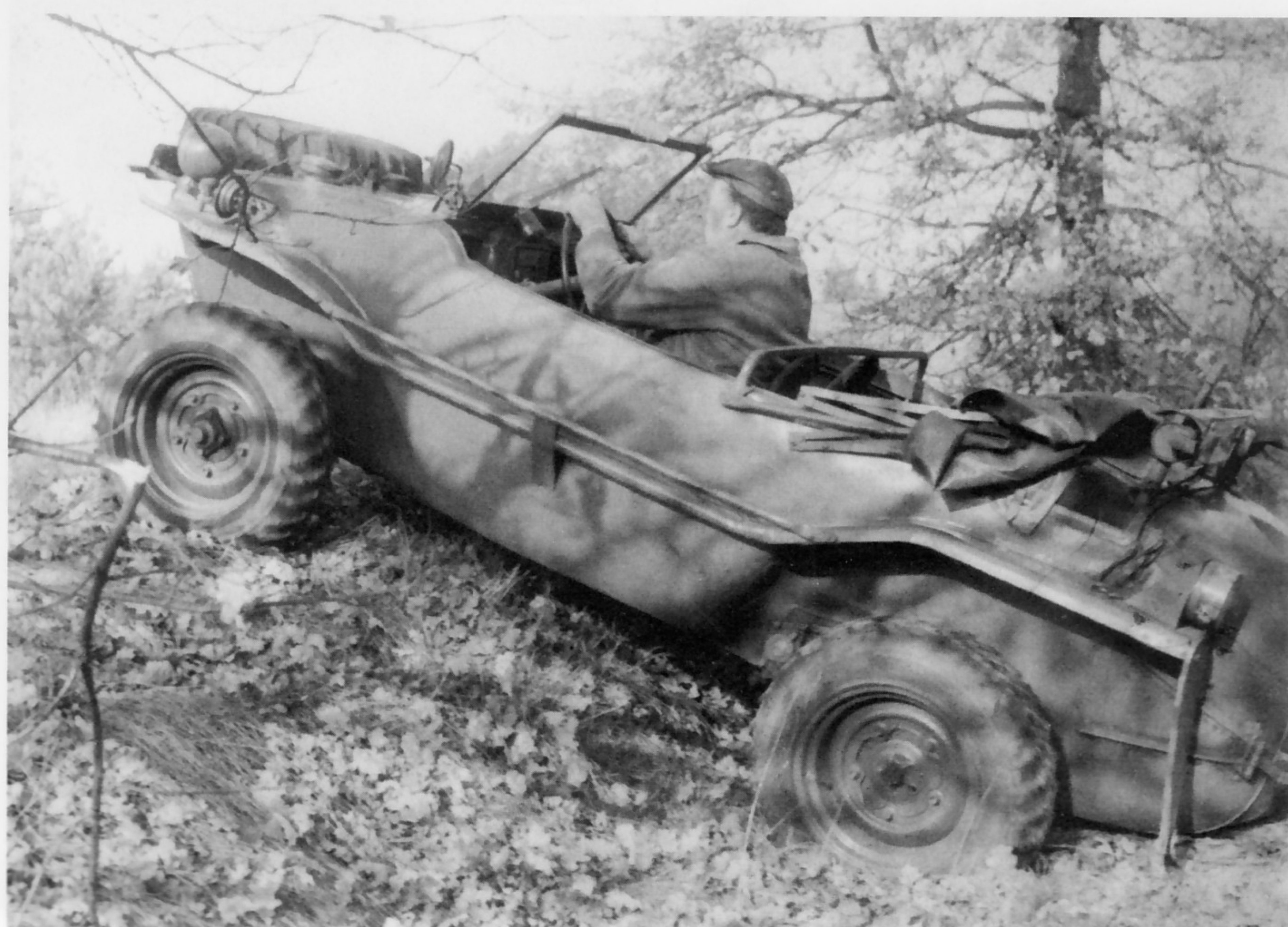
Das Verdeck ist offen. Gut zu sehen sind dabei seine Verstreben im zusammengeklappten Zustand.
