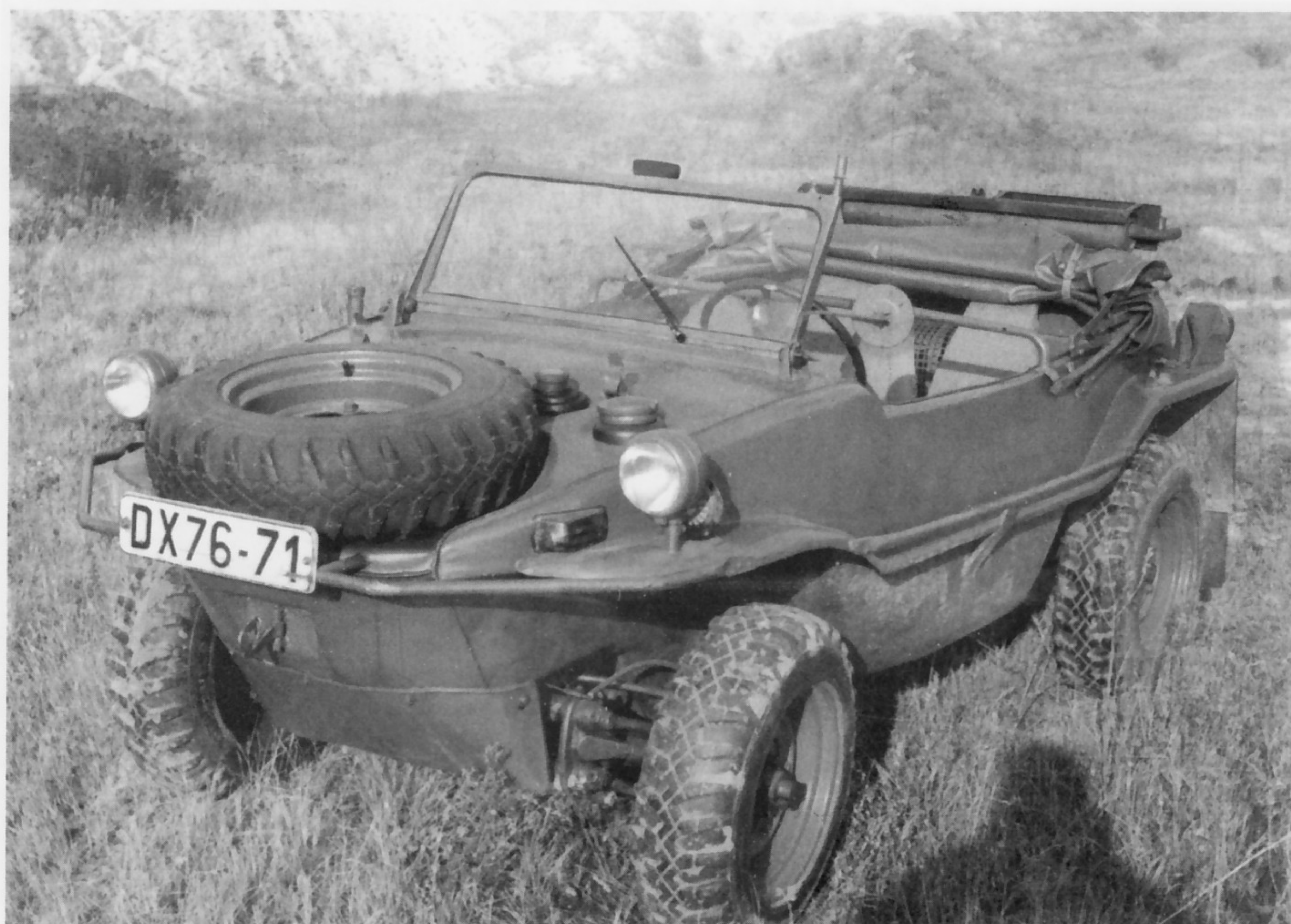
Zwischen den hinteren Sitzen ist ein Teil des Luftaustritts der Kühlung gut zu erkennen. Vorn deutlich zu sehen einer der beiden Tankeinfüllstutzen.
