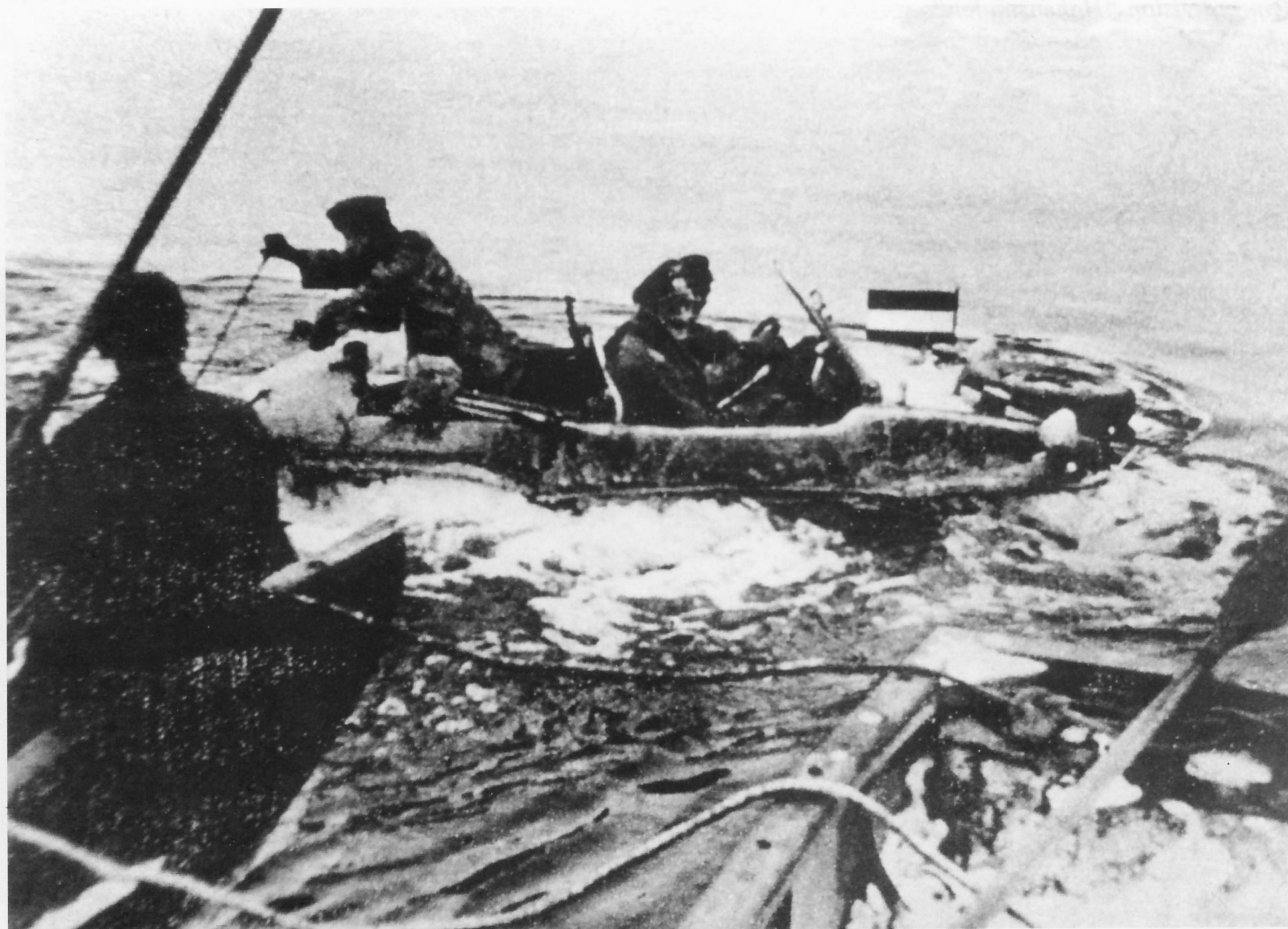
Hier ist gut zu sehen, wie das Fahrzeug auf den Übergang zur Landfahrt vorbereitet wird. Die Schiffsschraube wird angehoben, um die nötige Bodenfreiheit herzustellen.
