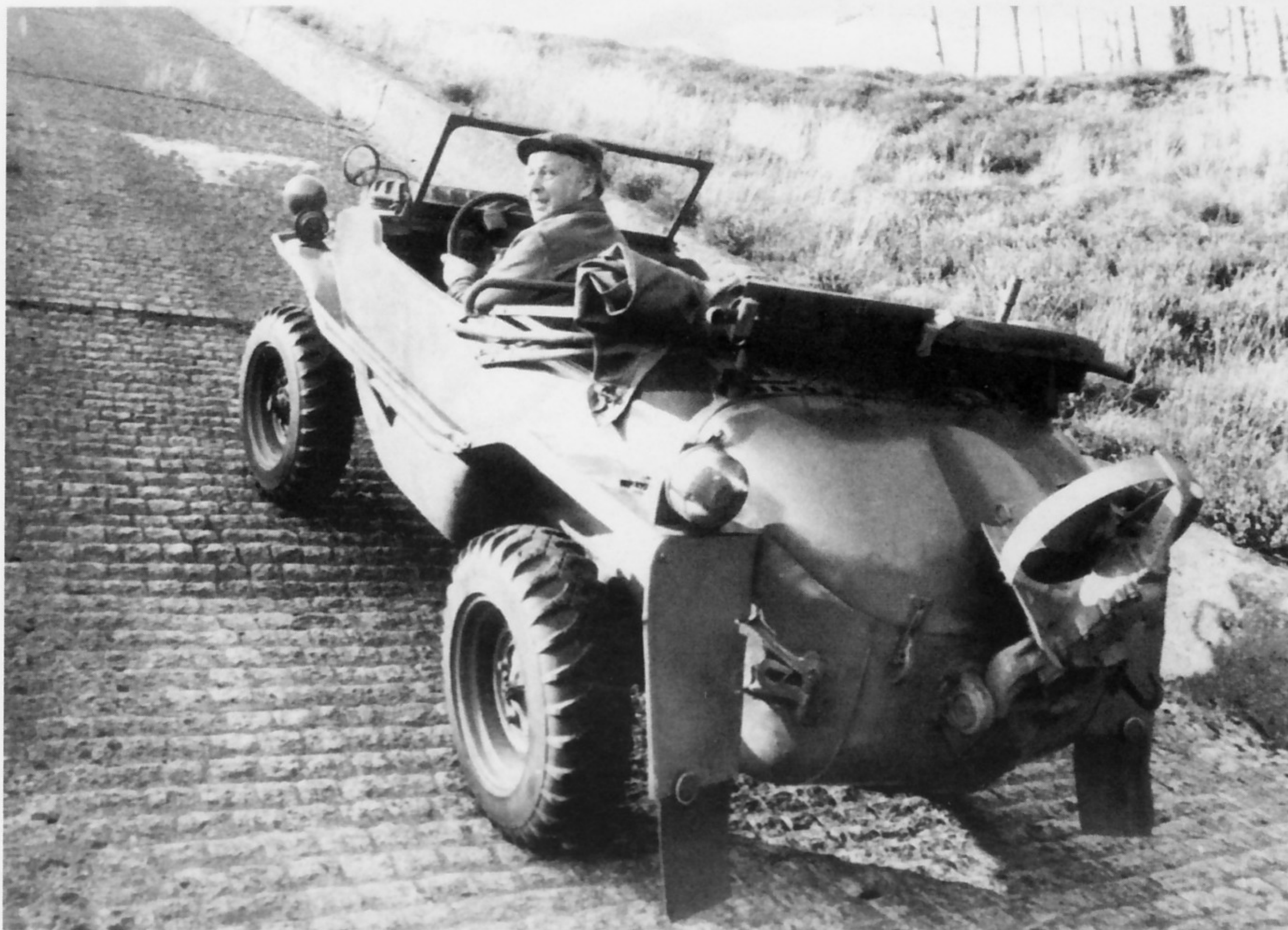
Der VW-Schwimmkübel bewies hervorragende Geländegängigkeit, hier demonstriert auf der Steigungsbahn der ehemaligen Heeresversuchsanstalt Kummersdorf (oben). Unten ein Schnittbild durch das Gesamttriebwerk des Fahrzeugs.
