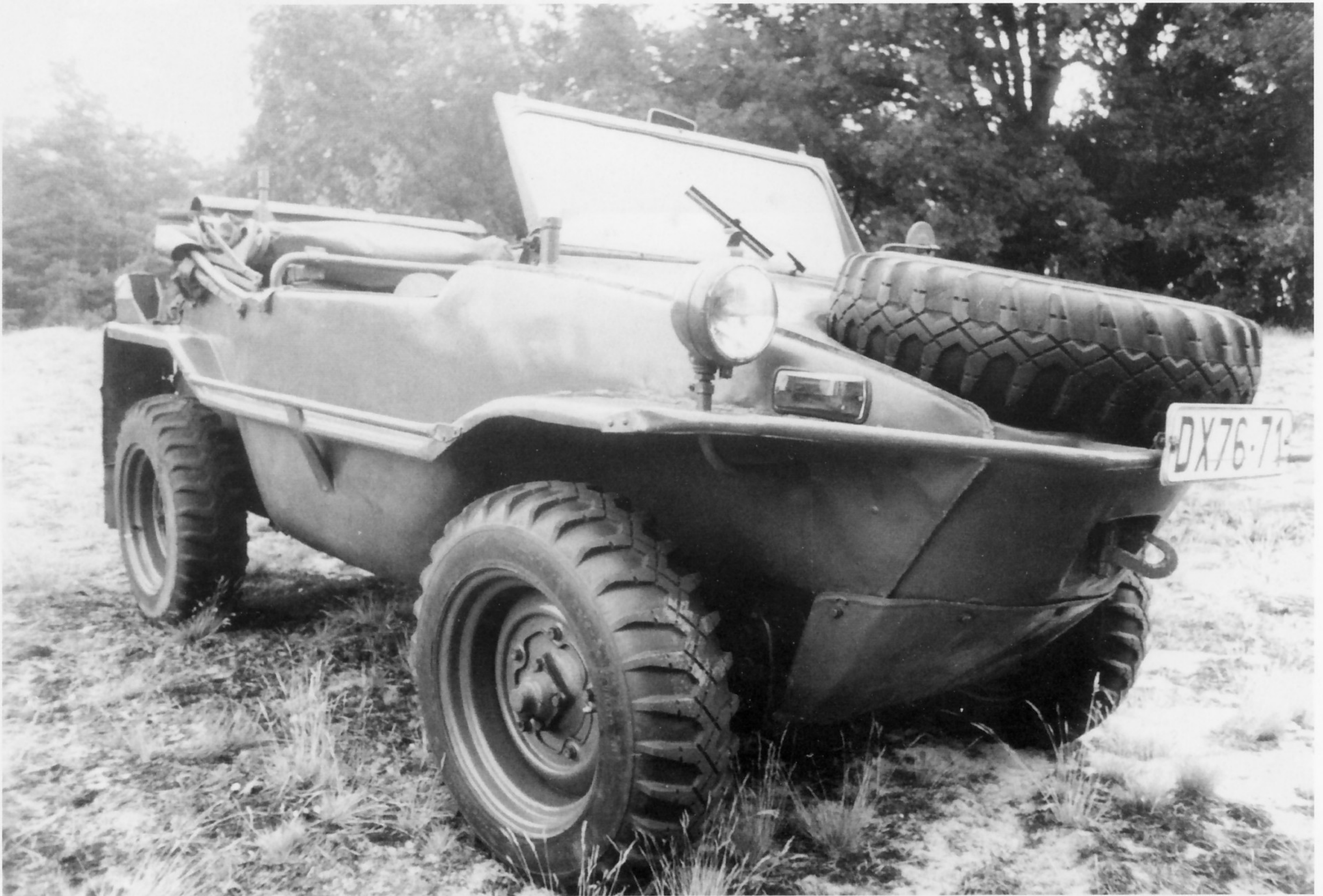
Hier ist die Befestigung der Stoßstange und der seitlichen Trittsange gut zu erkennen.
