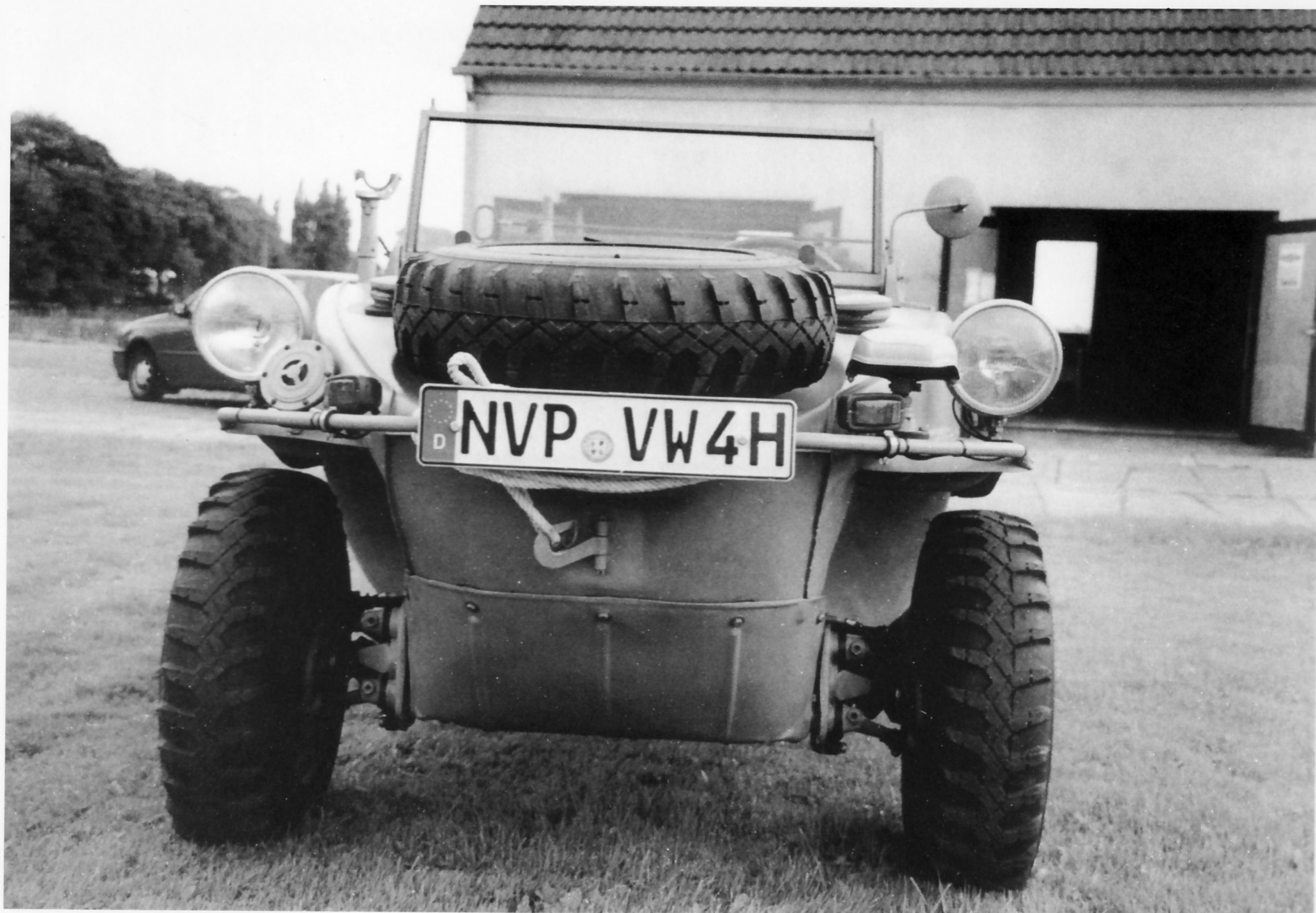
Front- und Heckansicht des VW-Schwimmkübels. Hier sind das vorn befestigte Ersatzrad und die dreiflüglige Schiffsschraube am Heck gut zu erkennen. Hinter den Sitzen ist die Stange zum Herablassen der Schiffsschraube bei Wasserfahrt angebracht. Das gut restaurierte Fahrzeug ist im Besitz eines Mecklenburger Sammlers.
