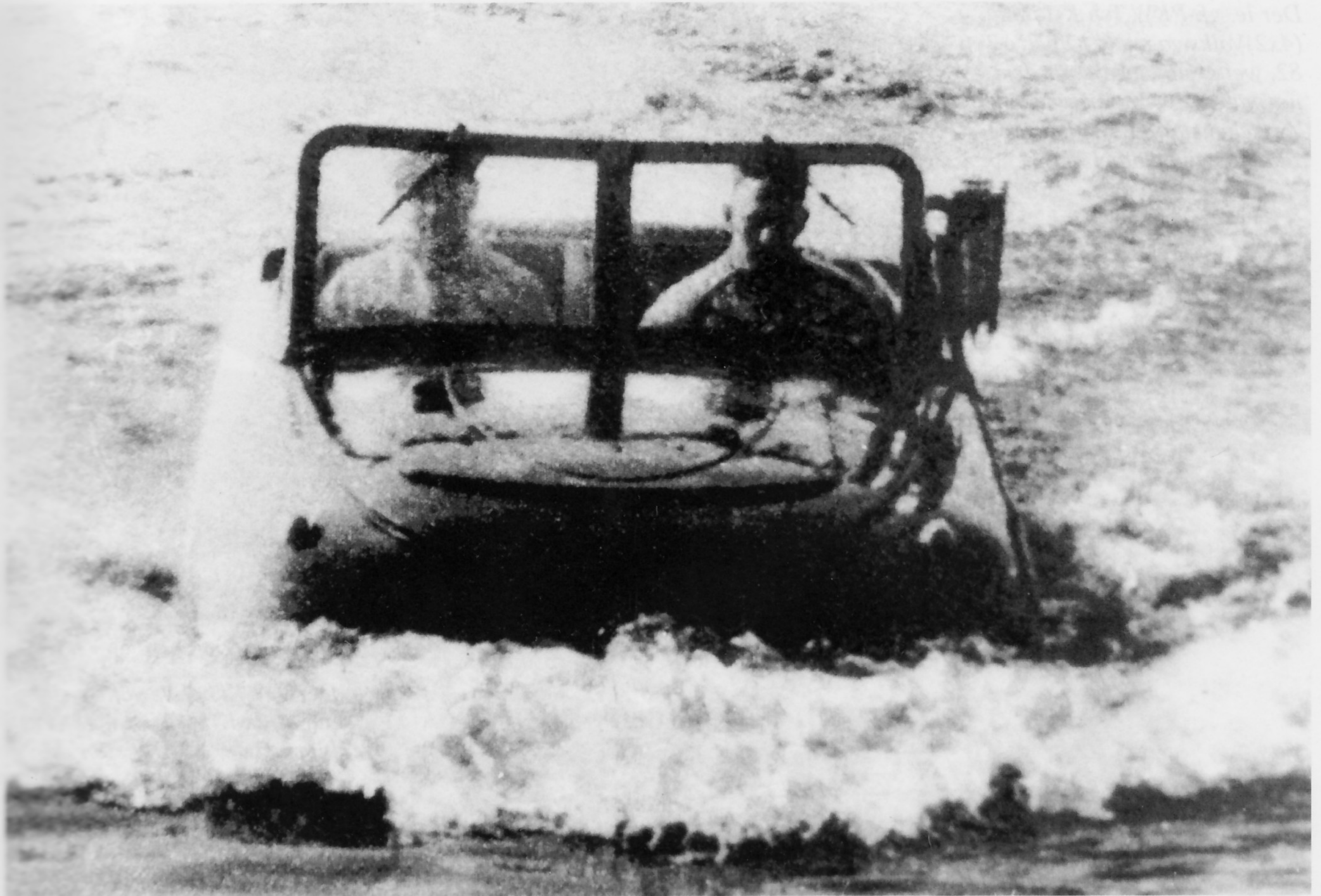
Die Vorzüge des Trippel-Wagens SG 6 (oben eine Aufnahme bei Wasserfahrt) und die des leichten geländegängigen Einheitskübels (Kfz 1) der Firma Stöwer (unten) wurden bei der Konstruktion des VW-Schwimmkübel vereint.
