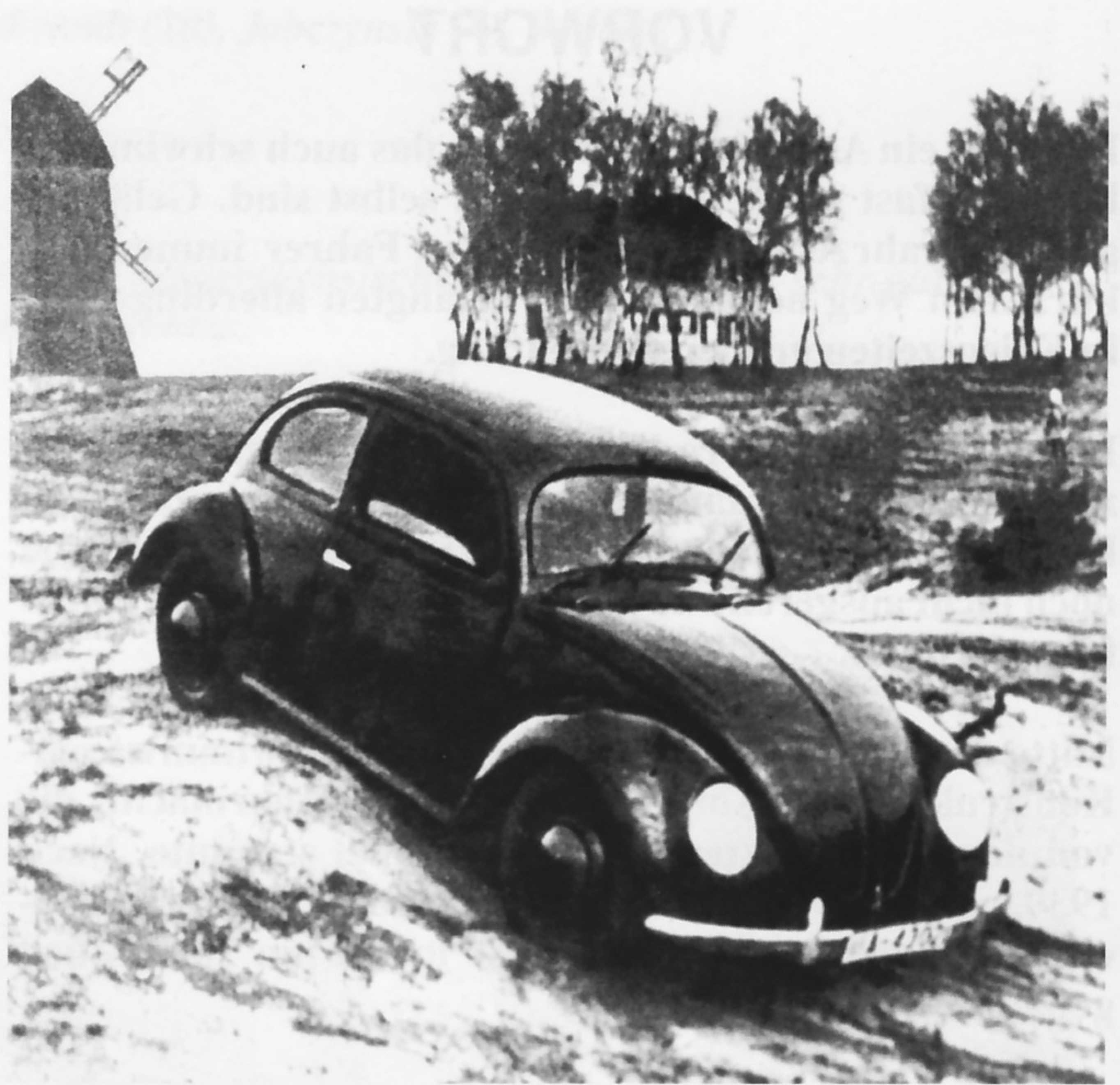
Der zivile VW "Käfer" wurde vom Heereswaffenamt erprobt und war Ausgangsform für die Umkonstruktion zum Schwimmkübel. Erkennungsmerkmal war u. a. das so genannte "Brezelfenster" im Heck.
