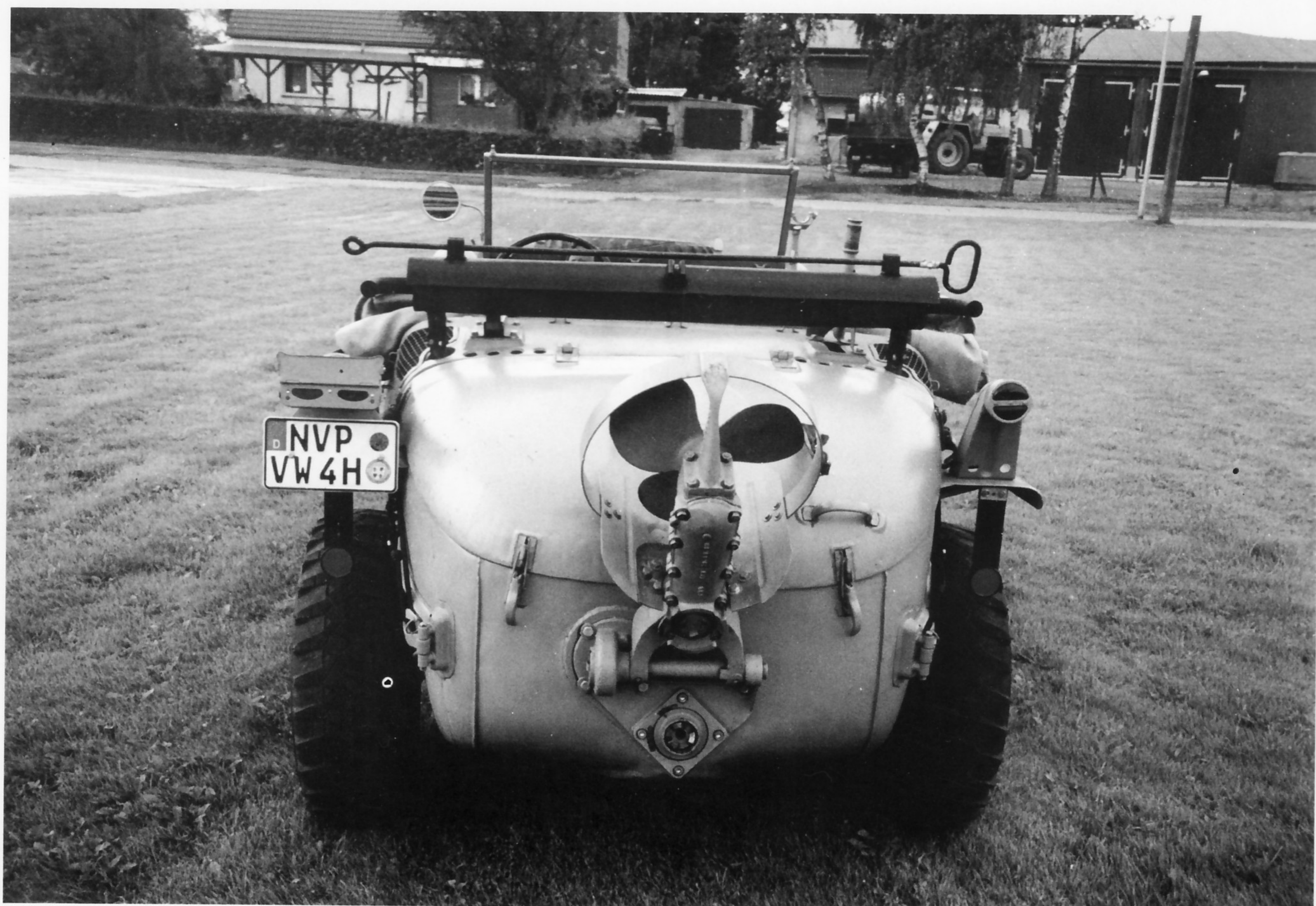
Front- und Heckansicht des VW-Schwimmkübels. Hier sind das vorn befestigte Ersatzrad und die dreiflüglige Schiffsschraube am Heck gut zu erkennen. Hinter den Sitzen ist die Stange zum Herablassen der Schiffsschraube bei Wasserfahrt angebracht. Das gut restaurierte Fahrzeug ist im Besitz eines Mecklenburger Sammlers.
