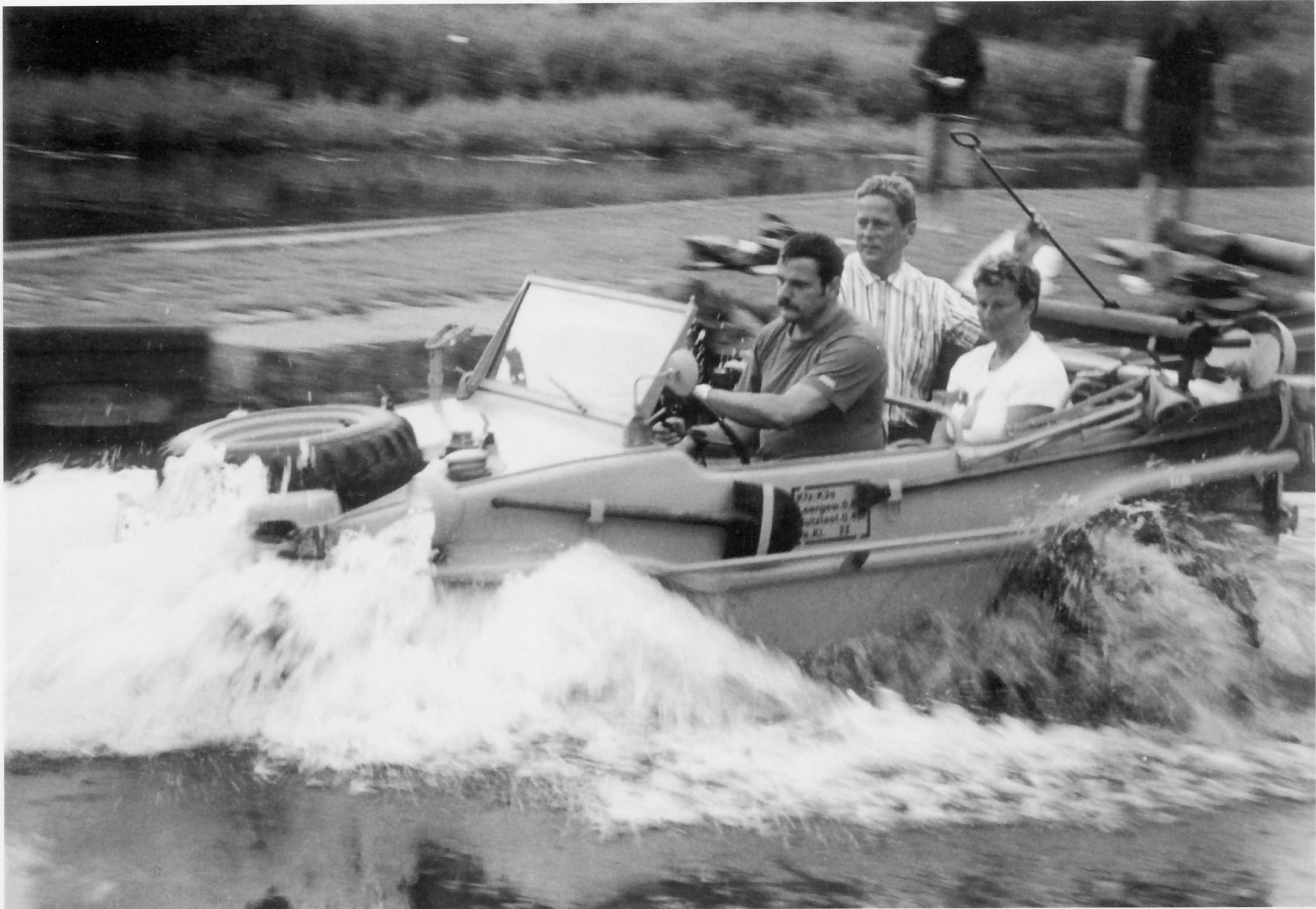
Dieses Fahrzeug eines Mecklenburger Sammlers wird ins Wasser gefahren. Der Mitfahrer hält die Stange zum Herablassen der Schiffsschraube schon bereit.
