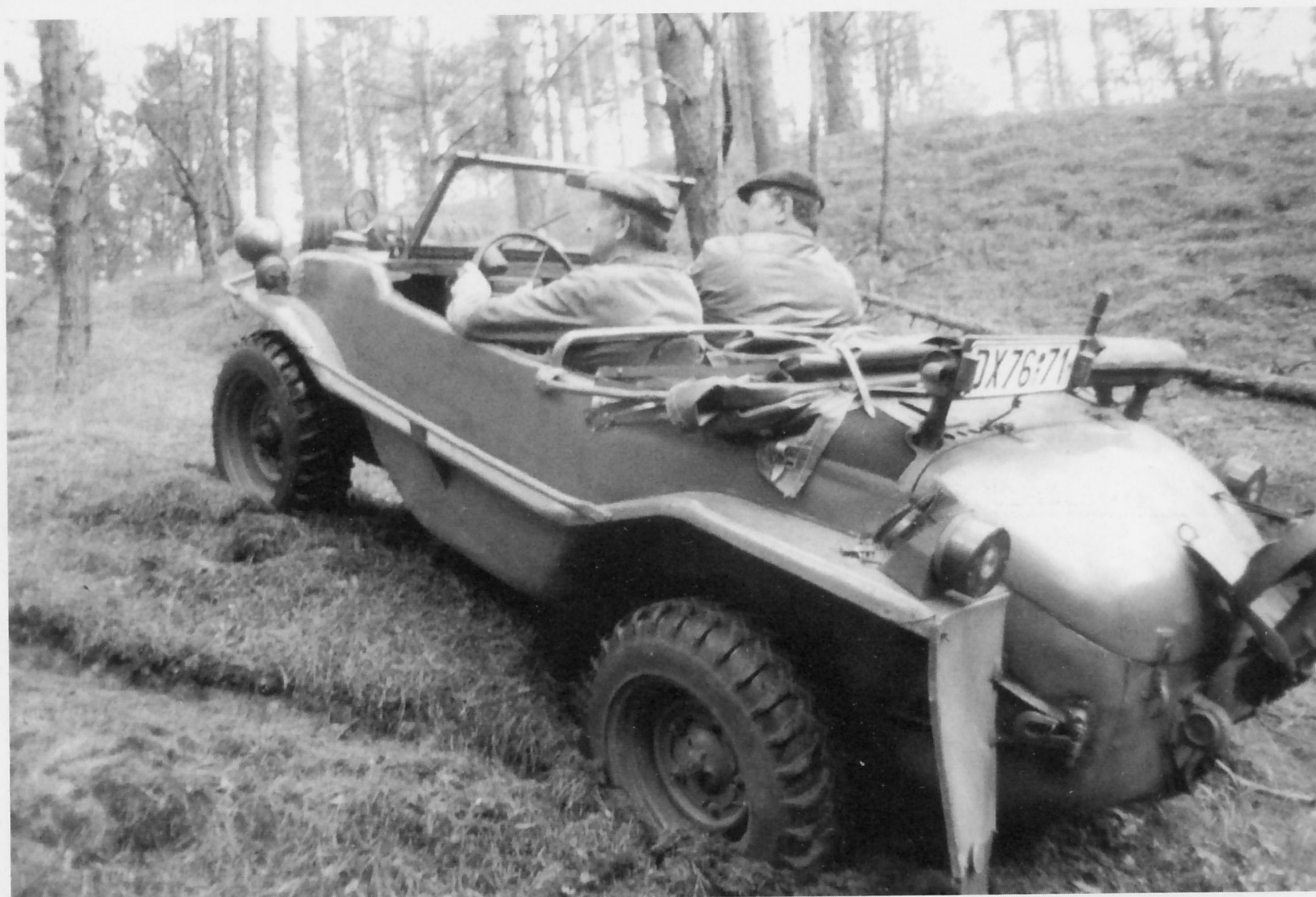
Die Bodenfreiheit ohne Belastung beträgt 265 mm, unter Belastung 245 mm. Damit ist eine Geländegängigkeit nicht beeinträchtigt.
