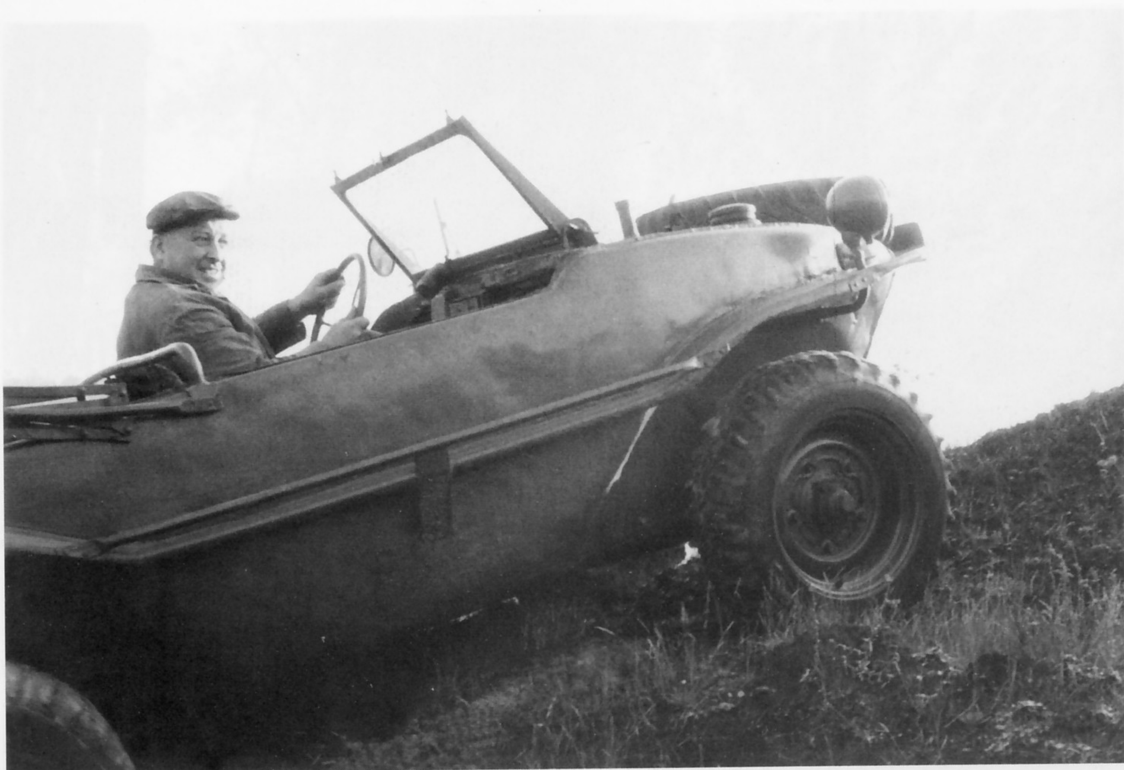
Die Bodenfreiheit ohne Belastung beträgt 265 mm, unter Belastung 245 mm. Damit ist eine Geländegängigkeit nicht beeinträchtigt.
