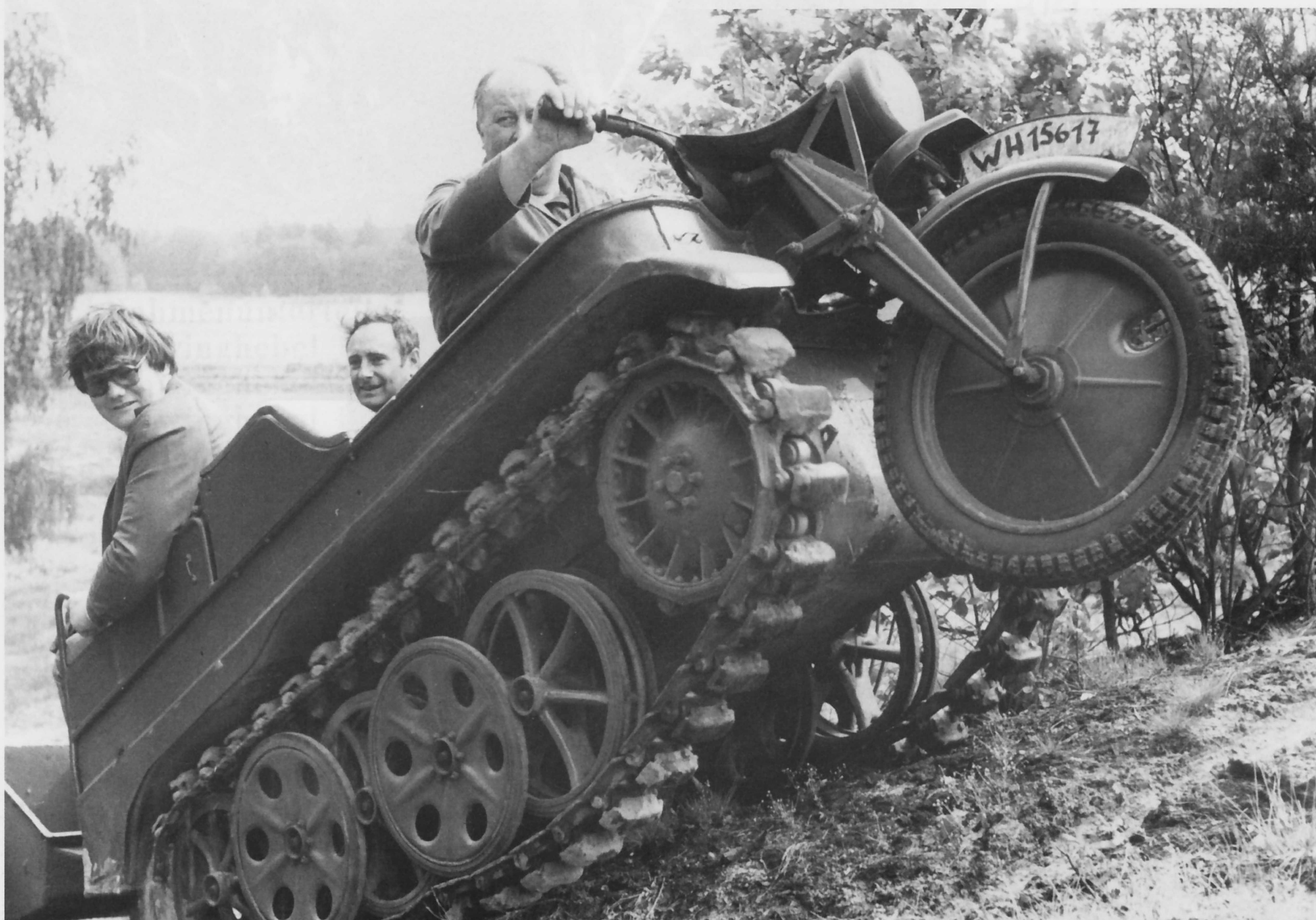
Dieses Foto entstand im Mai 1984 bei einem Fahrzeugsammler in Brandenburg. Deutlich zu sehen ist hier die 170 mm breite Gleiskette mit Gummipolstern auf den 40 Gliedern.
