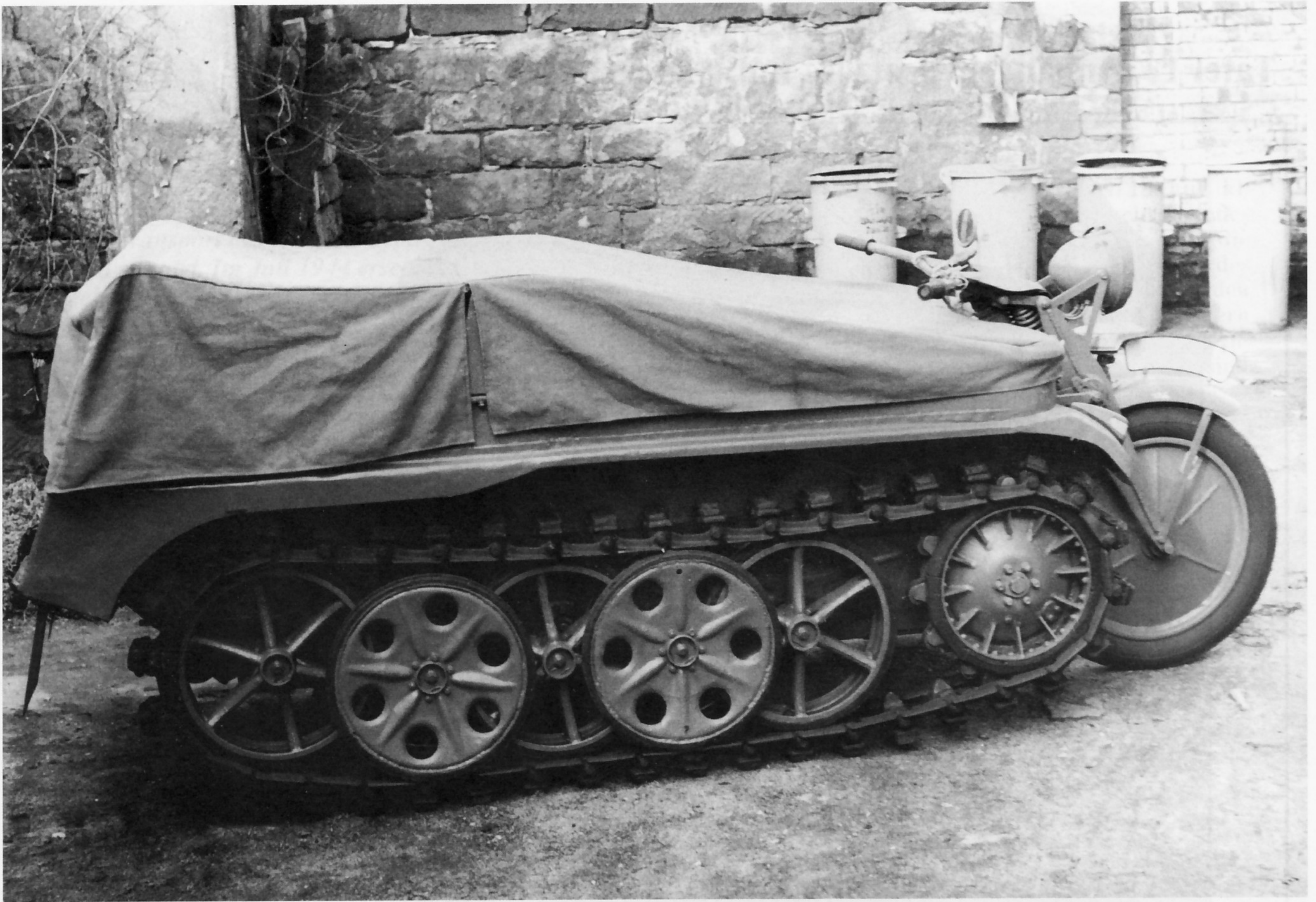
Gegen Witterungseinflüsse war das Kleine Kettenkrafttrad HK-101 (Sd.Kfz.2) mit einer Wetterschutzplane versehen. Sie wurde aufgerollt hinter den beiden Beifahrersitzen transportiert. Bei Bedarf konnte sie ausgerollt und über das gesamte Fahrzeug gerollt werden.
