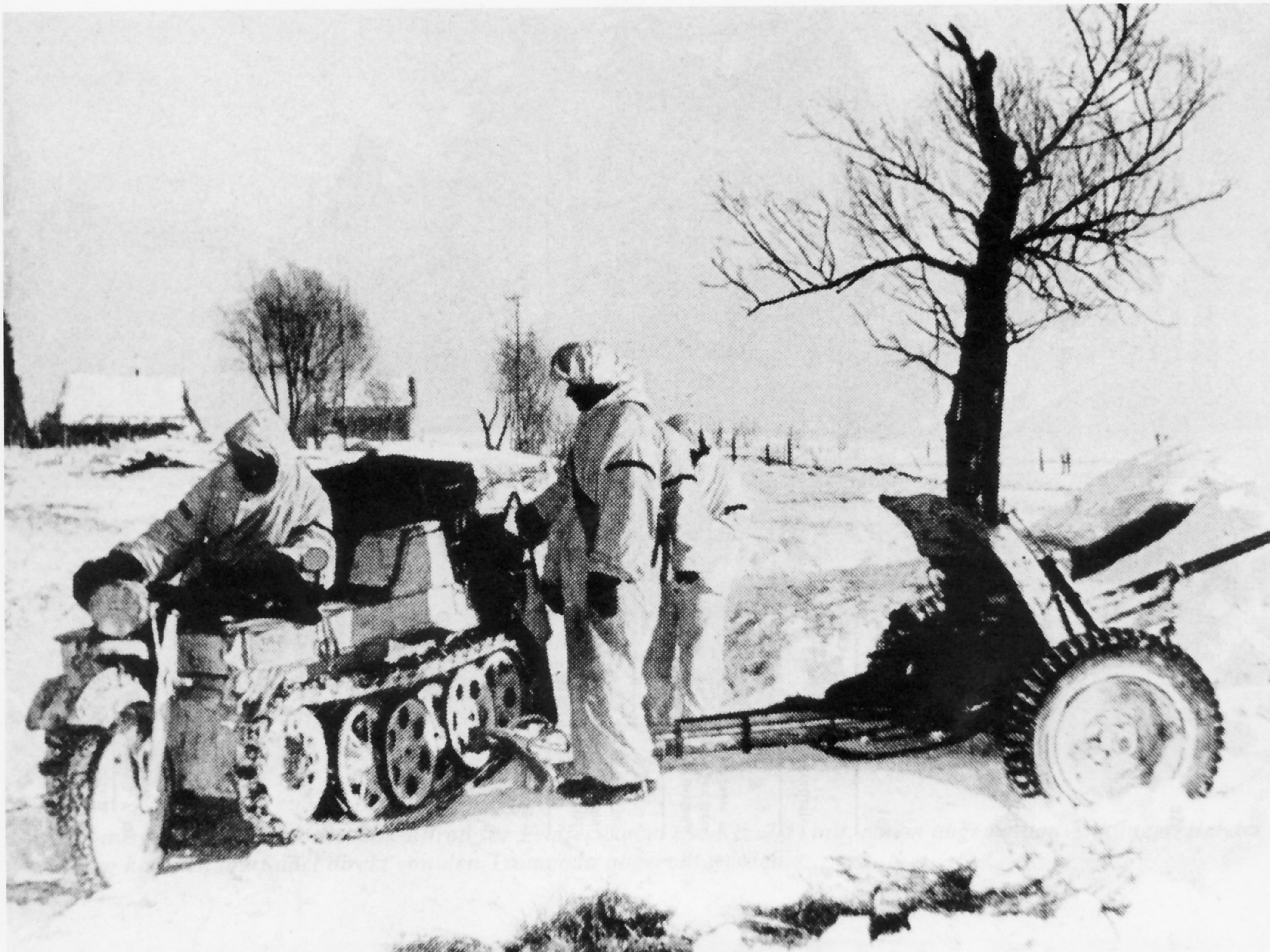
Das Kleine Kettenkrafttrad HK-101 (Sd.Kfz. 2) im Wintereinsatz bei der 5. Jägerdivision mit angehängter 3,7-cm-Panzerjägerkanone. Gebirgsjägerkompanien (zu zwölf Geschützen) verfügten lt. Kriegsständenachweis vom 1.11.44 über drei Kettenkräder je Zug für Geschütze und sechs Kettenkräder mit Anhänger für Munition.
