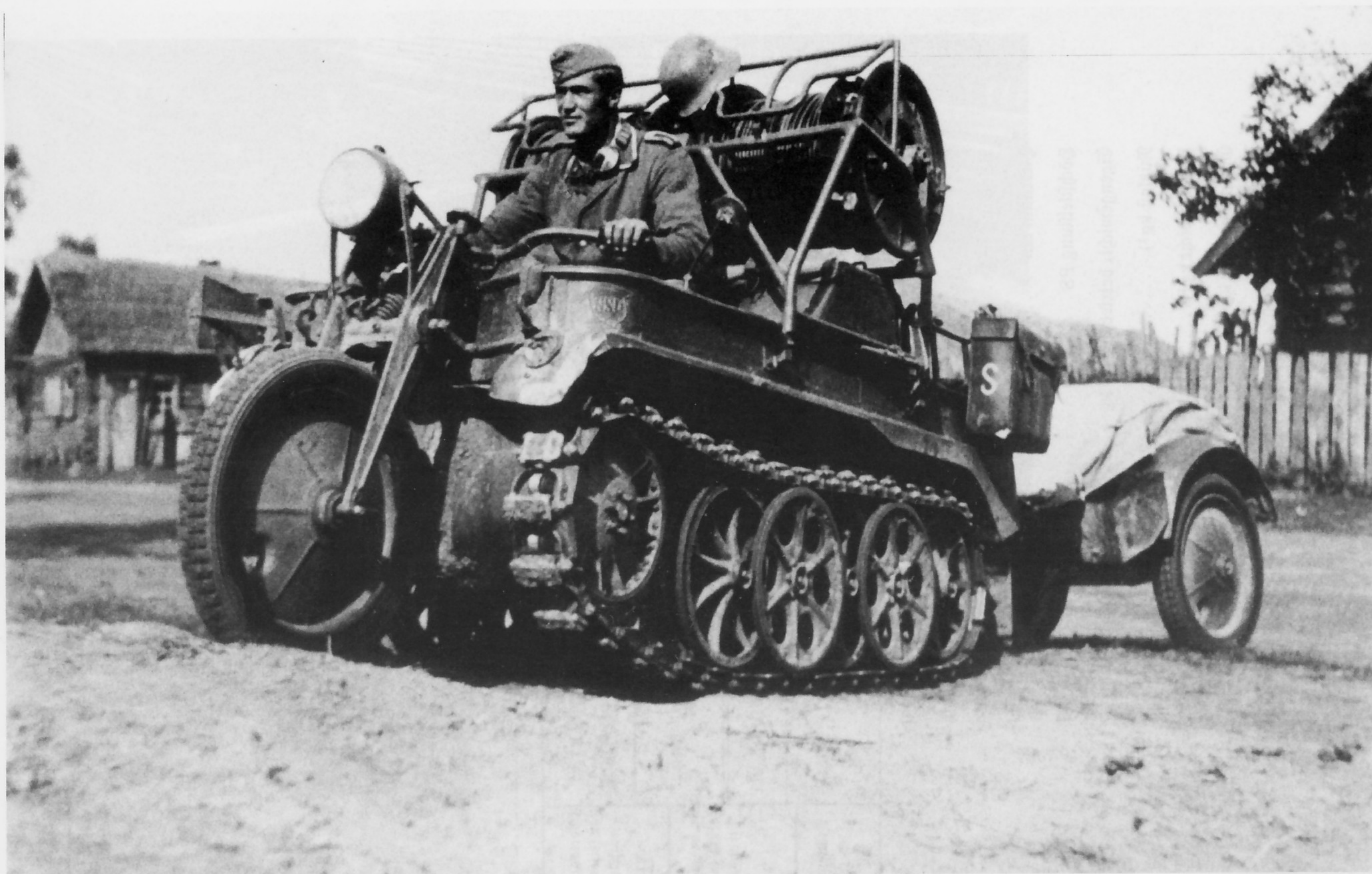
Das voll ausgerüstete Kleine Kettenkrafttrad für Feldfern kabel (Sd.Kfz. 2/1) mit einem abgeplanten Anhänger. Bei der Verlegung konnten die Kabel direkt von den Trommeln abgerollt werden.
