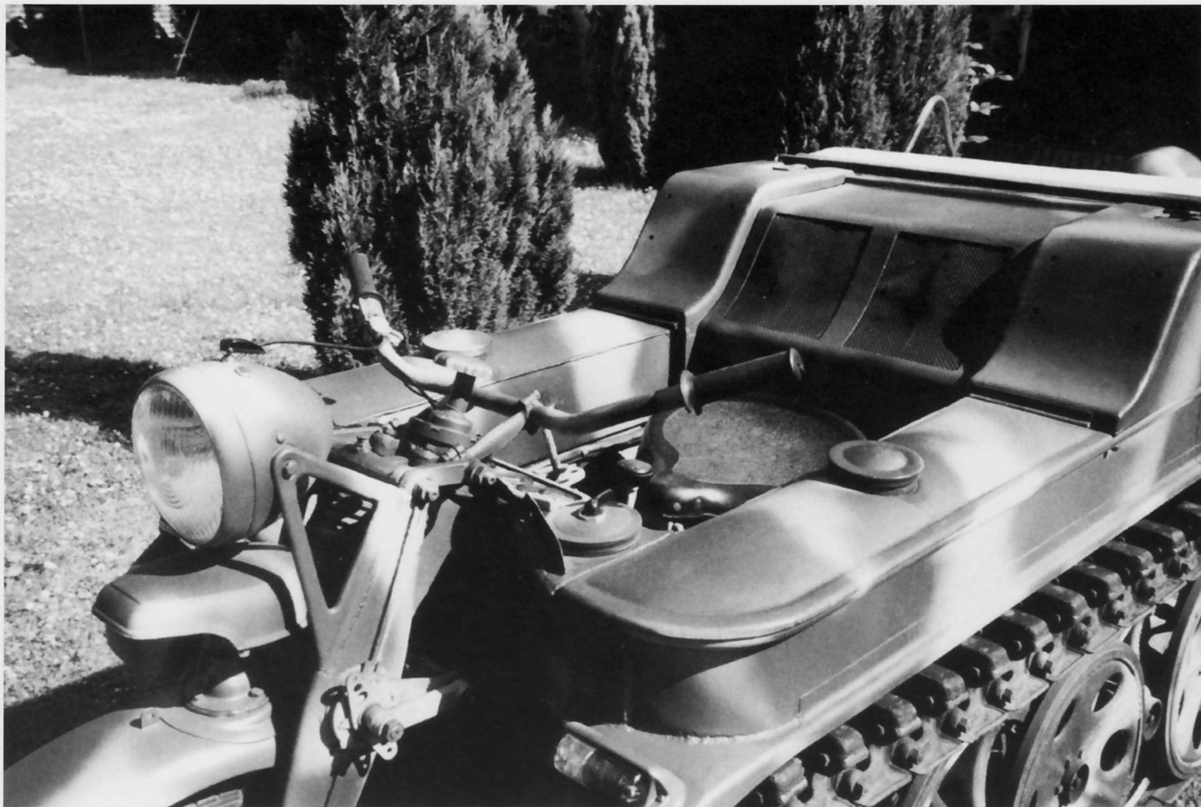
Als Fahrersitz fand der Sattel des 600-ccm-NSU-Motorrades Verwendung.
