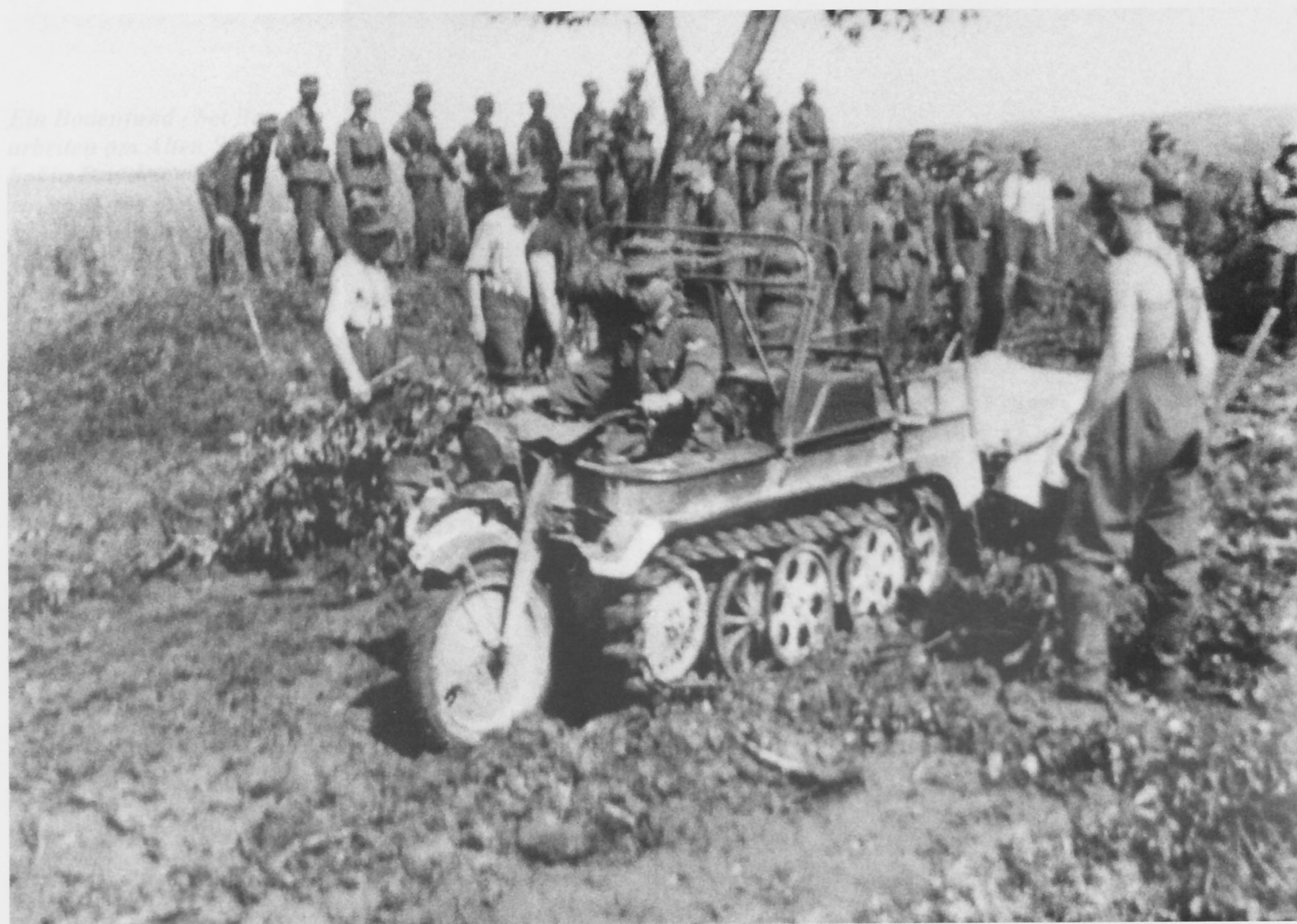
Das Kleine Kettenkrafttrad für schweres Feldkabel (Sd.Kfz. 2/2) mit dem einachsigen Anhänger (Sd.Ah. 2/2) bewältigte aufgeweichten Untergrund ohne Probleme.
