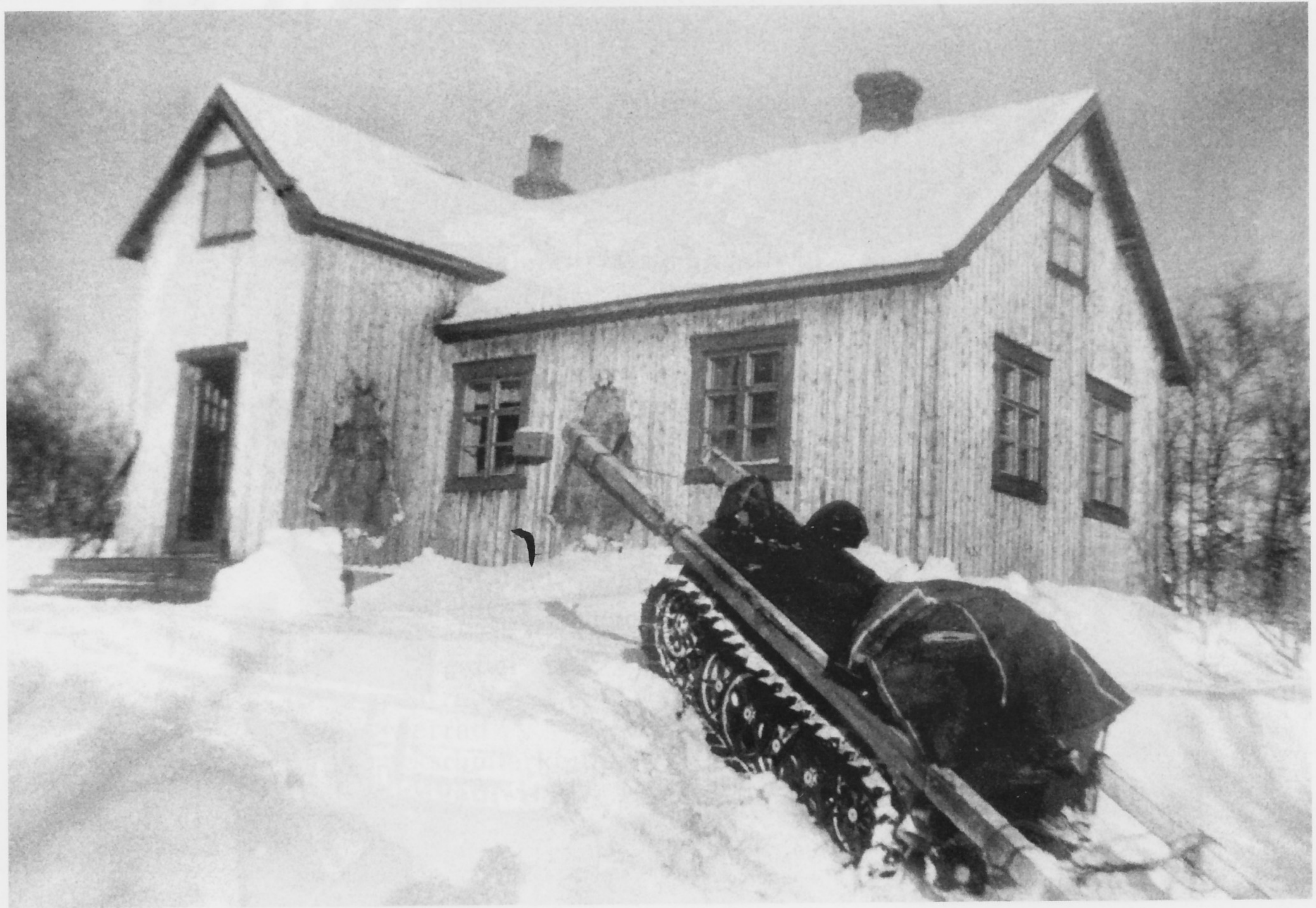
Das Kleine Kettenkrafttrad HK-101 (Sd.Kfz. 2) bewältigte Steigungen bis 24° mühelos. Hier ist der hintere Teil des Fahrzeugs mit einer Plane abgedeckt.
