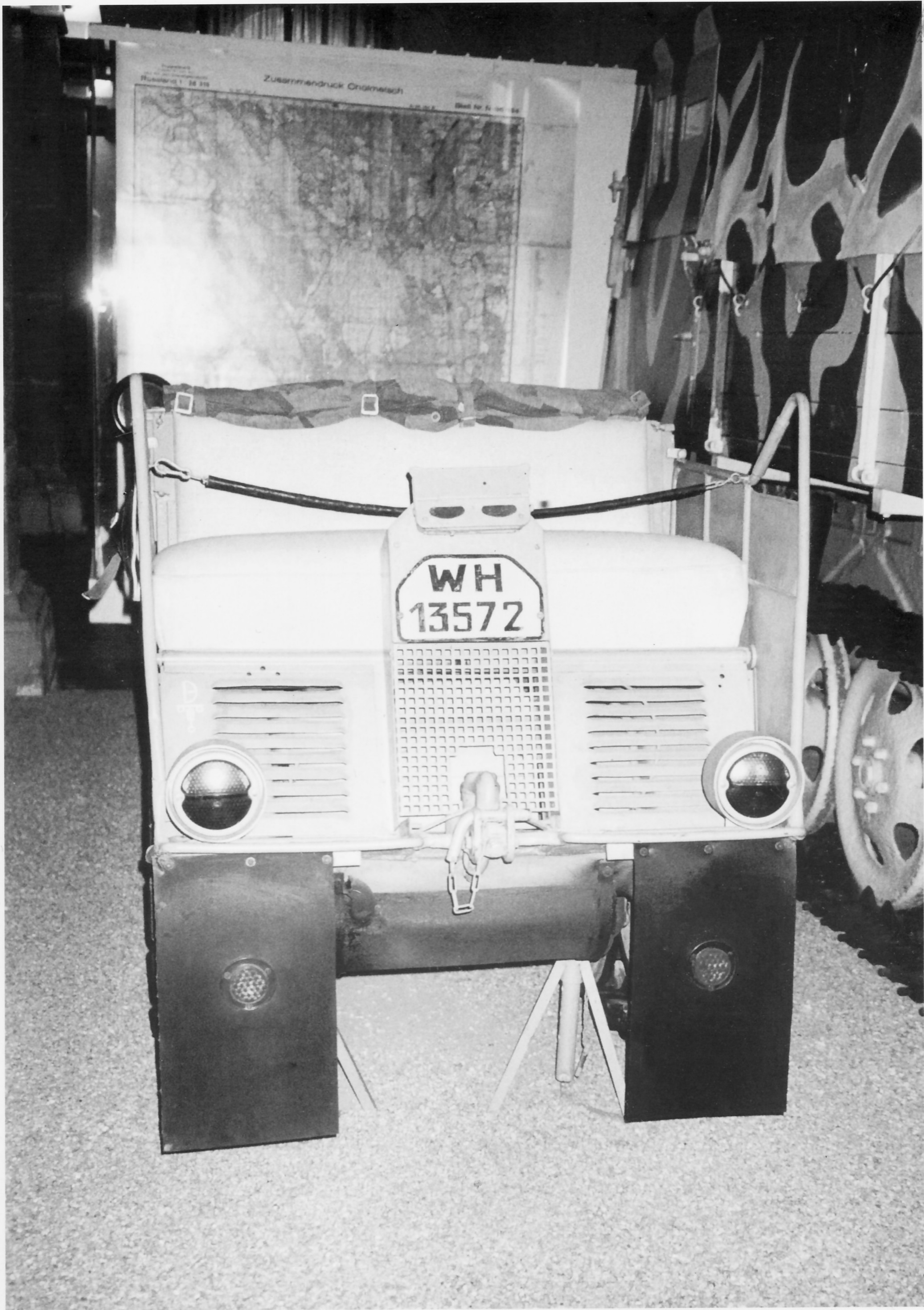
Rückansicht des Kleinen Kettenkrafttrades HK-101 (Sd.Kfz.2). Gut zu erkennen die Anhängerkupplung für den Sd.Ah. 1 und die Schutzbleche, die serienmäßig angebracht waren.
