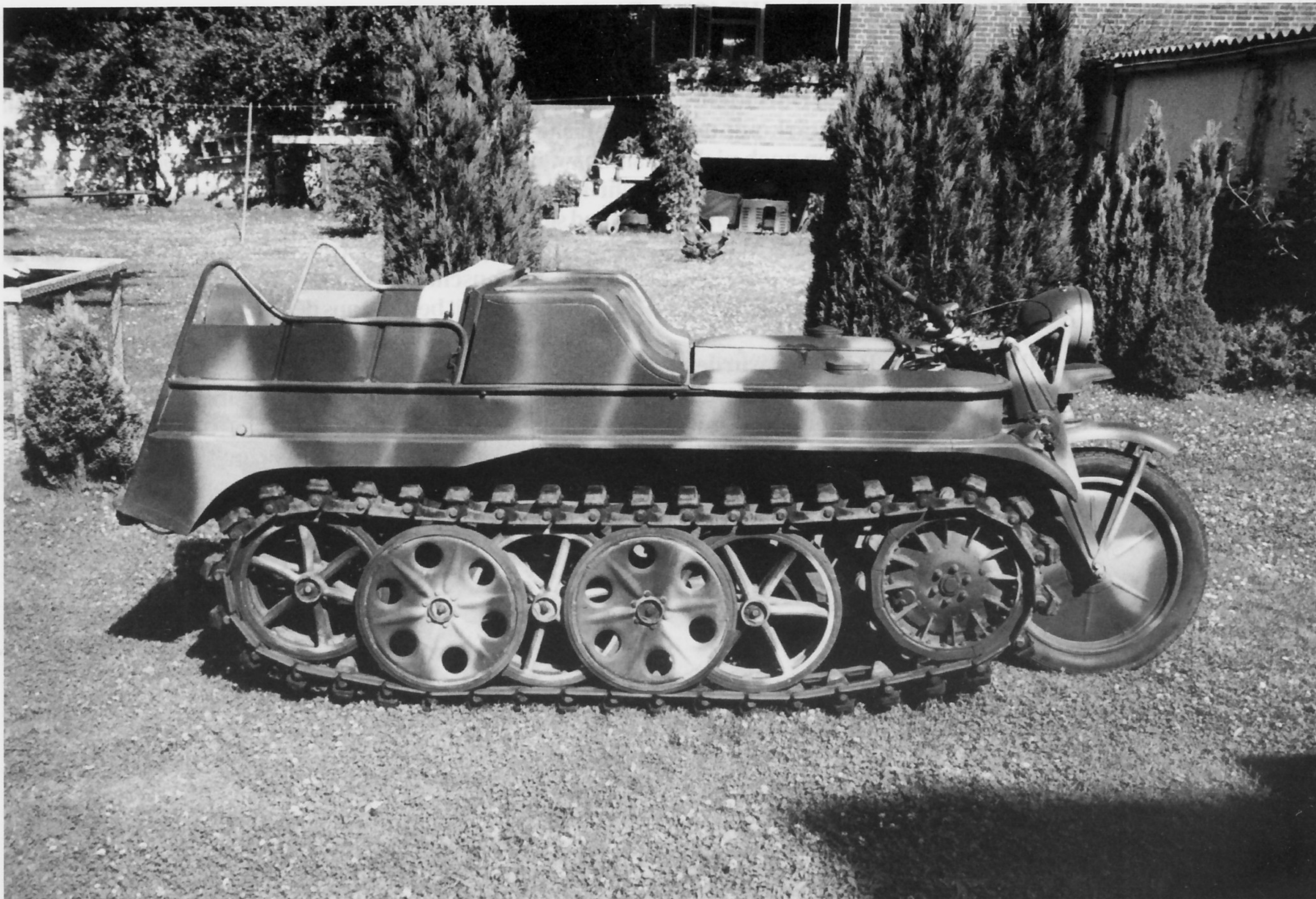
Seitliche Ansicht des Kettenlaufwerkes. Gut zu erkennen ist die versetzte Anordnung der inneren (Speichen-) und äußeren (gelochten) Laufräder und ihre Gummibandagen.
