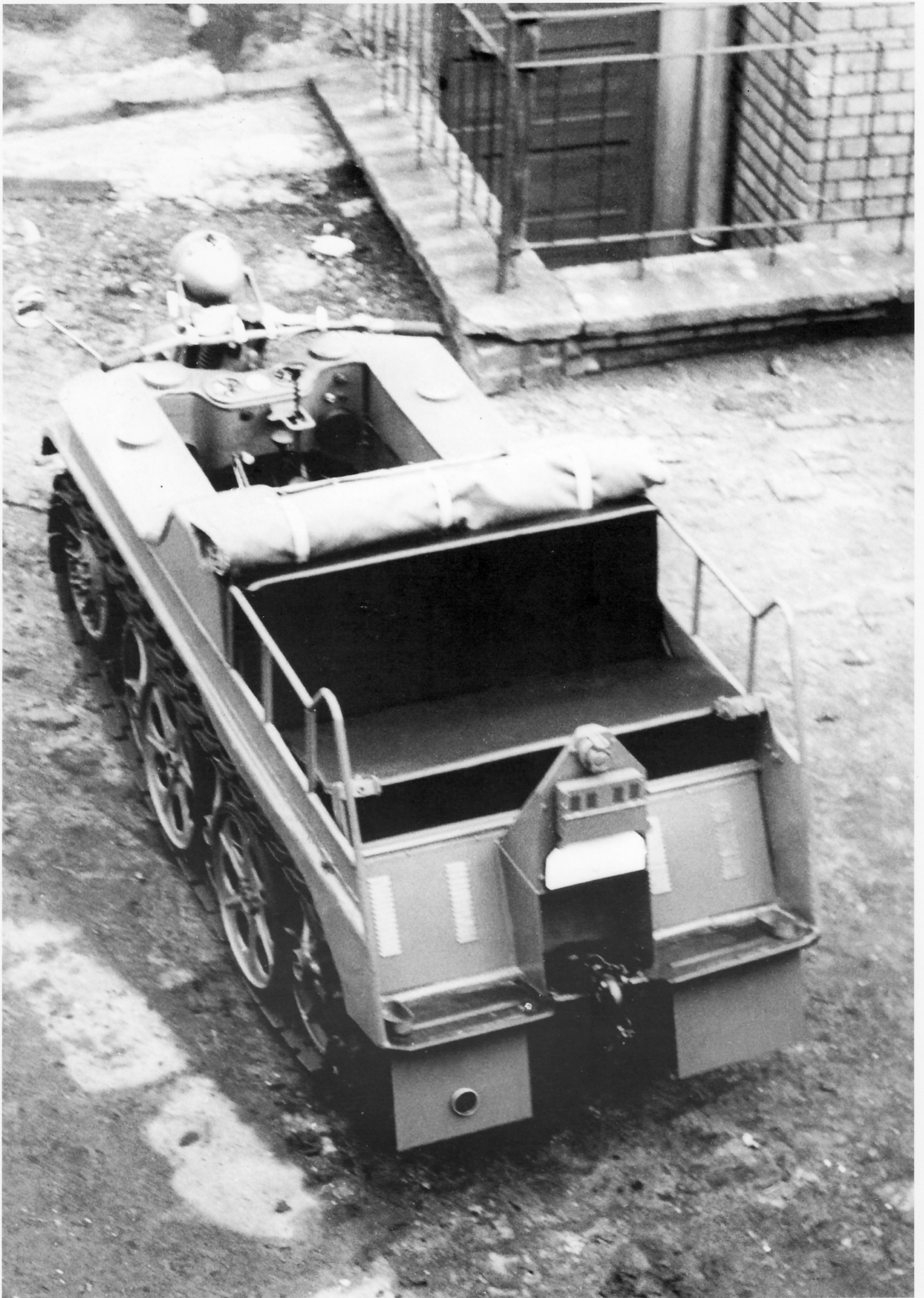
Das Kettenkraftrad in der Draufsicht. Gut erkennbar ist die Raumaufteilung mit dem Platz für den Fahrer, dahinter der Motorraum, die Abdeckplane (aufgerollt) und der Platz für die zwei Mitfahrer einschließlich den Halterungen für zwei Karabiner 98K.
