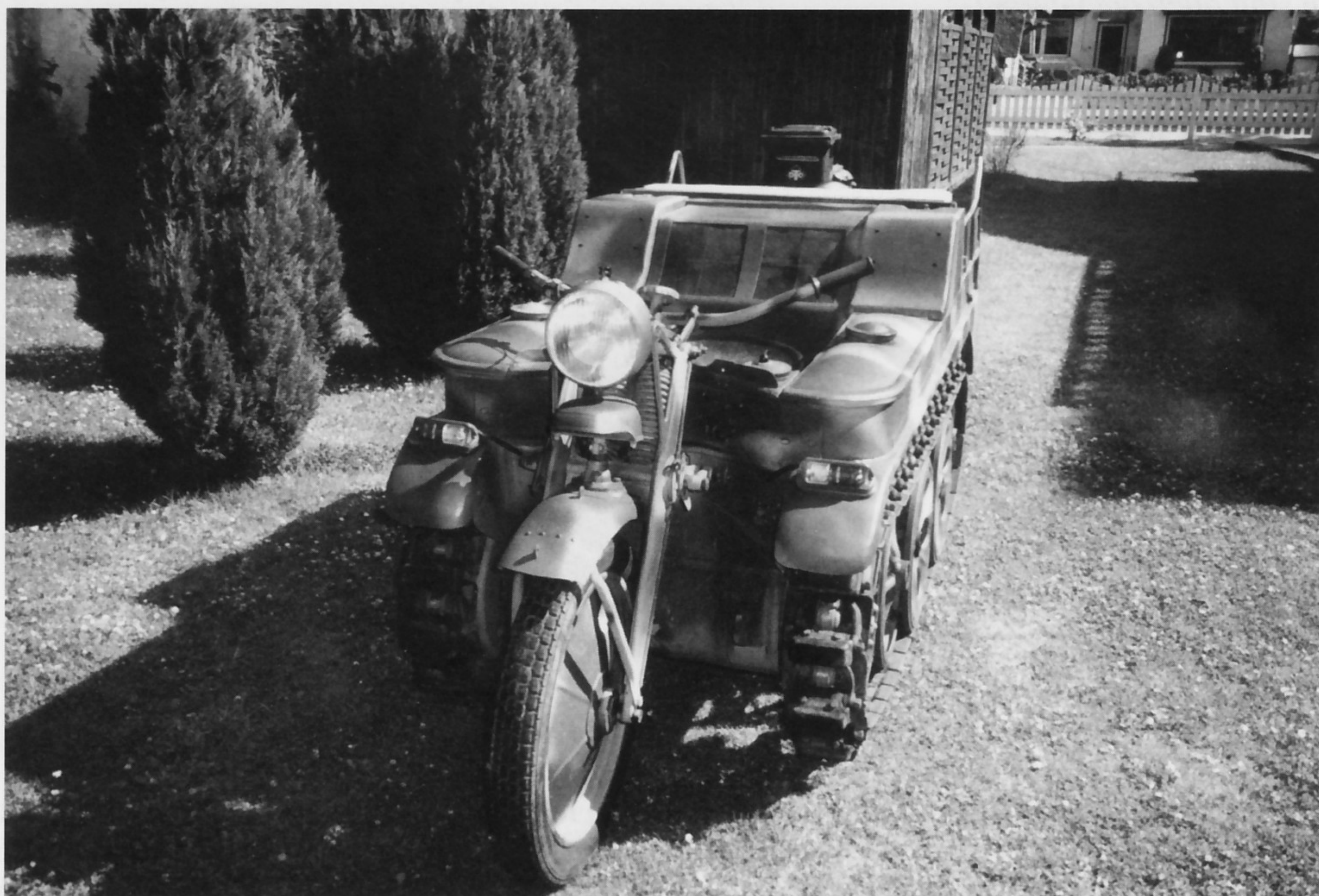
Die elektrische Anlage wurde von einer Batterie mit 6 V 75 Ah versorgt. Der Scheinwerfer war, wie viele andere Teile, dem NSU Motorrad entlehnt.
