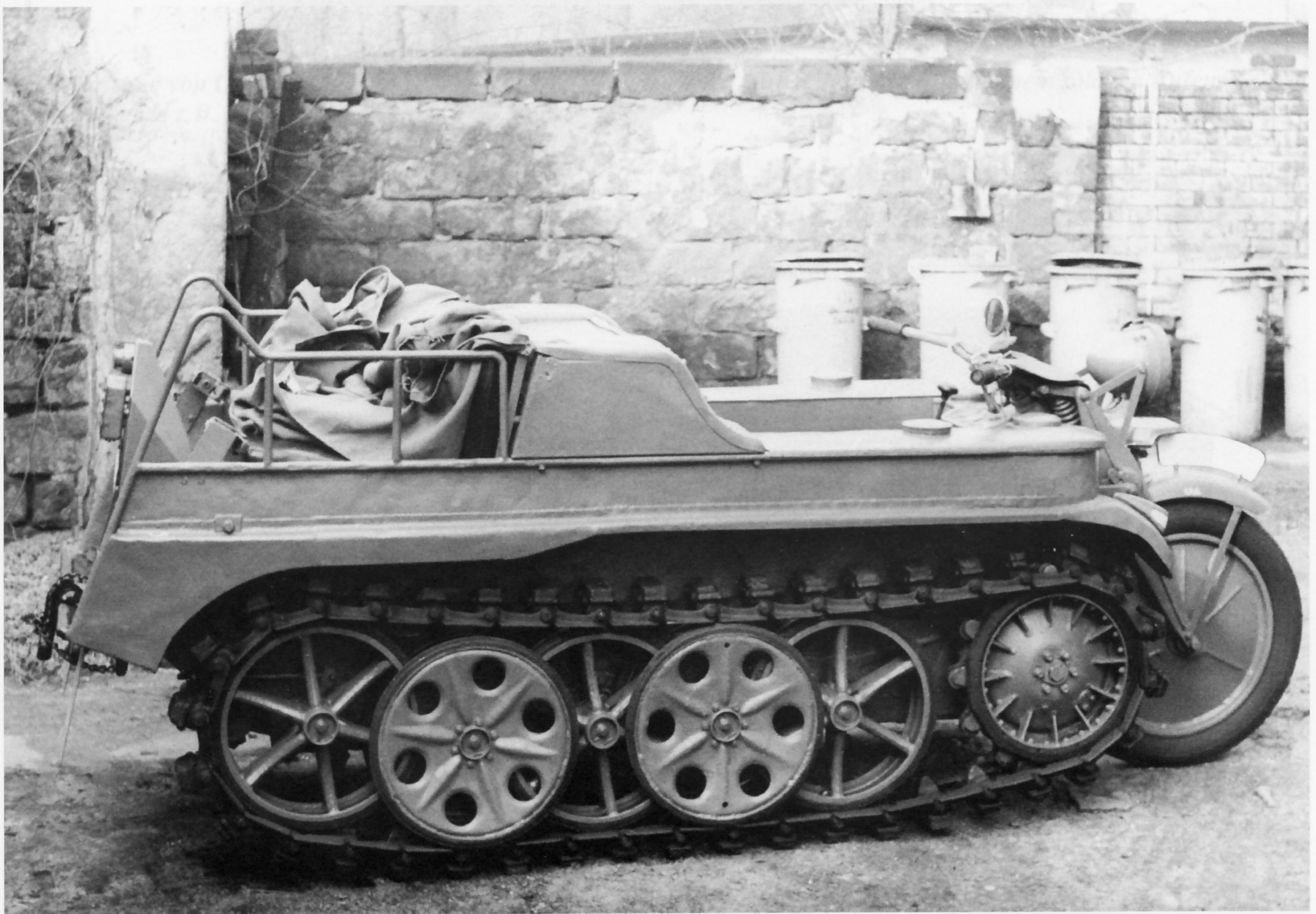
Gegen Witterungseinflüsse war das Kleine Kettenkrafttrad HK-101 (Sd.Kfz.2) mit einer Wetterschutzplane versehen. Sie wurde aufgerollt hinter den beiden Beifahrersitzen transportiert. Bei Bedarf konnte sie ausgerollt und über das gesamte Fahrzeug gerollt werden.
