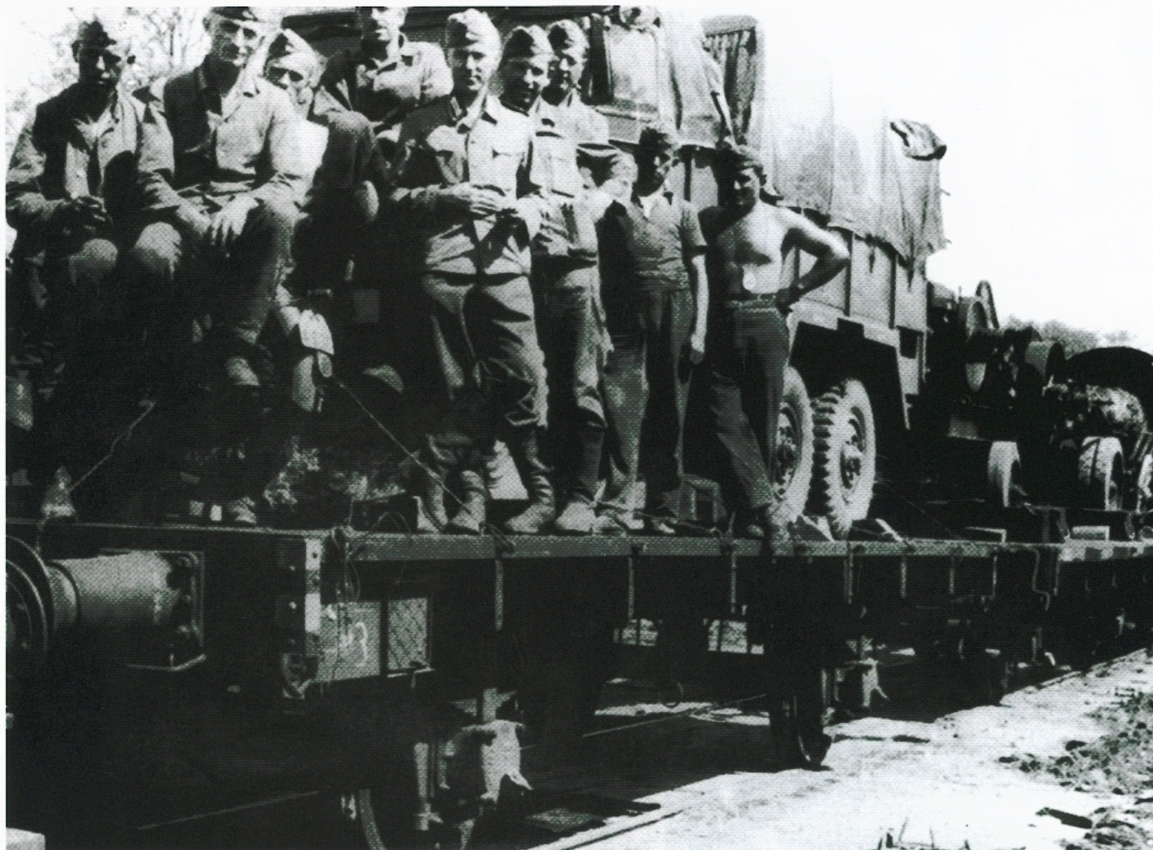
Auf langen Strecken wurden Fahrzeuge zum Transport auf Eisenbahnwagen verladen. Der leichte geländegängige Einheits-LKW 2,5 t (6x6) wurde in die Verladeklasse I b eingestuft (das galt für alle Varianten des Fahrzeuges). Mit Holzkeilen und Spanndrähten wurden die Fahrzeuge festgestellt. Auf diesem Zug wurden auch ein landwirtschaftliches Gerät und ein bespanntes Fahrzeug (landesüblich) verladen.
