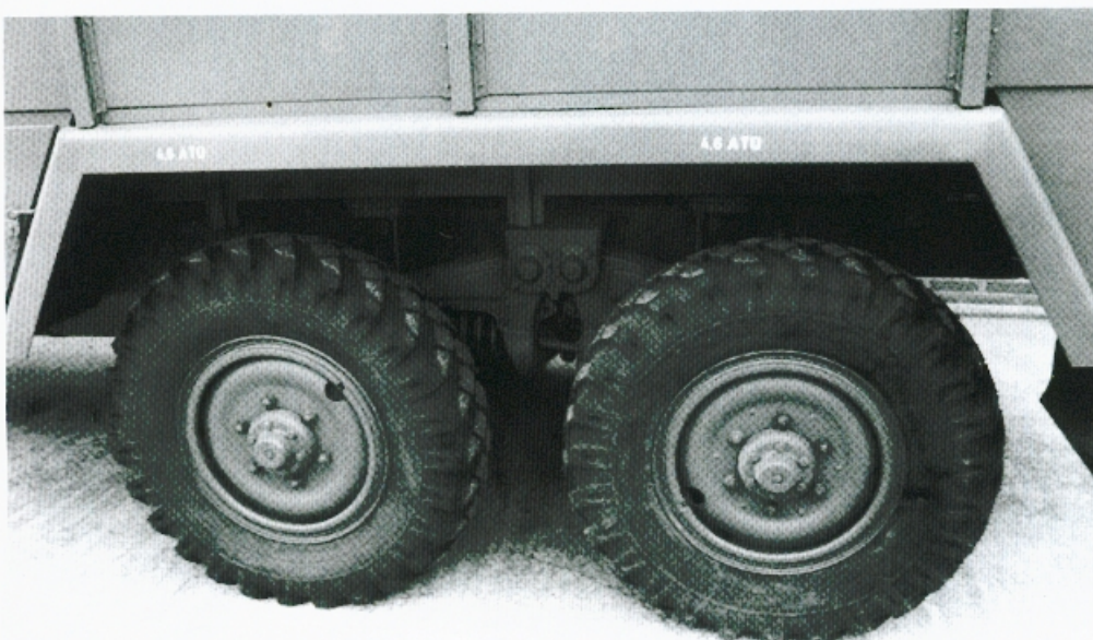
Blick auf die beiden Hinterräder. Die Radaufhängung ist auch auf dieser Aufnahme gut zu erkennen. Es wurden Geländereifen aufgezogen (210-18 Gelände). Beachte das kräftige Profil.
