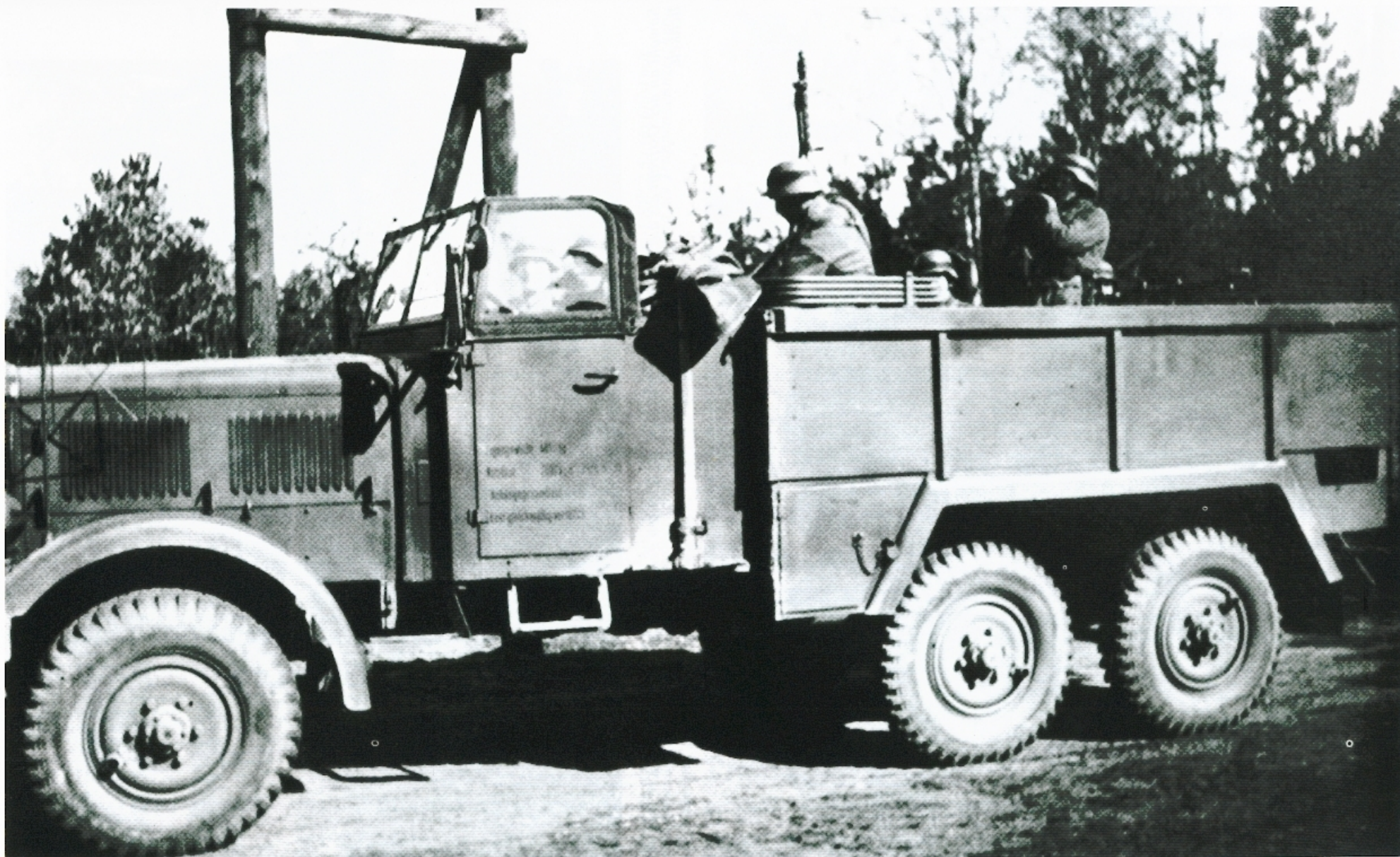
Dieser leichte geländegängige Einheits-LKW 2,5 t (6x6) wurde als Mannschaftskraftwagen genutzt. Die Besatzung führt ein Fla-MG mit. Beachte bei dieser Aufnahme die auf der Fahrertür aufschablonierten Angaben zu Eigengewicht, Nutzlast und Anhängelast. Es fehlt auch nicht der Hinweis „Last gleichmäßig verteilen“. Diese Angaben waren u.a. für die Eisenbahnverladung wichtig.
