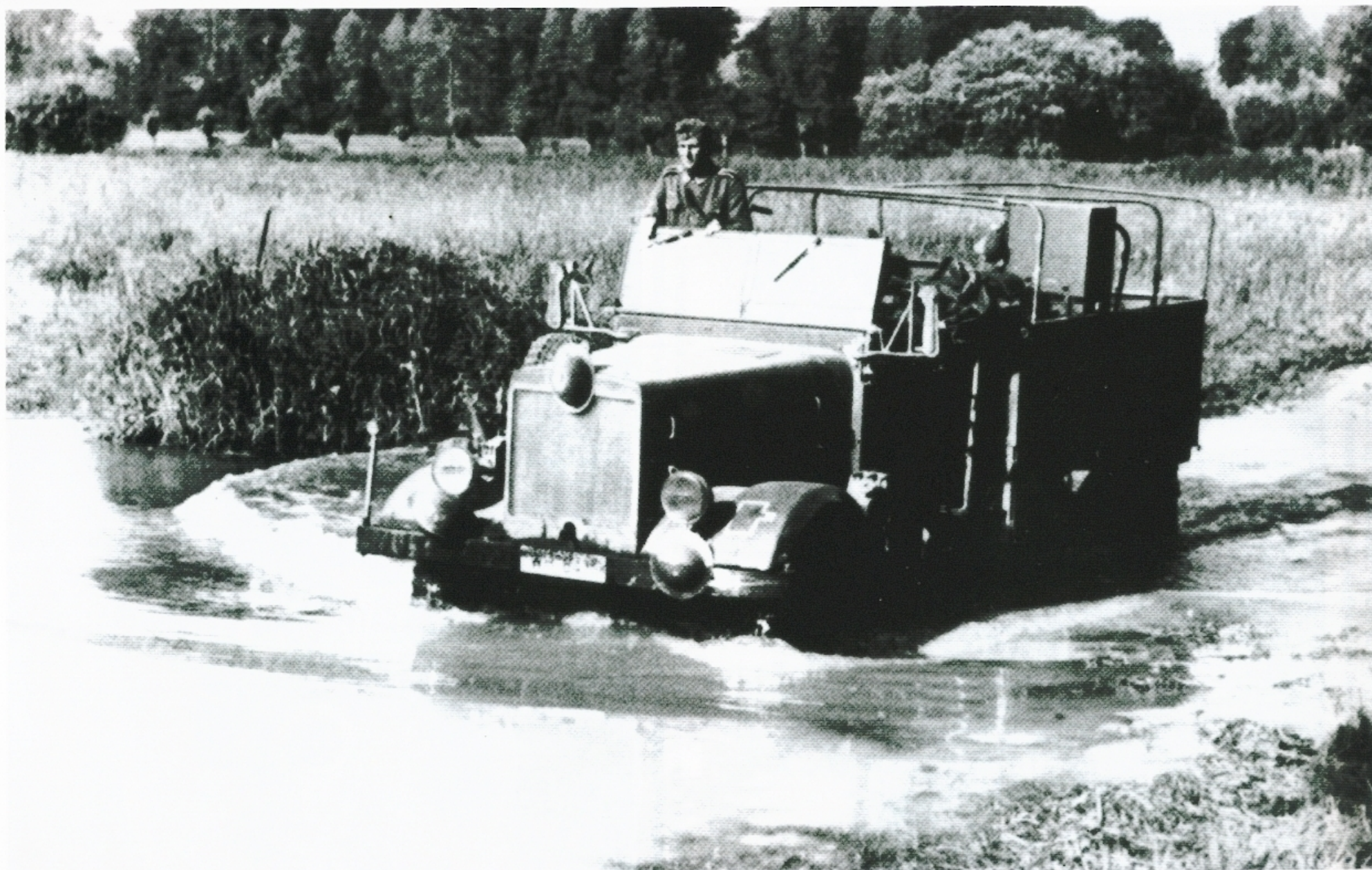
Die Wadfähigkeit des leichten geländegängigen Einheits-LKW 2,5 t (6x6) ist mit 800 mm angegeben. Bei dieser Wasserfahrt hat der Feldfernkelwagen eines Nachrichtenzuges die maximale Tiefe noch nicht erreicht. Die Aufnahme entstand an der Ostfront.
