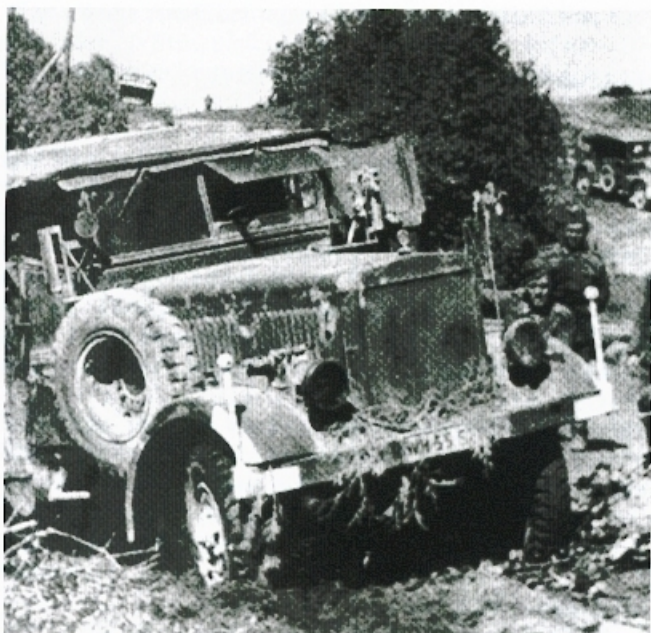
Ein leichter geländegängiger Lastkraftwagen 2,5 t (6x6) Einheitsdiesel G 3 A hat Mühe, sich durch den lockeren Boden zu kämpfen. Das Foto entstand bei Einsatz an der Ostfront.
