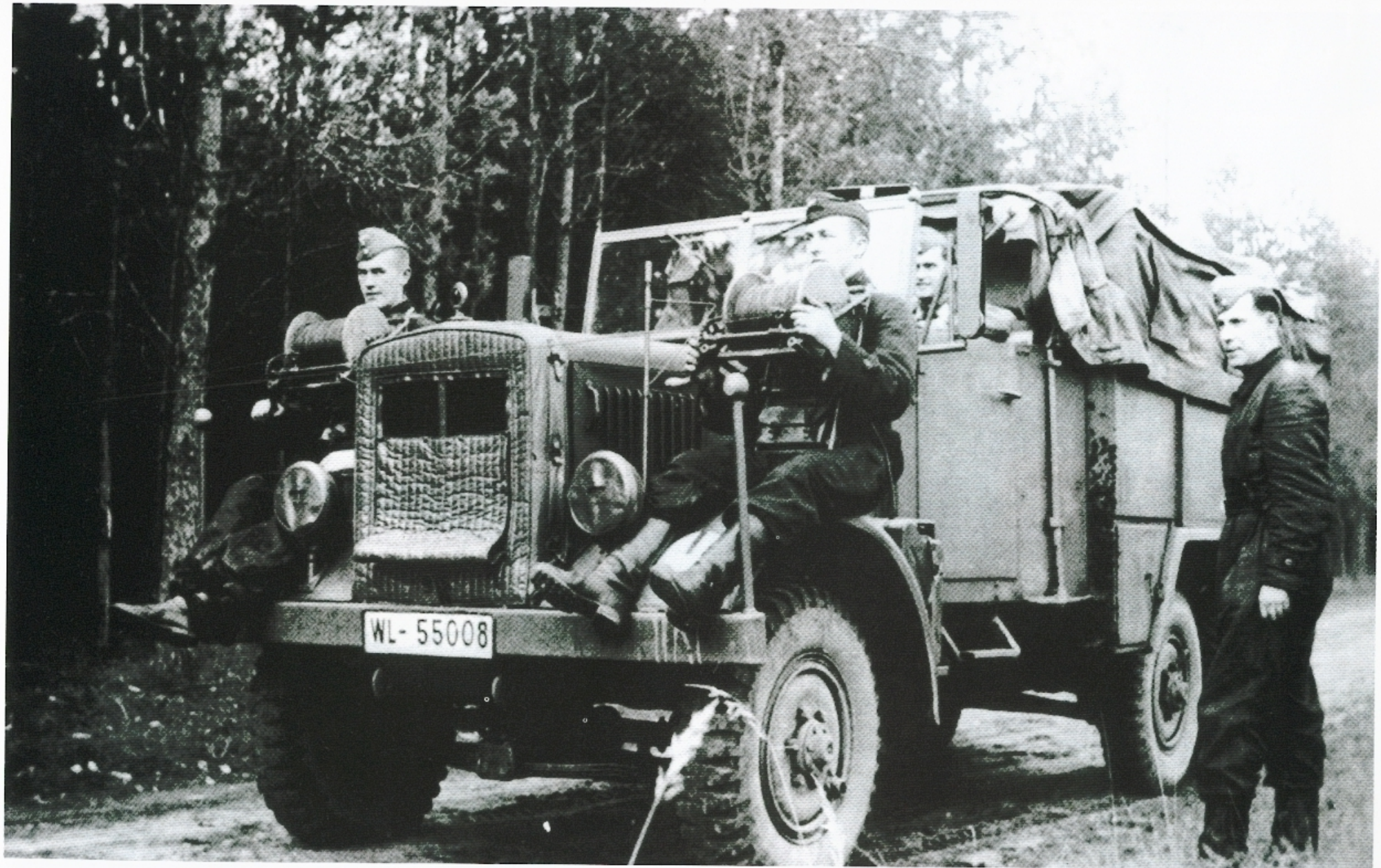
Der leichte geländegängige Einheits-LKW 2,5 t (6x6) wurde auch bei der Luftwaffe eingesetzt, hier als Fernsprechkraftwagen (Kfz. 77). Die Kabeltrommeln wurden zum Transport auf der Ladefläche befestigt (siehe Typenblatt 80a, Seite 18). Beachte auch die Abdeckung des Kühlergrills zum Schutz vor Kälte.
