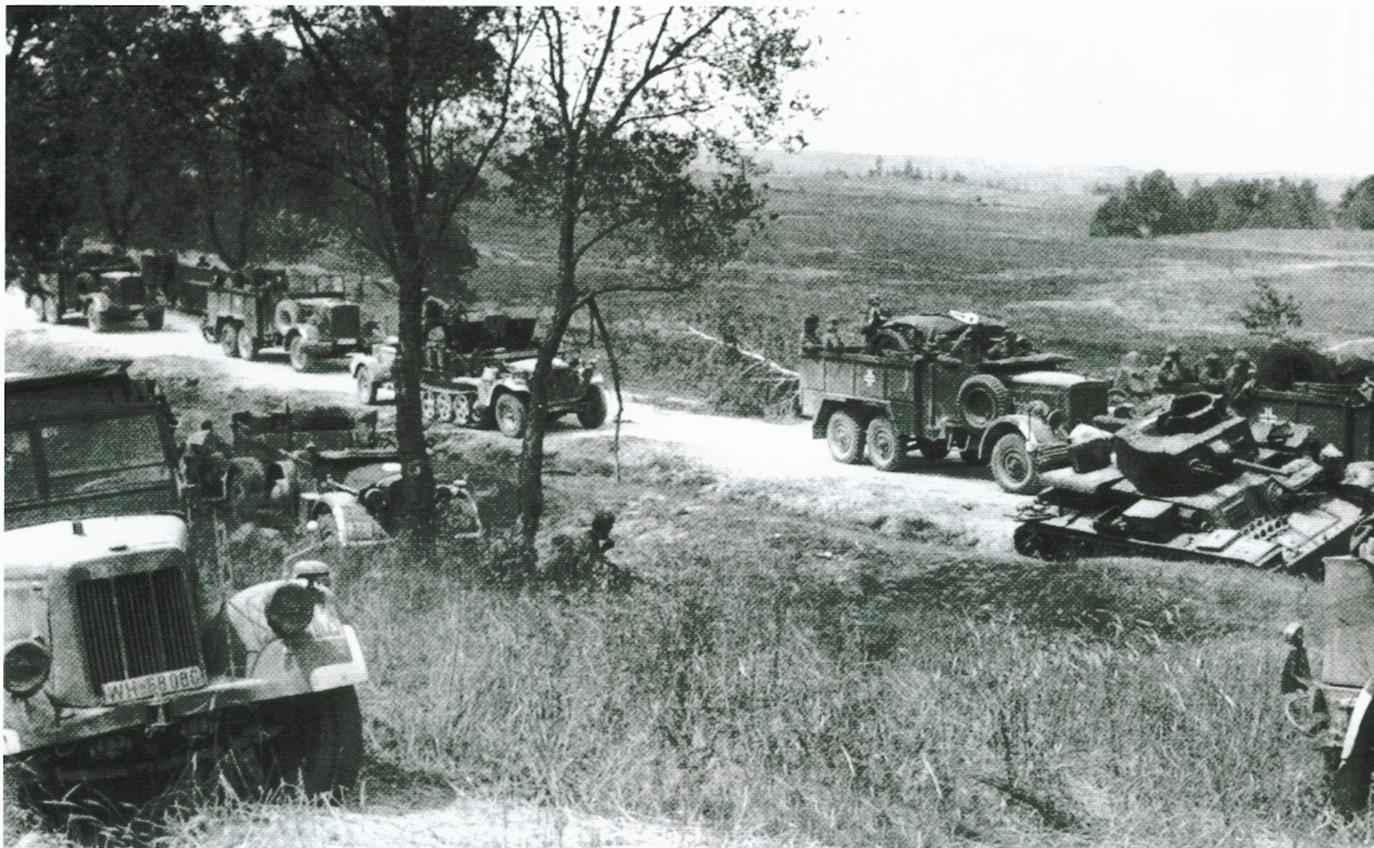
Auf dem Vormarsch an der Ostfront. In der Kolonne fahren mehrere leichte geländegängige Einheits-LKW 2,5 t (6x6). Links vorn zu sehen ein leichter Zugkraftwagen 3 t (Sd.Kfz. 11). In der Senke hinter dem Baum steht eine mittlerer geländegängiger PKW (Kfz. 15). Das Halbkettenfahrzeug in der Kolonne ist ein leichter Zugkraftwagen 1 t (Sd.Kfz 10/4). Bei dem Panzerkampfwagen am rechten Bildrand handelt es sich um den PzKw 38 t, ein tschechisches Modell.
