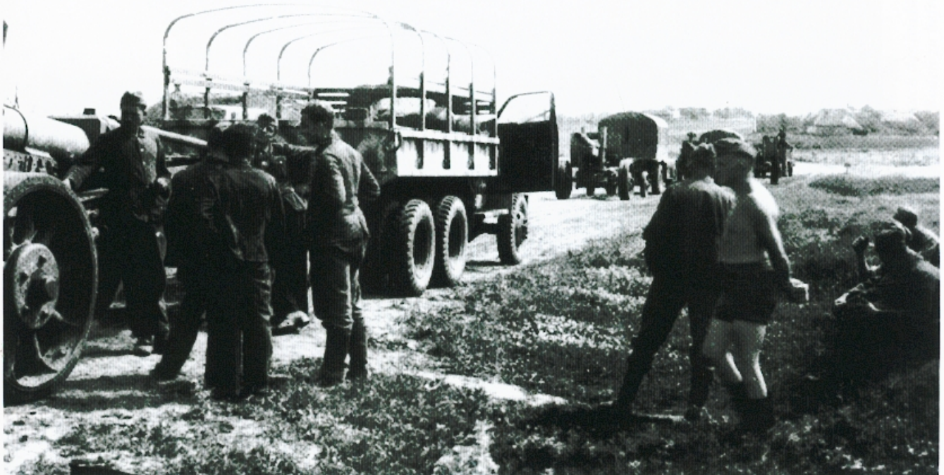
Im deutschen Heer wurden auch erbeutete Fahrzeuge genutzt. Als Ersatz für den leichten geländegängigen Einheits-LKW 2,5 t (6x6) kamen auch 2-t-LKW (6x6) Studebaker US 6 - U2 zur Verwendung, hier zu sehen mit angehängter 15,2-cm-Kanone K 433/1 (r)-russ. 37. Diese Fahrzeuge, die von der Roten Armee in den USA geleast wurden, hatten einen hohen Benzinverbrauch.
