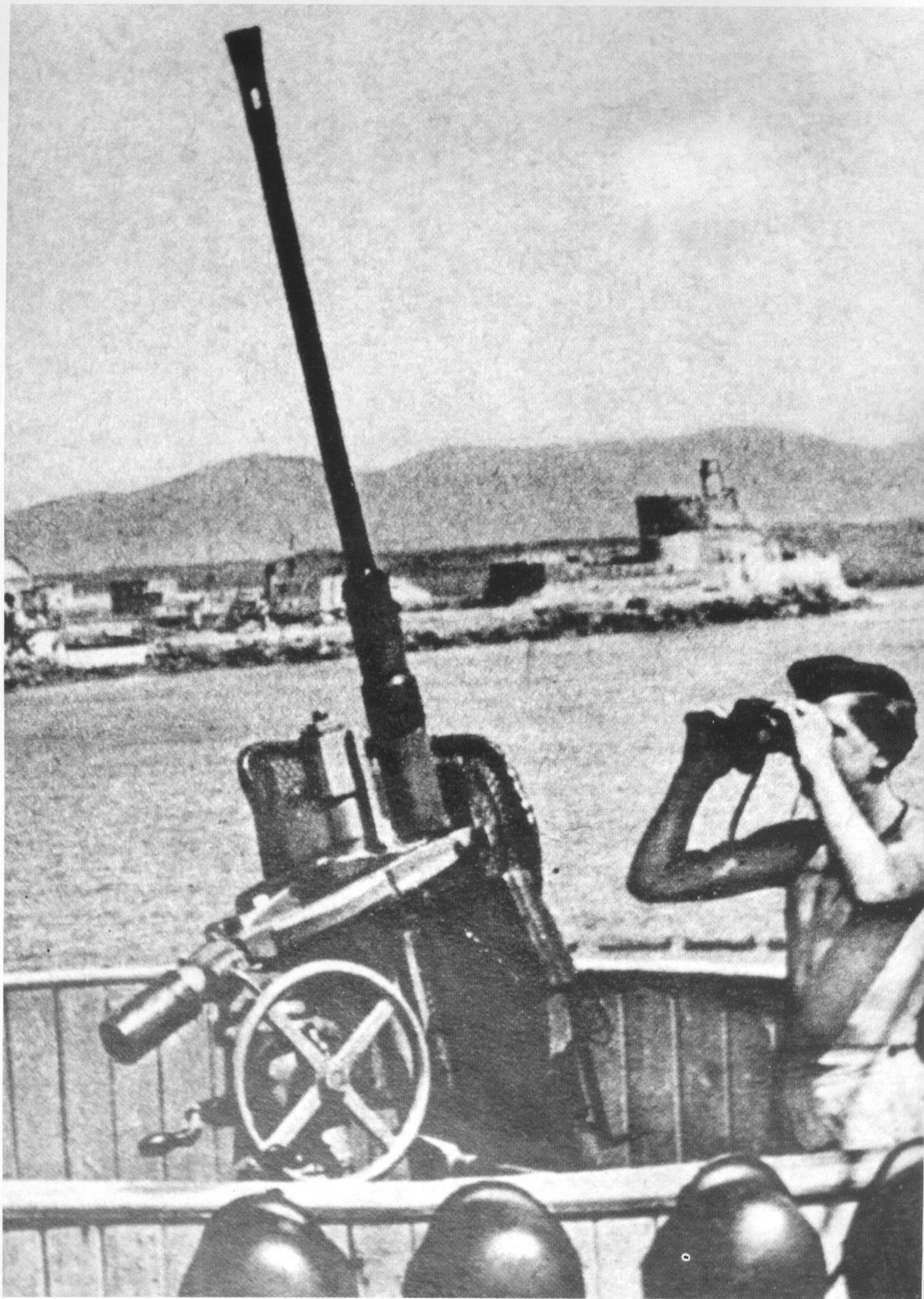
Die 2-cm-Fliegerabwehrkanone 30 in 2-cm-Sockellafette 30 oder 37 kam während des Krieges nicht nur auf schwimmenden Einheiten der Kriegsmarine zum Einsatz. Diese Aufnahme zeigt diesen Geschütztyp in ortsfester Aufstellung, im Rahmen einer Küstenbefestigung.
