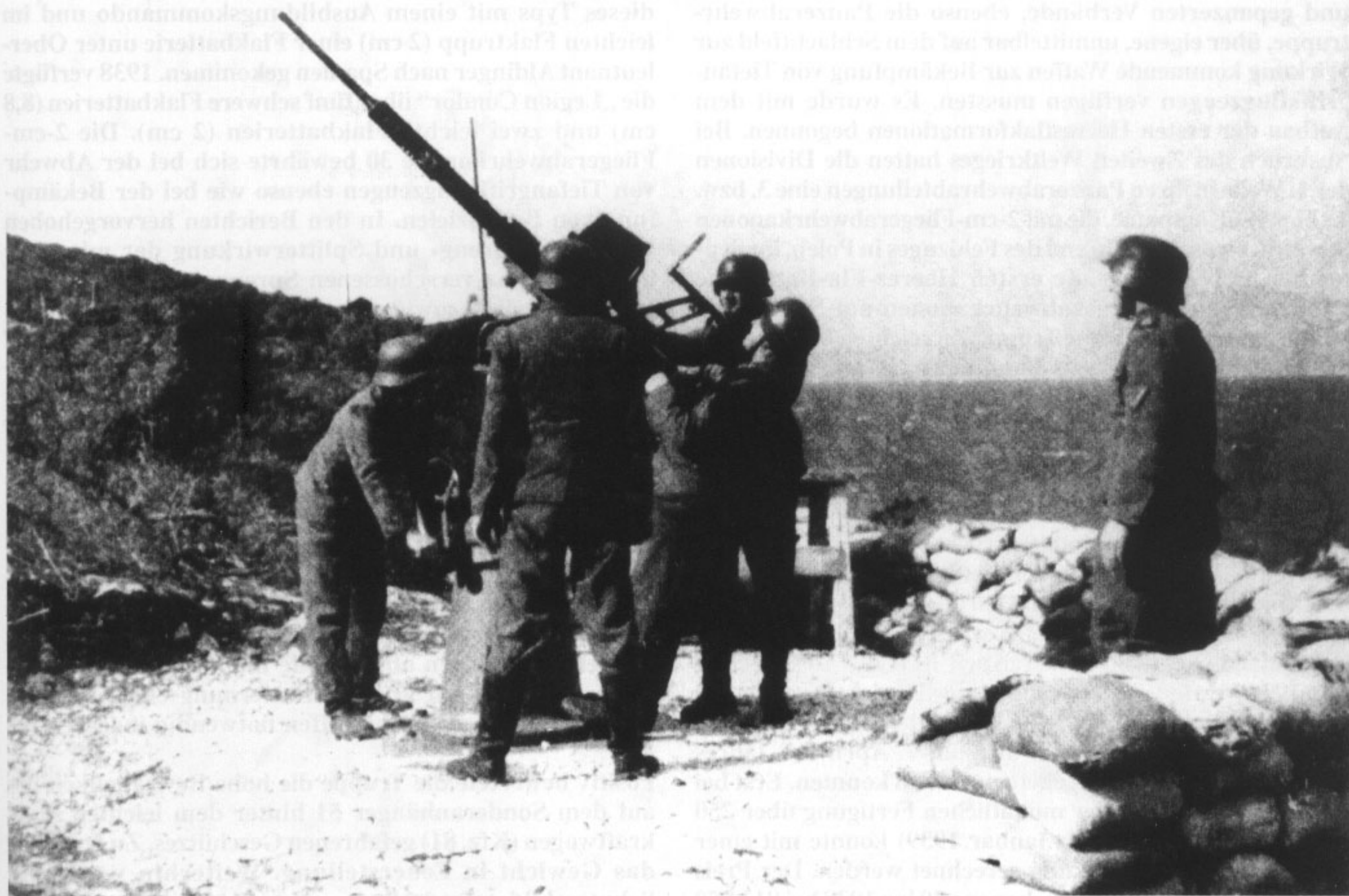
Die 2-cm-Fliegerabwehrkanone 28 (Oerlikon) auf Sockellafette in Feuerstellung am Atlantikwall. Das Trommelmagazin nahm 60 Granatpatronen auf und ermöglichte eine praktische Feuergeschwindigkeit von 120 Schuß in der Minute. Die größtmögliche Schußhöhe lag bei 3700 m.
