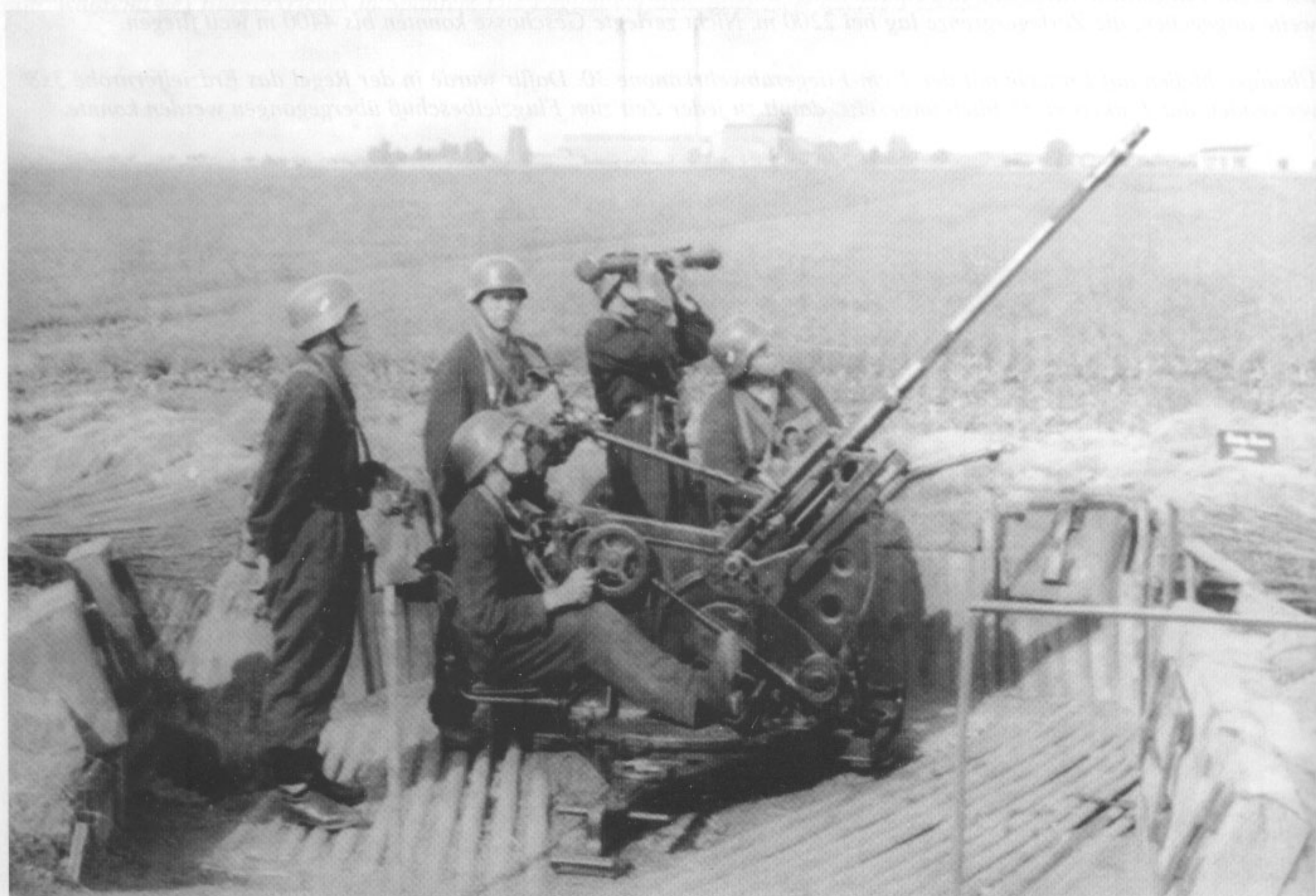
Vorbereitungen zum Schießen gegen Luftziele mit dem Flakvisier 35 und dem Entfernungsmeßgerät Em 1 mR. In der Regel wurde ohne den Entfernungsmesser geschossen, allerdings im Vernichtungsbereich unterhalb von 1200 m. Oberhalb dieser Entfernung blieben die Erfolgsaussichten beim Schießen mit der 2-cm-Fliegerabwehrkanone 30 gering.
