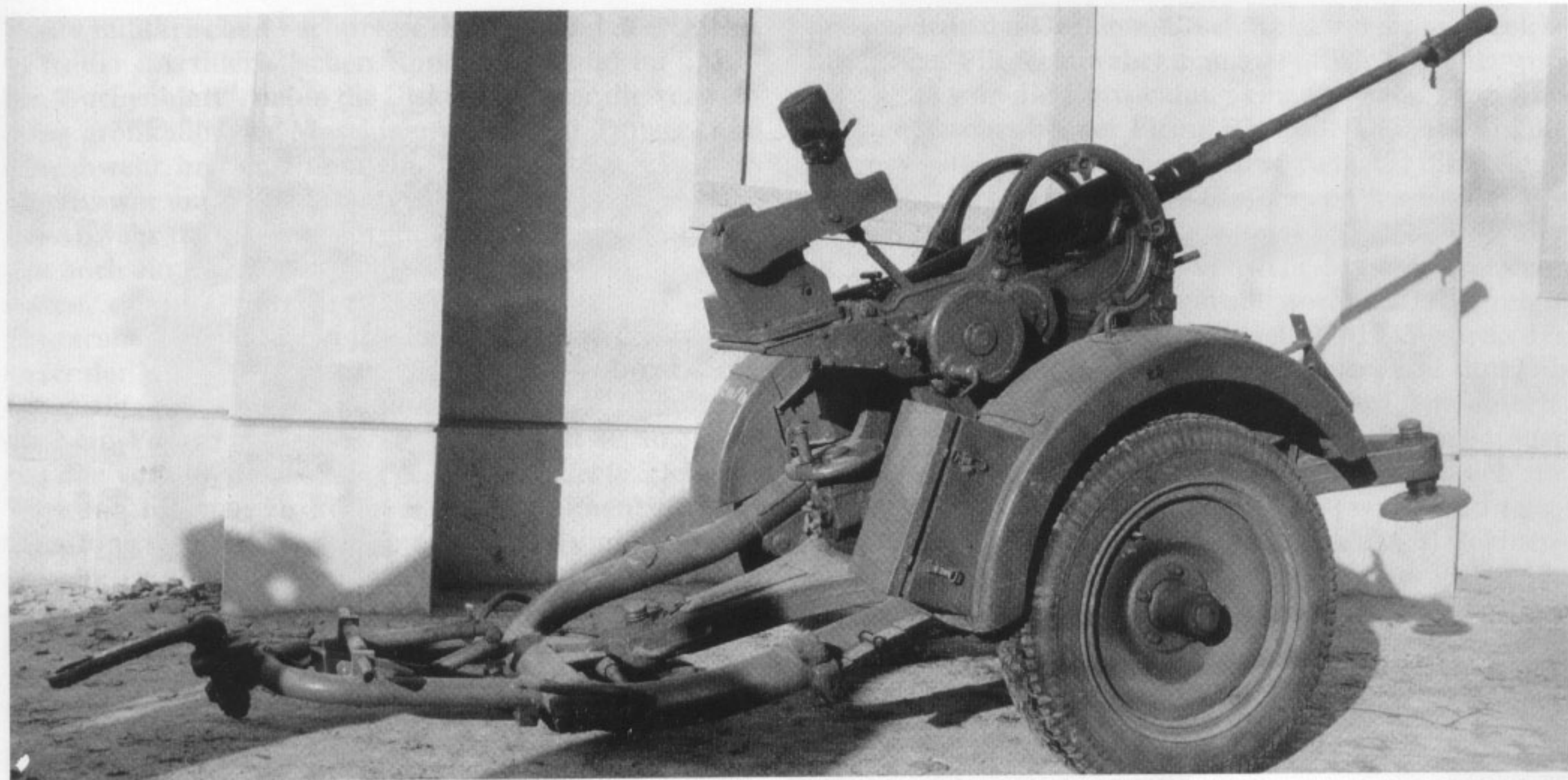
Die 2-cm-Fliegerabwehrkanone 38 auf dem Sonderanhänger 51. In Fahrstellung ergab sich ein Gewicht von 770 Kg (ohne Schutzschild).
