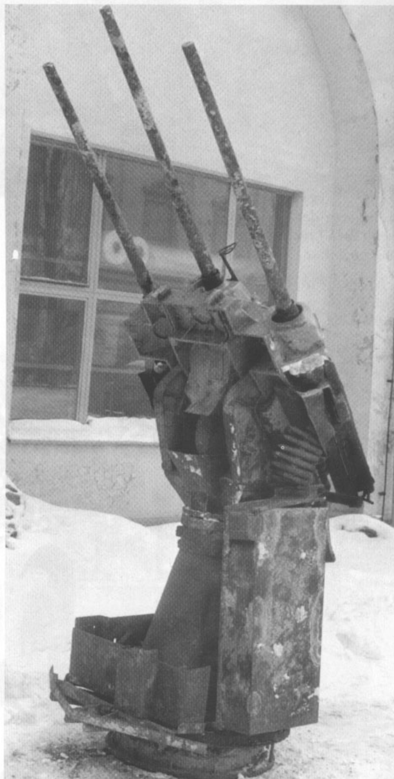
Die Fliegerabwehr-Sockellafette mit drei 2-cm-Maschinengewehren 151/20 sollte ab 1944 die Fliegerabwehr des Heeres verstärken. Theoretisch konnten 700 Schuß in der Minute abgegeben werden.
