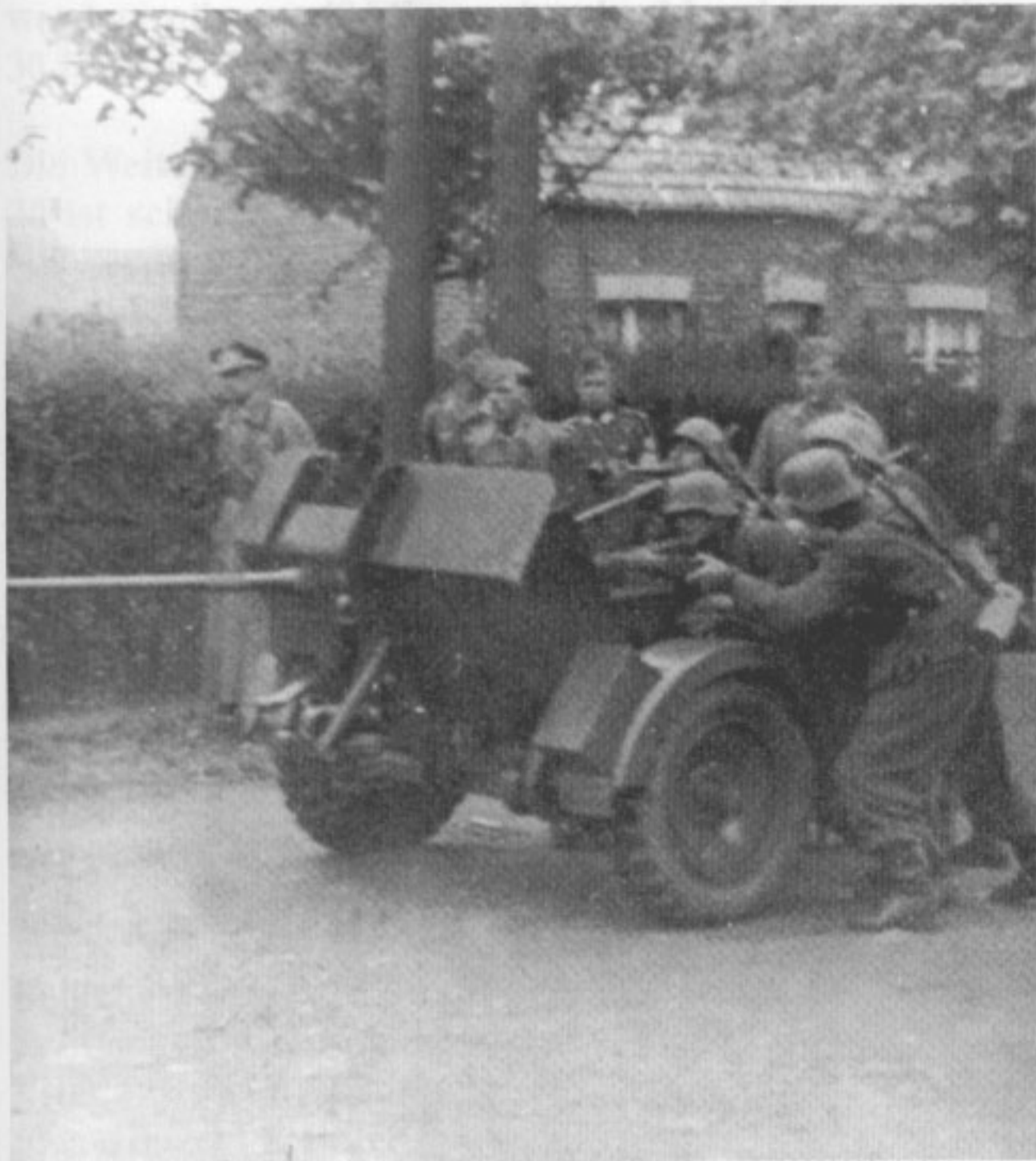
1940 ist für die 2-cm-Fliegerabwehrkanone ein 6 mm starkes und 112 Kg schweres Schutzschild zur Einführung gekommen. Es wurde auf Anweisung des Zugführers je nach Gefechtslage angebaut bzw. abgebaut.
