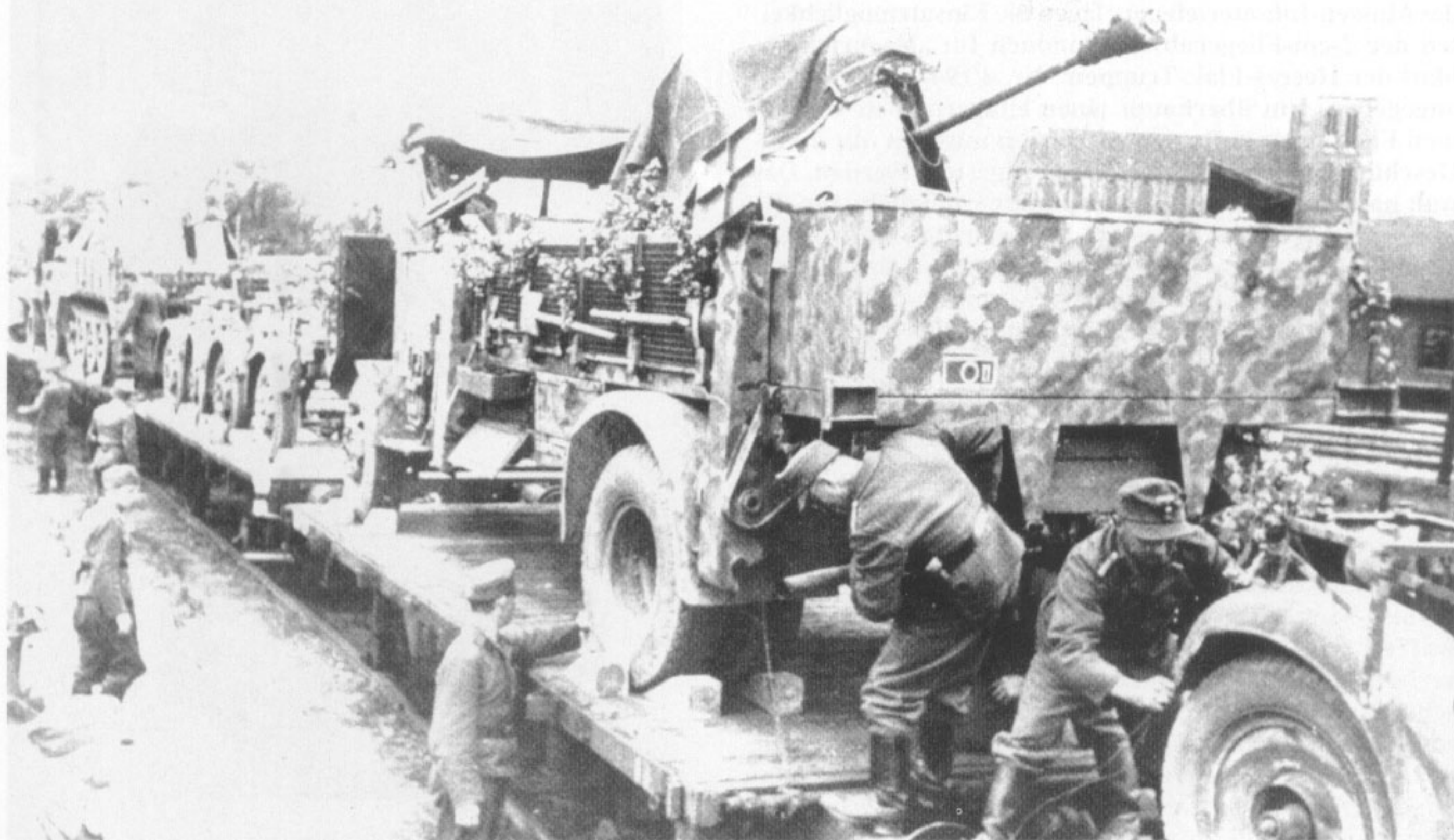
Als wirkungsvolle Alternative für die leichten Fliegerabwehrgeschütze im Kaliber 2 cm trat 1943/44 die 3,7-cm-Fliegerabwehrkanone 43 in Erscheinung. Im Bild eine 3,7-cm-Fliegerabwehrkanone 43 auf schweren geländegängigen LKW (4x4) Büssing-NAG 4500 A bei einer NSKK-Einheit an der Westfront.
