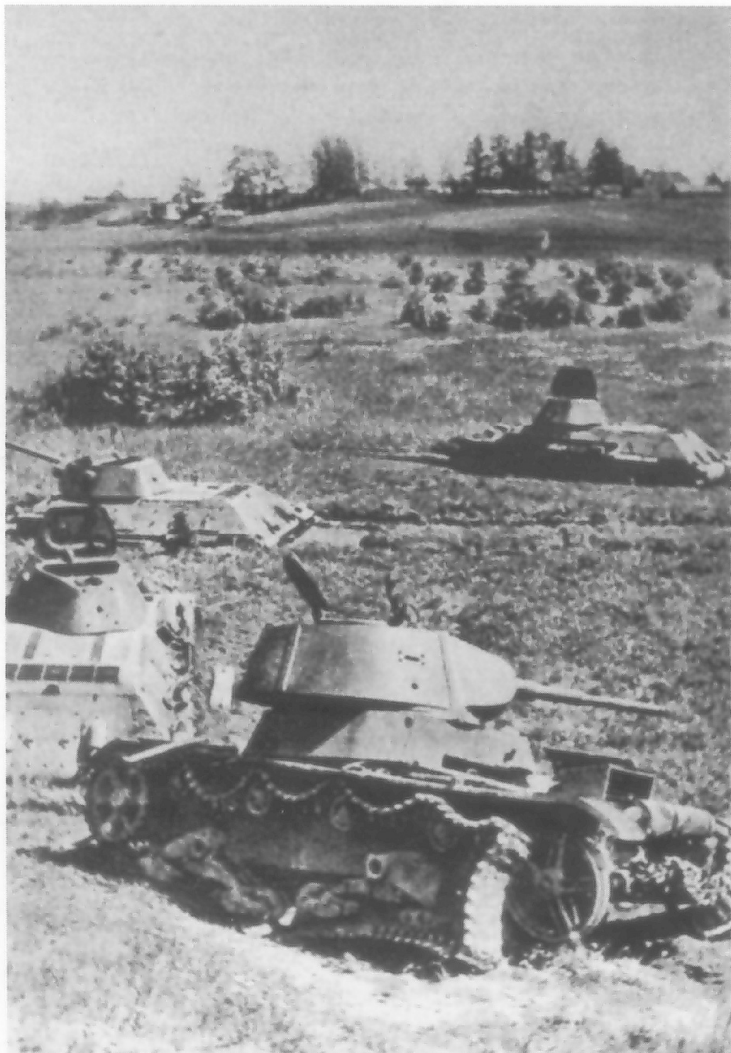
Liegengebliebener russischer leichter Panzer T-26, Modell 1937. Dahinter wesentlich modernere und leistungsfähigere Kampfwagen vom Typ T-34, Modell 1941. Die Aufnahme zeigt anschaulich, wie wirksam natürliche Hindernisse, in diesem Fall eine versumpfte Wiese, den Einsatz gepanzerter Fahrzeuge behindern konnten.
