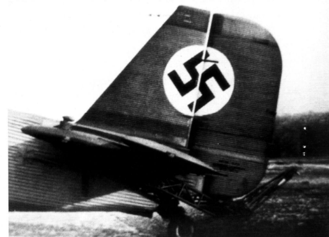
Nahansicht der Starrschleppleinrichtung, die am hinteren Rumpfwerk der Ju 52/3m befestigt war. Im Laufe der Zeit wurden diese Anlagen jedoch gegen die leichter am Spornrad zu befestigenden Seilschlepp-Kupplungen ausgetauscht.
