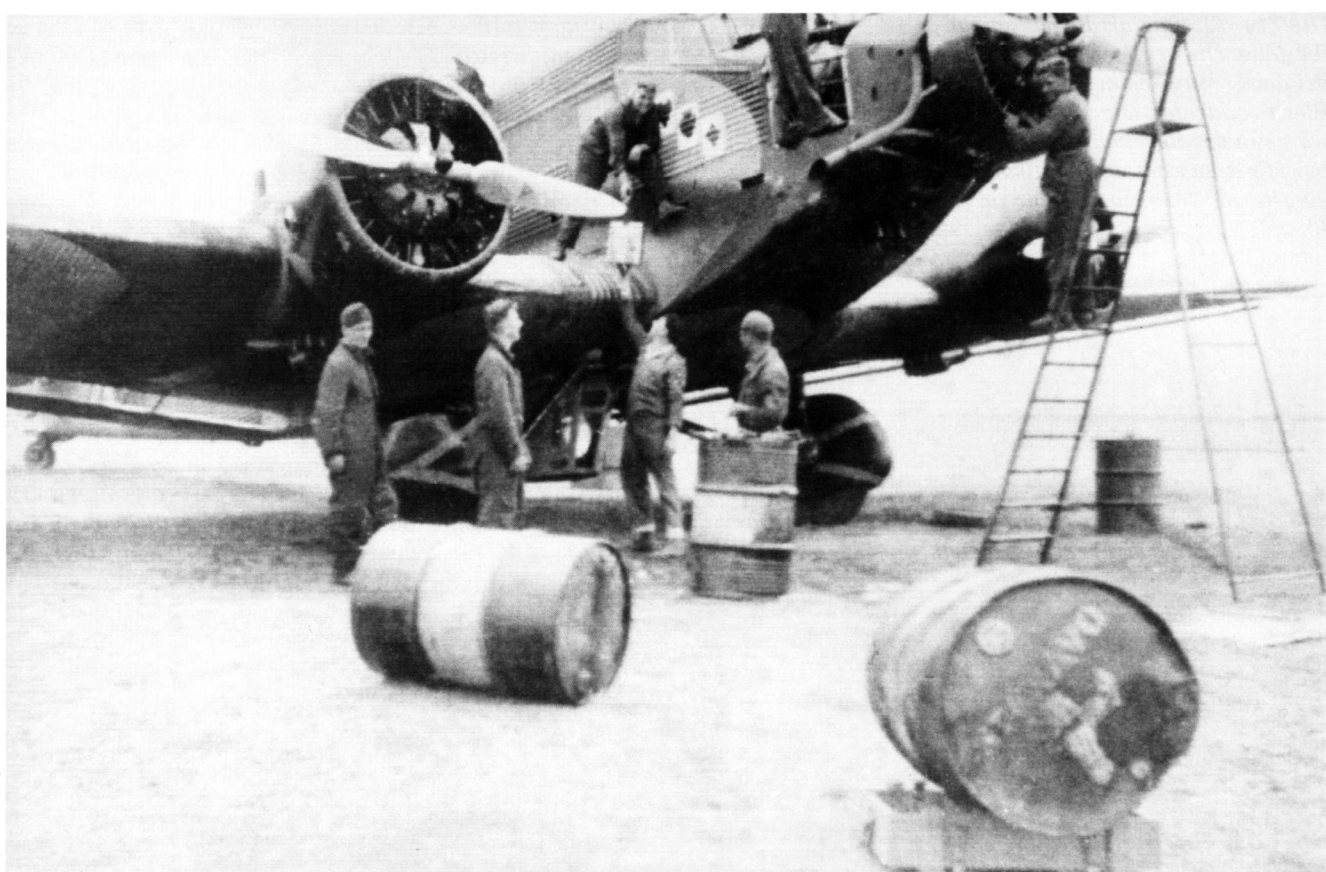
In den Flächen dieses Behelfskampfflugzeugs der Legion Condor war ein starres MG 17 nahe bei der Flächenvorderkante eingebaut. Unter dem Rumpf ist der verglaste Waffenstand zu sehen, in welchem der Bombenschütze seinen Platz fand.
