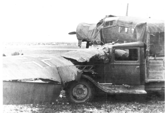
Wegen versagender Bremsen geriet diese Ju 52/3m nach der Landung ins Schleudern und rutschte mit voller Wucht gegen einen abgestellten LKW, der für die Entladung der Maschinen auf dem Flugfeld stand.
