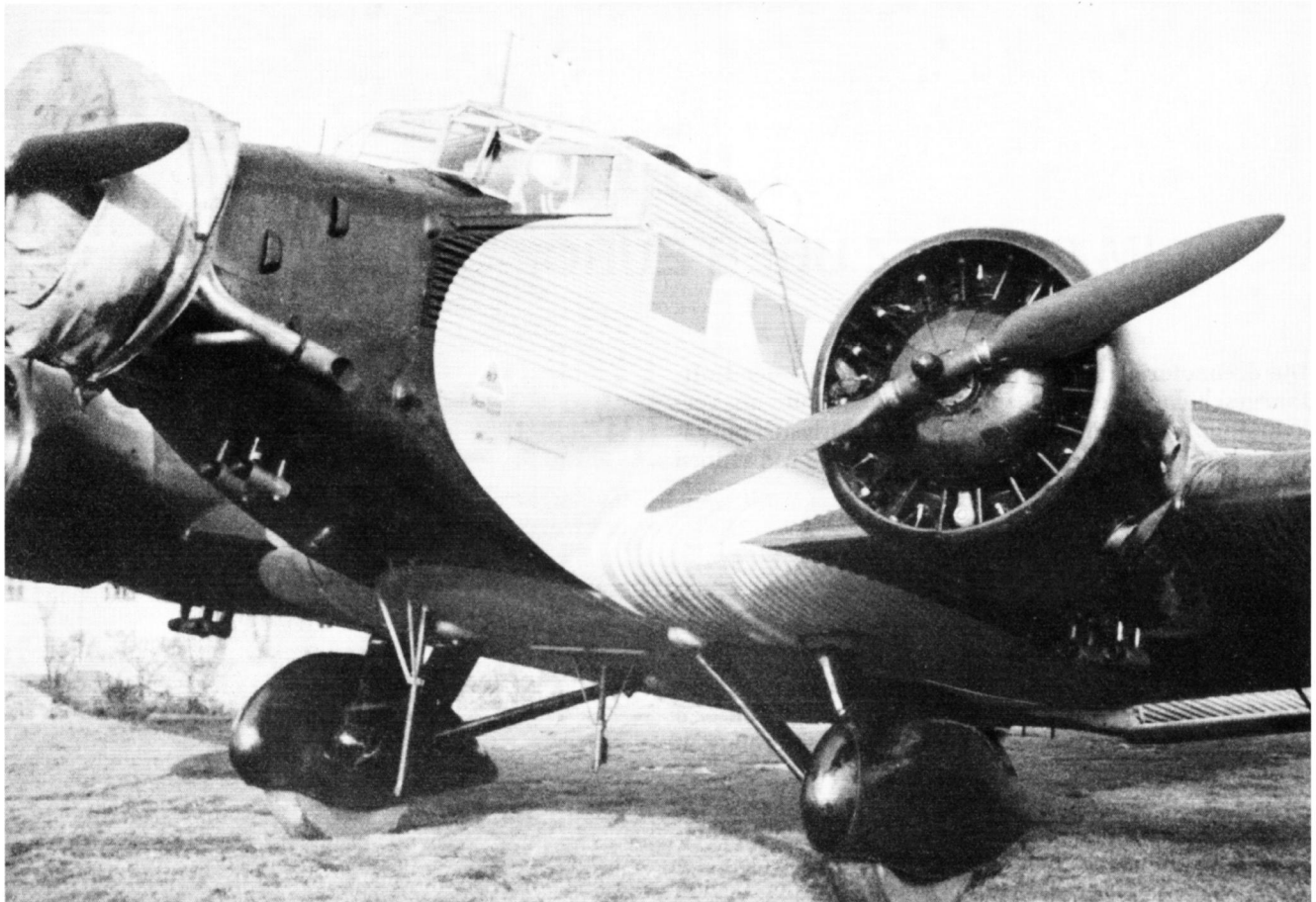
Zahlreiche Ju 52/3m wurden bei zivilen und militärischen Forschungseinrichtungen verwandt. Bei dieser Maschine handelte es sich um eine Erprobungsmaschine, die für Tests mit neuen Funkgeräten mit zusätzlichen Antennen ausgerüstet war.
