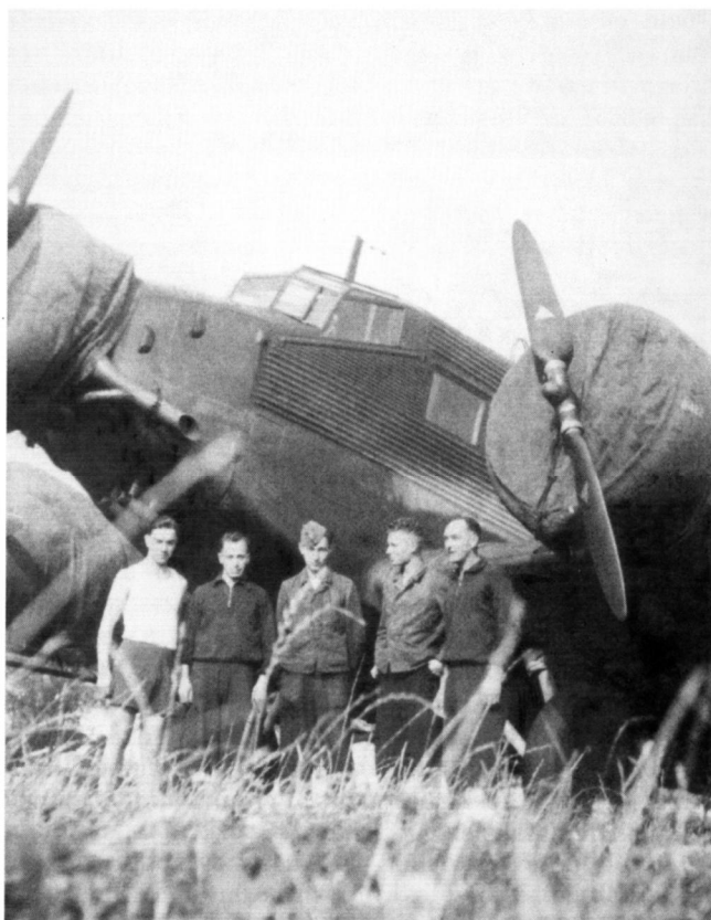
Zur Ausrüstung aller Ju 52/3m gehörte diese Verkleidung der Sternmotoren, um sie vor Verschmutzung oder Vereisung zu schützen. Die Aufnahme entstand anlässlich einer Verlegungsübung auf freiem Feld in der Nähe von Memmingen.
