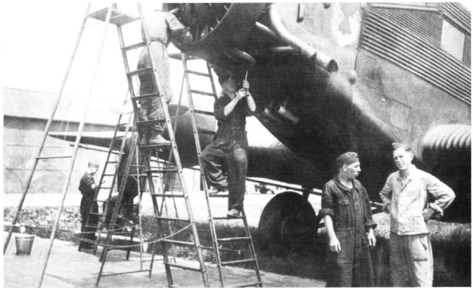
Während der 20-Stunden-Kontrolle fand der Staffelführer Zeit für diesen Fototermin, bei dem er die Warte der 1./Kampfgruppe z.b.V. 105, die sich gerade an der Triebwerksanlage zu schaffen machten, ablichtete.
