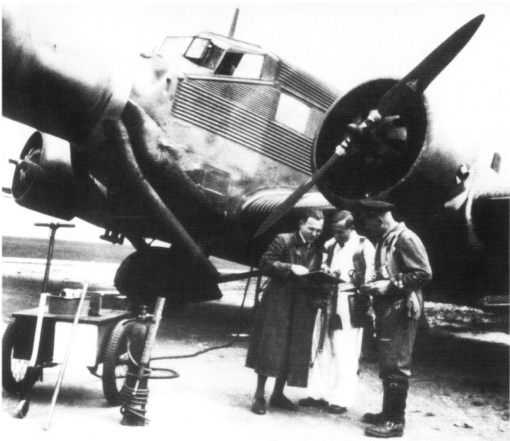
Zahlreiche Ju 52/3m wurden den Motorenherstellern als Erprobungsträger für neue Triebwerke überlassen. Als Mittelmotor dieser Maschine war eine neue Ausführung des BMW 801 angebracht, um im Dauerbetrieb getestet zu werden.
