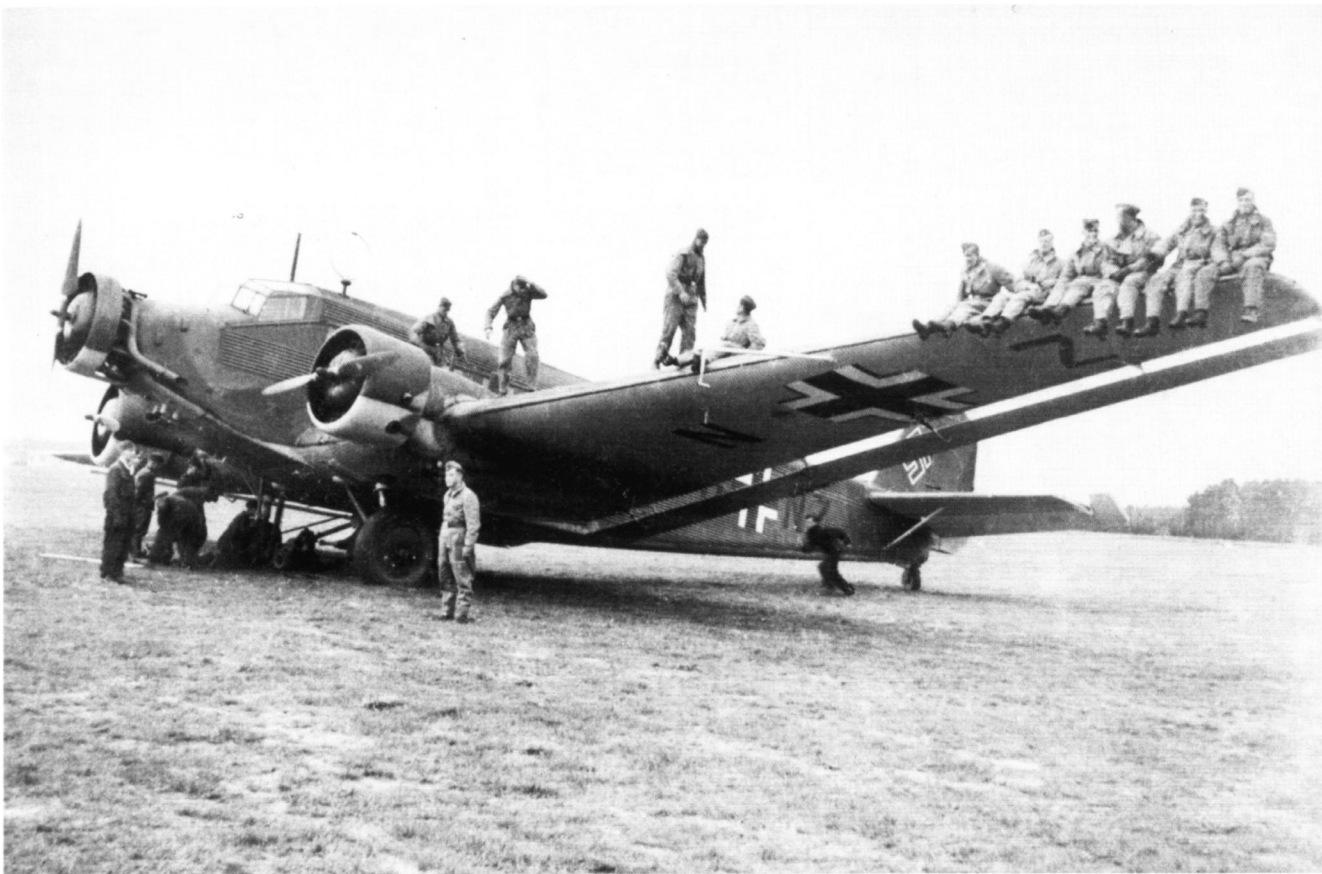
Die Robustheit der Konstruktion der Ju 52-Transporter wird verdeutlicht durch die hohe Belastbarkeit der Tragflächen. Unter dem Rumpf wurde zwischen dem Hauptfahrwerk gerade eine sperrige Außenlast angebracht.
