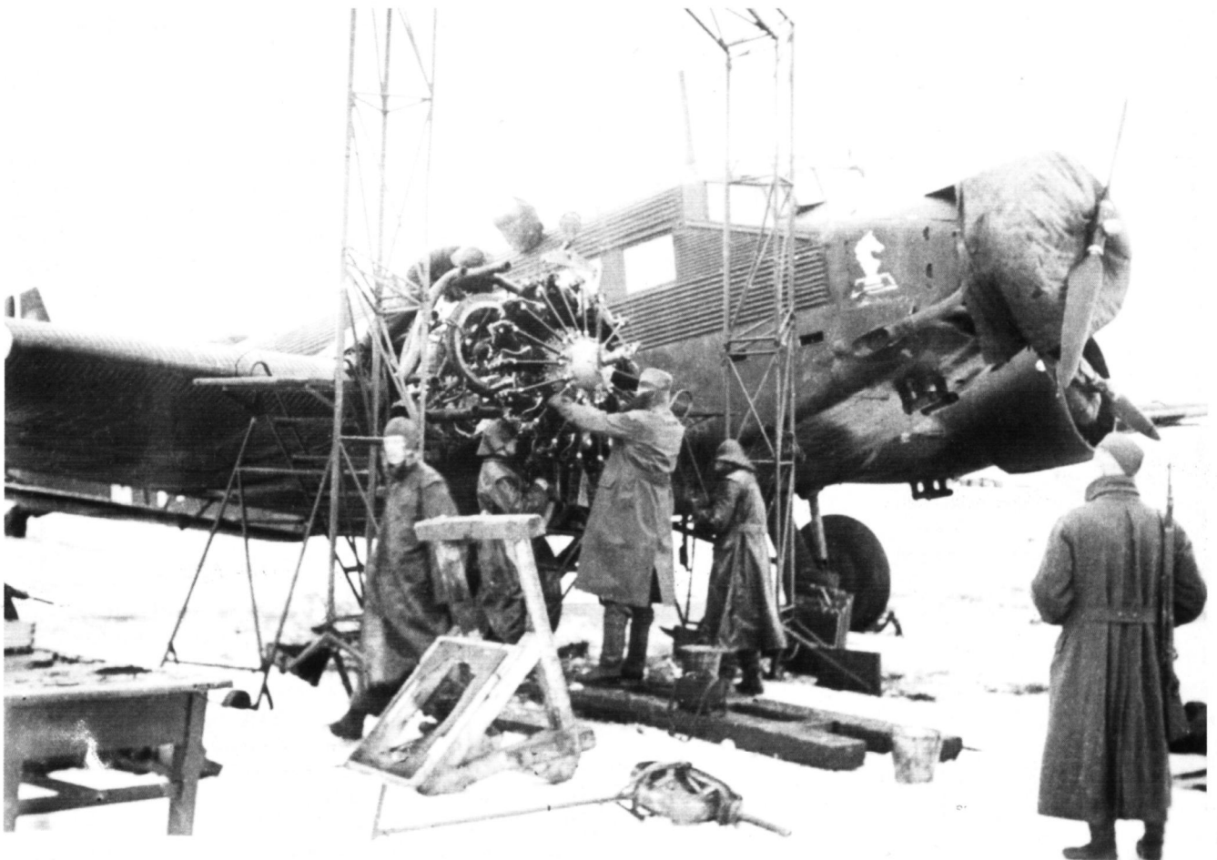
Eine Maschine der I. Gruppe des Transportgeschwaders (TG) 1 während des Triebwerkswechsels unter freiem Himmel. Da auf den vorgeschobenen Absprungbasen ständig mit Partisanen gerechnet werden mußte, war ein zusätzlicher Posten aufgestellt.
