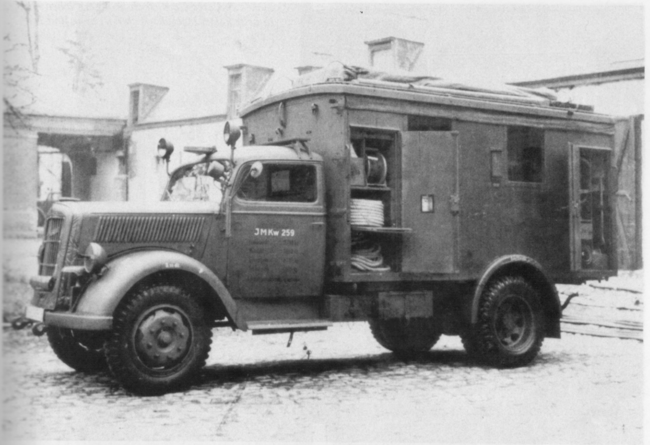
Opel Blitz 3 to als Instandsetzungsmannschaftswagen IMkw, Baujahr 1940.
