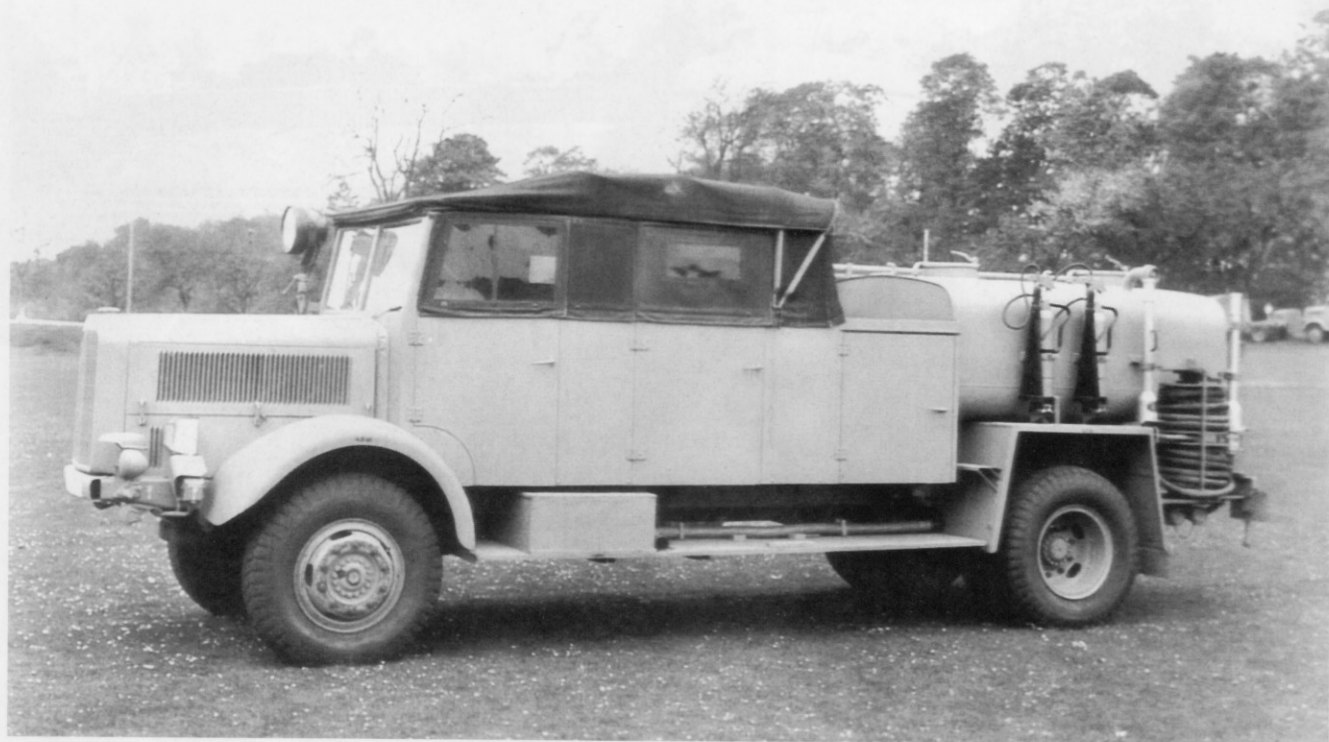
Vereinfachte Ausführung des Mercedes Benz L 4500 als Tanklöschfahrzeug TLF 25, Baujahr 1944.
