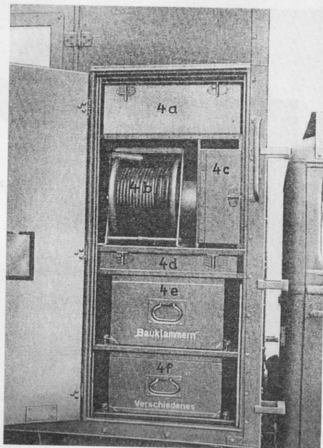
Kabeltrommel und Baumaterial waren im vorderen rechten Gerätefach untergebracht.
