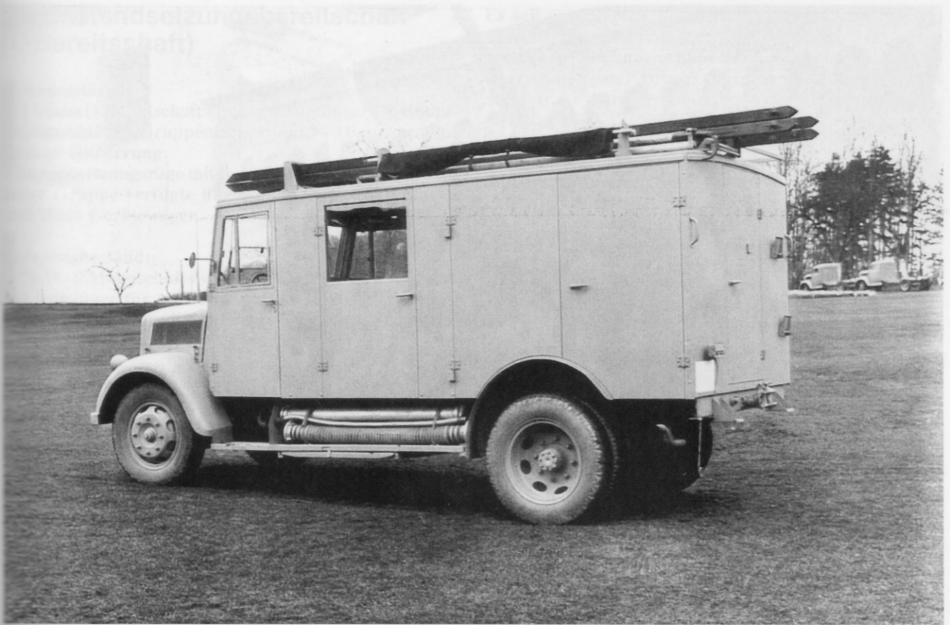
Die Aufbauten der späten LF 15 waren nicht mehr aus Stahlblech sondern aus Hartfaserplatten gefertigt.
