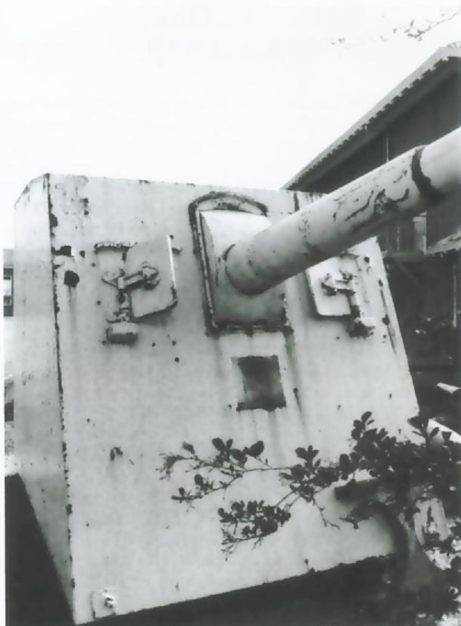
Geschützturm einer 15 cm Boforskanone, wie sie in der Batt. Helsingör verwendet wurde.
