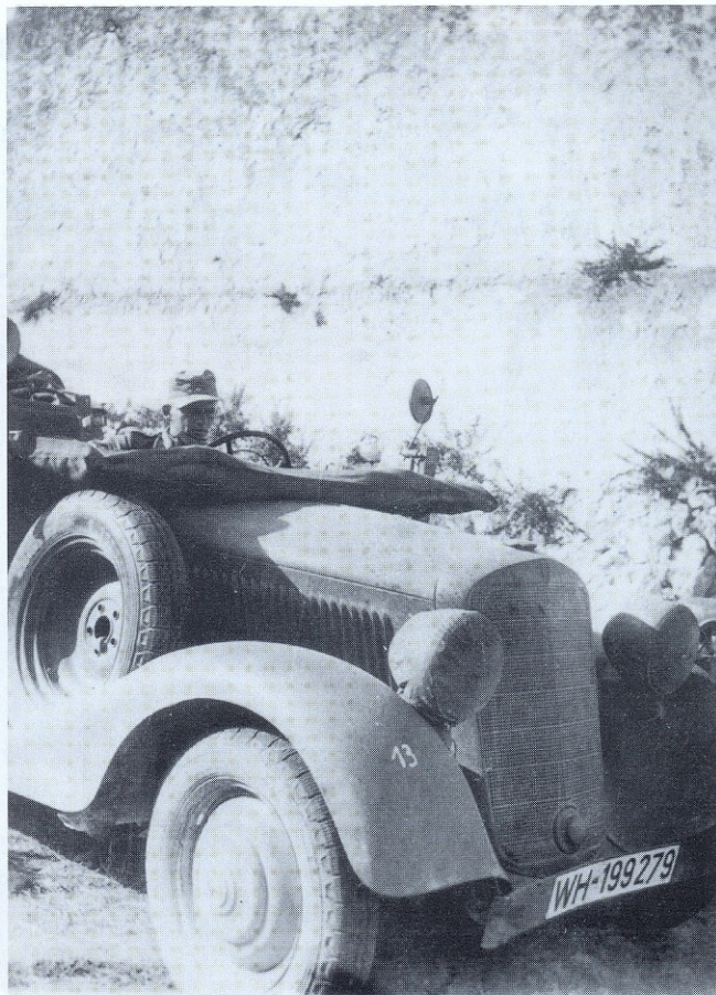
Ein 170 Kübel mit umgeklappter Windschutzscheibe in Schutzhülle. Bei diesem Fahrzeug wird die graue Tarnfarbe durch den Staub verhüllt. Nordafrika 1942.
