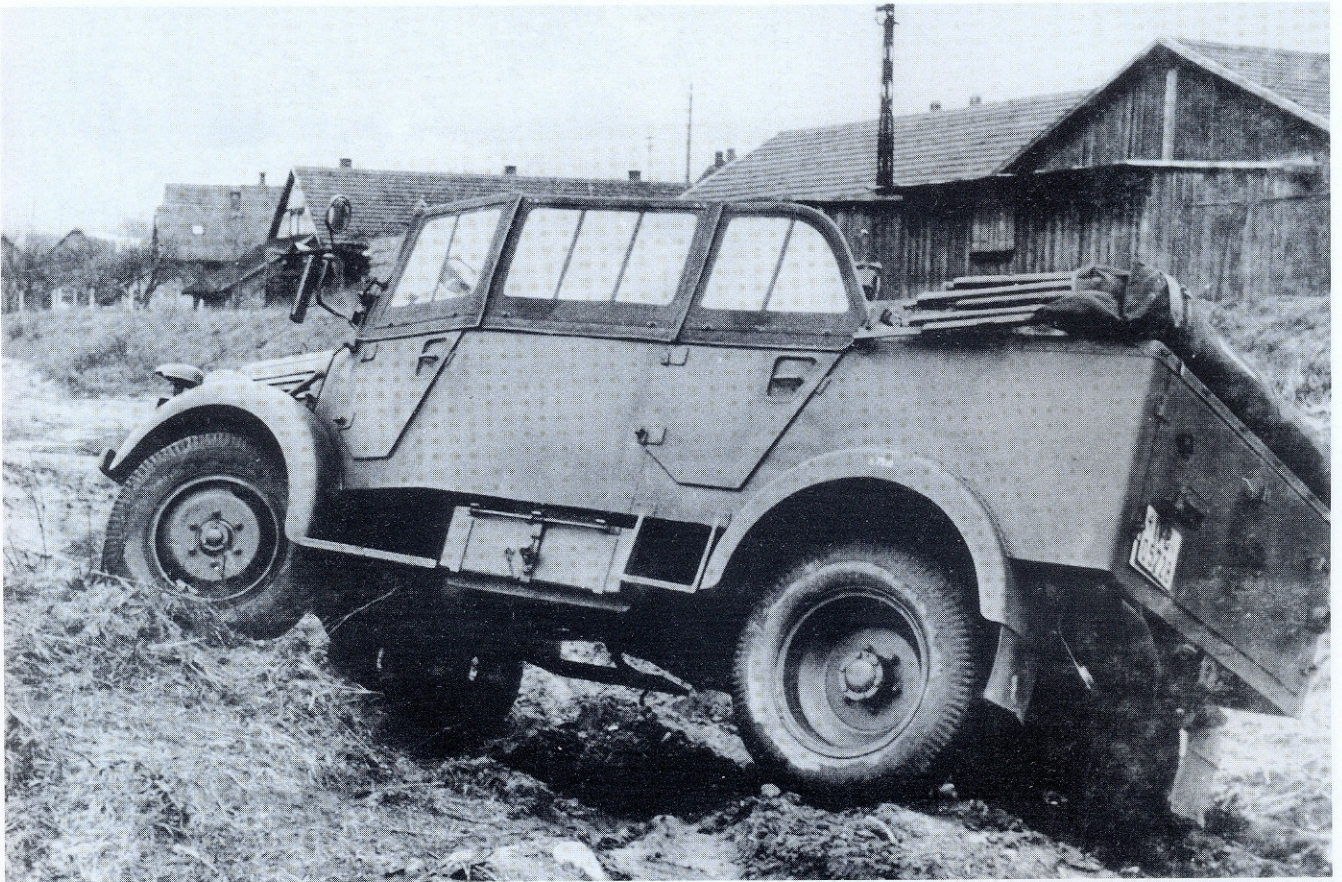
Nach dem Schell-Programm, das eine Rationalisierung der deutschen Automobil-Produktion versah, sollte sich die Daimler Benz AG auf den Bau von LKW mit 3, 4, 5 und 6 Tonnen Nutzlast konzentrieren. Entgegen den staatlichen Vorgaben entwickelte man dennoch einen 1,5 Tonner, der sich dann als Achtsitzer bei der Truppe bestens bewährte. Die technischen Daten des 1500 A: 2,6 Liter Vergasermotor, 60 PS bei 3000 U/min, Allrad-Antrieb, 2 Sperr-differentiale, Höchstgeschwindigkeit 85 km/h, Verbrauch 30 Liter (Gelände), 20 Liter (Straße), Bodenfreiheit 240 mm, Gewicht 2400 kg.
