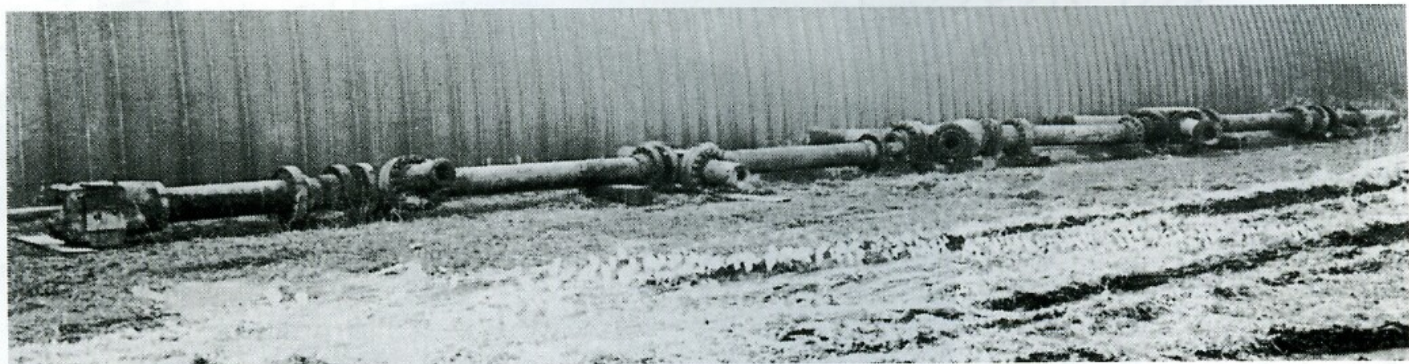
Provisorischer HDP-Versuchsaufbau aus fünf Verbindungsstücken mit Verschluß- und Mündungsteil.
