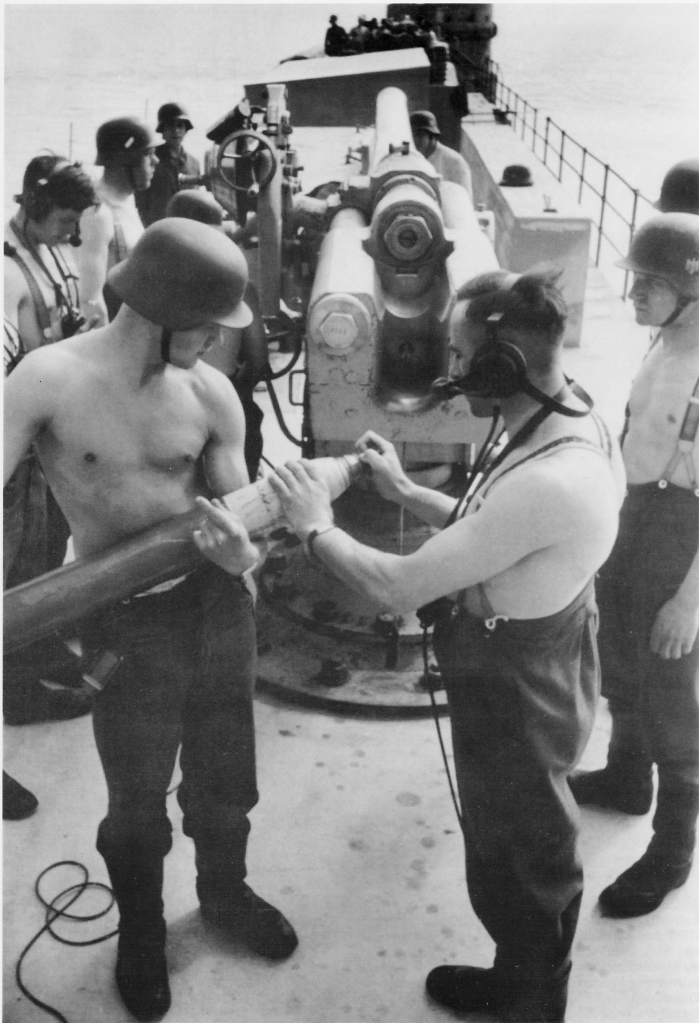
Der Zeitzündler einer 10,5 cm Sprenggranate wird mit dem Zündstellschlüssel eingestellt.
