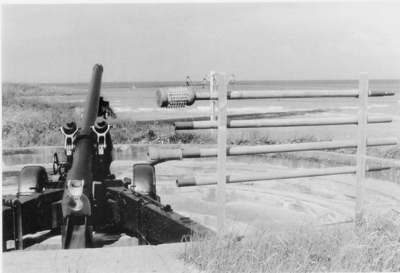
Die Rohrreinigungsgeräte der 12 cm K 370 (b) in einer Halterung am Rand der Kesselbettung.
