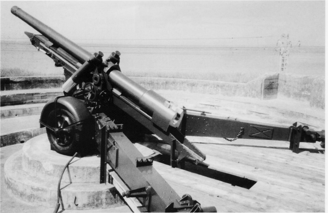
Die Kanonen wurden mit dem Radfahrgestell auf den betonierten Sockel gestellt.
