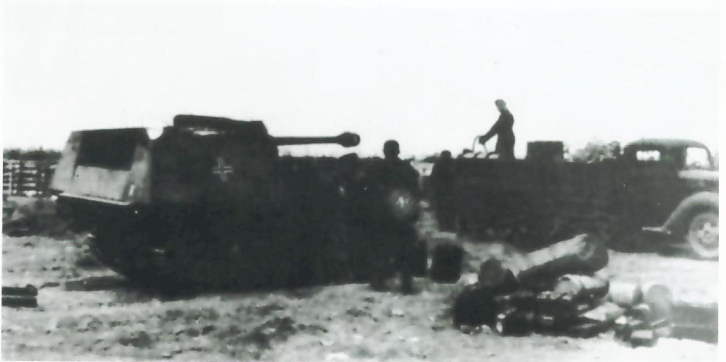
Zu den ersten Panzerjäger-Selbstfahrlafetten mit der 7,5-cm-Panzerjägerkanone 40 gehörte der Geschützwagen auf Lorraine Schlepper (f) (Sd.Kfz.135), der im Sommer 1942 zur Truppe gelangte.
