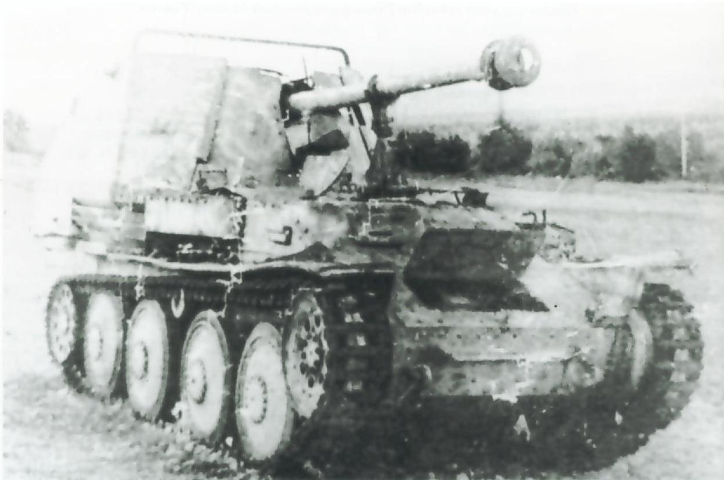
Front - und Heckansicht einer Panzerjäger-Selbstfahrlafette 38 (t), die auch unter der Bezeichnung "Marder" III bekanntgeworden ist. Das Fahrzeug wog 10,5 t und konnte maximal 42 km/h erreichen. der Fahrbereich ist mit 190 km angegeben. Die Panzerung bot Schutz vor SmK-Munition und Granatsplittern.
