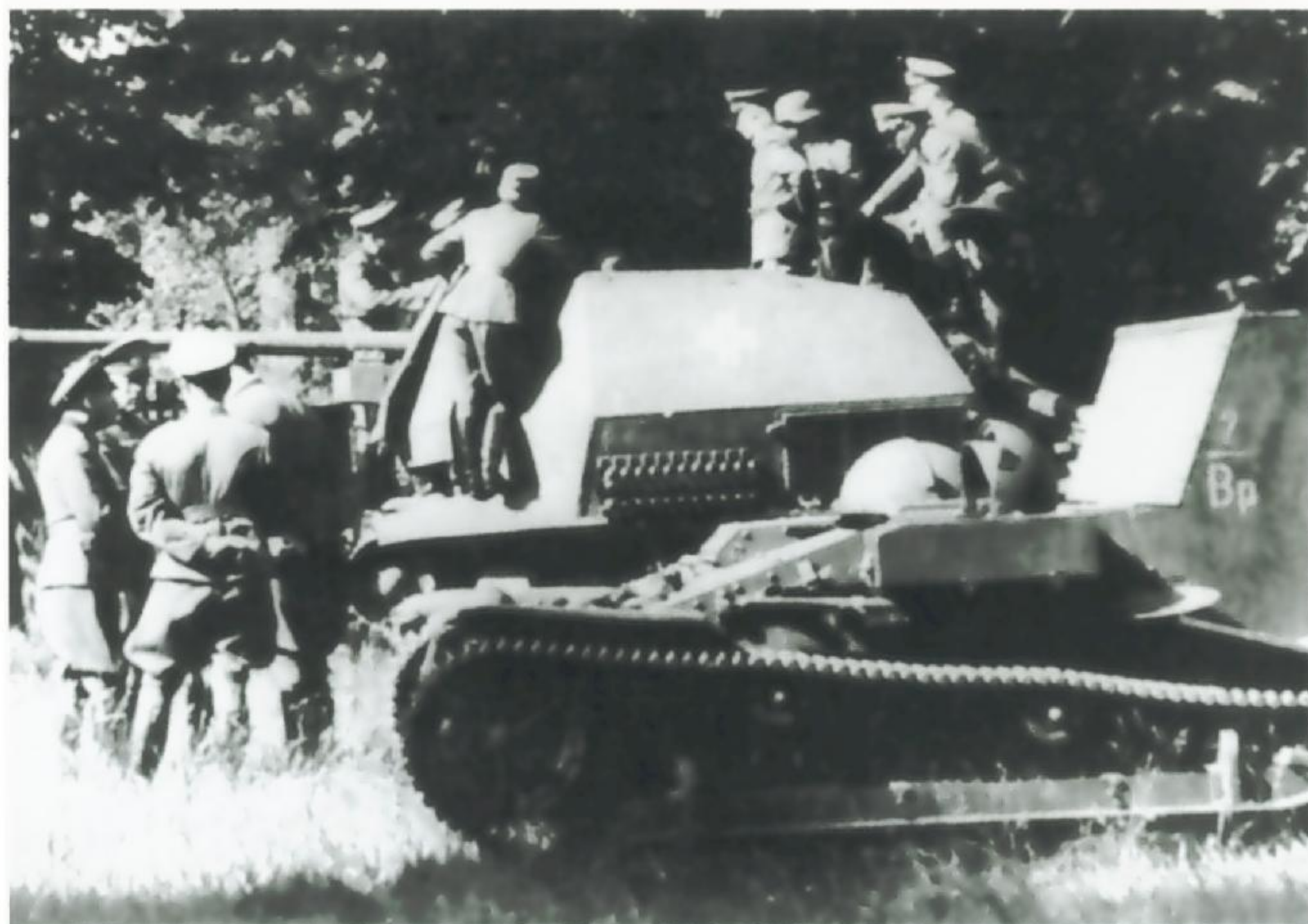
Der Versuch das Zugmittel, den Raupenschlepper Ost (RSO) mit der 7,5-cm- Panzerjägerkanone 40/4 zu einer Selbstfahrlafette zu verbinden, führte zu dieser wenig gelungenen Lösung einer Panzerjäger-Selbst- fahrlafette,.
