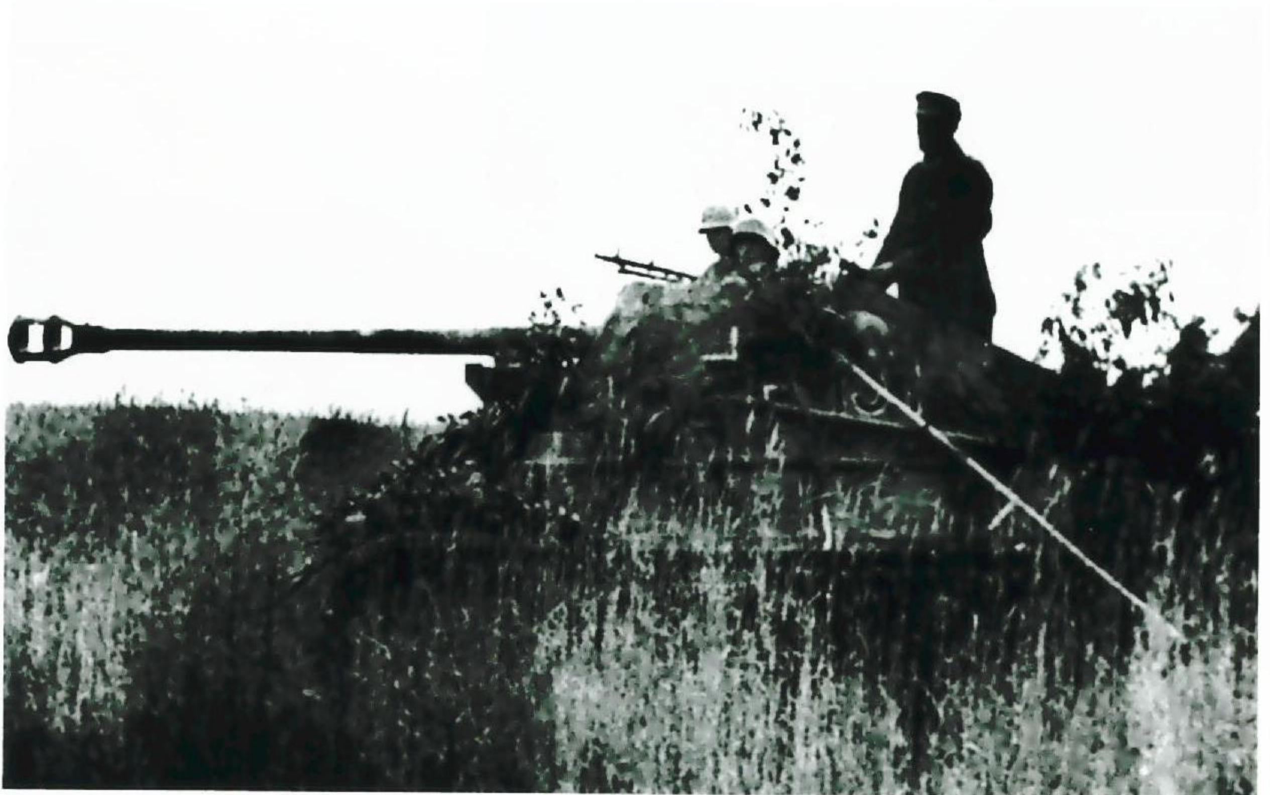
Im Spätsommer 1942 war bei einer Panzerdivision im Osten ein Truppenversuch durchgeführt worden. Aufgabe war es gewesen in der Truppe vorhandene Panzerkampfwagen II mit feldmäßigen Mitteln in eine Panzerjäger-Selbstfahrlafette umzurüsten. Geschütze und sonstige Einbauteile wurden auf dem Versorgungsweg zugeführt.
