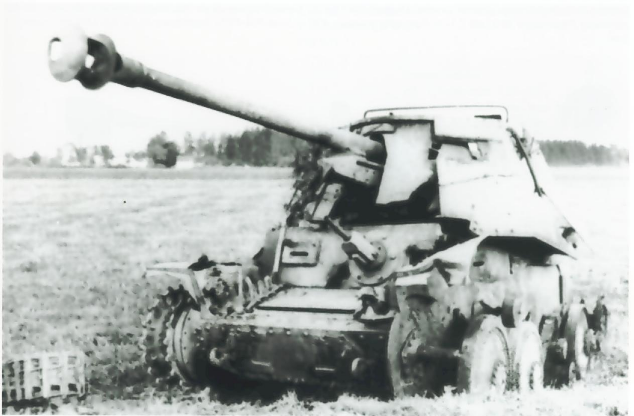
Diese Aufnahme von einer völlig zerstörten 7,5-cm-Panzerjägerkanone 40/3 (7,5-cm-Pak 40/3) auf Panzerkampfwagen 38 (t), Ausführung H (Sd.Kfz.138) entstand zum Kriegsende bei der Heeresgruppe Mitte (Böhmen und Mähren).
