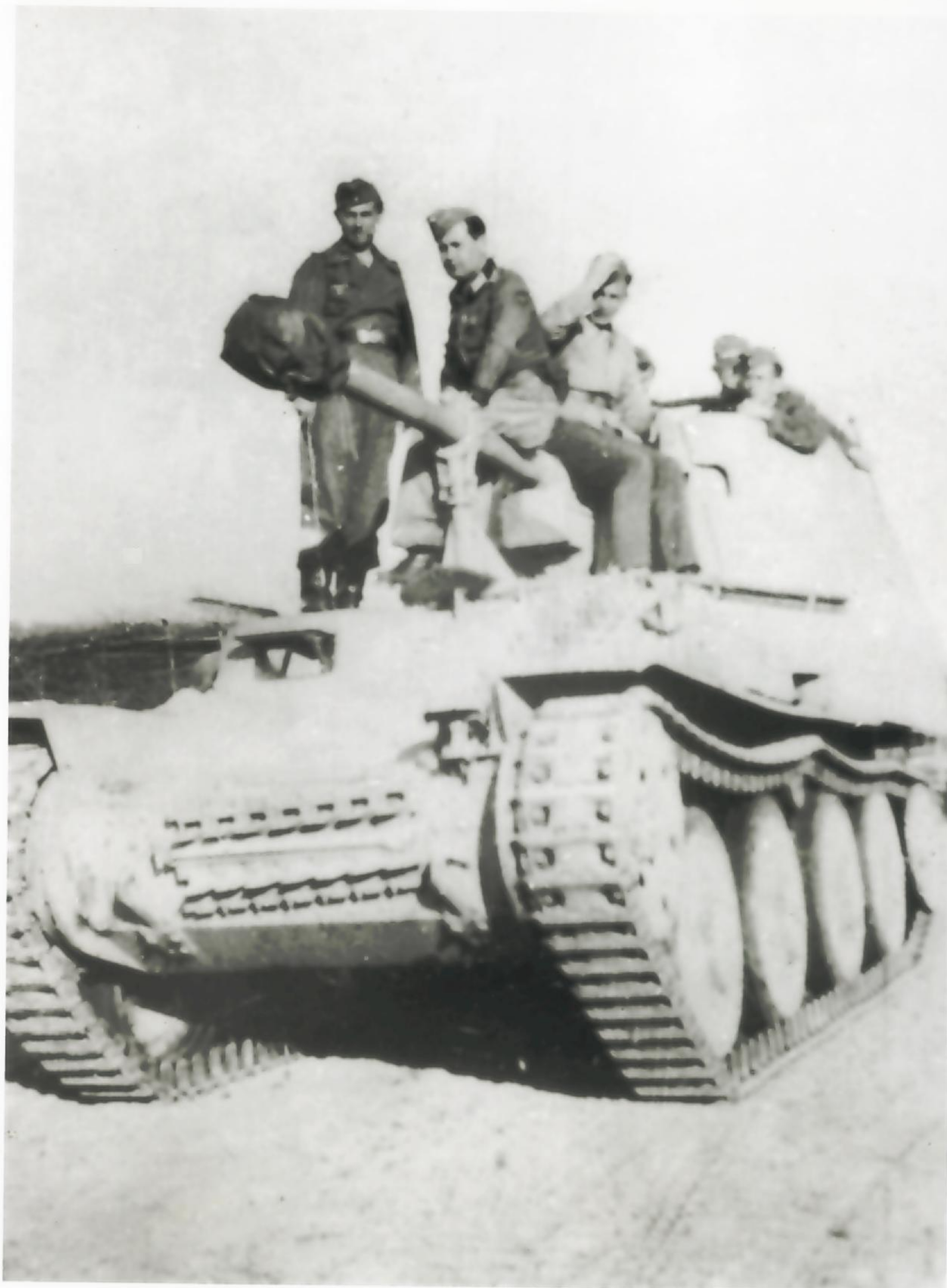
Panzerjäger 38 (t) mit 7,5-cm-Panzerjägerkanone 40/3, Ausführung M (Sd.Kfz.138)
