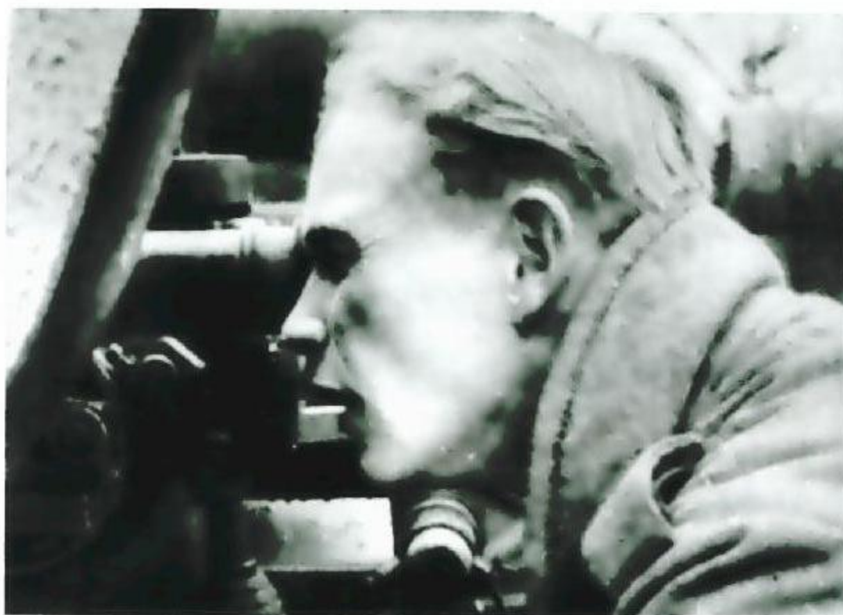
Richtschütze am Zielfernrohr 3x8°. Es besaß eine dreifache Vergrößerung und ermöglichte das Anrichten und genaue Beobachten des Zieles auch auf größere Entfernung.
