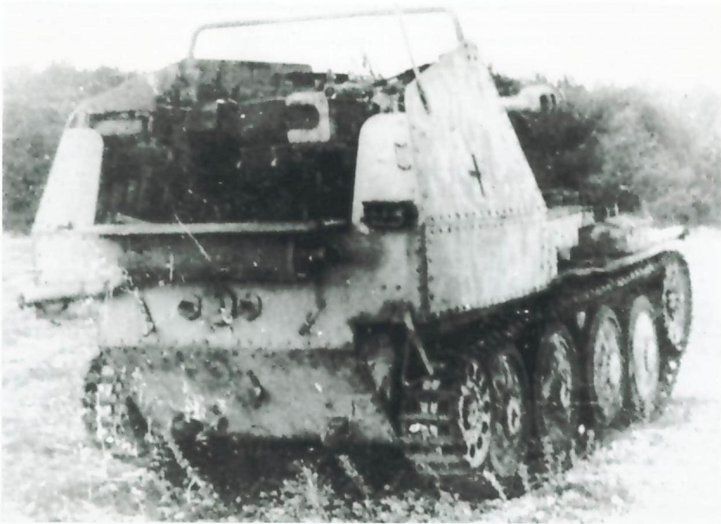
Front - und Heckansicht einer Panzerjäger-Selbstfahrlafette 38 (t), die auch unter der Bezeichnung "Marder" III bekanntgeworden ist. Das Fahrzeug wog 10,5 t und konnte maximal 42 km/h erreichen. der Fahrbereich ist mit 190 km angegeben. Die Panzerung bot Schutz vor SmK-Munition und Granatsplittern.
