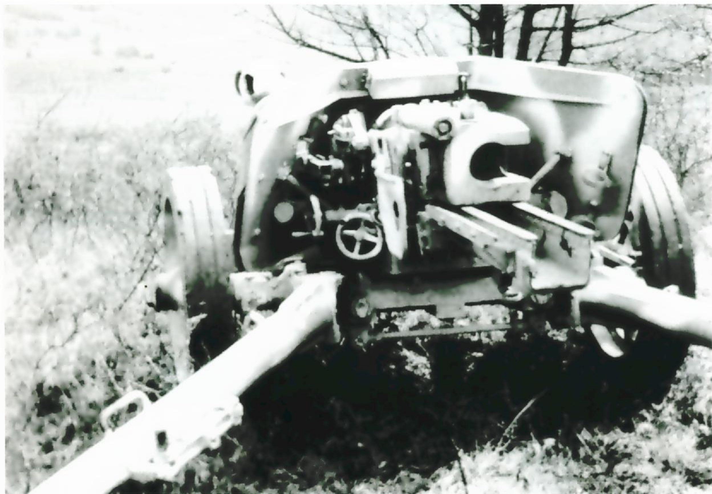
Bei der Auswahl der Feuerstellung für die 7,5-cm-Panzerjägerkanone 40 wurde angestrebt die Räder möglichst in einer waagerechten Ebene stehen zu lassen. So konnte ein Verkanten des Rohres vermieden werden. Die Holme paßten sich dank ihrer gelenkigen Verbindung mit der Achse den Bodenverhältnissen an. Wichtig war, daß beide Holme eine Auflage auf dem Erdboden hatten.
