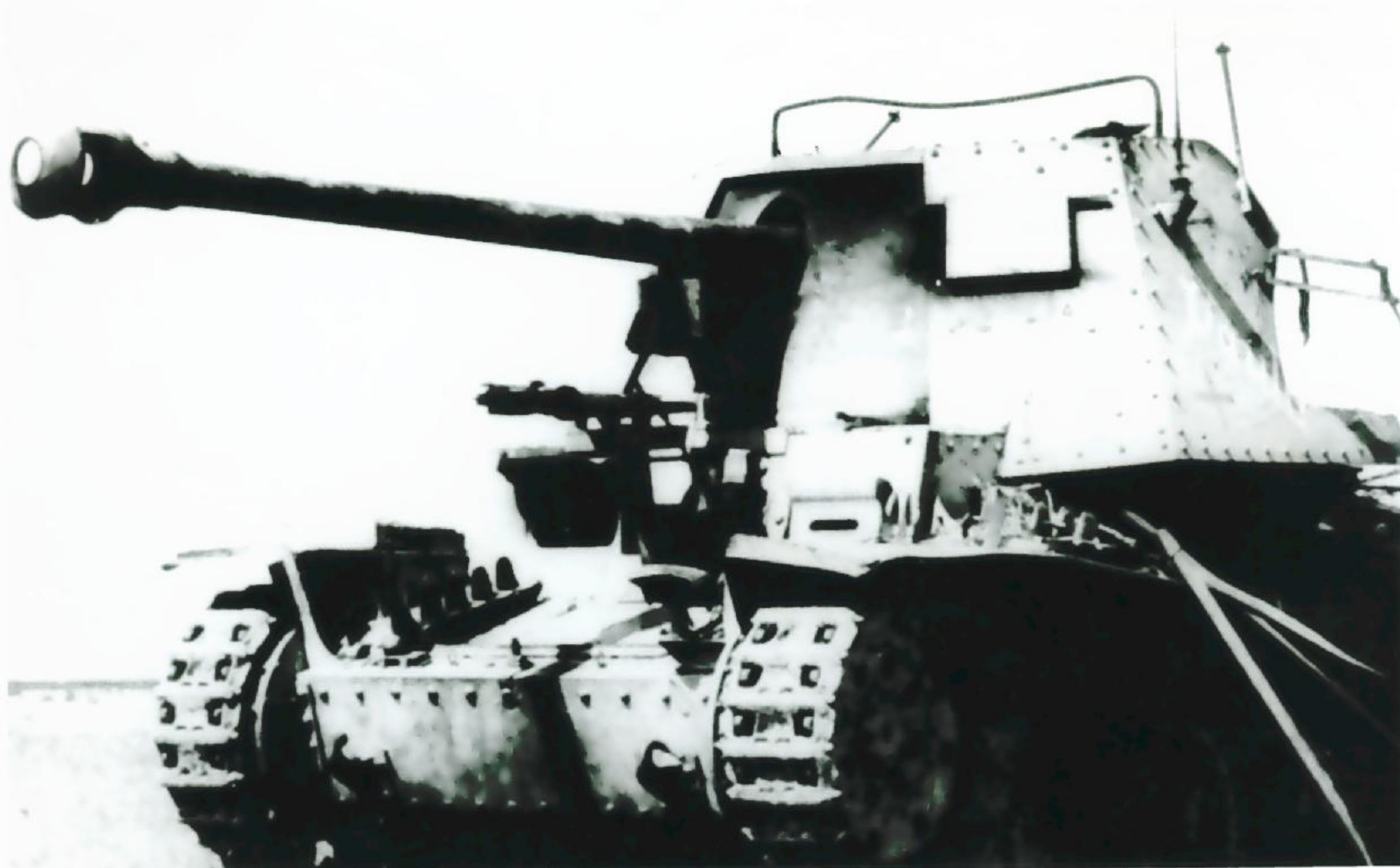
Die 7,5-cm-Panzerjägerkanone 40/3 (7,5-cm-Pak 40/3) auf dem Fahrgestell des Panzerkampfwagen 38 (t), Ausführung H (Sd.Kfz.138) wie sie am November 1942 an die schnellen Panzerjägerkompanien und -abteilungen ausgeliefert wurden.
