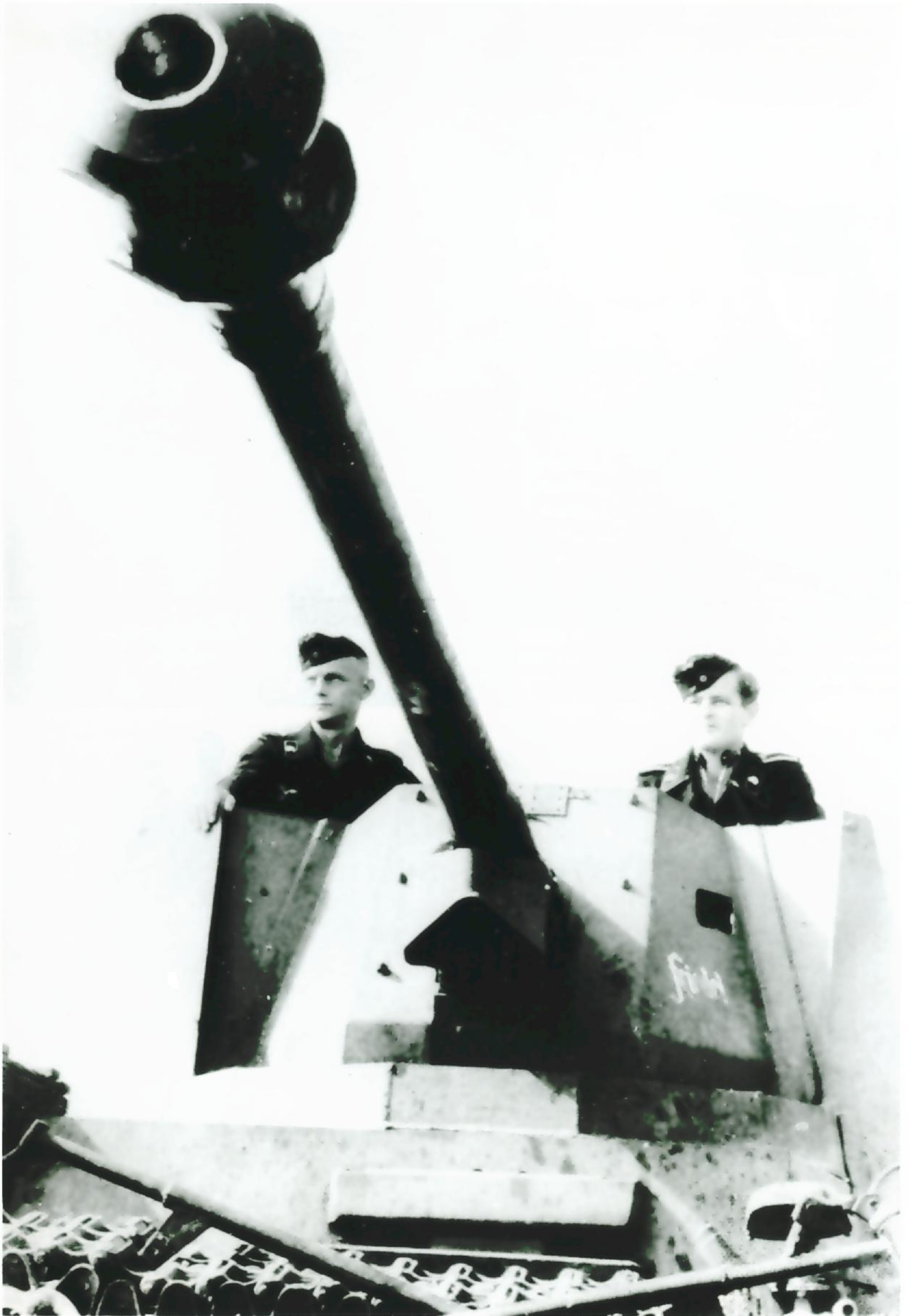
Die 7,5-cm-Panzerjägerkanone 40/2 (7,5-cm-Pak 40/2) auf dem Fahrgestell Panzerkampfwagen II (Sf.) (Sd.Kfz.131).
