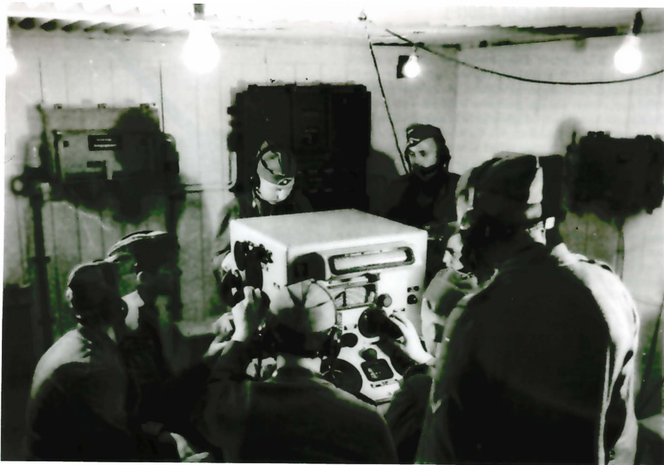
Der Feuerleitrechner der Batt. M IV. Die Grundwerte wurden durch die optischen E-Meßgeräte, die Funkmeßortung oder die Wärmepeilgeräte an den Rechner geliefert. Das Bedienungspersonal des Rechners bestand aus drei Mann. Außerdem war in der Rechenzentrale für jedes Geschütz ein Befehlsübermittler, der über Kopfhörer und Sprechfunk mit dem Geschütz verbunden war. Der Leitstandoffizier war ebenfalls mit Sprechfunk ausgerüstet.
