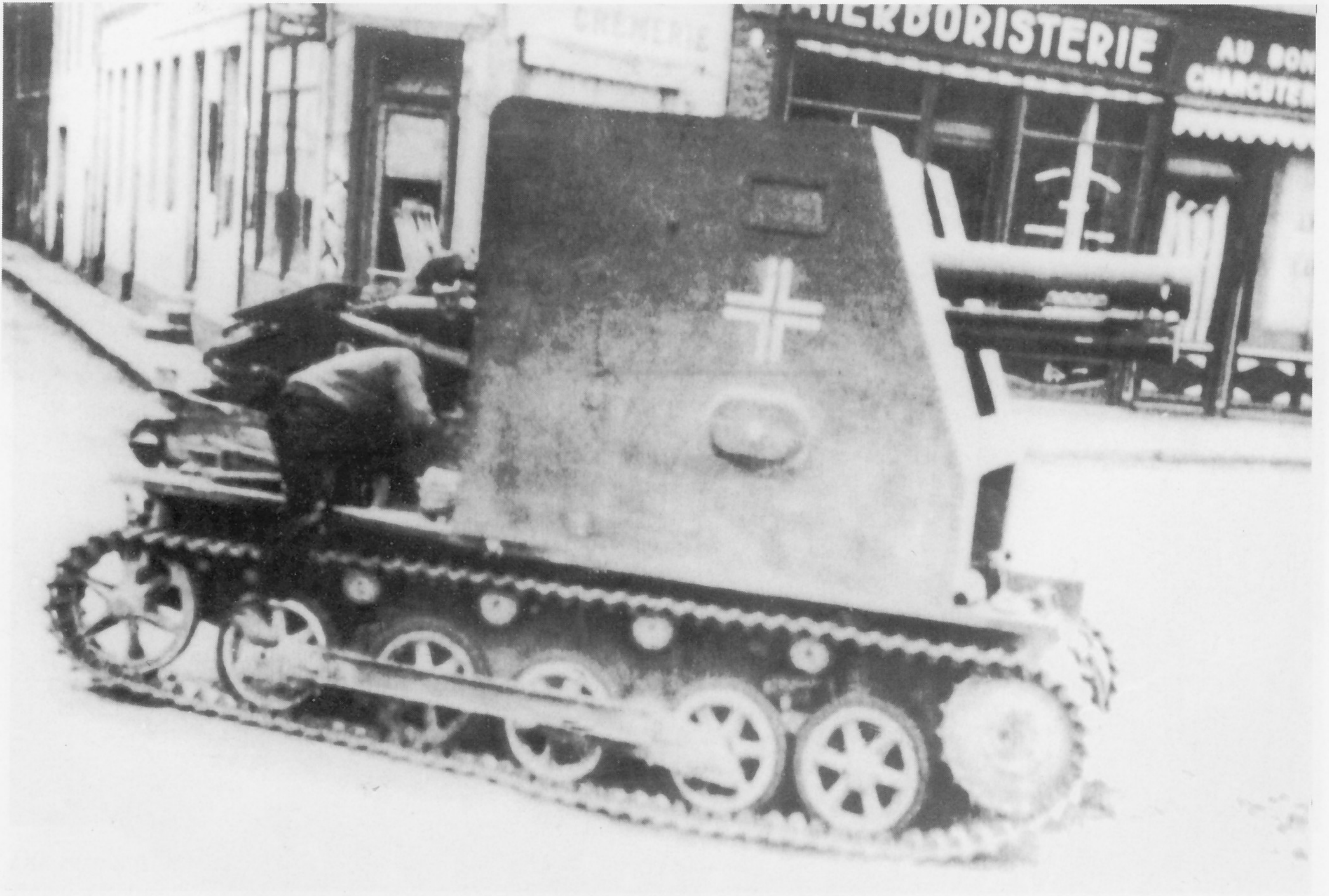
Beim Schützenregiment 1 der 1. Panzerdivision befand sich im Frankreich- und im Rußlandfeldzug die schwere Infanteriegeschützkompanie 702 mit sechs 15-cm-schweren Infanteriegeschützen 33 auf Panzerkampfwagen I B-Fahrgestell. Diese klobig und unbeholfen wirkende Fahrzeug war das Vorbild der ab 1943 hergestellten 15-cm-schweren Infanteriegeschütze 33 (Sf.) auf Panzerkampfwagen 38 (t) (Sd.Kfz.138/1).
