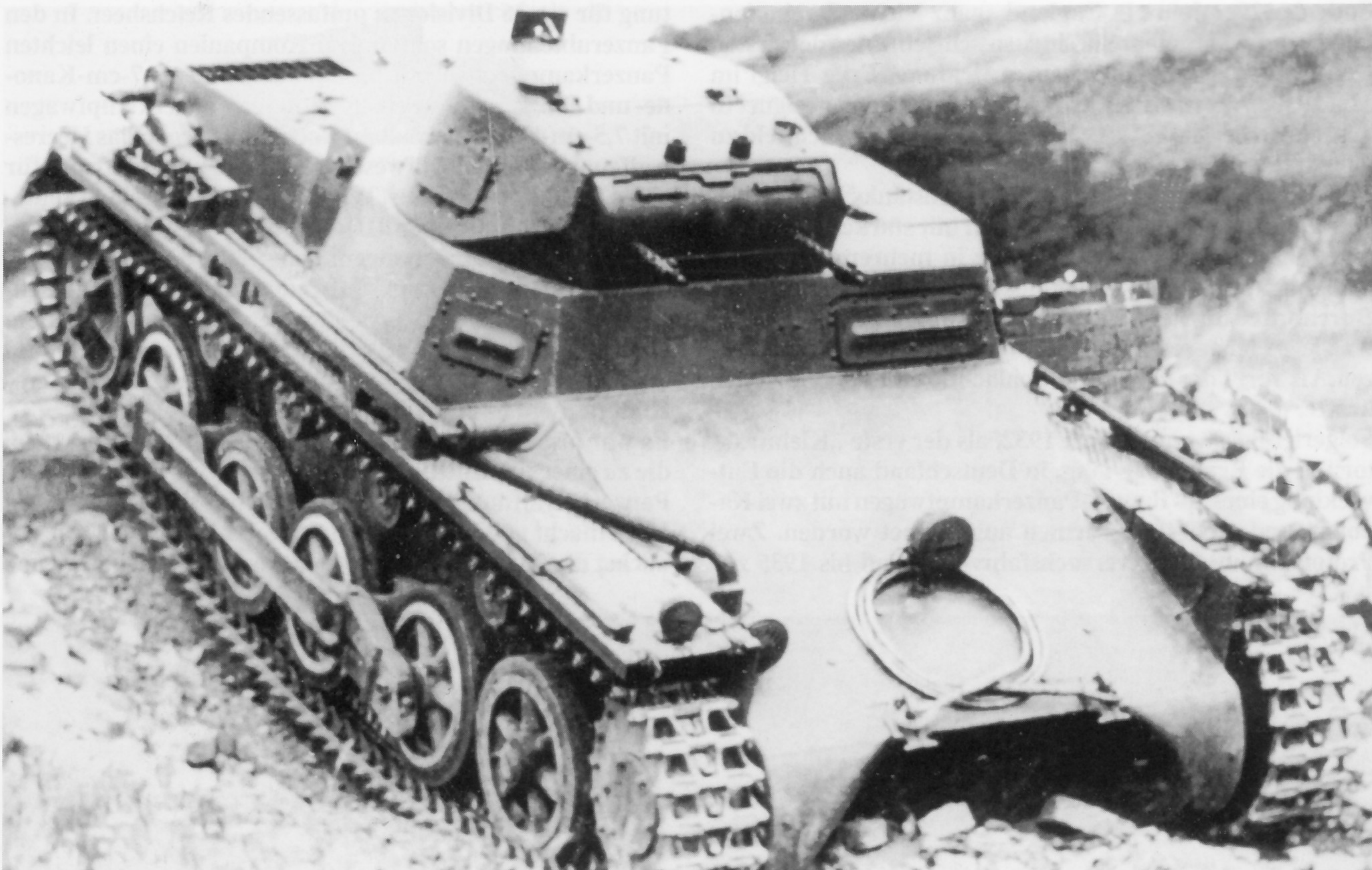
Der Panzerkampfwagen I (MG) (Sd.Kfz.101), Ausführung B verfügte mit seinem 6-Zylinder-Maybach-Motor NL 38 (100 PS) über größere Leistungsreserven gegenüber der A-Ausführung (16,6 PS/Tonne an Stelle 10,5 PS/Tonne). Feuerkraft und Panzerschutz waren gleich.
