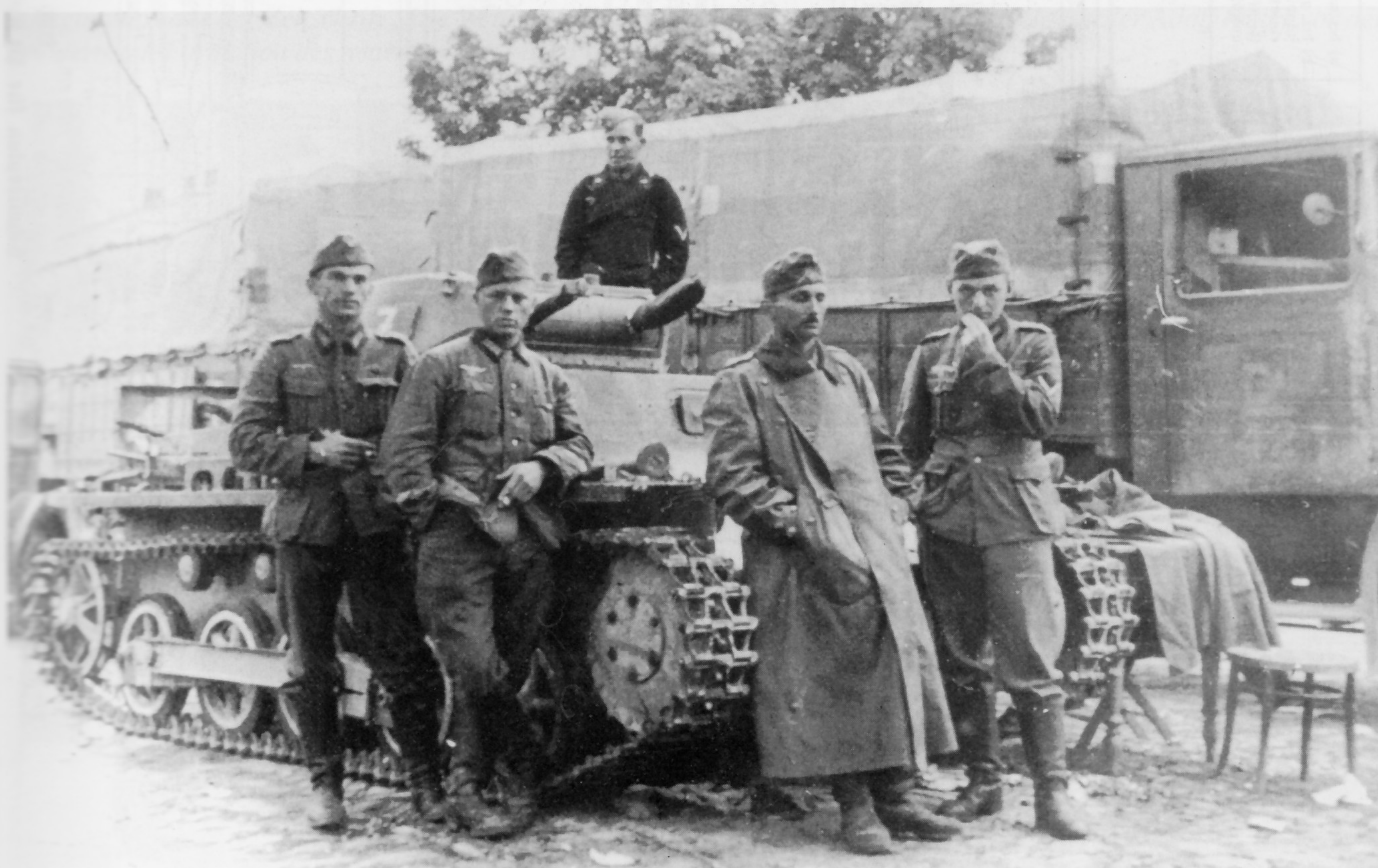
Soldaten einer Nachschubkolonne lassen sich vor einem Panzerkampfwagen I (MG) (Sd.Kfz.101), Ausführung B fotografieren. Im Vergleich mit den Personen aber auch den dahinter abgestellten Lastkraftwagen ist die geringe Höhe des Kampfwagen (1,72 m) gut zu erkennen.
