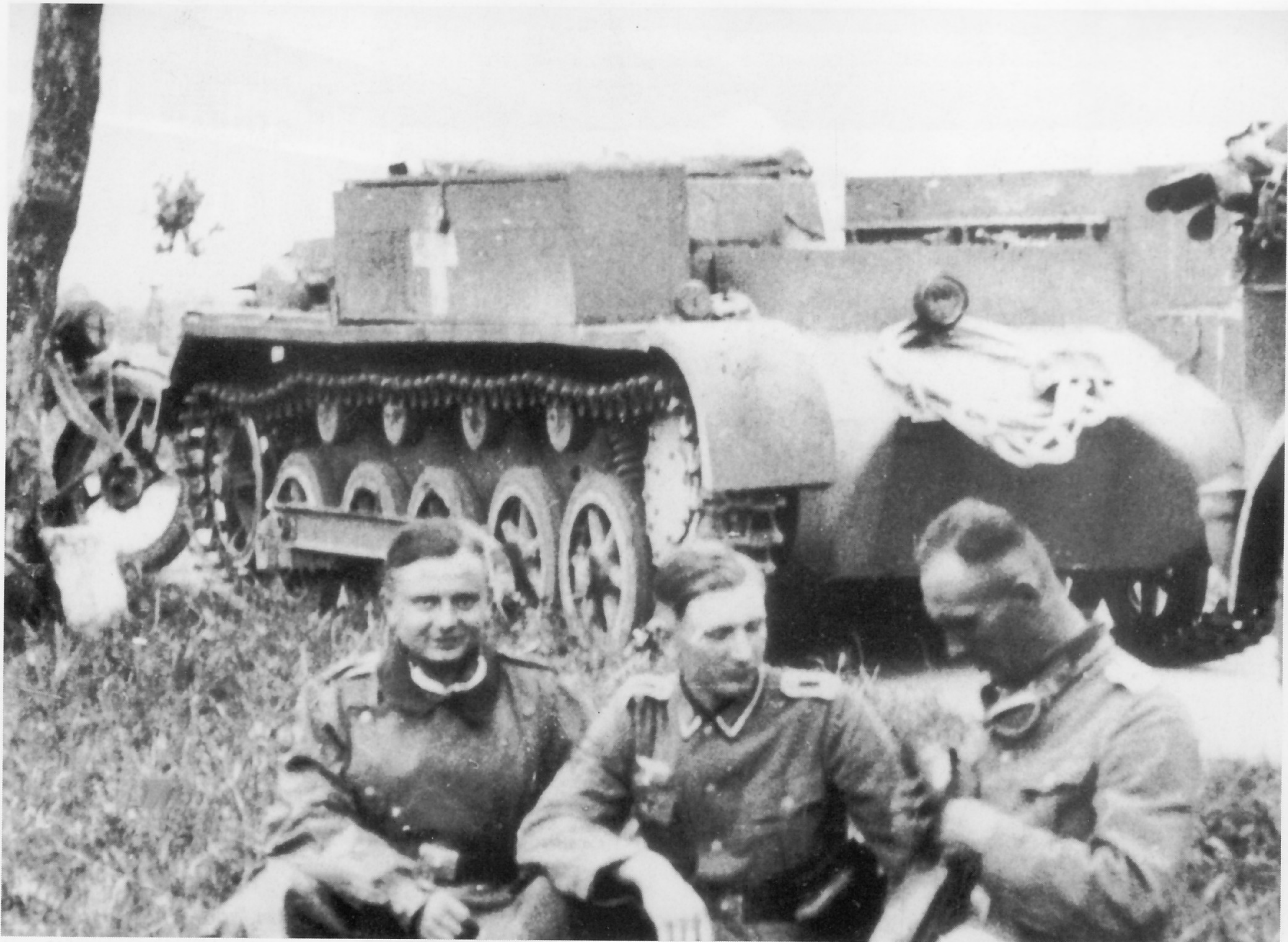
Zwischen dem November 1936 und November 1938 kamen 164 Instandsetzungskraftwagen I zur Auslieferung. Durch Umbauten bei der Truppe ist der Stauraum zur Mitführung von Werkzeug und Ersatzteilen vergrößert worden. Verwendet wurden die Fahrzeuge in den Instandsetzungstrupps (I-Trupp). Ein Teil fand später Verwendung in Fahrschulen.
