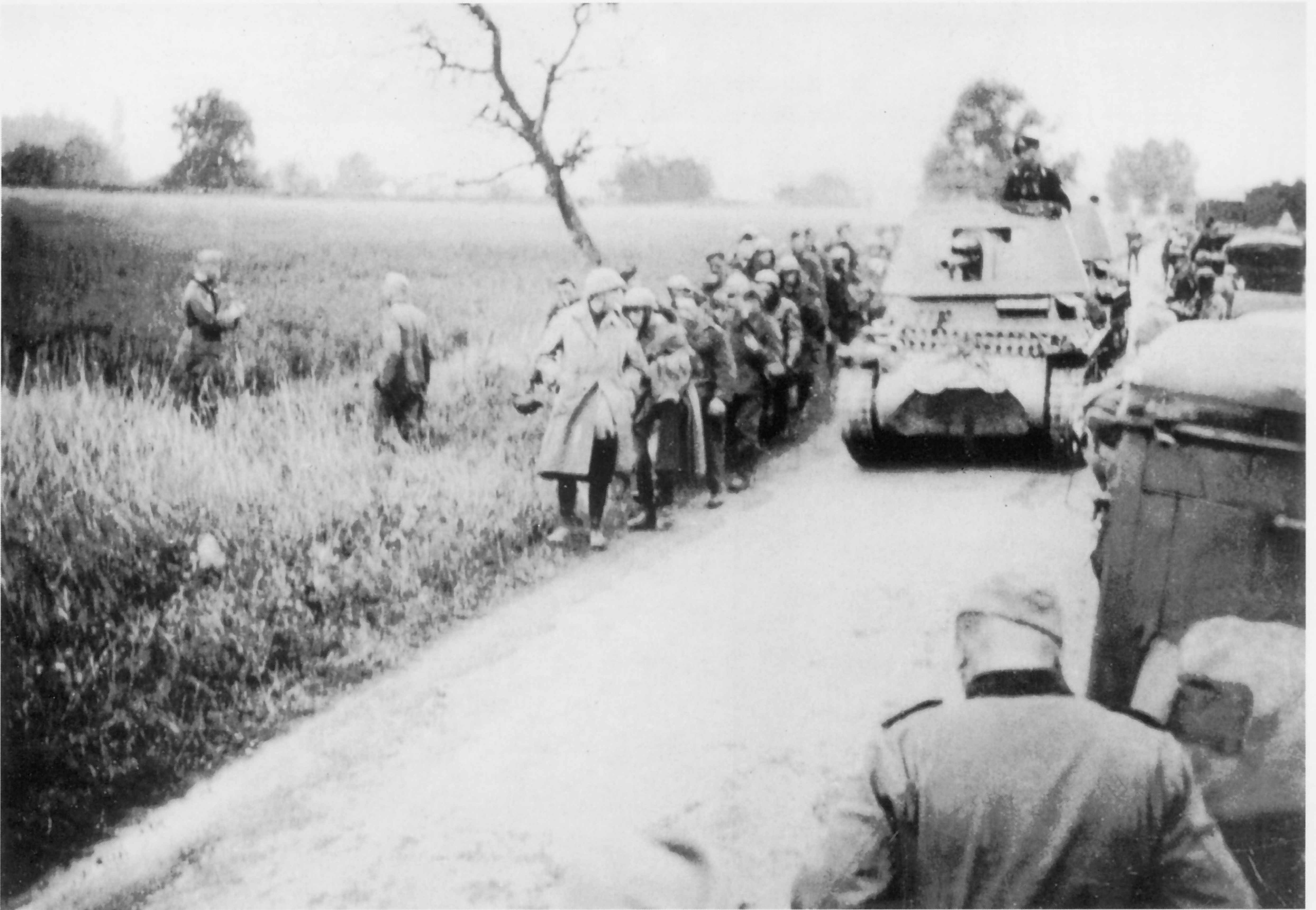
Das zulässige Gesamtgewicht des Panzerjäger I ist mit 6,4 t angegeben, die maximale Geschwindigkeit mit 42 Km/h. Bei einer Gesamthöhe von 2,26 m ergab sich eine Feuerhöhe von 1,72 m. Auch diese Aufnahme ist 1940 in Frankreich gemacht worden, als die Fahrzeuge einer Panzerjägerabteilung eine Kolonne französischer Kriegsgefangener überholen.
