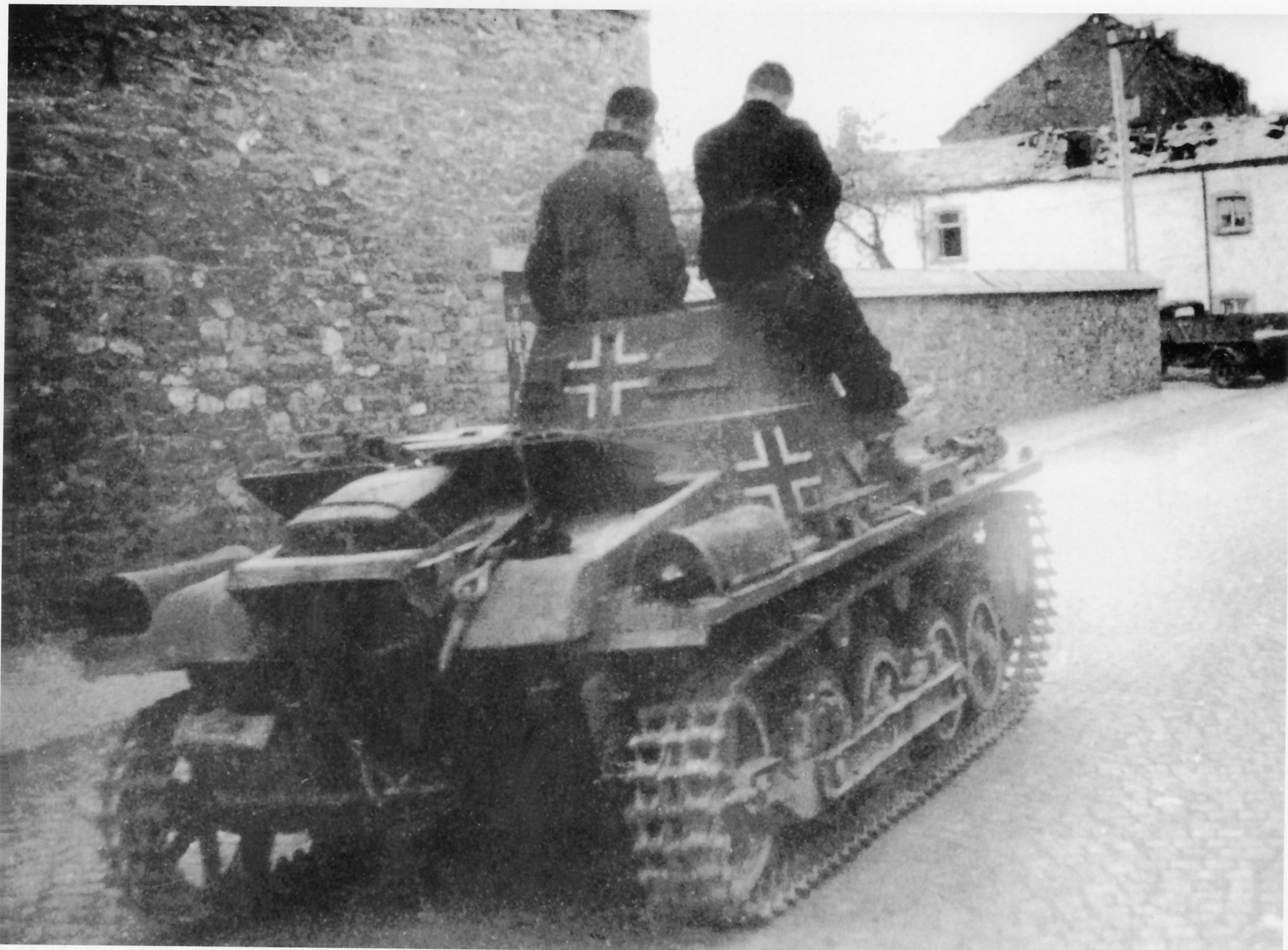
Gut zu erkennen ist bei diesem Panzerkampfwagen I (MG) (Sd.Kfz.101), Ausführung A die Anordnung der Auspuffanlagen, an beiden Seiten und die veränderte Luftzufuhr auf der Motorraumabdeckung. In der Mitte das Nebelkerzenabwurfgerät. Frankreich 1940.
