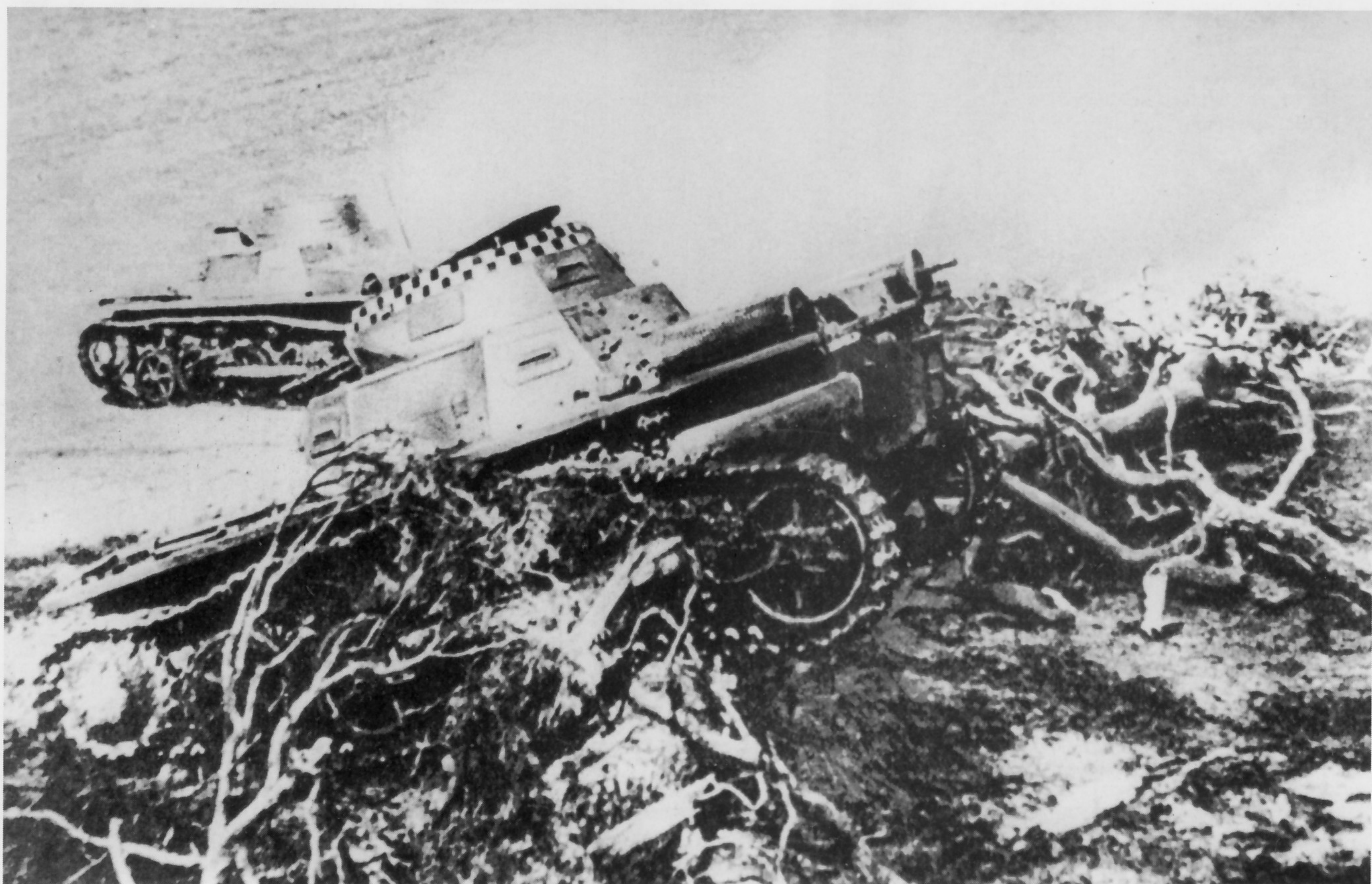
Hindernisse (Gräben, Mauerreste, Baumstämme usw.) waren möglichst in den niedrigen Gängen zu nehmen. Das Lenken beim Abwärtsfahren von Hängen war bis auf kleine Einschläge möglichst zu vermeiden. Wendungen auf der Stelle sollten nur in Notfällen ausgeführt werden. Im Bild: Panzerkampfwagen (MG) (Sd.Kfz.101), Ausführung A beim Panzerregiment 3 vor dem Krieg.
