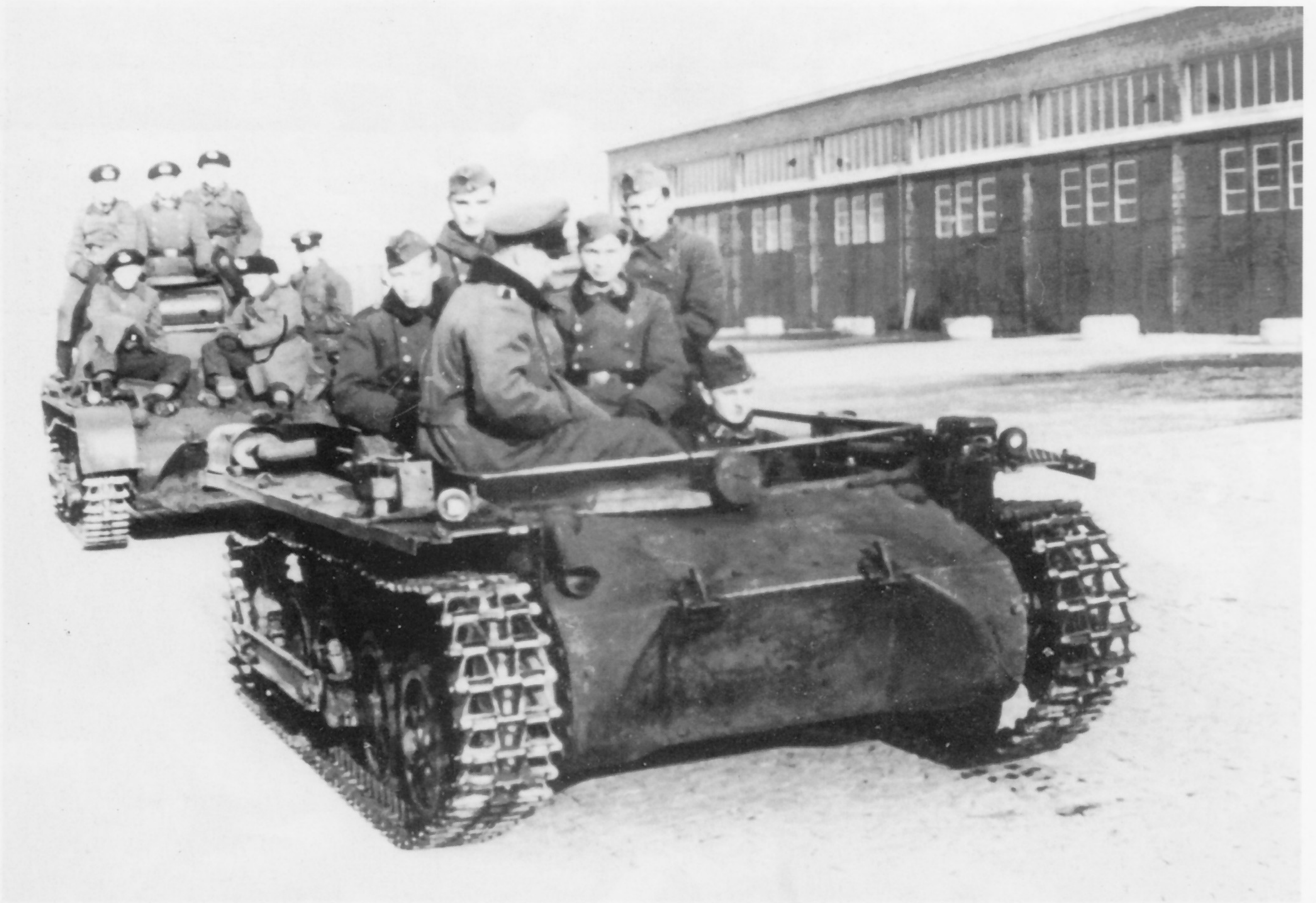
Ohne Aufbau und Turm wog der Fahrschulpanzer IA (LaS Krupp) etwa 3,5 t. Im Fahrerraum fanden neben dem Fahrlehrer mehrere Fahrschüler Platz.
