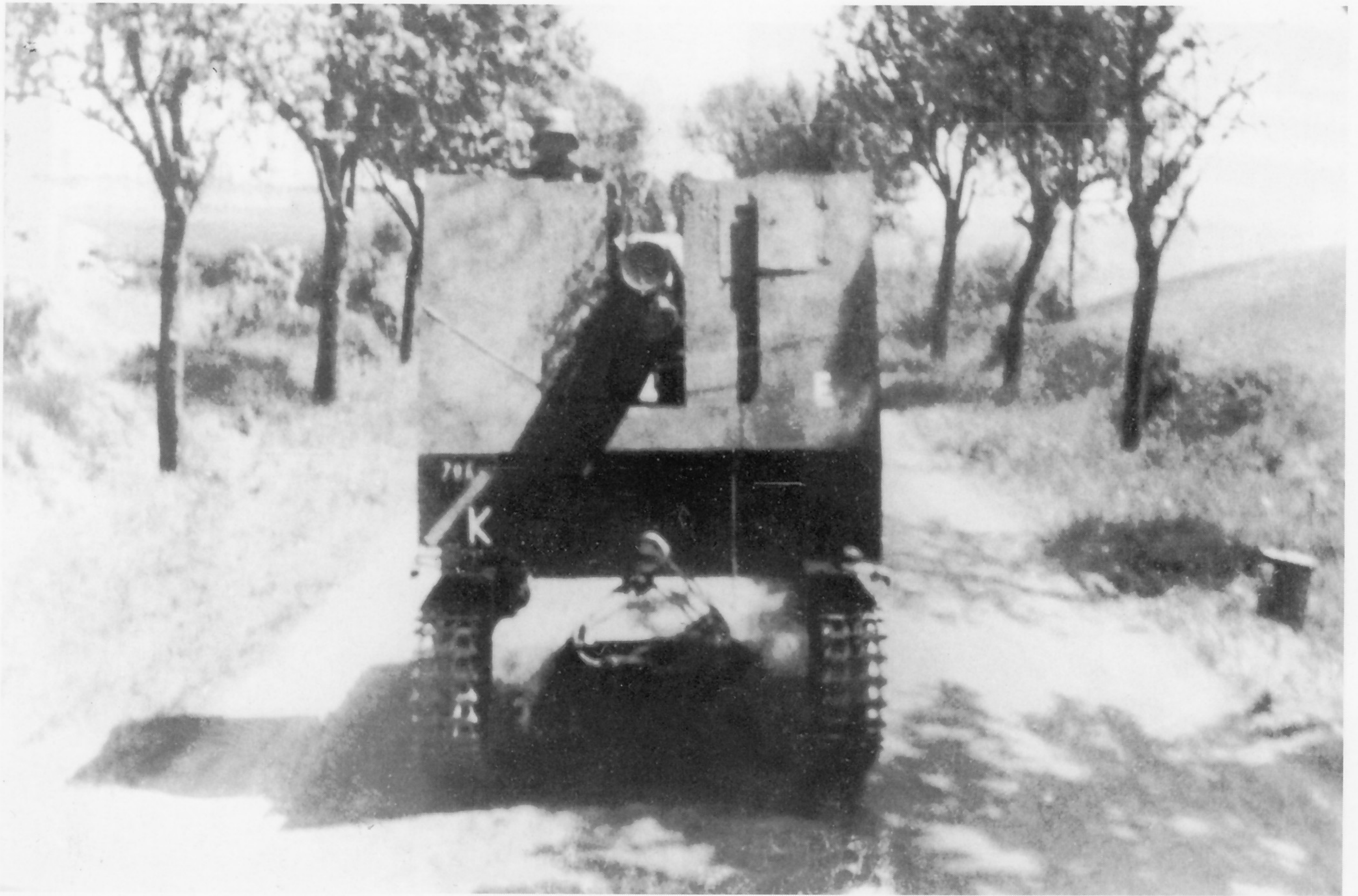
Das 15-cm-schwere Infanteriegeschütz konnte 38 Kg schwere Sprenggranaten bis 4700 m weit schießen. Deren Spreng- und Splitterwirkung war beachtlich. Daneben gab es Nebel- und Hohlladungsmunition.
