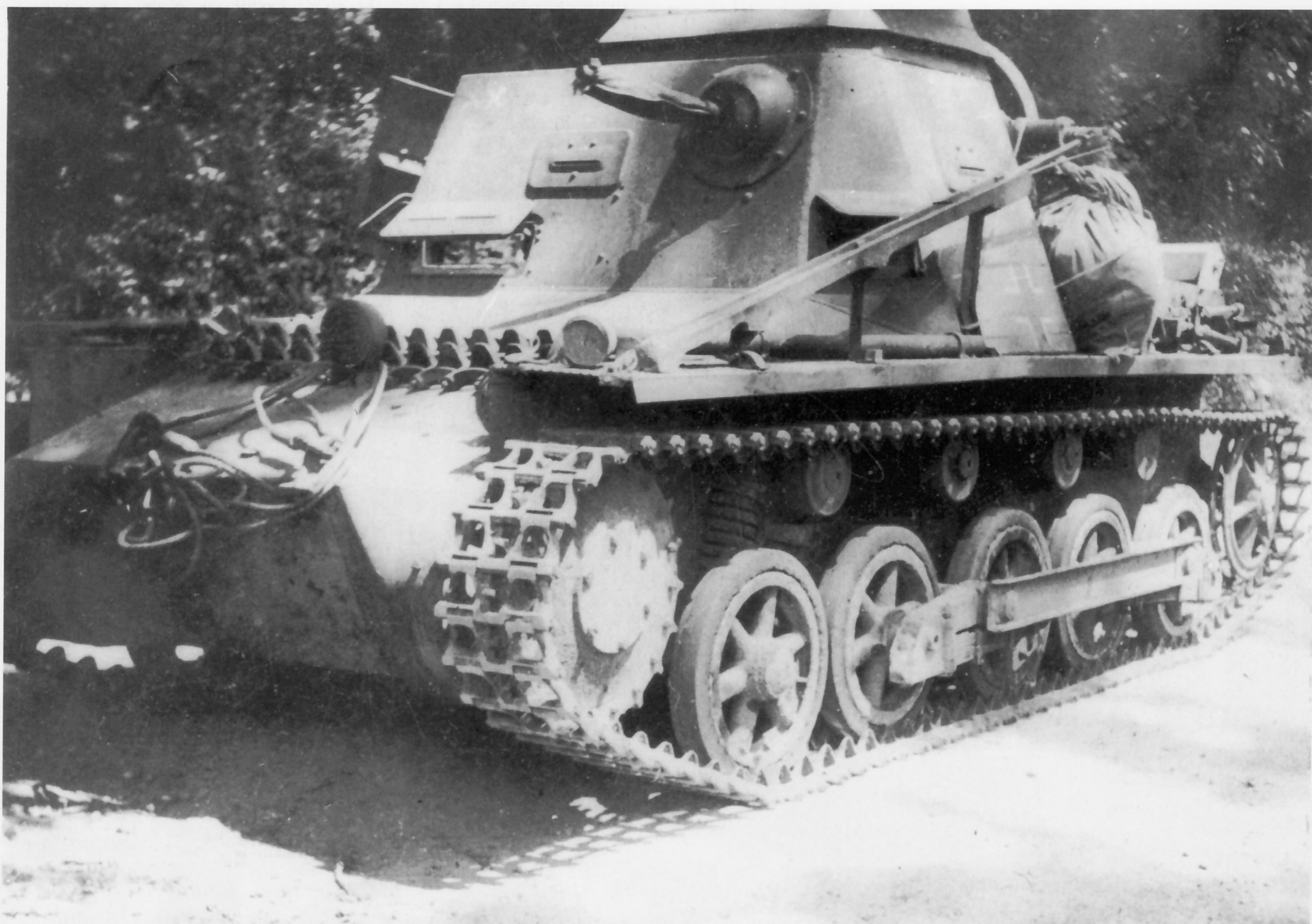
Der kleine Panzerbefehlswagen (Sd.Kfz.265) hatte ein Gesamtgewicht von 5,88 t. Drei Mann Besatzung fanden im Fahrzeug Platz (Kommandant, Funker, Fahrer). Zur Ausrüstung gehörten bei Verwendung als Kompanie-Chefpanzer ein 20-Watt-Sender c und zwei UKW-Empfänger. Die beiden Empfänger wurden etwa ab 1939 gegen den UKW-Empfänger e ausgetauscht. Charakteristisch war die 2 m lange Stabantenne mit dazugehöriger Antennenschutzrinne (in Fahrtrichtung rechts). Vereinzelt waren andere Antennenformen anzutreffen.
