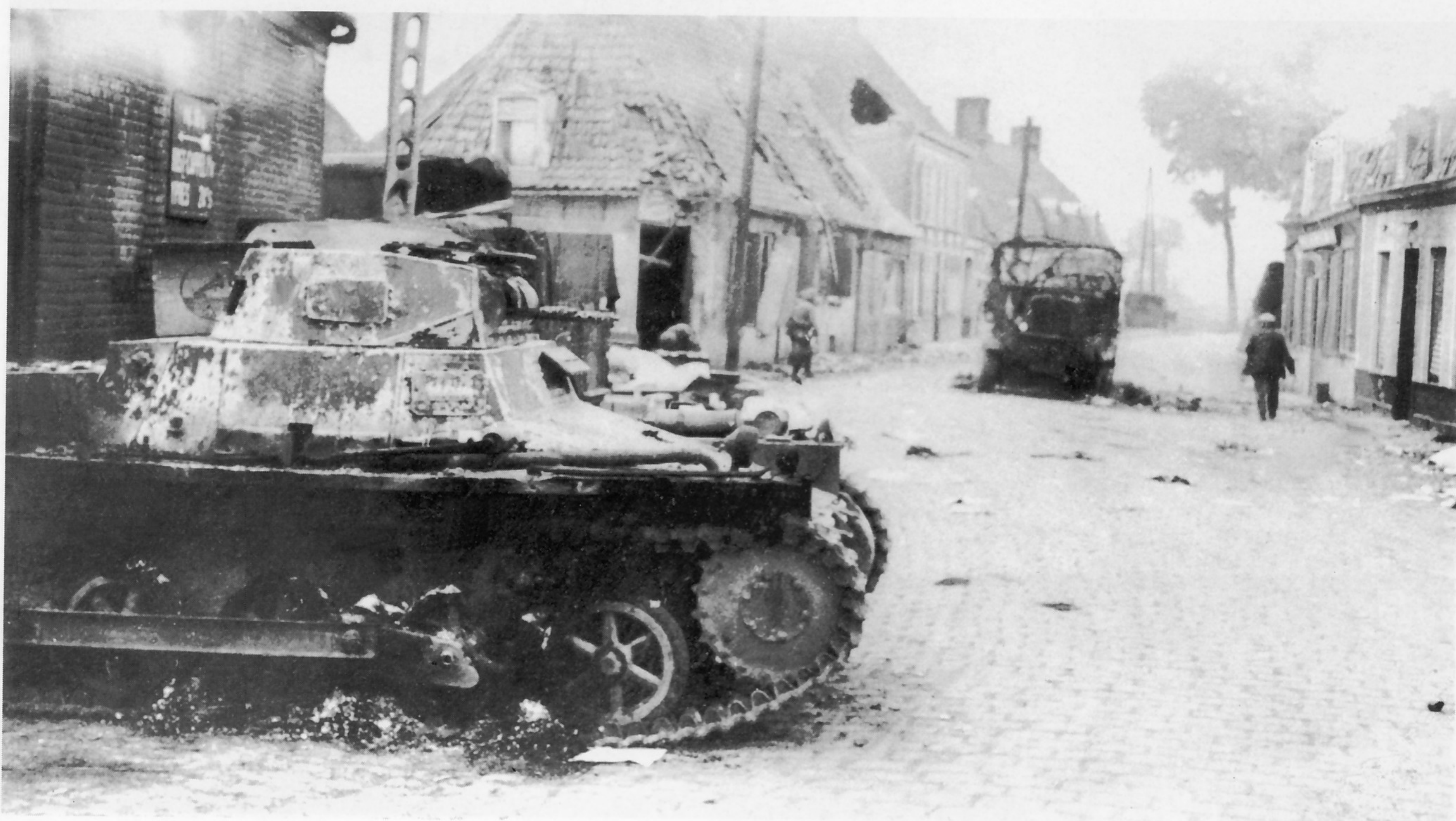
Dieser völlig ausgebrannte Panzerkampfwagen I (MG) (Sd.Kfz.101) muß zu den Totalverlusten an Panzerfahrzeugen im Frankreichfeldzug gezählt werden. Die hochvergüteten Panzerbleche waren ausgeglüht und hatten ihre so Schutzwirkung weitestgehend eingebüßt. Aufnahme vom Juni 1940.
