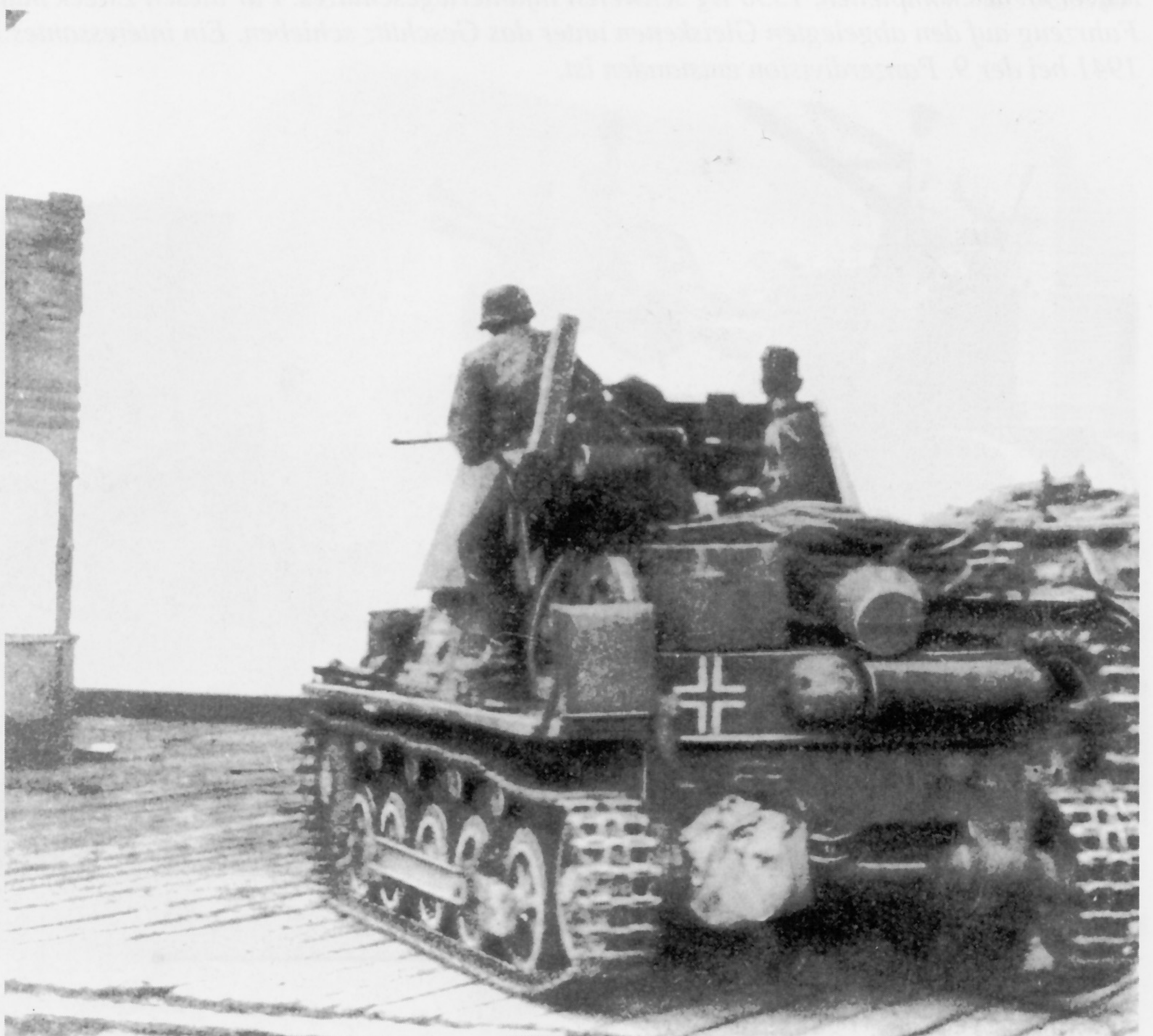
Das zulässige Gesamtgewicht des Panzerjäger I ist mit 6,4 t angegeben, die maximale Geschwindigkeit mit 42 Km/h. Bei einer Gesamthöhe von 2,26 m ergab sich eine Feuerhöhe von 1,72 m. Auch diese Aufnahme ist 1940 in Frankreich gemacht worden, als die Fahrzeuge einer Panzerjägerabteilung eine Kolonne französischer Kriegsgefangener überholen.
