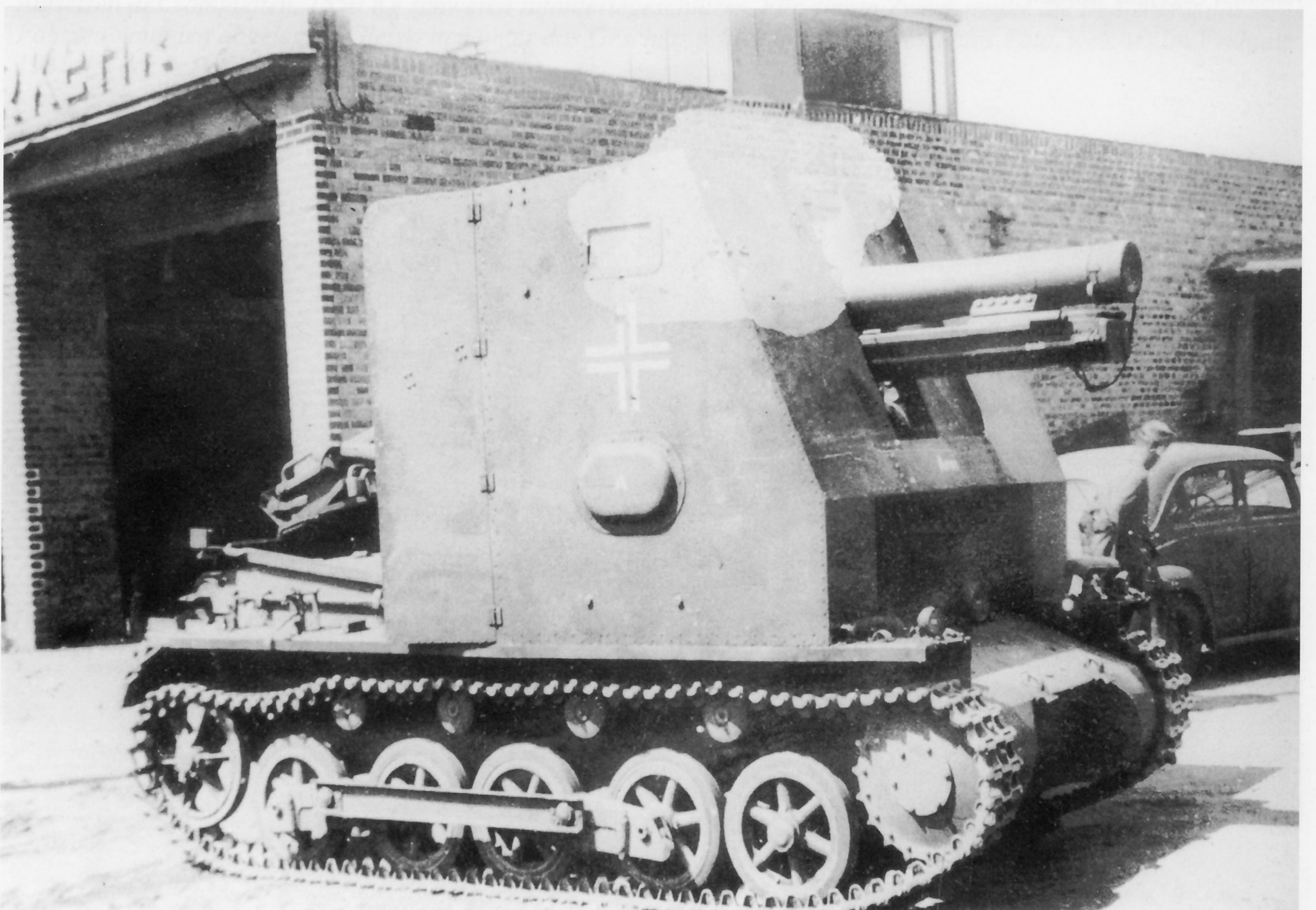
Beim Schützenregiment 1 der 1. Panzerdivision befand sich im Frankreich- und im Rußlandfeldzug die schwere Infanteriegeschützkompanie 702 mit sechs 15-cm-schweren Infanteriegeschützen 33 auf Panzerkampfwagen I B-Fahrgestell. Diese klobig und unbeholfen wirkende Fahrzeug war das Vorbild der ab 1943 hergestellten 15-cm-schweren Infanteriegeschütze 33 (Sf.) auf Panzerkampfwagen 38 (t) (Sd.Kfz.138/1).
