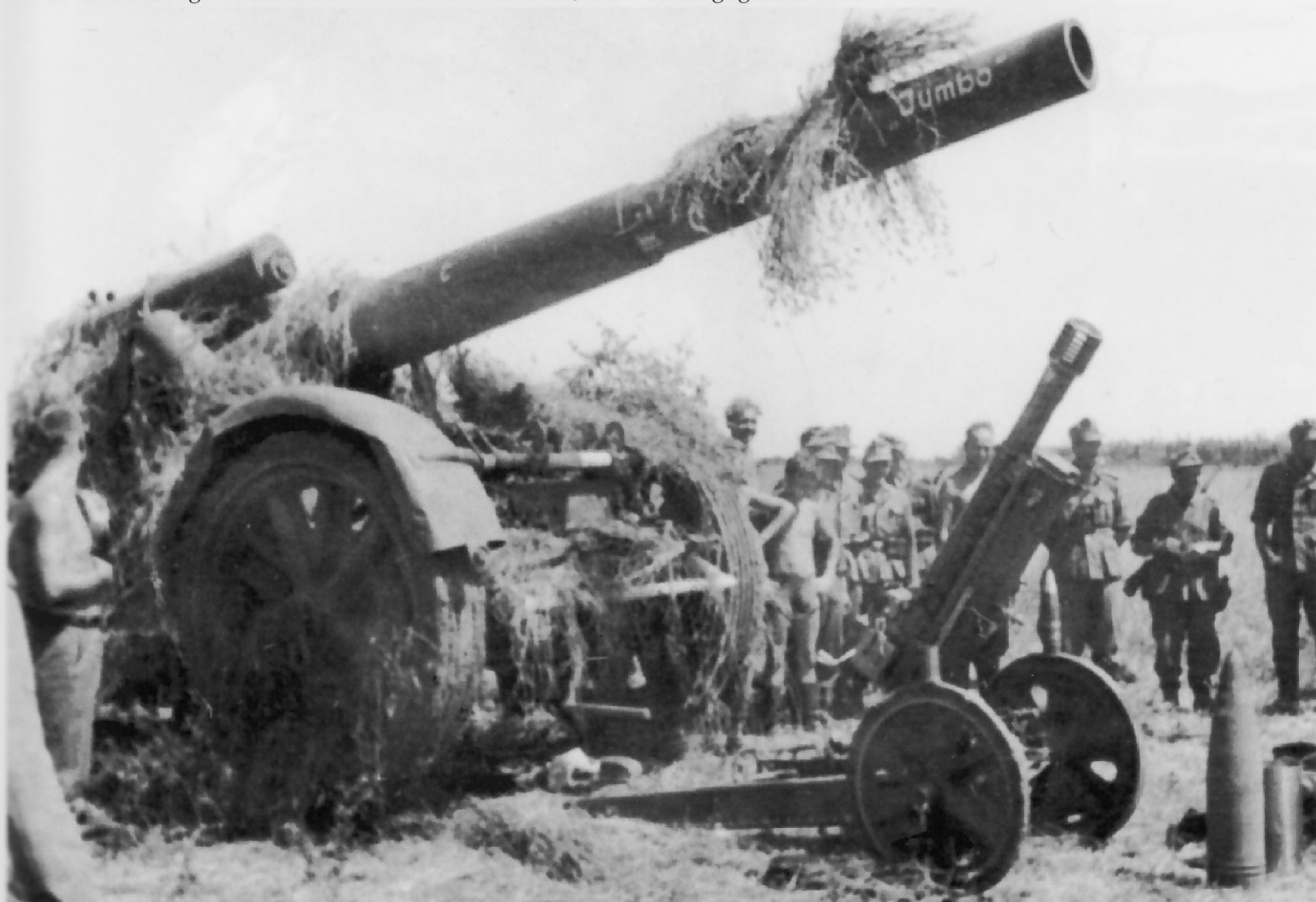
Riese und Zwerg - 21cm Mörser neben einem 7,5 cm Gebirgsgeschütz 36
