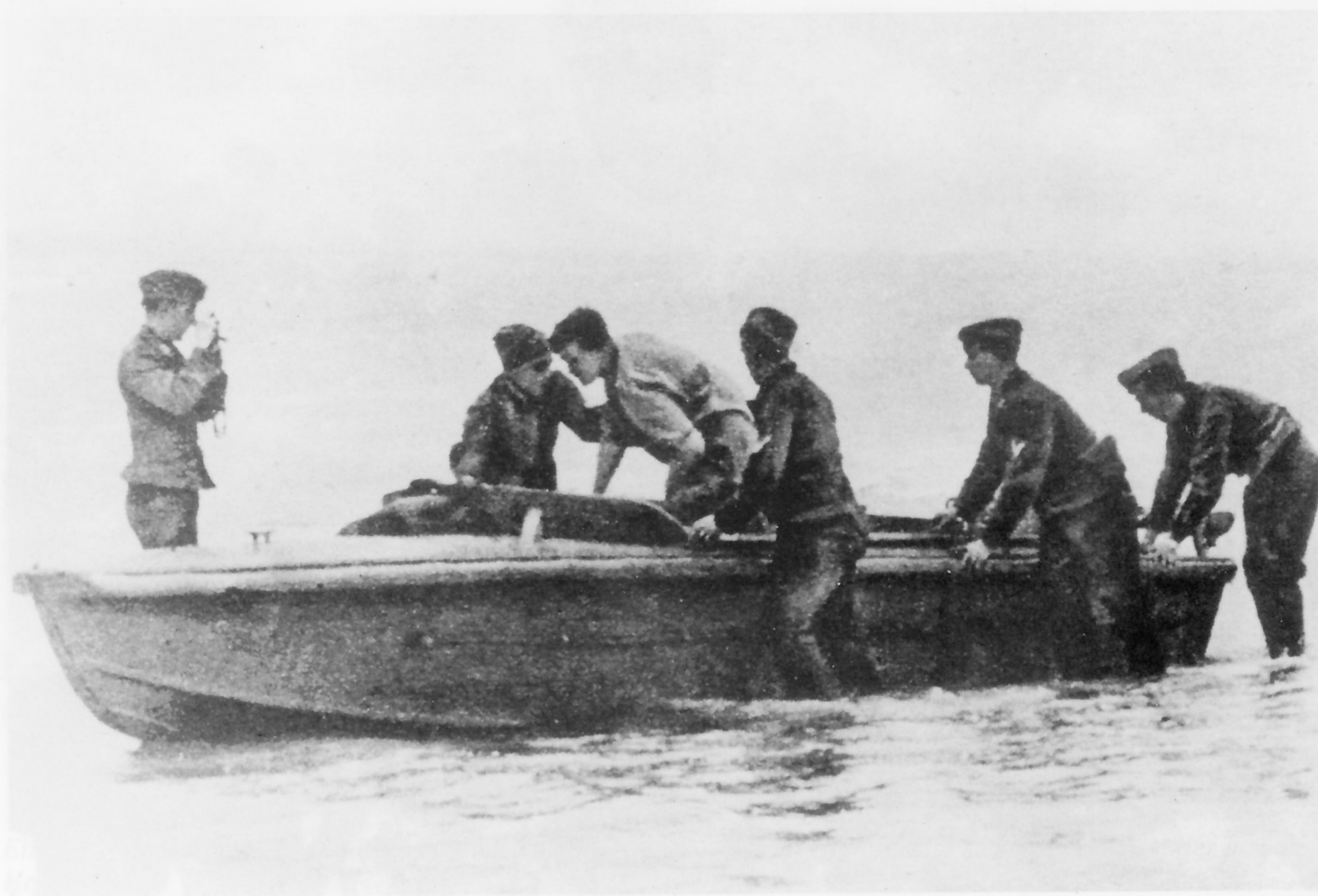
Hier handelt es sich um Angehörige der Luftwaffe (Div. Hermann Göring?) bei der Ausbildung an einem seetüchtigen Sturmboot. Gut erkennbar die Verstärkungen beiderseits des Kiels.
