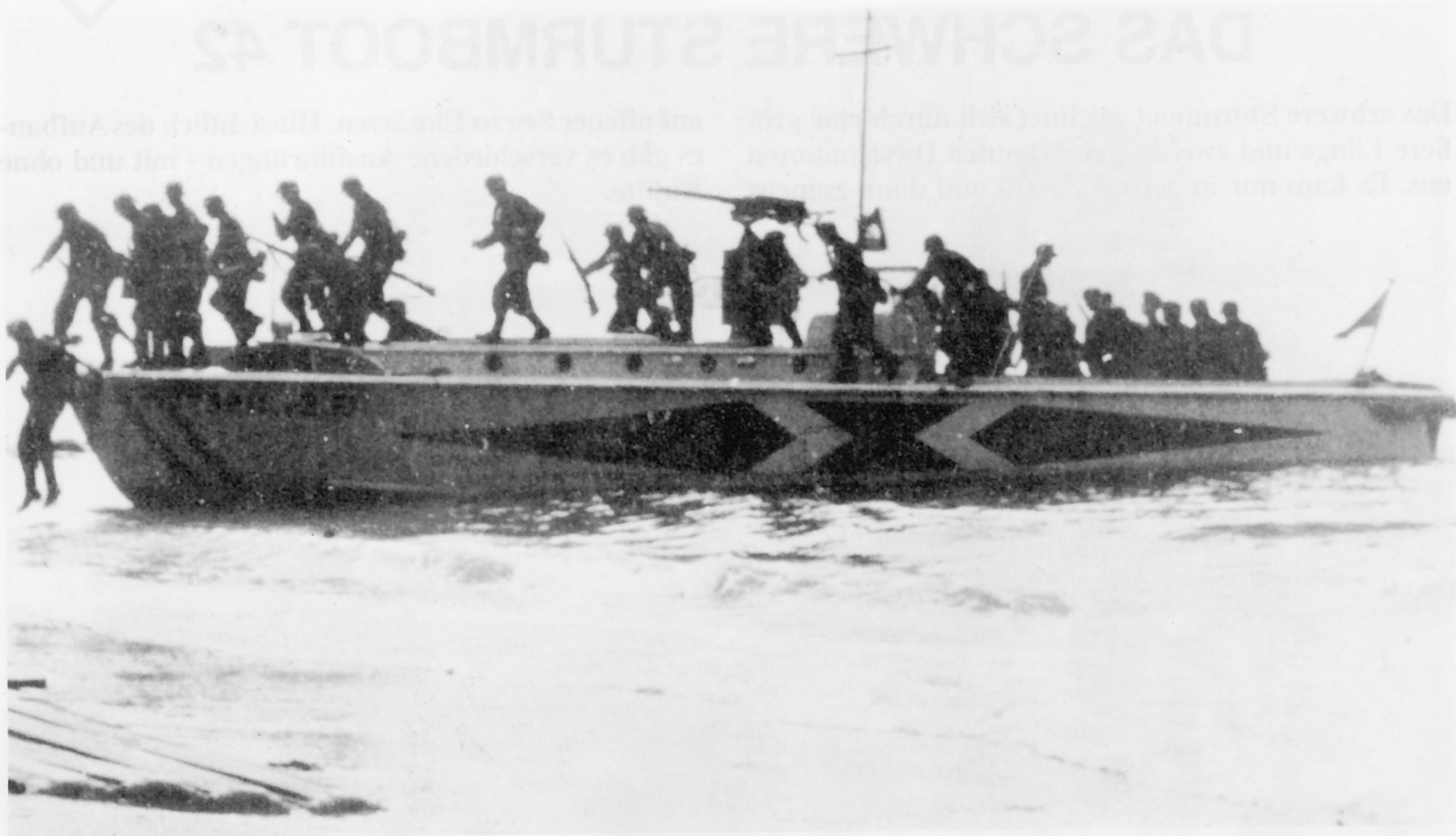
Anlandung eines Schweren Sturmbootes 42. Es hatte eine Länge von 14,50 m, war 3 m breit und zeigte einen Tiefgang von 0,65 m. Es wog 9,5 t, hatte zwei Dieselmotoren mit je 250 PS und konnte 40 Soldaten transportieren.
