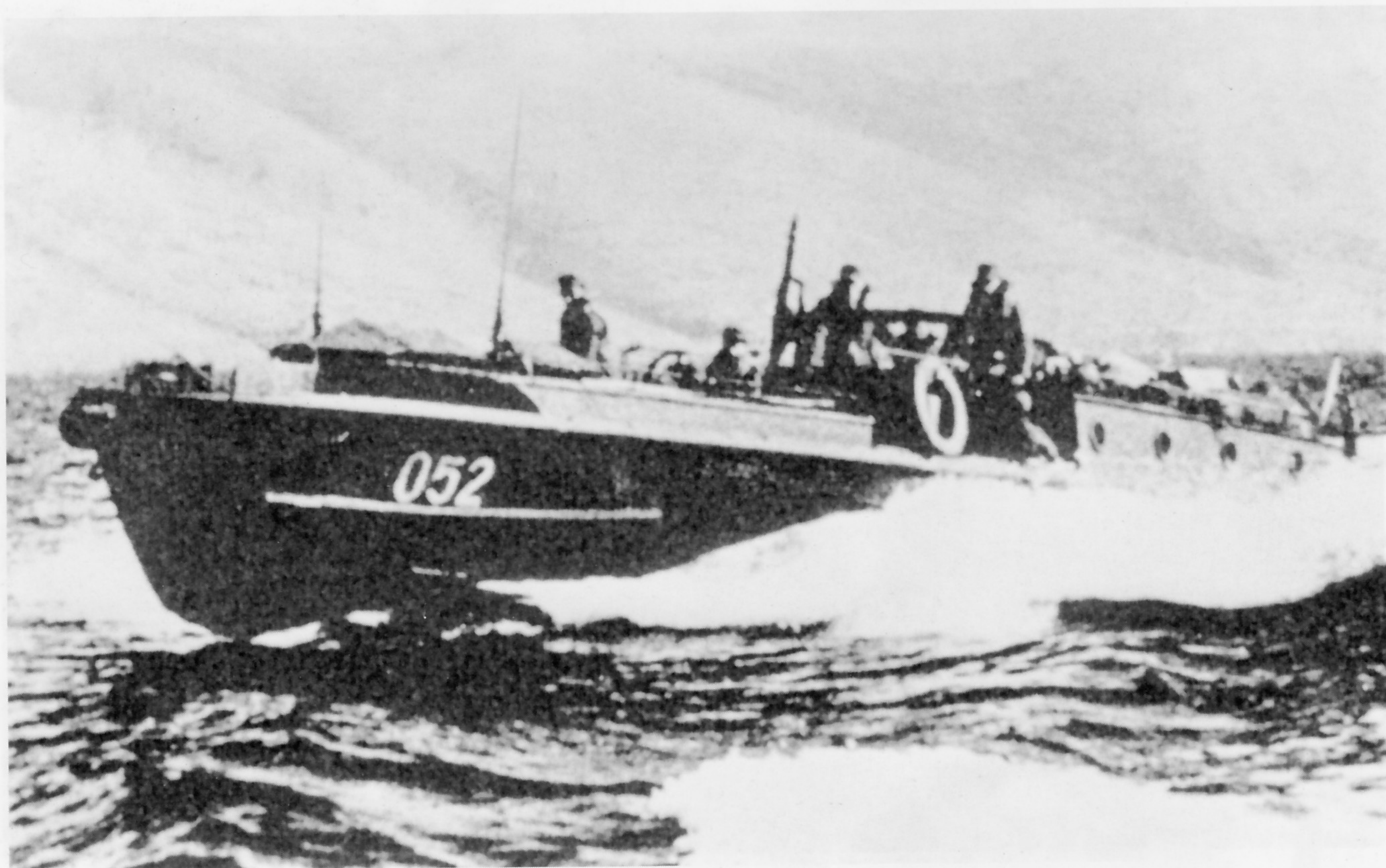
Ein Schweres Sturmboot mit Kajütenaufbau. Es diente vorrangig als Führungsboot (s. Antennen) bei Landungsunternehmen.
