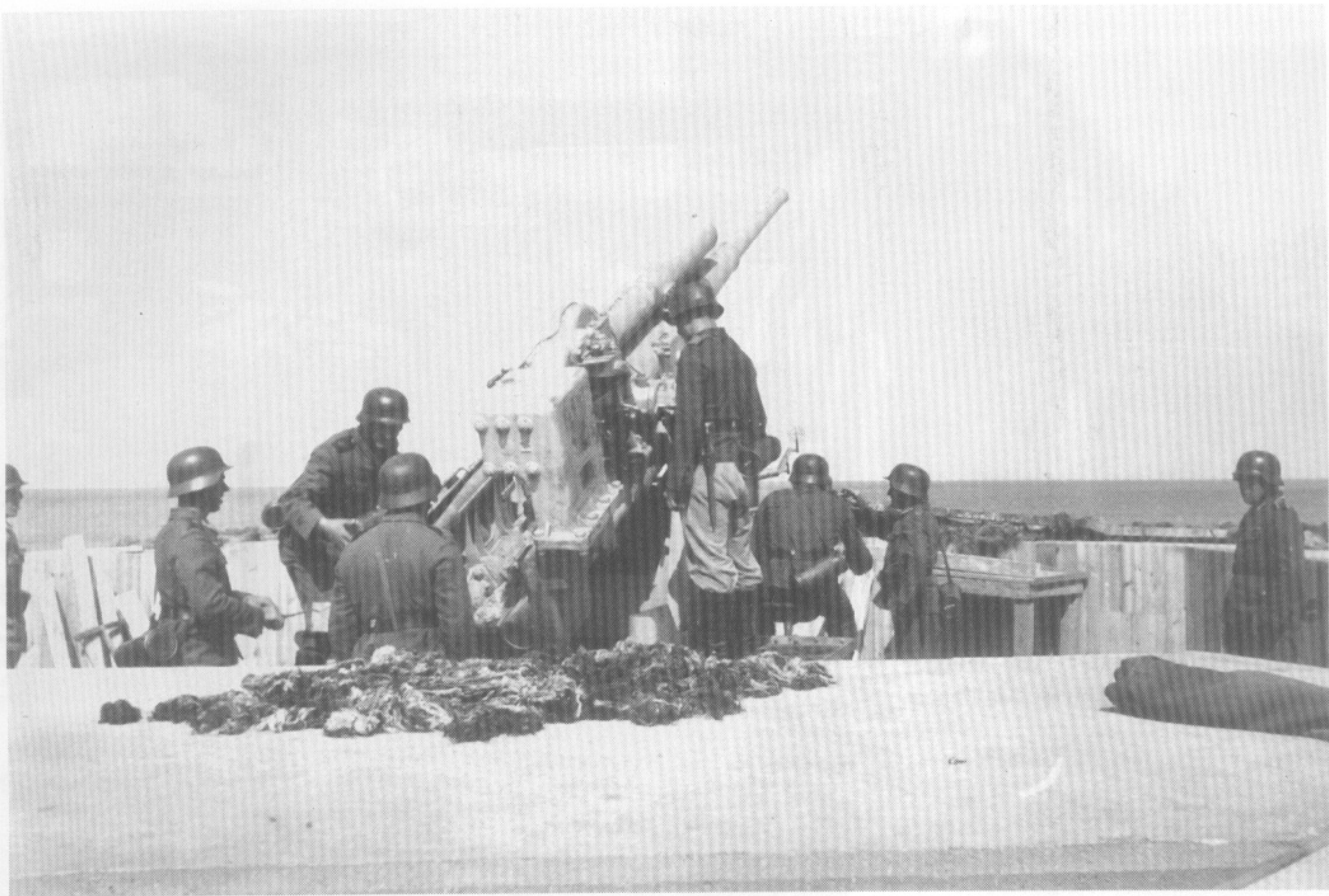
Alarm in der Batt. Creche II. An der rechten Geschützseite visiert der Richtkanonier das Ziel mit dem Drahtvisier an. Dieses wurde von den Marineartilleristen selbst angefertigt, nachdem die Engländer vor dem Rückzug alle Zieleinrichtungen an den 9,4 cm Vickers Geschützen zerstört hatten. (BA)
