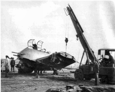
Bergung der bruch- gelandeten Me 210 SO+MU, W-Nr 281, offensichtlich durch RAF- Personal. Wie bei Bergungen üblich, wurde zunächst die Bewaffnung ausgebaut. Die nach vorn herausgezogen- en Schutz- rohre der beiden MG 151 sind deutlich sichtbar. So konnten die Waffen von unten entfernt werden. (Radlinger)
