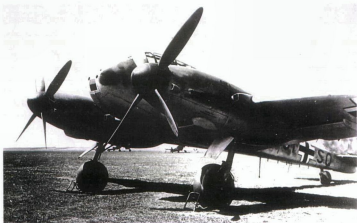
Links: Hier ist besonders deutlich die anfangs noch eckige Lader-Ansaughutze zu sehen. (Mohr)
