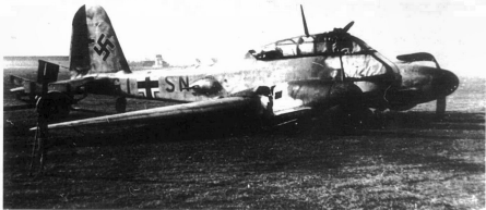
Bauchlandung der Me 210 V-10 wegen Fahrwerkschaden nach einem Testflug am 16. 6. 1941. (Mohr)
