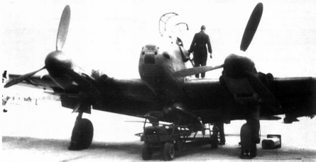
Me 210 DI+NF W.-Nr. 194, im Juni 1942 als Versuchsträger für den von Blohm & Voß entwickelten und gebauten Lufttorpedoträger L 10 "Friedensengel". Die E-Stelle Gotenhafen-Hexengrund testete die Kombination L 10/Lufttorpedo LT 950 u. a. auch mit dieser Me 210. (Nowarra)
