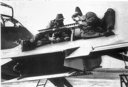
Wartungsarbeiten an der ausgefahrenen Sturzflugbremse der VN+AD. (Radinger)
