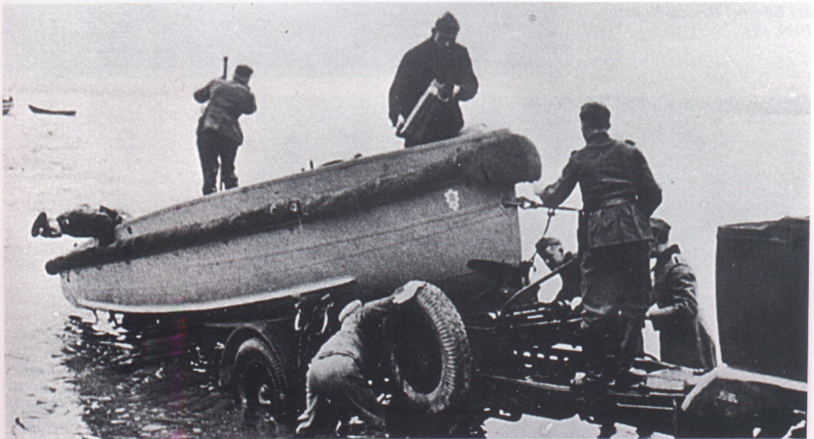
Ein Motorboot wird vom Sd. Ah. 13 abgesetzt. Es hatte einen 100 PS 6 Zylinder Maybach-Motor. Motorboote wurden zum Schleppen und Drücken von Fähren beim Übersetzen und beim Brückenbau eingesetzt. (RF)
