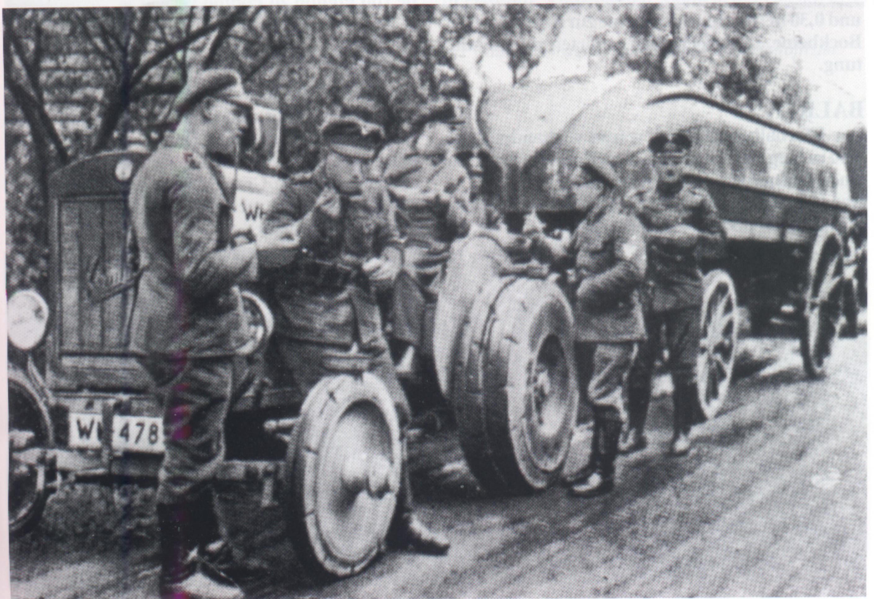
Eine Brückenkolonne während einer Marschpause. Der Pontonwagen für Pferdezug wurde behelfsmäßig motorisiert mit einem Komnik-Schlepper.
