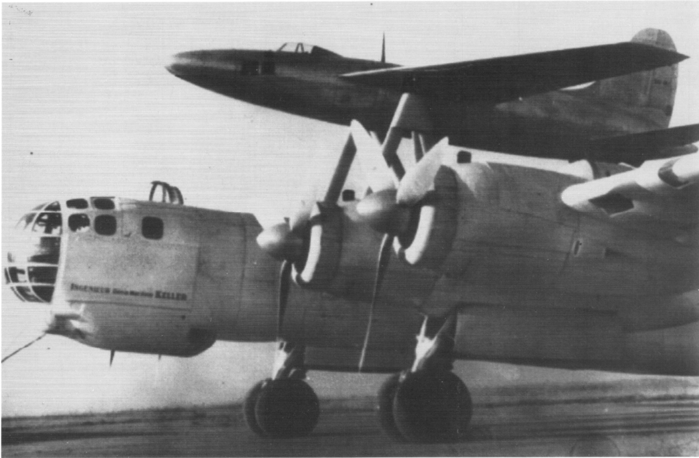
Französischer Versuchsträger AAS-1 (ursprünglich He 274) mit aufgesetzter SO-M1 (1946).
