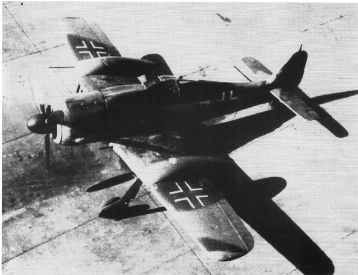
Oben: Eine Fw 190A-8 mit "Doppelreiter"-Zusatztanks von je 300 l Inhalt auf den Tragflächen, wie sie auf der geplanten "Führungsmistel" (rechts) eingesetzt werden sollten.
