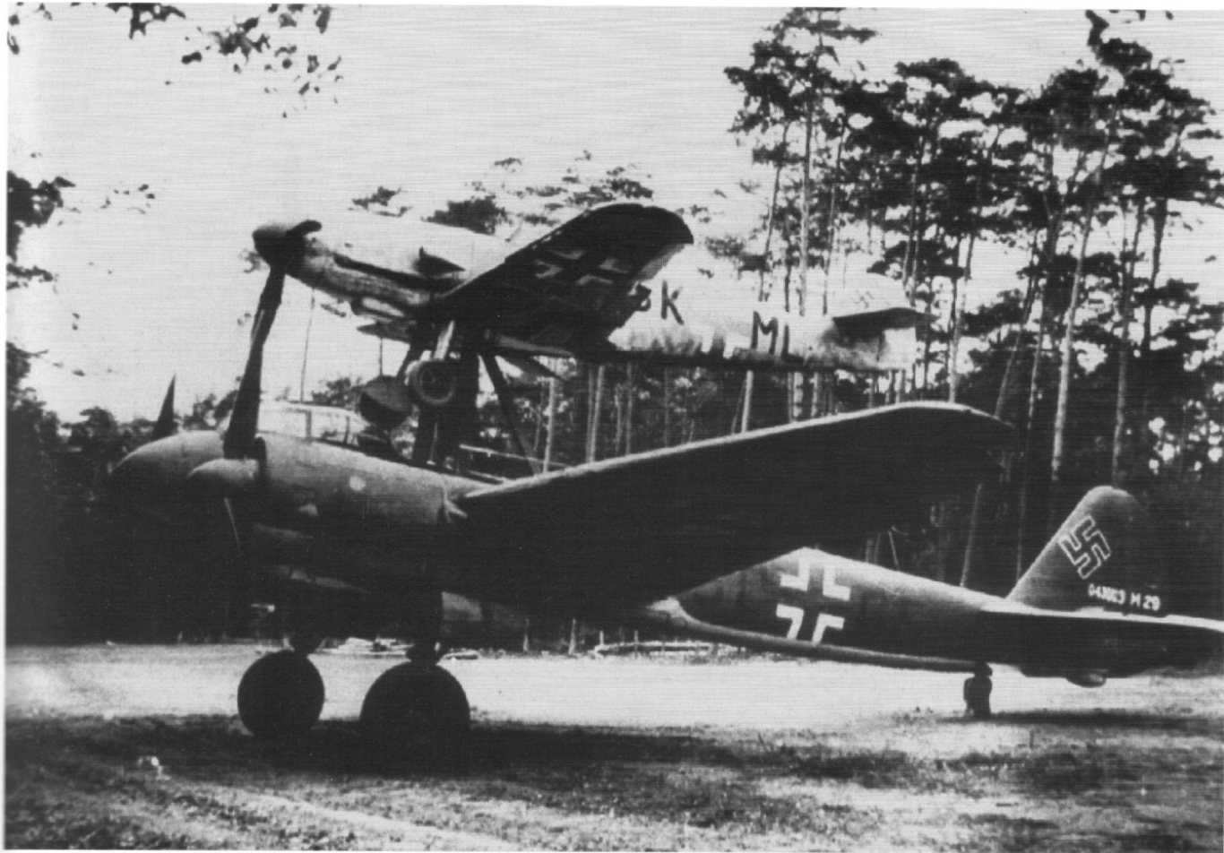
Diese Ju 88 A-4 einer Mistel 1 bekam bis zum vorgesehenen Umbau zur Einsatzversion eine provisorische Bugnase.
