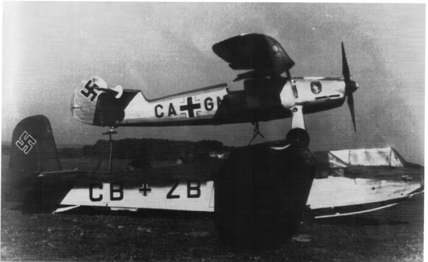
Oben: Fw 56 "Stößer" als Führungsmaschine — deutlich zu sehen: die Seilpyramide und die Radstützen auf der DFS 230. Unten: Das startbereite Gespann.
