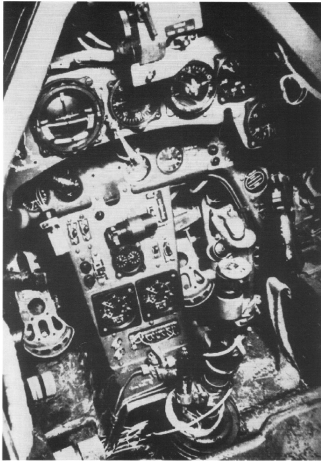
Im Cockpit der Fw 190 wurde es eng, da alle wichtigen Funktionen der Ju 88 mit übernommen werden mußten.
