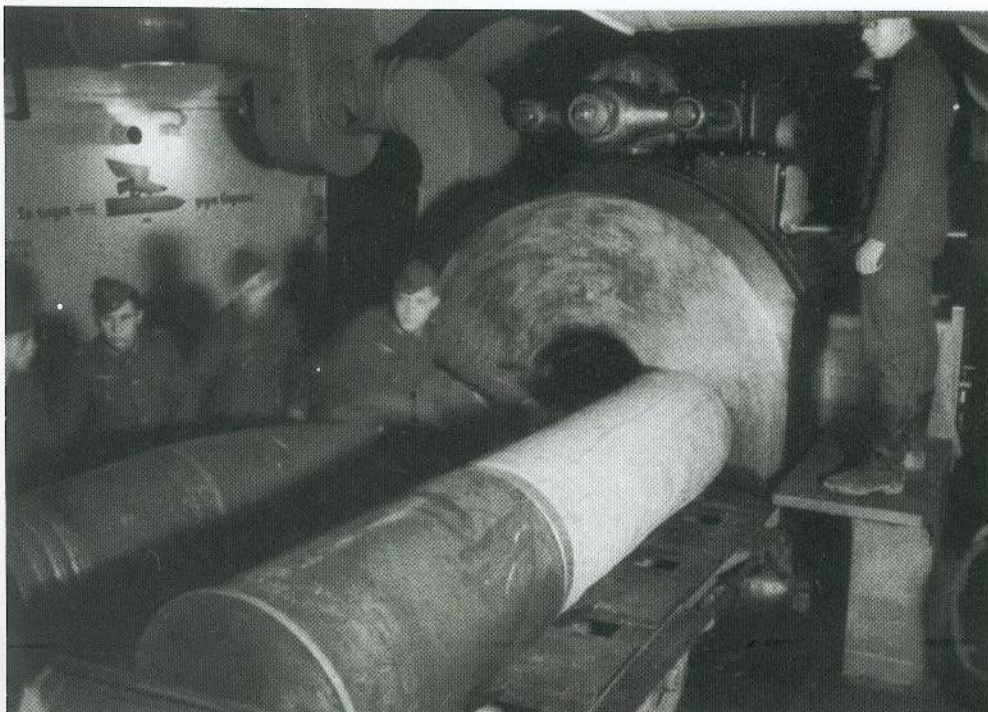
Links: Ladevorgang im Turm Cäsar. Auf dem Lade- wagen liegen Geschöß, Vorkartusche und Hauptkartusche. Die La- dekanoniere rollen gera- de das Geschöß vor das Ladeloch, welches dann vom elektrischen An- setzer in das Rohr ge- schoben wird. Hinter den Artilleristen ist die Schußtafel zu erkennen. Auf der rechten Seite steht der K 1 auf einem Podest, bereit, den Ver- schluß zu schließen. (BA)
