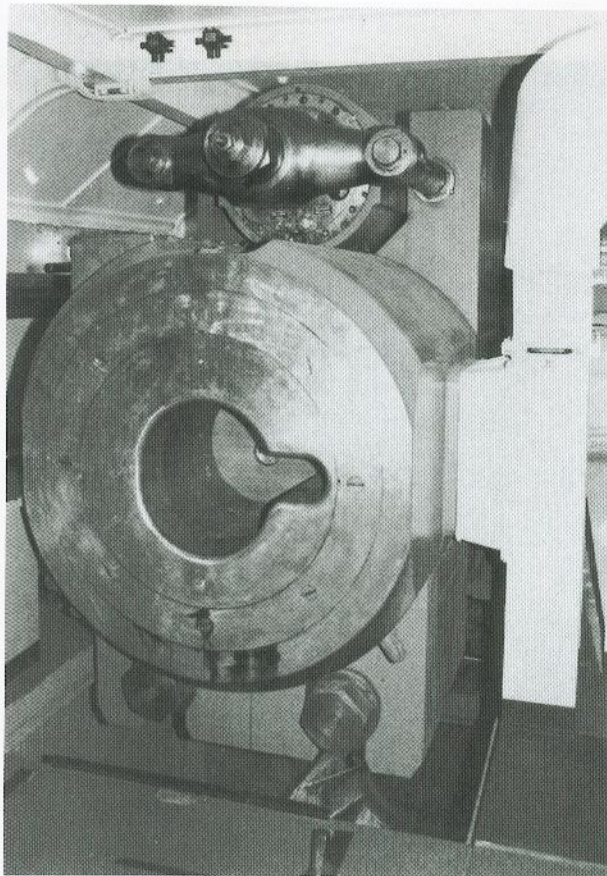
Das Bodestück der 38 cm SK C/34. Darüber ist der Luftvorholer zu sehen. Auf der rechten Seite des Bodestücks ist die Absauganlage angebracht, die Pulverdämpfe direkt ins Freie lenkte.
