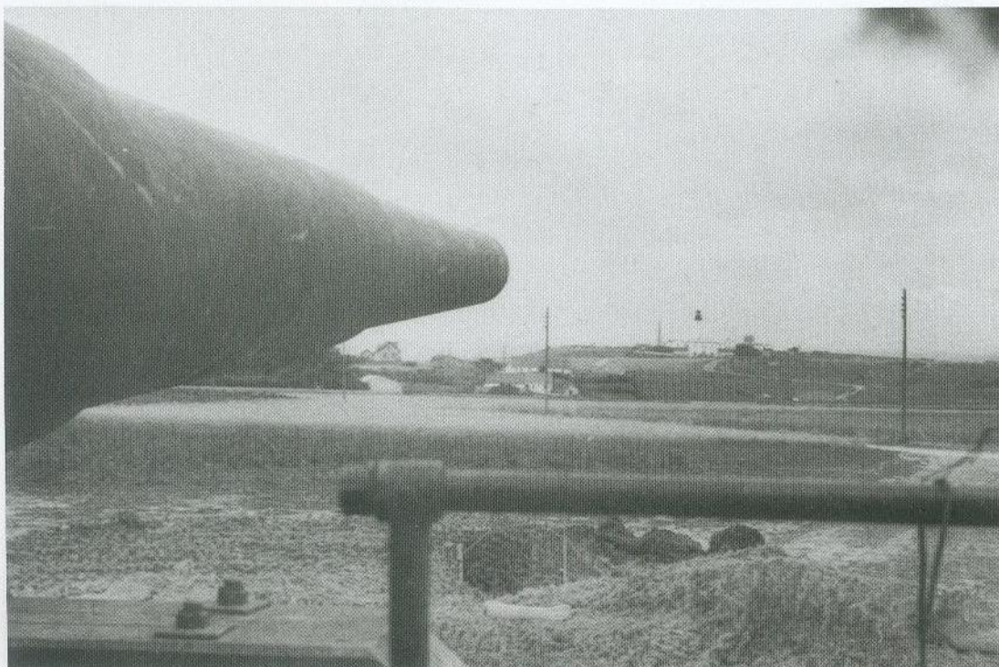
Das 15 m lange Rohr der 30,5 cm SK L/50 mit den zwei aufgeschröpften Ringnänkeln. Im Hintergrund ist der Leuchtturm vom Wimereux zu sehen. (BA)
