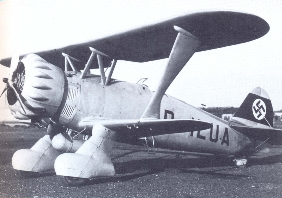
Links: Die Hs 123 V2, Kennung D-ILUA, hatte wie die V3 und V4, bereits die endgültige NACA Hauptform.
