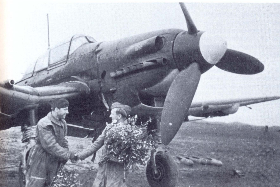
Links: Der Einbau eines Jumo 211 J mit 1.300 PS Lei- stung, der flachere Kühler und eine neu konstruierte Kabinen- haube gaben dem Standardsturzkampf- flugzeug der Luftwaffe ein neues Aussehen. Die Geschwindigkeit konnte nochmals ge- ringfügig, die Abwurfpla- ten auf 1.600 kg er- höht werden. Als Ab- wehrbewaffnung erhielt die D-Serie ein MG 81Z. Diese späte Ausfüh- rung der Ju 87 D-3 be- saß außerdem eine zu- sätzliche Panzerung.
