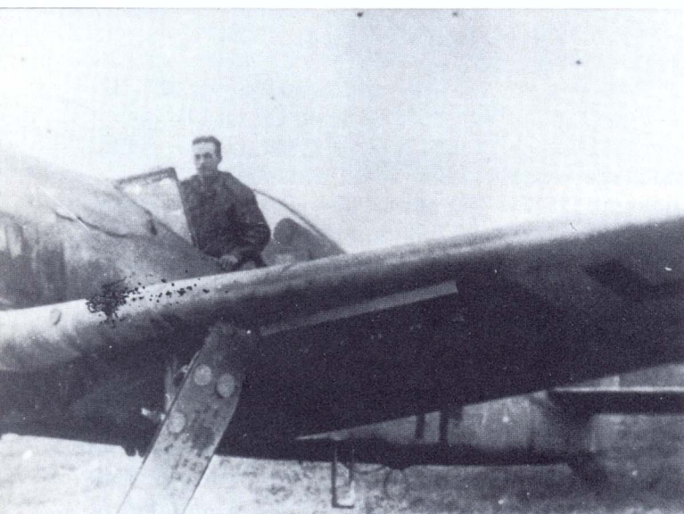
Oben: Diese Fw 190 F-8 ist mit Abschußrosten für Raketenbewaffnung zur Panzerbekämpfung ausgerüstet.
