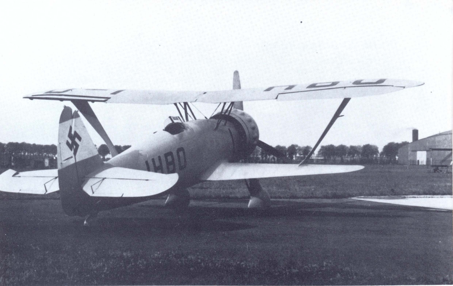
Oben: Die Henschel Hs 123 stellte das erste für die Luftwaffe gebaute Sturzkampfflugzeug dar. Während die A-Serie mit Junkers Ju-Pak Zweiblatt Metallflugschraube ausgerüstet war, erhielten einige der frühen V-Muster eine verstellbare VDM Dreiblattflugschraube und einen stärkeren BMW 132 K Motor. Diese Flugzeuge sollten als Mustermaschinen für die B- und C-Serie dienen, welche aber zugunsten der Ju 87 aufgegeben wurde.
