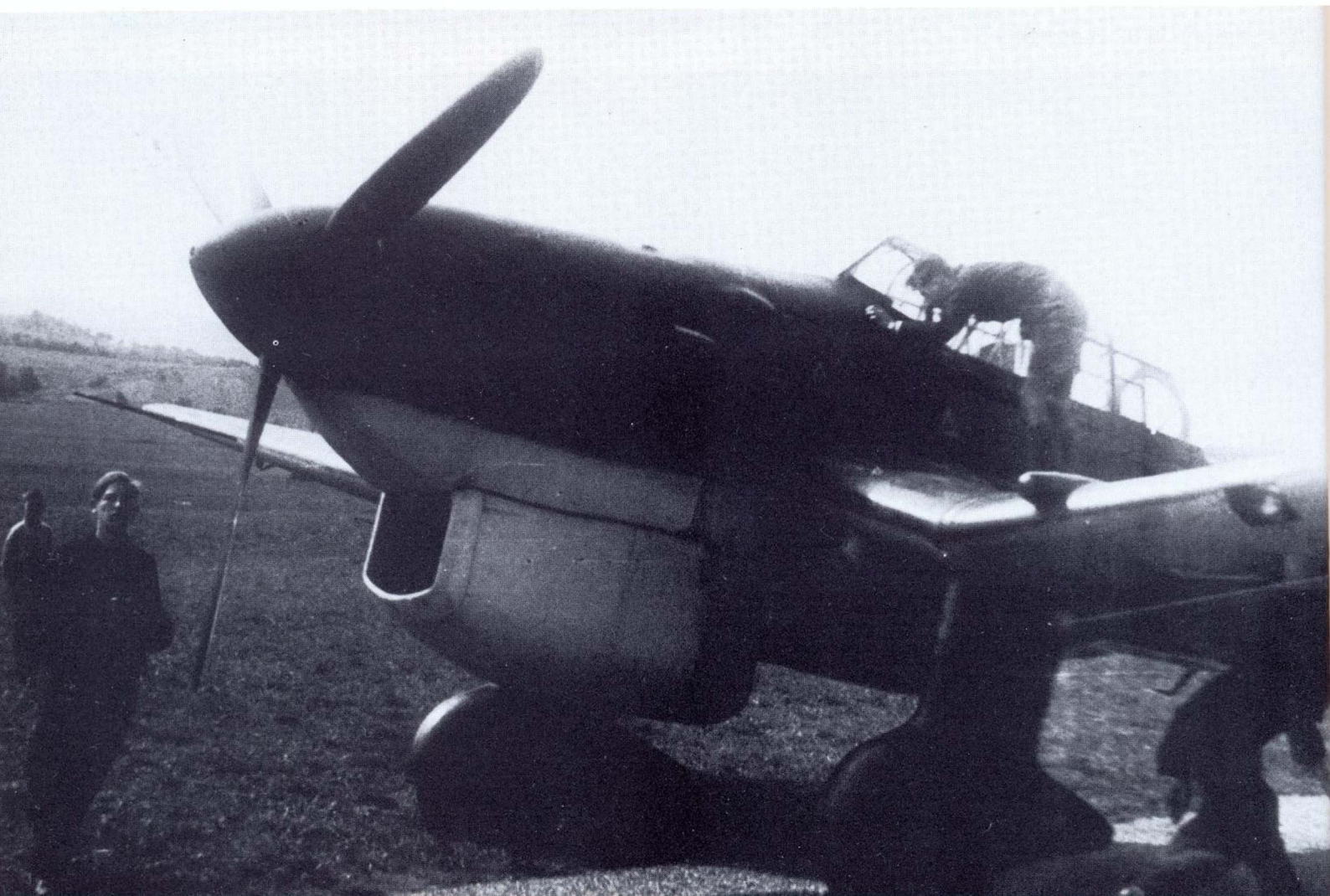
Unten: Diese Ju 87 B diente für Vorstudien zum Einbau des Jumo 213 E. Dazu konstruierte die Firma Bär einen speziellen Kühler, welcher an dieser Maschine erprobt wurde.
