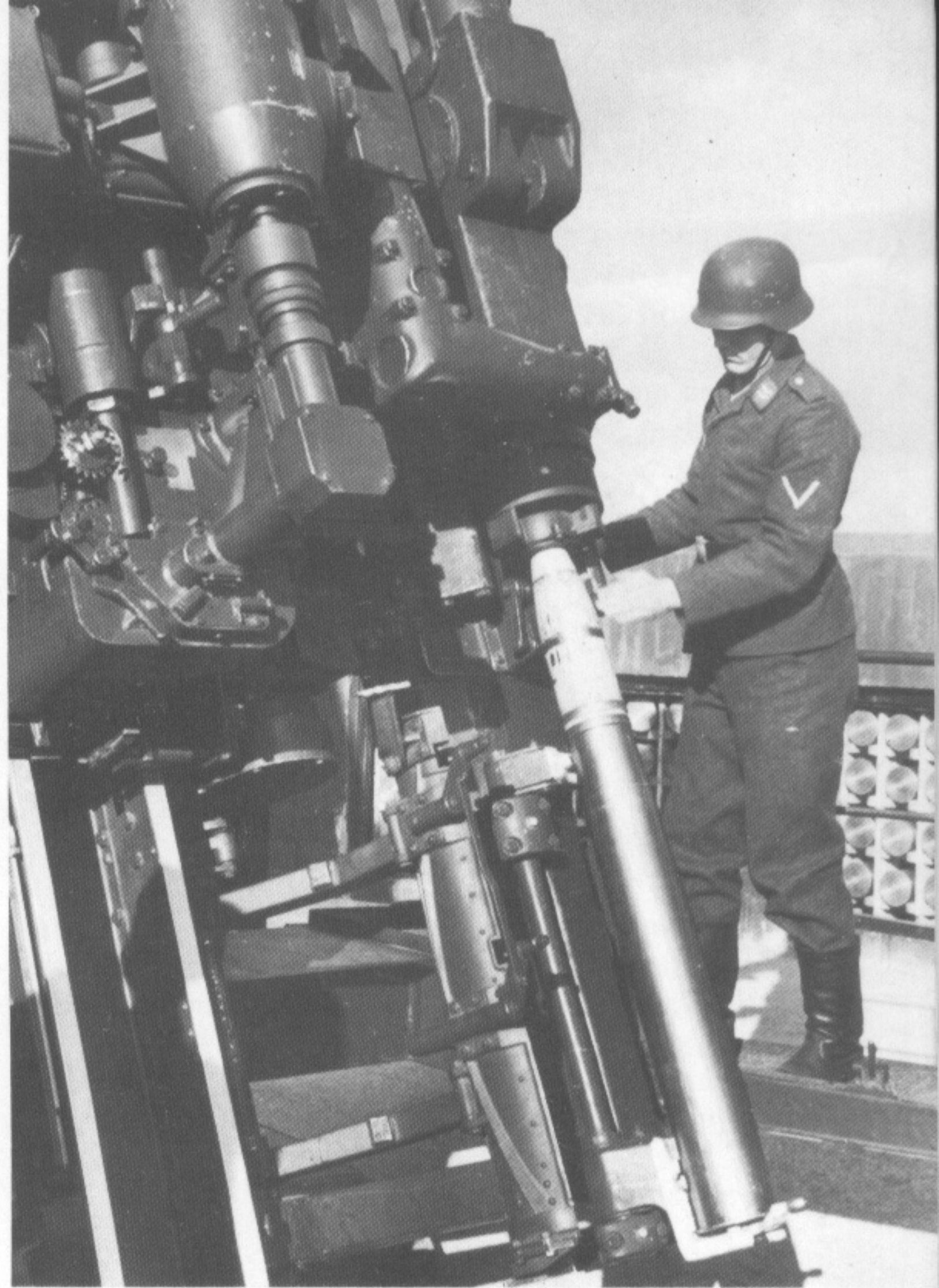
Eine Patrone liegt bei großer Rohrerhöhung in der Stellschale. Bei einer Rohrerhöhung von 50^\circ bis 88^\circ hat hier der K13 die Ladebühne ausgeschwenkt. Ab 65^\circ Rohrerhöhung mußte er die Patrone beim Umliegen von der Stellschale in die Ladeschale andrücken, um ein Herausschleudern zu verhindern.
