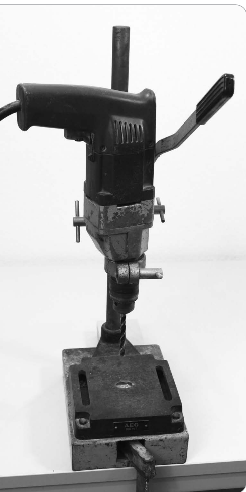
Eine Bohrmaschine samt Bohrmaschinenständer gehört zur Grundausrüstung beim RepStrap-Bau. Als Befestigung am Tisch kann eine Schraubzwinge dienen.
