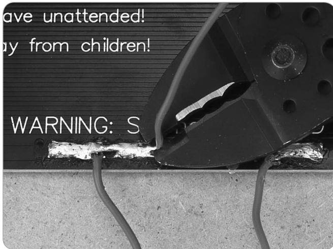
Die Drahtbrücke zwischen den beiden Lötflächen ist zwar kaum sichtbar, jedoch wichtig für die Funktion des Heizbetts. Das isolierte Stück Kabel, das beim Löten als Griff gedient hat, können danach einfach entfernen.
