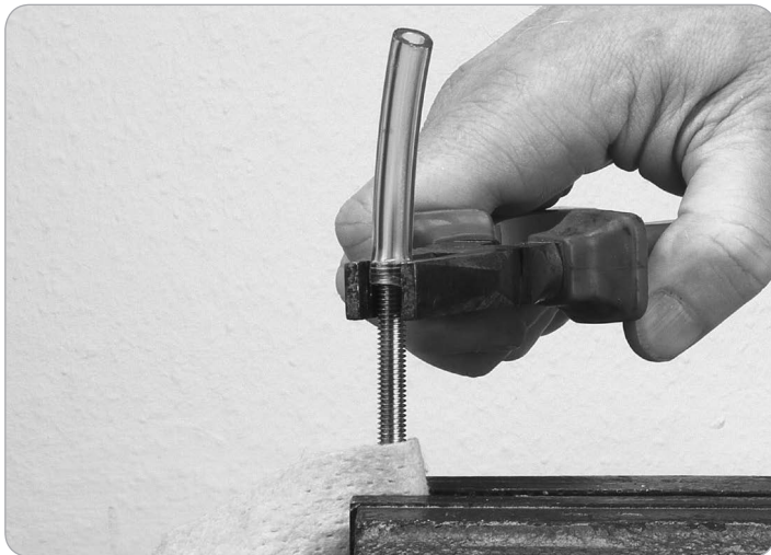
Eine provisorische Motorkupplung entsteht.
