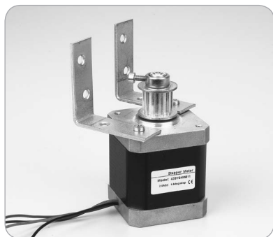
Zwei Stuhlwinkel dienen als preisgünstige Motorhalter.
