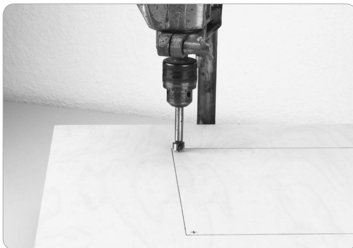
Optisch ansprechende Innenecken am Portal gelingen Ihnen mit dem Forstnerbohrer.
