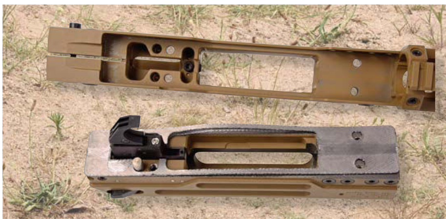
Saubere Systembettung im Leichtmetallchassis. An der Systemunterseite befindet sich eine vibrationsmindernde Platte.
