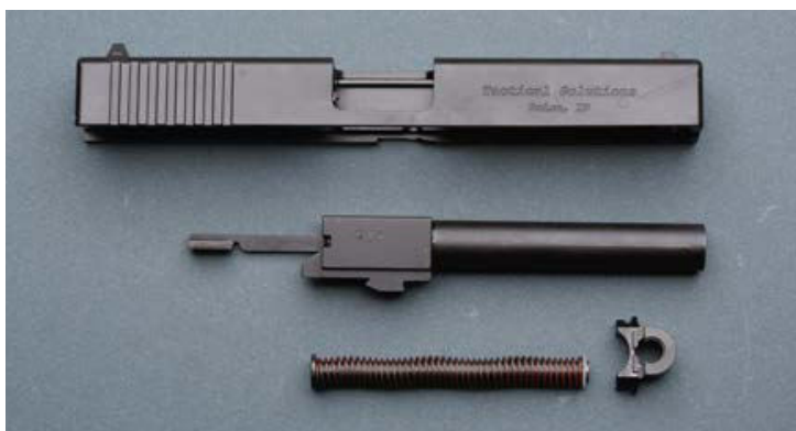
Ein Blick in einen originalen Verschluss einer G17 und des TSG-22 sowie zur feldmäßigen Reinigung zerlegte Baugruppen.
