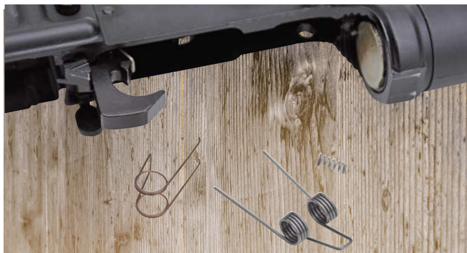
Zur Überarbeitung des Abzuges wurden lediglich die Abzugs-, Schlagstück- und Unterbrecherfeder gegen solche von JP Enterprises ausgetauscht und schon sank der Abzugswiderstand auf sportlich annehmbare 2.186 Gramm.
