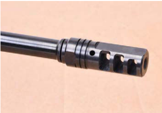
Drei-Kammer-Kompensator und Top-Streukreis mit Lapua 69 Grains Scenar-Fabrikmunition.
