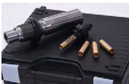
Deutsche Spezialisten unterstützen uns mit Werkzeugen und Komponenten, um das Kaliber .408 CT wiederladen zu können. Hier Matrice und flexible Setmatrice von Triebel Waffenwerkzeuge sowie CNC-gedrehte .408 CT-Kupfermassivgeschosse von Jaguar.
