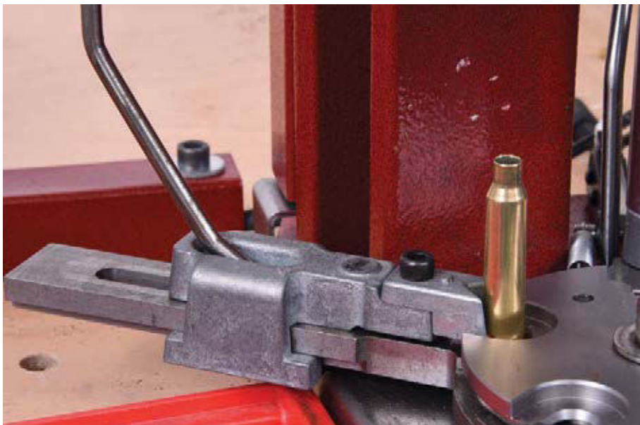
Das Hülsenzufuhrsystem der Hornady Lock-N-Load AP ist gelungen konstruiert und funktioniert in der Praxis tadellos.
