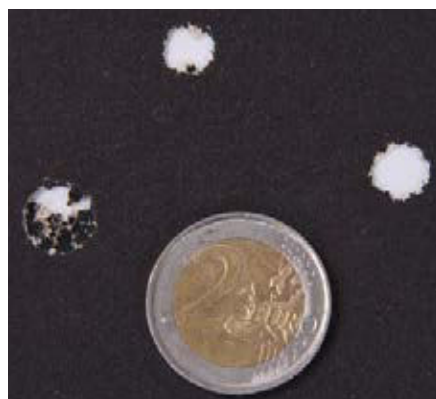
Drei-Schuss-Wiederholgenauigkeitstest bei nach jedem Einzelschuss vollzogener Kaliberkonvertierung (.308-.338-.408). Streukreis-Durchmesser: 45 mm auf 100 Meter.
