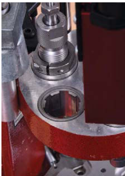
Die Hornady Lock-N-Load AP-Presse besitzt ebenfalls fünf Stationen. Komfortabel ist das Matrizen-Schnellwechselsystem mit Bajonett-Verschluss, passend für alle Matrizen mit 7/8"-14-Standardgewinde
