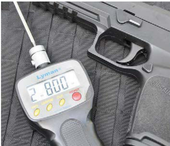
Der Abzug der Schlagbolzenschlosspistole gefiel in der Praxis durch seine Charakteristik mit klar definiertem Vorzug und Druckpunkt sowie kurzem Rückstellweg.
