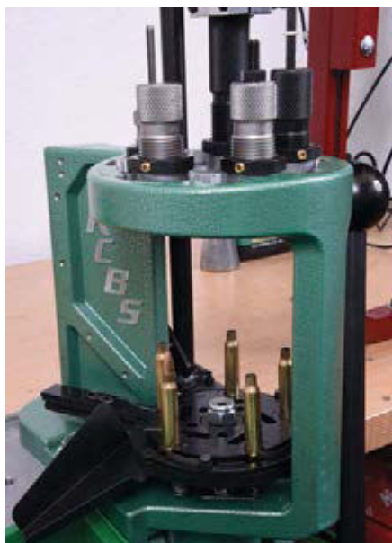
Die O-Rahmen-Presse RCBS Pro Chucker 5 besteht aus einer Leichtmetalllegierung. Sie kann mit einem „Conversion Kit“ auch auf sieben Stationen umgerüstet werden.
