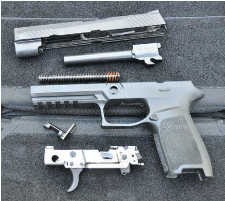
In ihre Hauptbestandteile zerlegte SIG Sauer P320. Typische Merkmale ist das wechselbare Multifunktions-Edelstahlgehäuse sowie der Polymerrahmen in drei Baugrößen.
