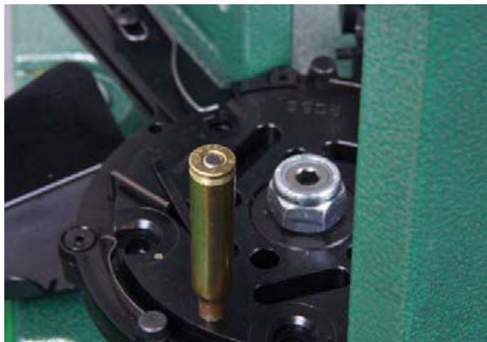
Bei beiden Progressivpressen werden die Zündhütchen perfekt in die Zündglocke im Hülsenboden gesetzt.
