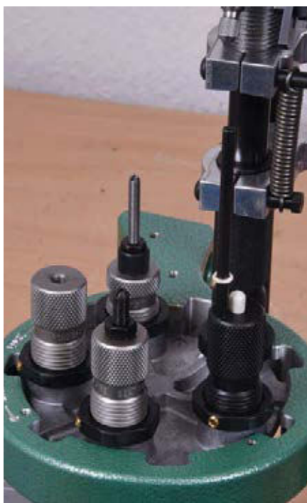
Die Matrizen-Wechselplatte der RCBS Pro Chucker 5 wird angeschraubt. Mit zusätzlichen Wechselkopfplatten mit eingesetzten, voreingestellten Matrizen ist ein Kaliberwechsel ruckzuck erledigt.
