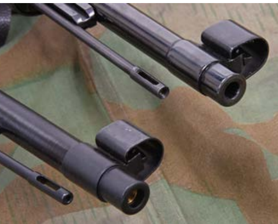
Blick auf die Mündungen mit darüber liegendem Korn mit Schutztunnel: Oben .308er, unten 6 mm BB.
