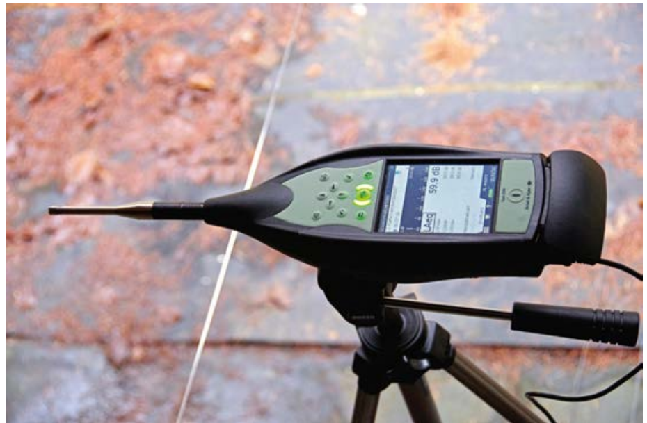
Ein Teil der erprobten Flüstertüten. Insgesamt wurden 37 Schalldämpfer getestet. Mit diesem Klasse-1-Schallpegel-Messgerät Bruel & Kjaer 2250 wurden die Messungen durchgeführt.
