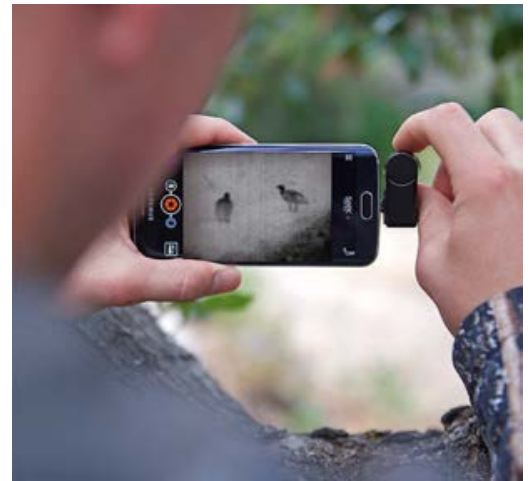
Die kompakte „Seek Thermal“-Wärmebildkamera kann einfach auf das Smartphone aufgesteckt werden.
