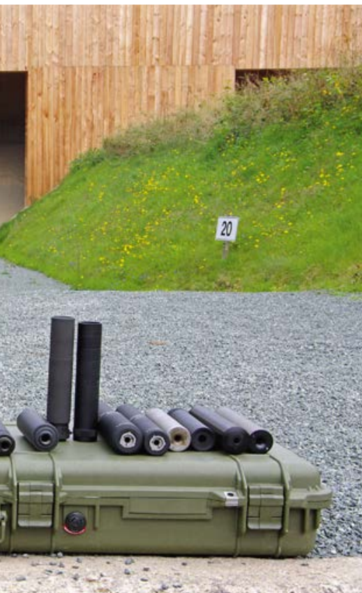
Ein Teil der erprobten Flüstertüten. Insgesamt wurden 37 Schalldämpfer getestet. Mit diesem Klasse-1-Schallpegel-Messgerät Bruel & Kjaer 2250 wurden die Messungen durchgeführt.
