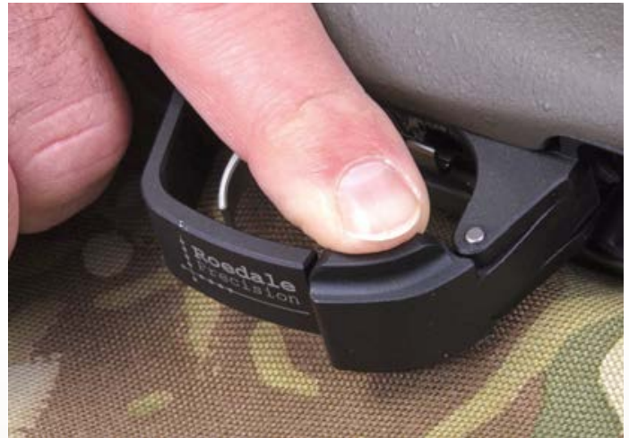
Der große Magazinauslöser lässt sich bestens bedienen. Das Gewehr kann übrigens auch mit AICS-Magazinen gefüttert werden.
