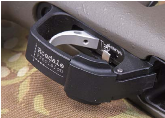
Der große Magazinauslöser lässt sich bestens bedienen. Das Gewehr kann übrigens auch mit AICS-Magazinen gefüttert werden.
