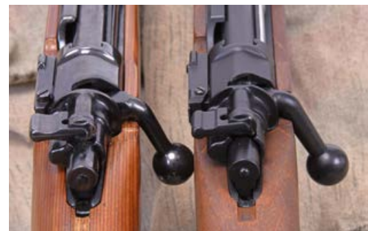
Original und Fälschung: Blick auf die Verschlusskammern mit Schlösschen und Dreistellungs-Sicherung der .308er (links) und der 6 mm BB (rechts).
