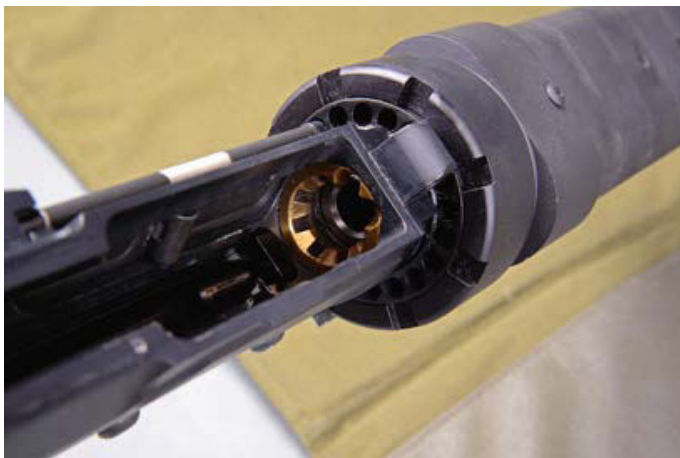
Goldenes Tor: Titannitrid-beschichtete „barrel extension“ aus Edelstahl von Michael Burk.
