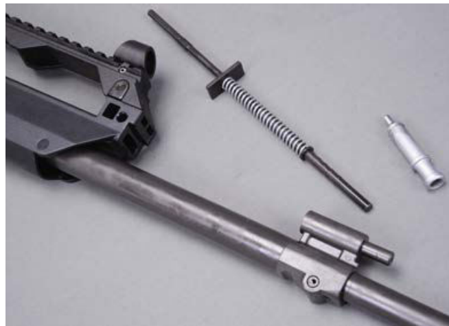
Blick unter den Handschutz: Das indirekte Kurzhub-Gaskolben-System („short stroke system“) im montierten und ausgebauten Zustand.
