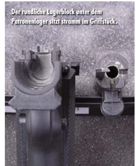
Dreifache Sicherung: Der Lauf wird mittels Schlittenfanghebel, Haltebolzen und Schraube im Rahmen fixiert.
