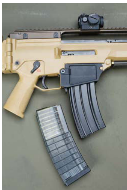
HK 243 TAR mit montiertem AR-Schacht und eingesetztem HRM-Magazin sowie beigelegtem HK 416 A5-Patronencontainer.
