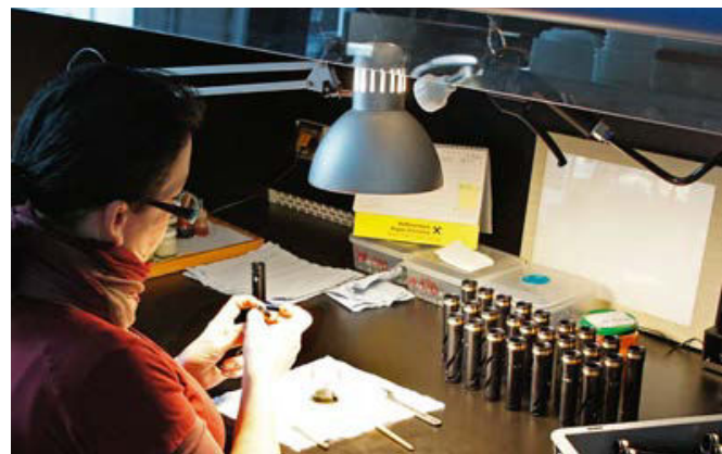
Bilder aus dem jungen, hochmodernen Kahles-Werk: Die Rohrkörper werden aus dem Vollen gefräst. Montage des bewegbaren Umkehrsystems in den Tubus. Man beachte die spiralförmigen Ausfräsungen im Tubus. Wenn man zoomt, werden Linsenteile durch diese Spirale gesteuert. Auch das Justieren ist Präzisionsarbeit.
