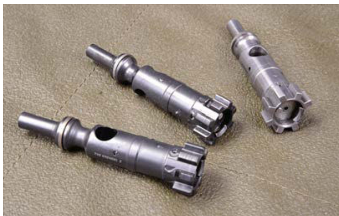
Verschlussträger von Fail Zero mit Nickel-Boron-Beschichtung sowie zwei Alexander-Arms-Verschlussköpfe und ein Verschlusskopf von Michael Burk mit 7,62er-Auszieher.
