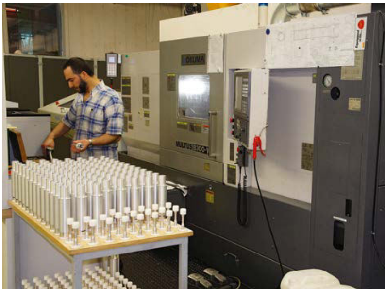
Bilder aus dem jungen, hochmodernen Kahles-Werk: Die Rohrkörper werden aus dem Vollen gefräst. Montage des bewegbaren Umkehrsystems in den Tubus. Man beachte die spiralförmigen Ausfräsungen im Tubus. Wenn man zoomt, werden Linsenteile durch diese Spirale gesteuert. Auch das Justieren ist Präzisionsarbeit.
