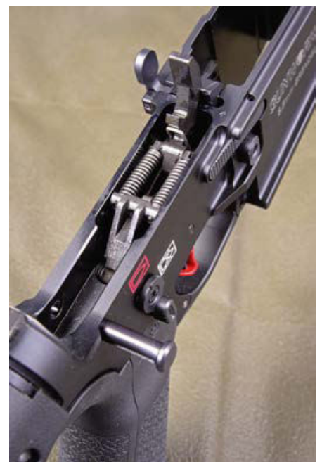
Die beiden Schraubenfedern auf der Oberseite der Hipertouch 24C-Abzugsgruppe lassen erkennen, dass hier anders konstruiert wurde.
