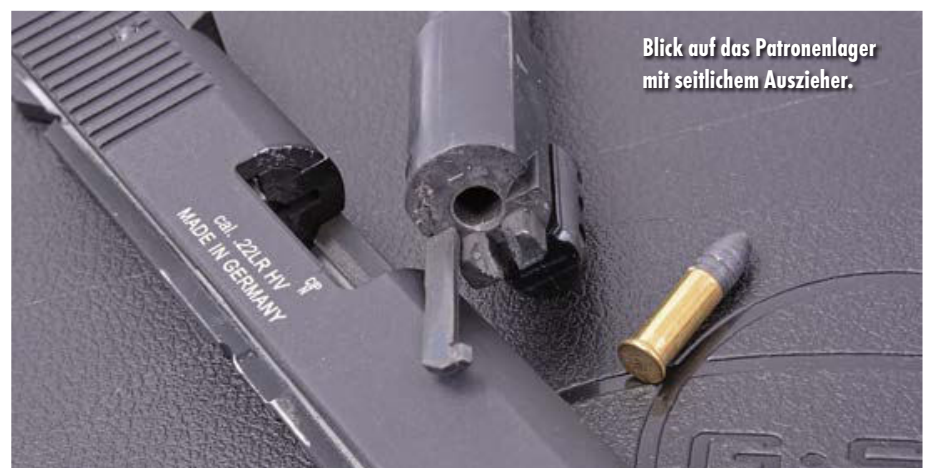
Der demontierte Feder-Masse-Verschluss mit fixem Lauf.
