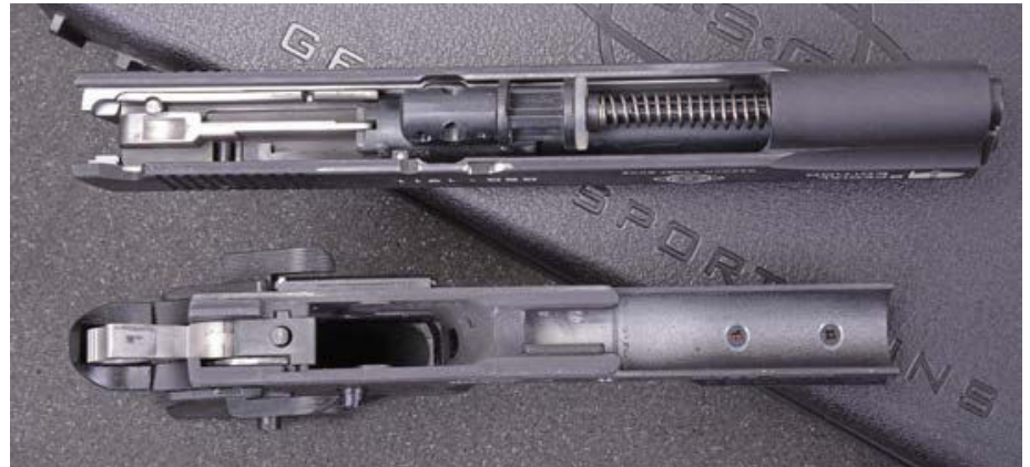
Griffstück aus Zinkdruckguss und Oberteil aus Leichtmetall, voneinander getrennt.
