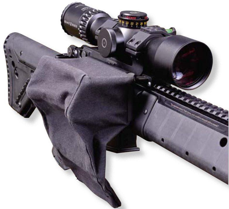
Montierter und abgenommener Hülsenfangsack. Bei den hohen Preisen für rares Messing in 6,5 mm Grendel eine lohnenswerte Investition.
