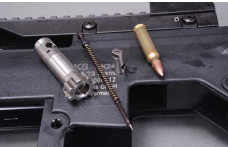
Der Drehkopf-Verschluss mit sechs Warzen im Detail.
