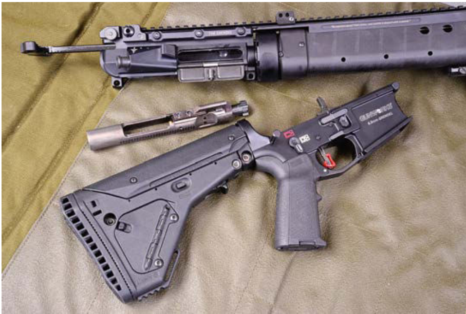
Die drei Hauptbauteile Griffstück, Systemgehäuse (samt Lauf und Handschutz) sowie kompletter Verschlussträger voneinander getrennt.
