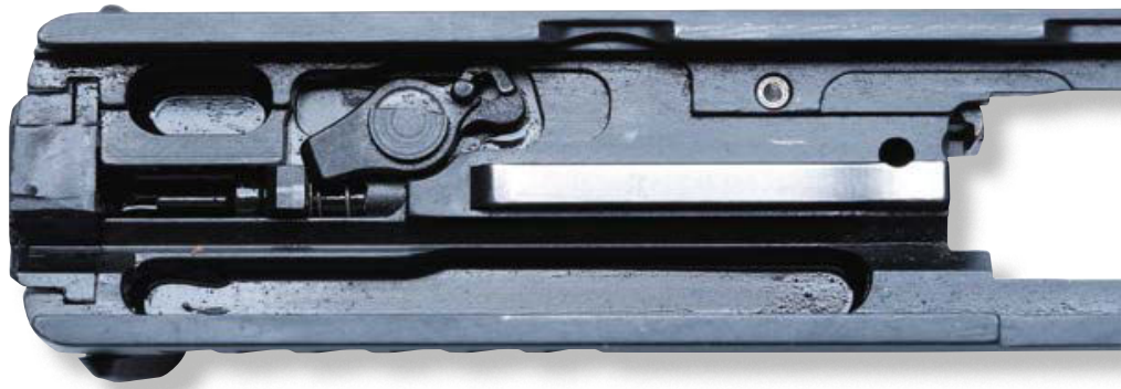
Die im Verschlussheck gelagerte Schlagbolzen-Schlosseinheit im Detail.
