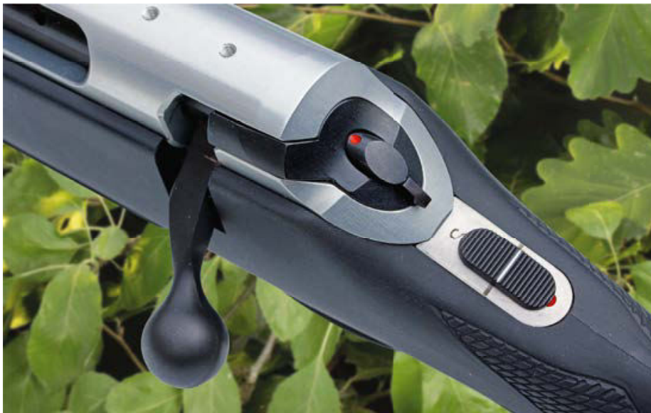
Blick auf die Drei-Stellungs-Sicherung am Kolbenhals.
