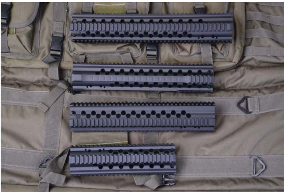
Verschiedene Handschutze aus Burk-Fertigung, die es in drei Baulängen und zwei Versionen gibt. Klassischer „Quadrail“- und handhabungsfreundlicherer Handschutz mit mittig weg gefrästen, seitlichen und unteren Montage-Profilen. Sie werden aus einem Strangprofil aus der Aluminiumlegierung 6061 hergestellt.
