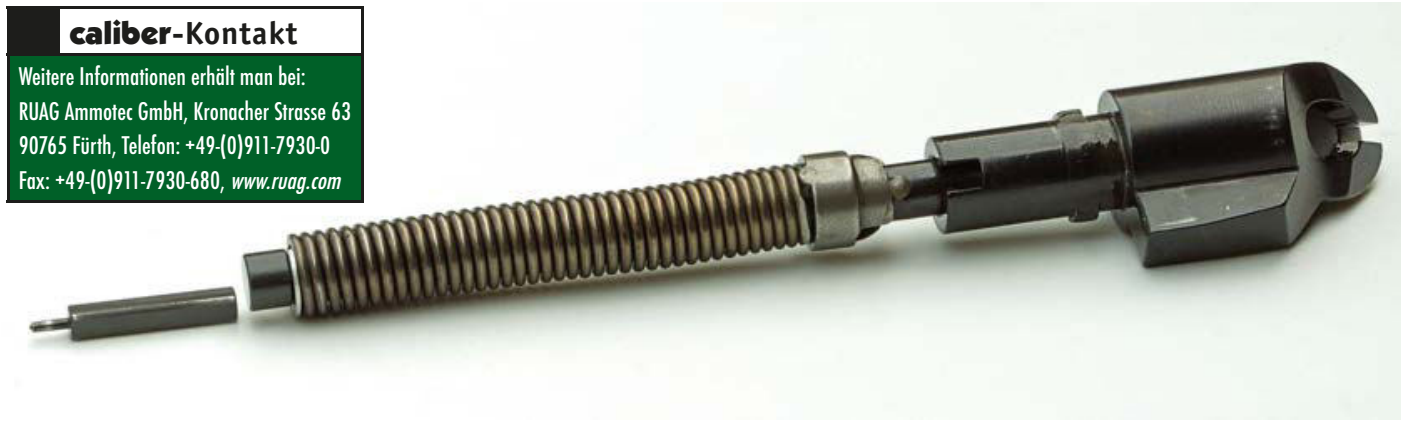
Herausgenommenes Schloss mit doppelter Zündeinheit (Schlagstück und -bolzen) und starker Antriebsfeder. Die doppelte Spannkurve im Detail.
