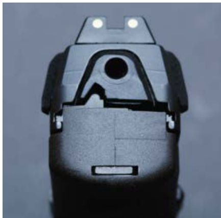
Verschluss-Rückseite: Abzugssystem im entspannten und gespannten Zustand, wobei im letzteren Modus der signal-rot gefärbte Kopf des Zündstifts/Ladestandanzeigers sichtbar wird.
