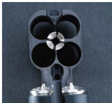
Blick auf die elektronische Zündeinheit im Stoßboden und das Laufbündel im Leerzustand.
