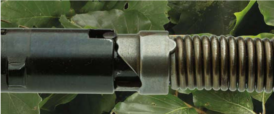
Herausgenommenes Schloss mit doppelter Zündeinheit (Schlagstück und -bolzen) und starker Antriebsfeder. Die doppelte Spannkurve im Detail.
