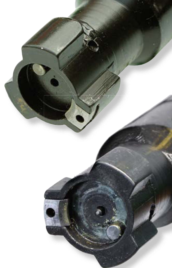
Der Verschlusskopf im Neuzustand und nach 100 Schuss ohne Reinigung.
