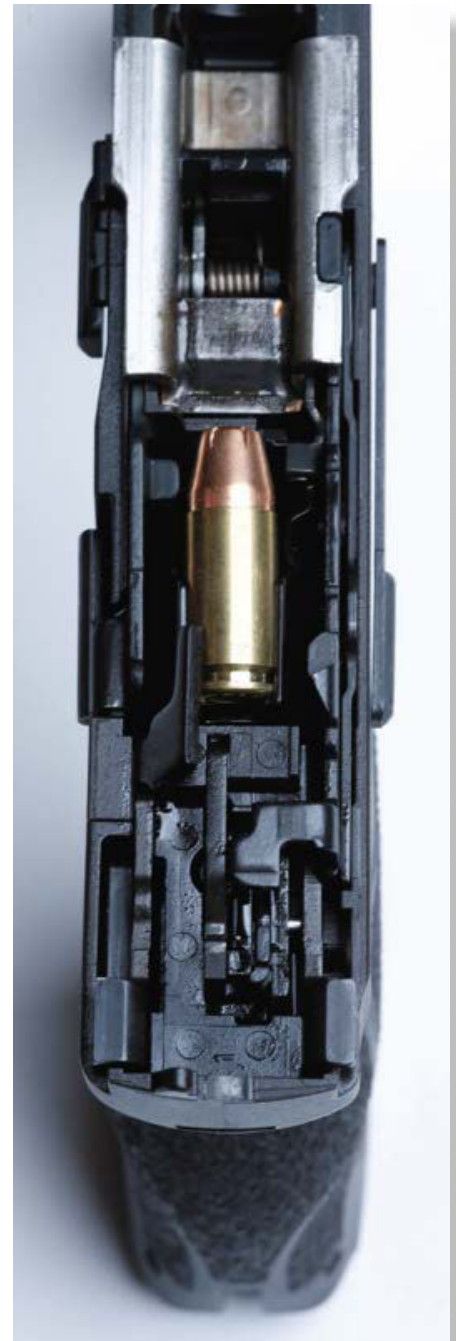
Blick in das Griffstück mit Abzugsgruppe und Verschlussführungsschienen.
