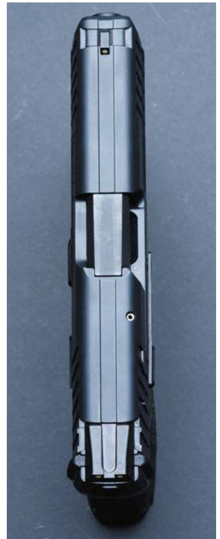
Verschlussoberseite/Visierlinie der SFP9 aus der Vogelperspektive, auch hier sind die griffigen Verschlussflügel im Kimmen-Bereich gut zu erkennen.
