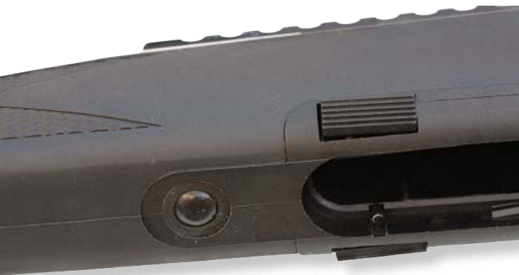
Doppelte Magazin-Arretierungsriegel am Schaft und die beiden Magazine für drei oder fünf Patronen.
