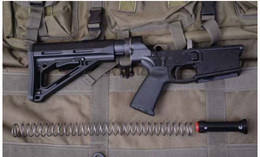
Selbst Anbauteile wie Schließfederrohr, Schließfeder samt Puffer sowie Schulterstütze stammen aus deutscher Produktion nach Burk-Vorgaben.
