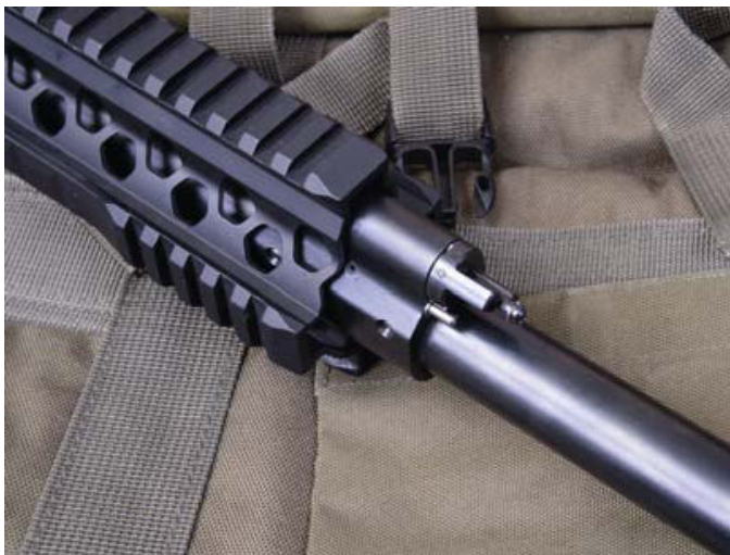
Verstellbare Gasentnahme-Einheit in zwei Positionen.
