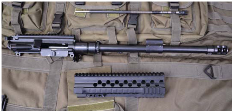
Systemgehäuse/Laufpartie bei abgenommenem Handschutz.
