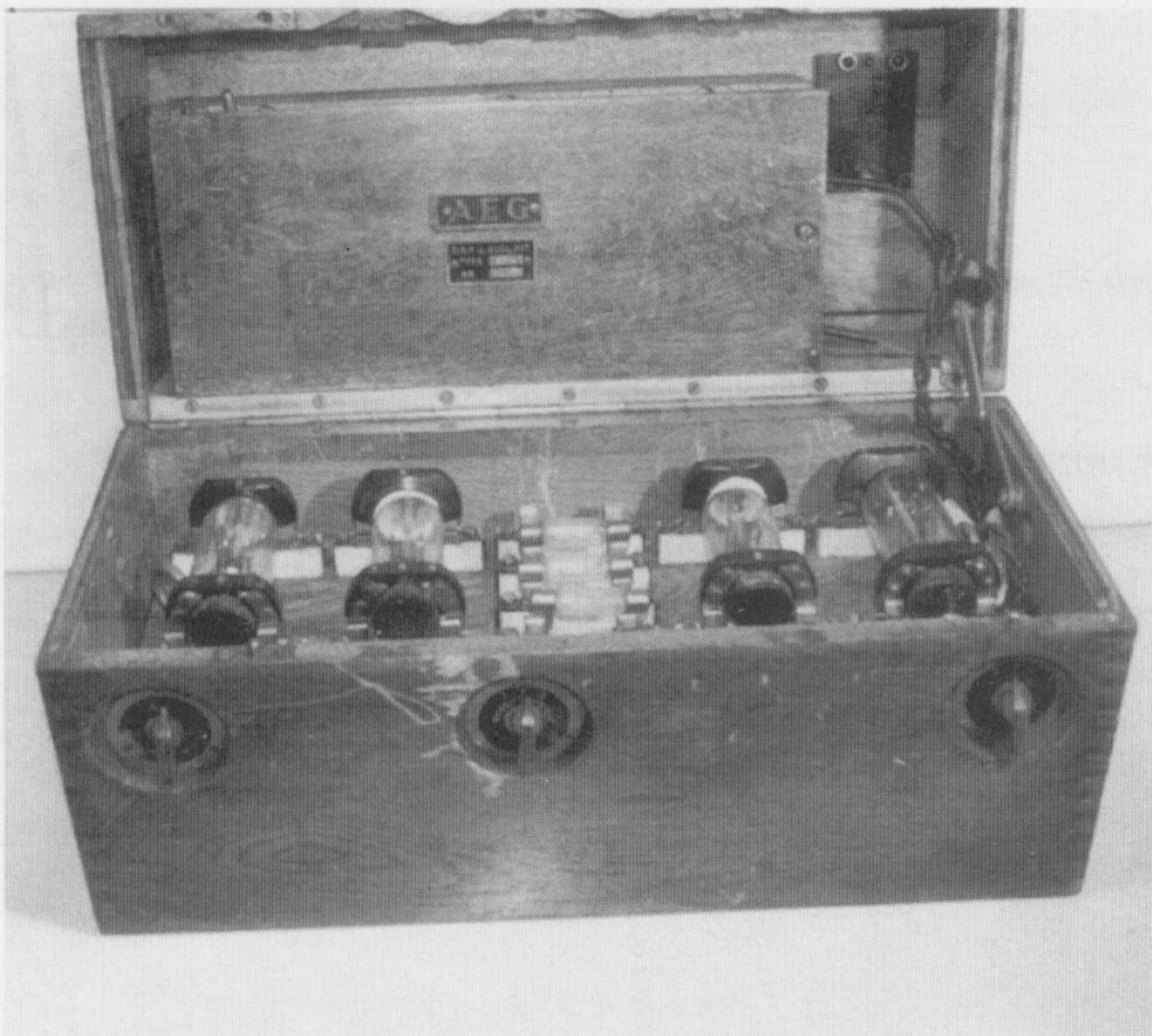
4 - stufiger Fernsprechverstärker KF 4 Mit der Erfindung der Liebenröhre (Elektronenröhre) konnte ein praktisch brauchbarer Fernsprechverstärker geschaffen werden. Ab 1917 wurde die „Liebenröhre“ durch die „Vakuumpöröhre“ ersetzt.
