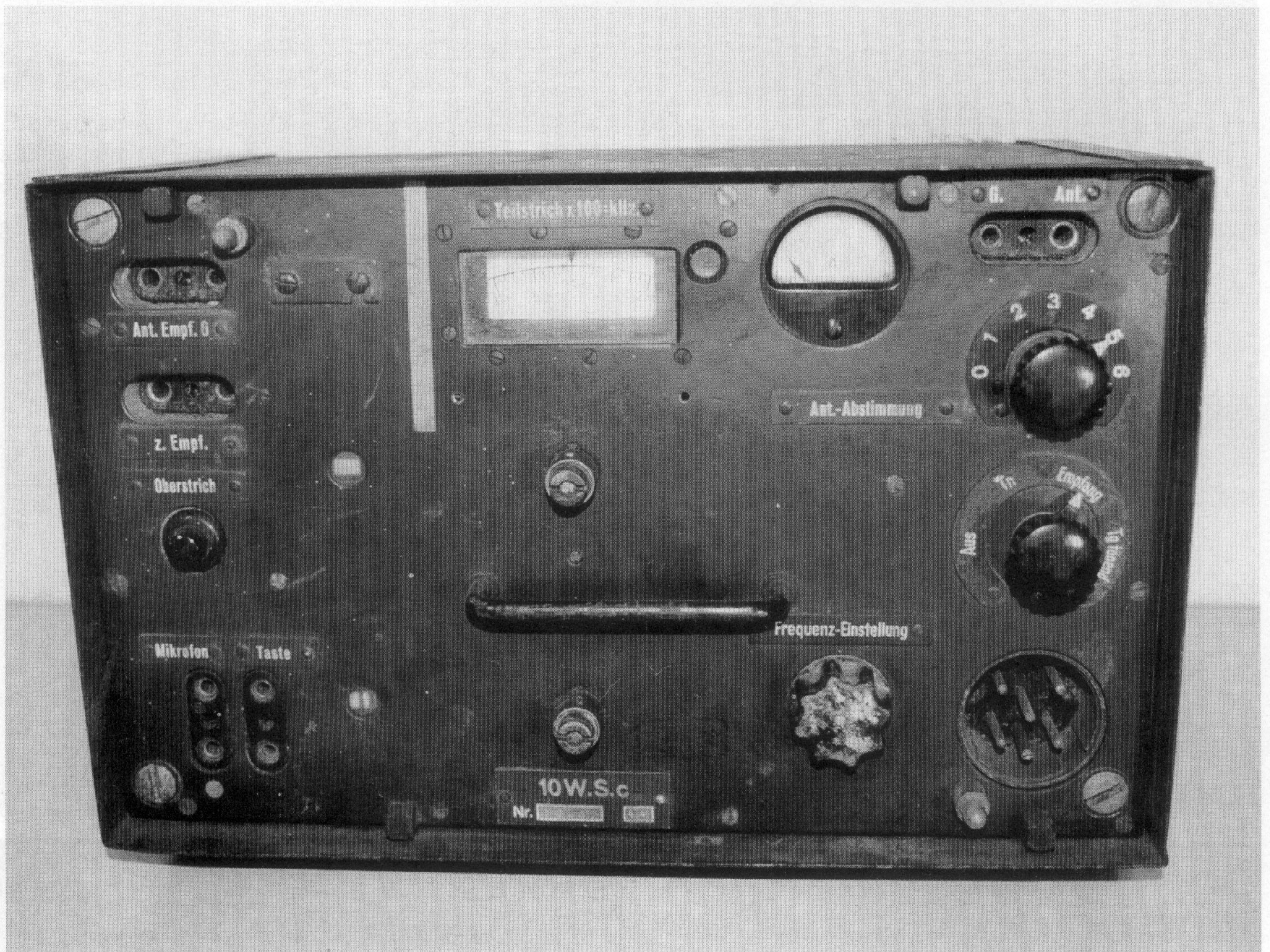
Die Sender 10 W.S. c und h, 20 W.S.c und d, 30 W.S., 30 W.S.a und 80 W.S.a sind speziell für Panzerfahrzeuge entwickelt worden. Sie waren jedoch ebenso wie die Empfänger der Panzerfahrzeuge ausbaubar und konnten „abgesetzt“ eingesetzt werden.
