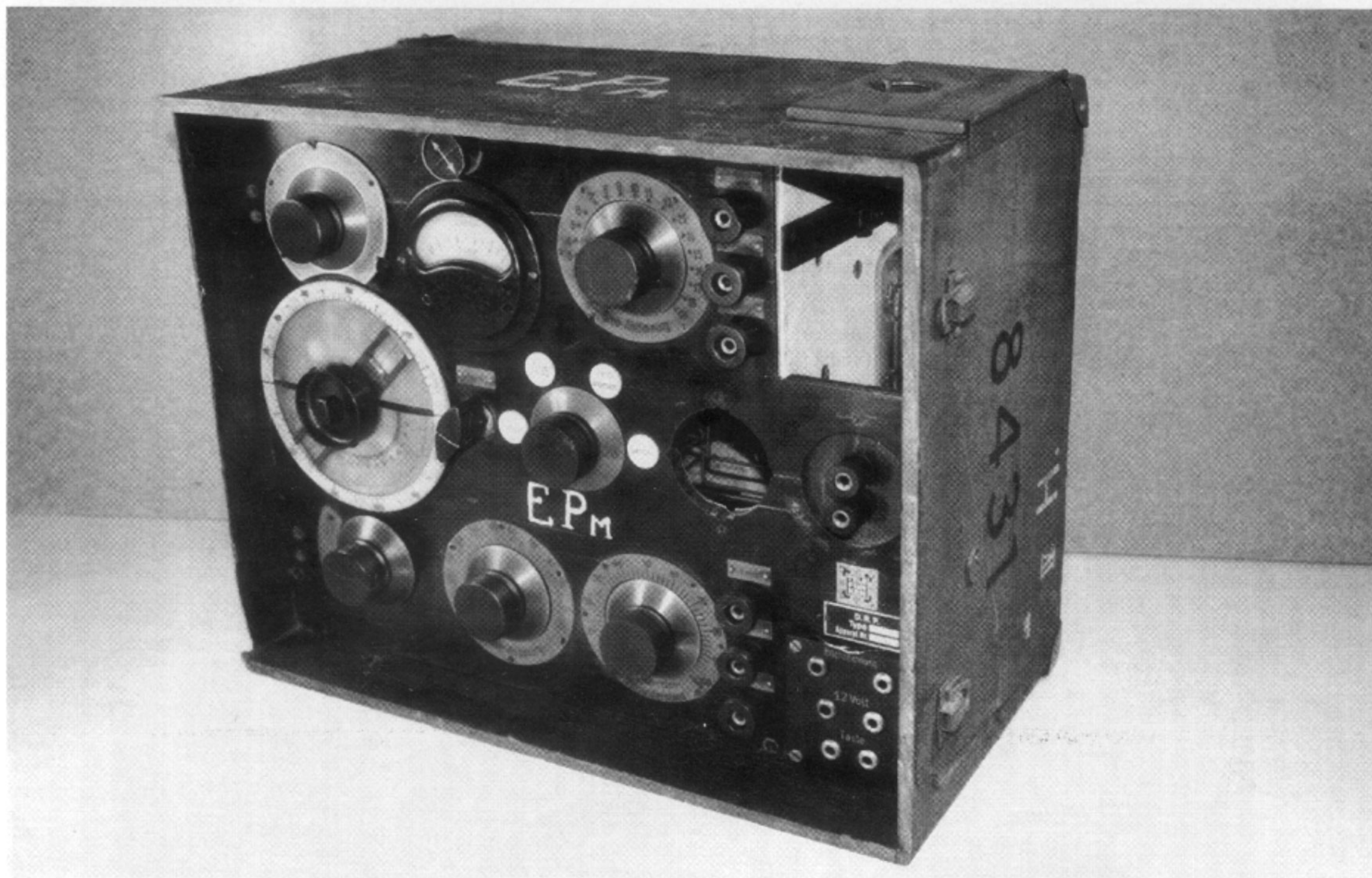
Kleine Röhrensender Station ARS 69, Hersteller Telefunken. 5 Watt-Sender für Telegrafie. Reichweite etwa 12 km. Mit dem ARS 68 (Sender und Empfänger in einem Gehäuse) und dem Sender ARS 69 mit dem separaten Empfänger E 225 wurden 1918 die ersten feldbrauchbaren Röhrenfunkgeräte ins Heer eingeführt.
