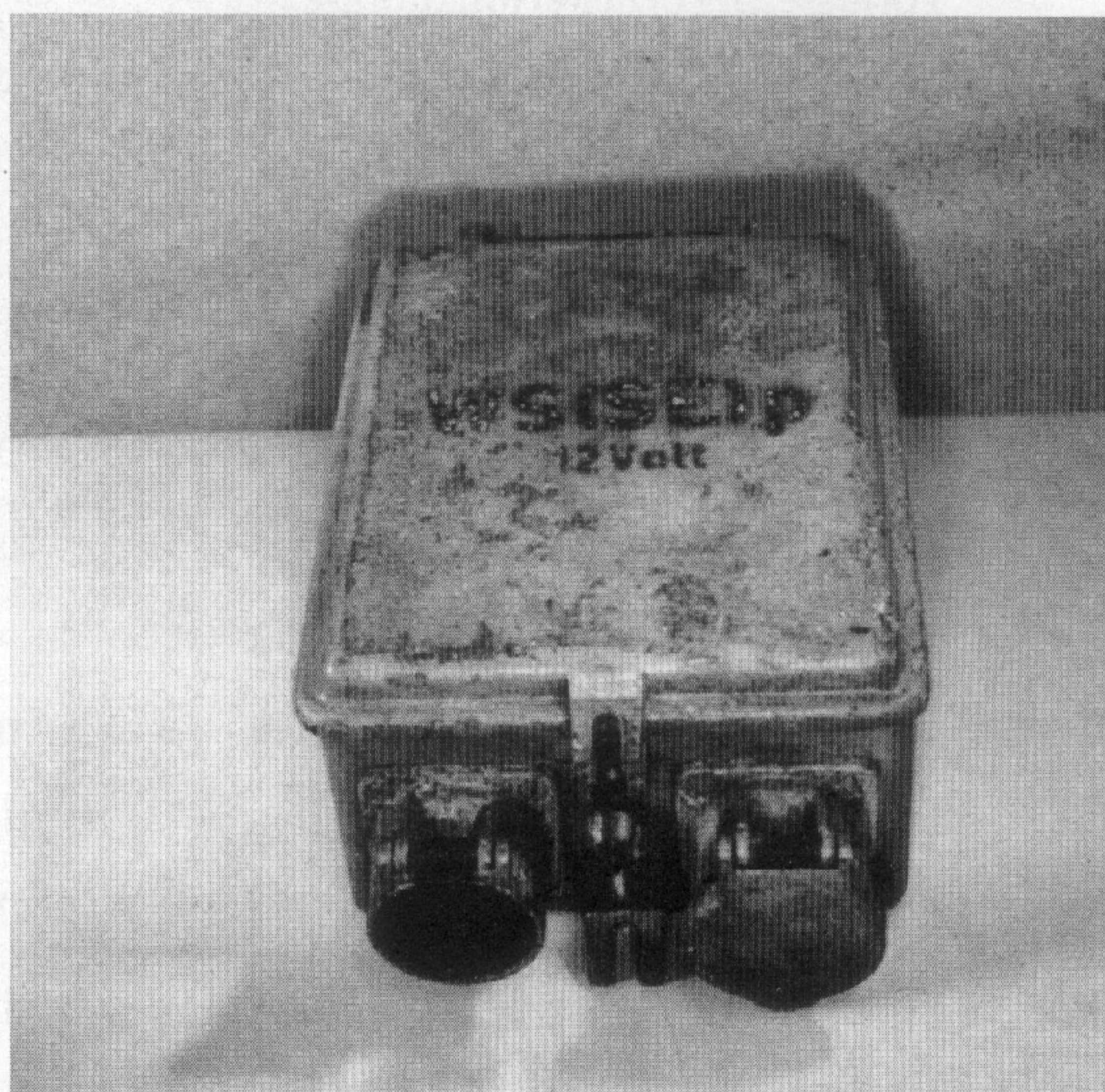
Stromversorgungsgerät für den Betrieb von Funkgeräten vom Bordnetz der Fahrzeuge.
