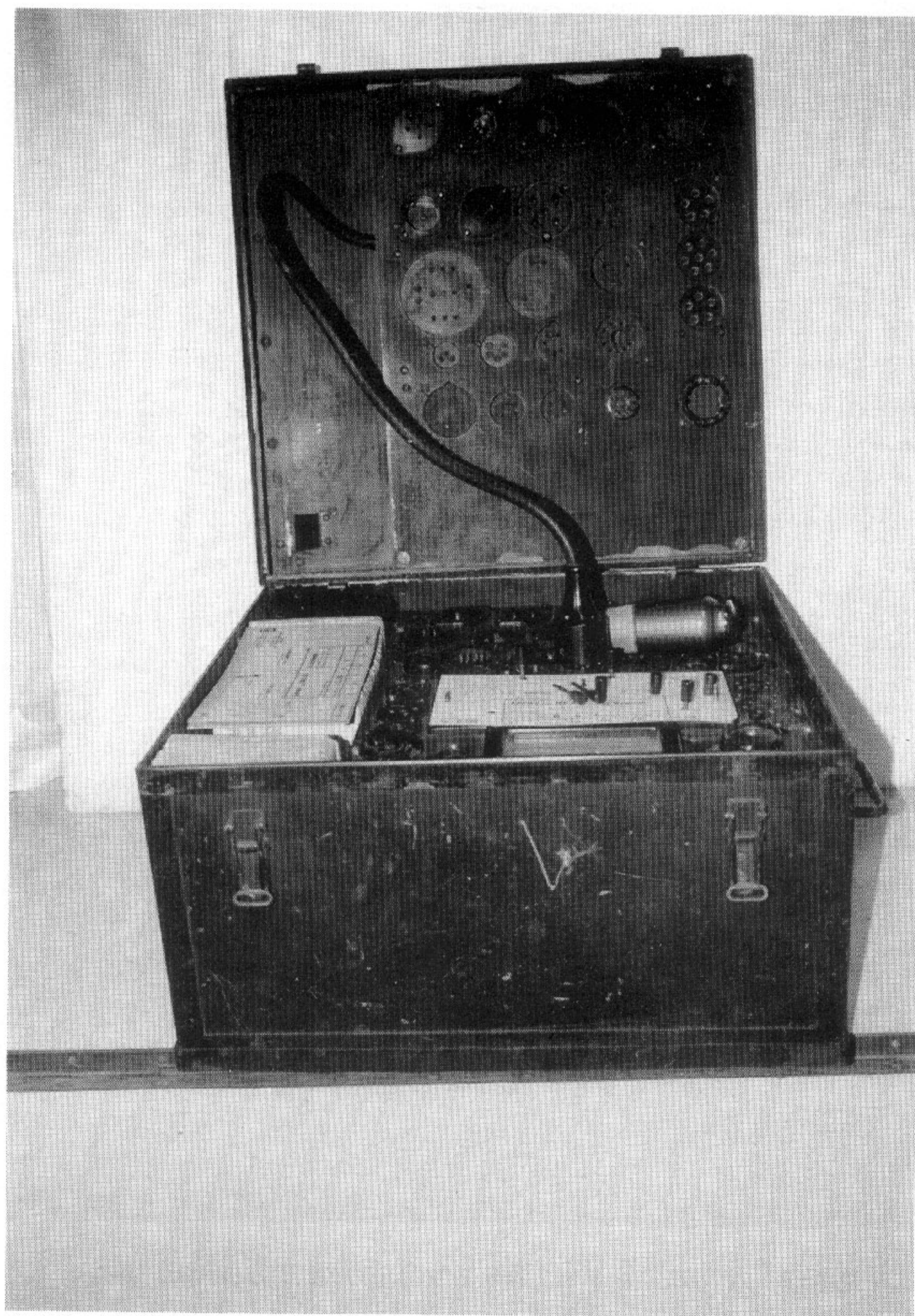
Röhrenprüfgerät RPG 4 (1944) Prüfgerät für ca. 1500 verschiedene Röhren
