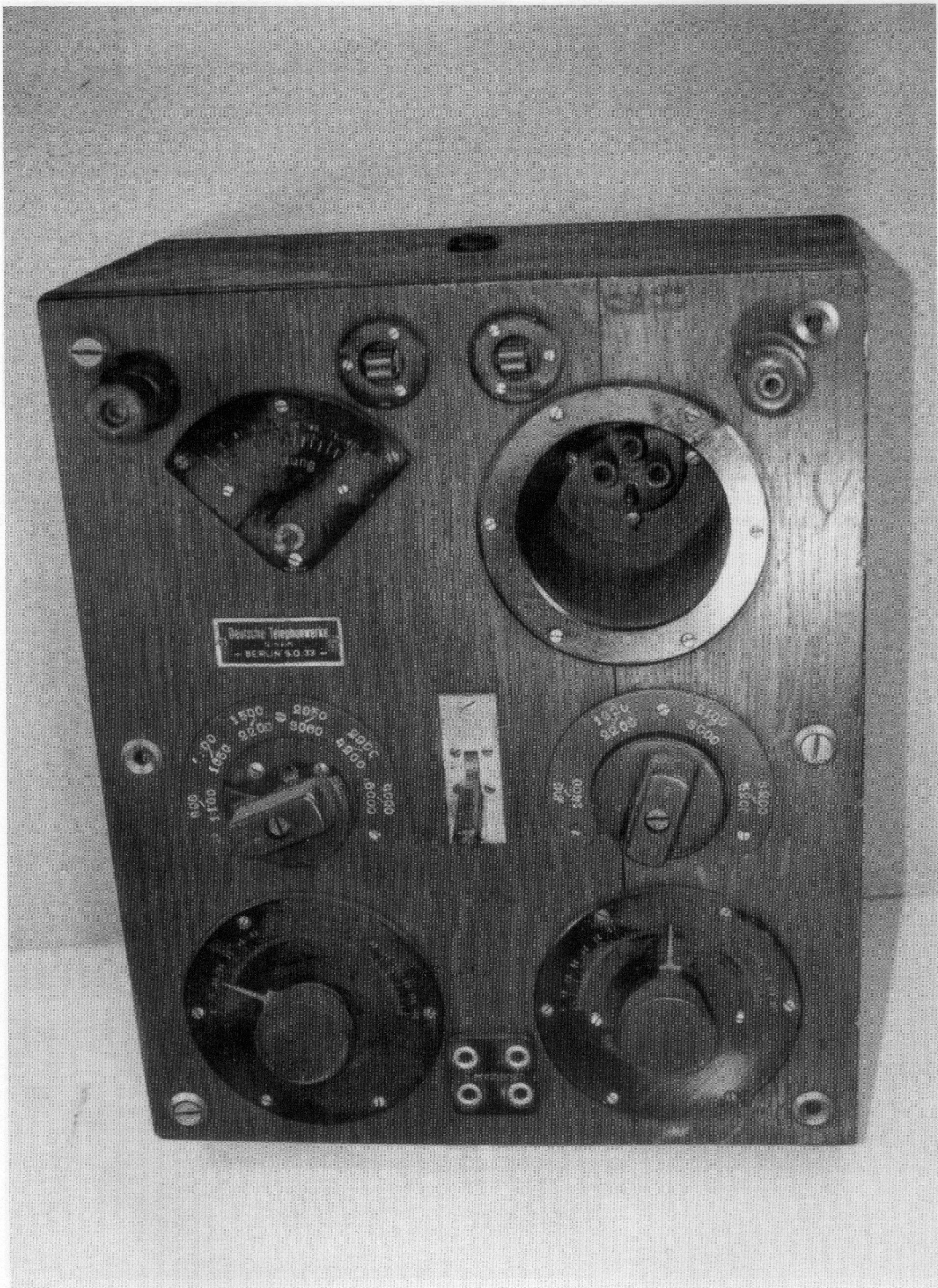
Empfänger D.T.W, Deutsche Telefonwerke Berlin. Einfacher Audionempfänger mit einer Röhre ohne Rückkopplung. Das Gerät besitzt keinen eingebauten Verstärker. Es ist deshalb ein zusätzlicher Verstärker erforderlich.
