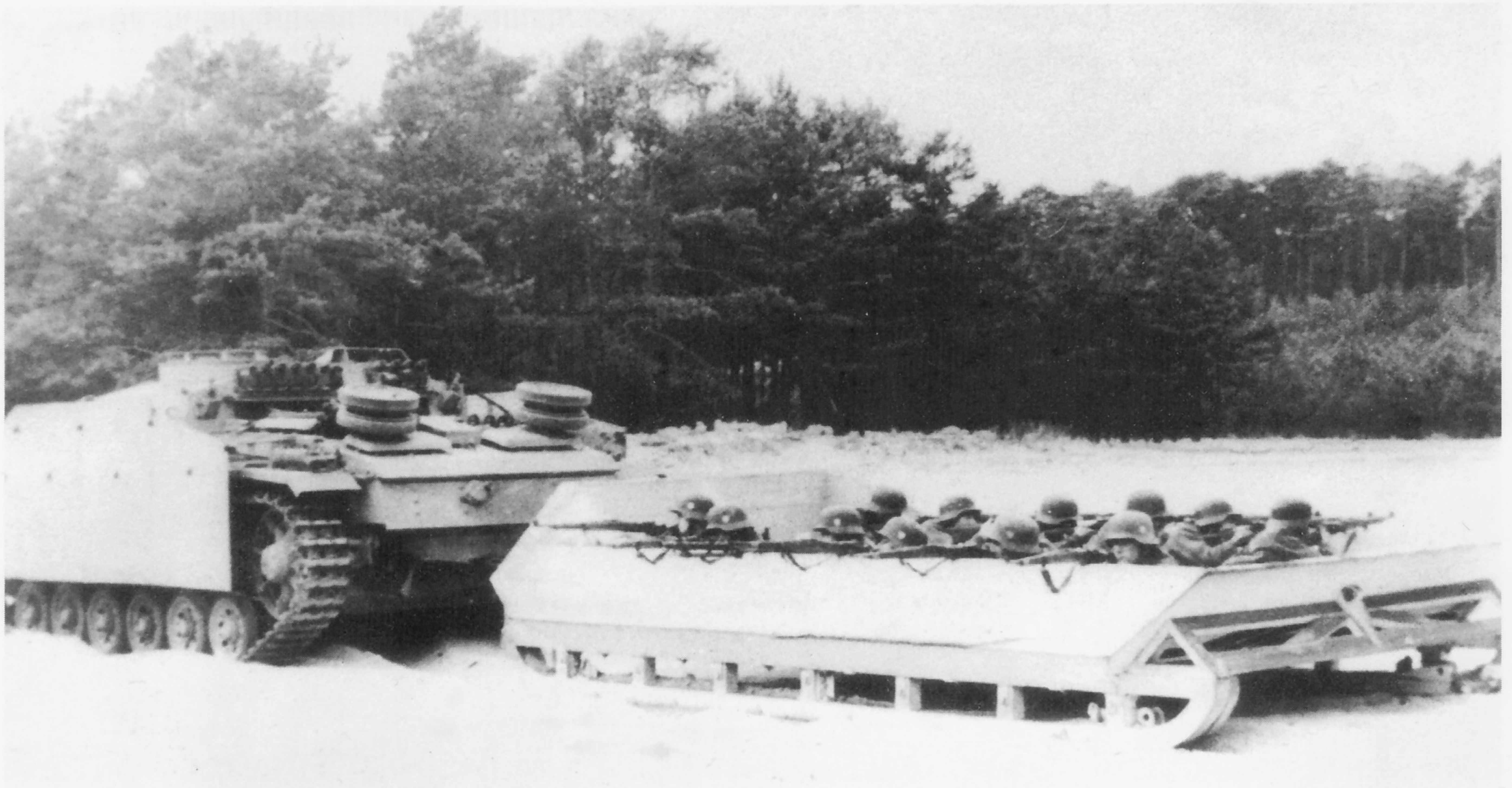
Zu den weniger bekannten Schlitten zählte der schwere Anhängerschleitten für Gleiskettenfahrzeuge. Er diente zum Transport von Mannschaften und Gepäck und wurde mit einer Anhängerdeichsel an Kettenfahrzeuge angehängt.
