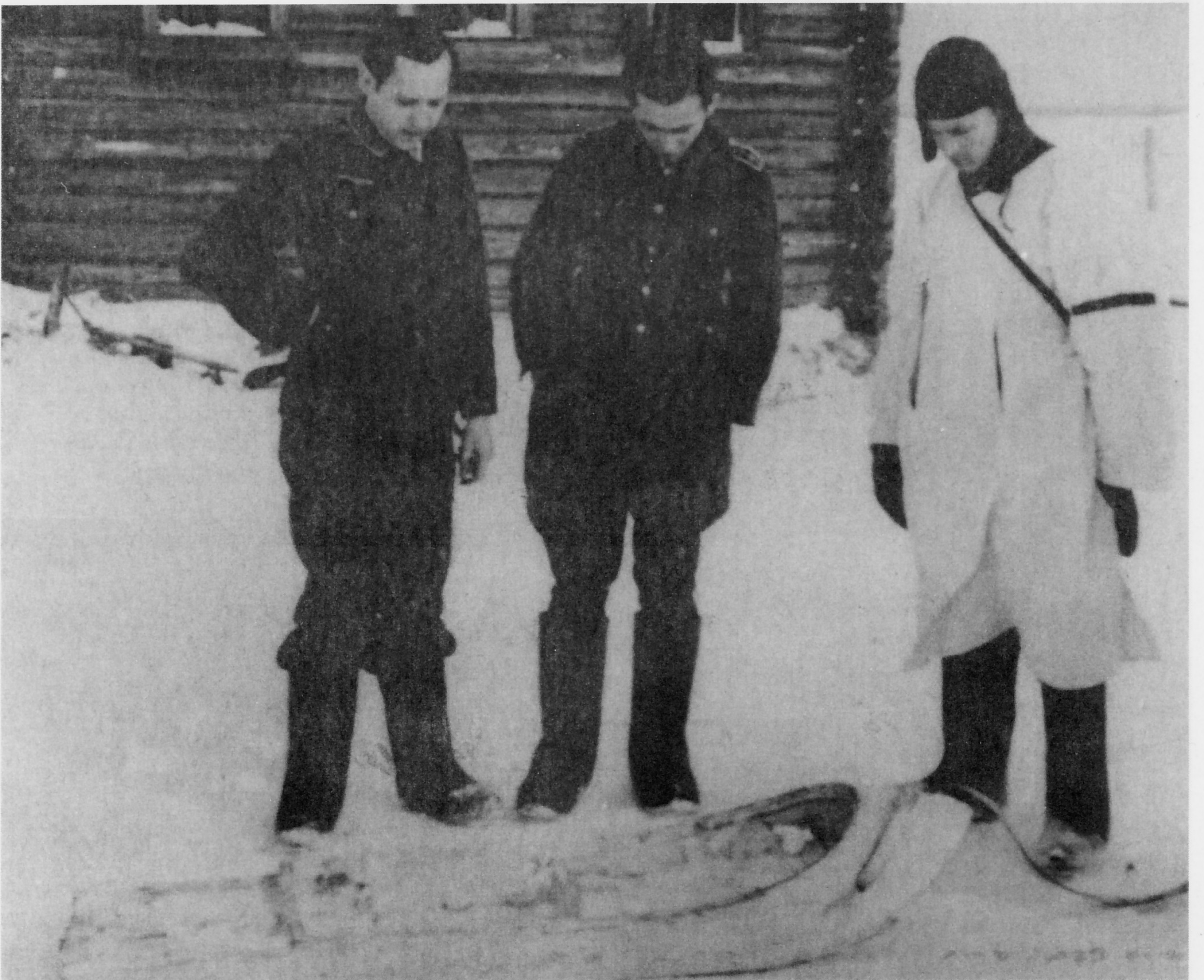
Offensichtlich rief dieses eigenartige Schneefahrzeug bei den Soldaten Verwunderung hervor. Es handelte sich um einen finnischen Akja, der bei einer Sanitätseinheit zum Verwundetentransport im Tiefschnee eingesetzt und hier scherzhaft als "Sarg mit flachen Kufen" bezeichnet wurde. Die Akjas konnten nur im tiefen Schnee eingesetzt werden; auf gebahnten Wegen schleuderten sie.
