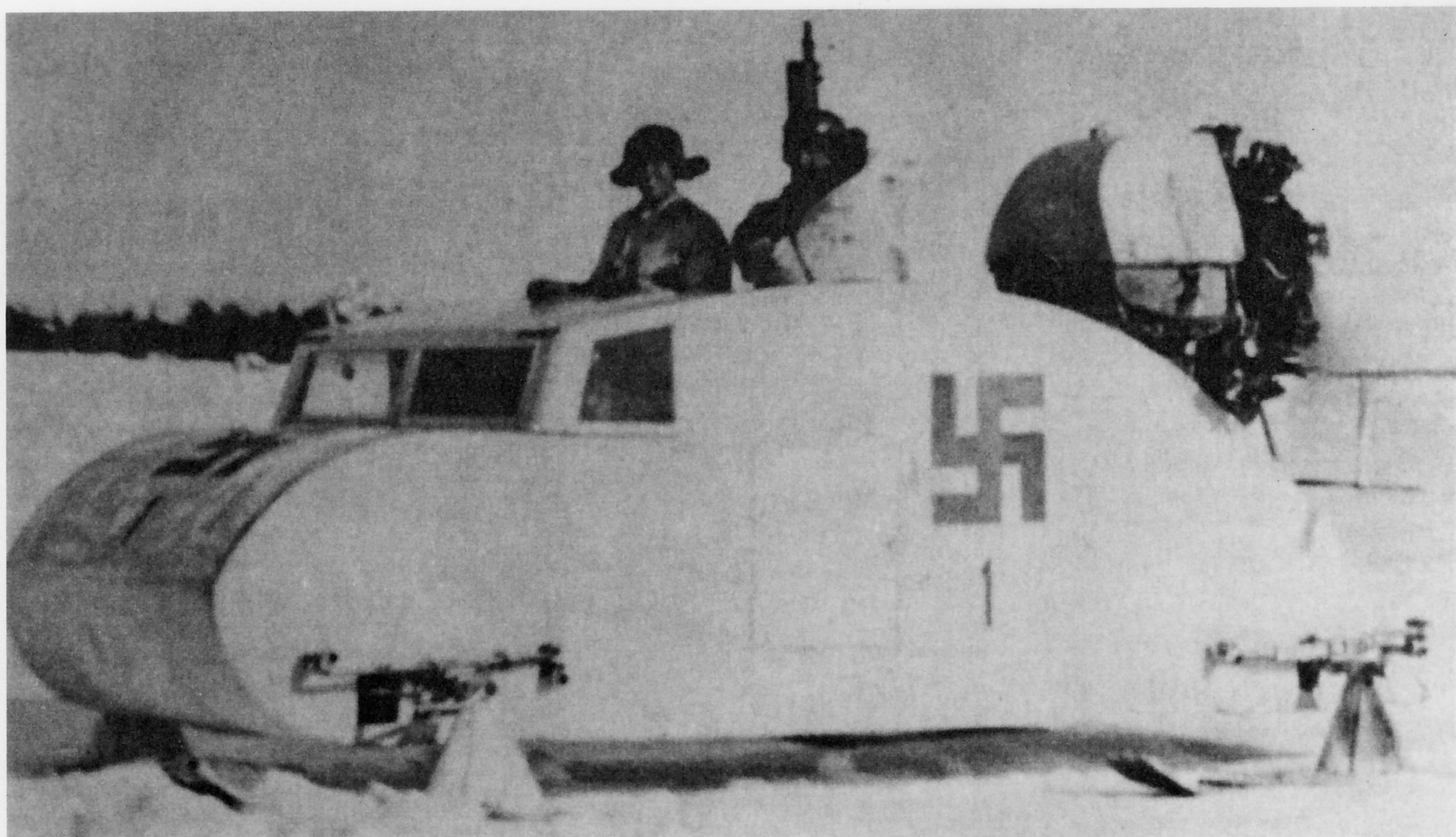
Hier eine andere Variante des Propellerschlittens bei den finnischen Truppen, die das Hakenkreuz als nationales Emblem an ihren Militärfahrzeugen hatten. Die Bugform deutet daraufhin, daß es sich hier um den Umbau eines russischen Beuteschlittens vom Typ NKL 16/41 handelt, der auf russischer Seite erstmals im Winter 1941/42 in größerer Stückzahl als Transportmotorschlitten zum Einsatz kam
