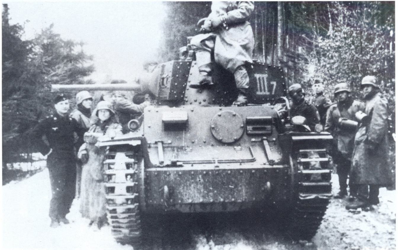
Ein fabrikneuer Panzerkampfwagen 38(t) (3,7-cm) der Ausführung E während einer Übung im Februar 1941. Fahrzeuge dieser Ausführung sind ab November 1940 zur Auslieferung gekommen. Beachte die gerade ausgeführte Fahrerfront und die mit einer kreisrunden Panzerplatte verschlossene Öffnung für das Bug-Maschinengewehr.
