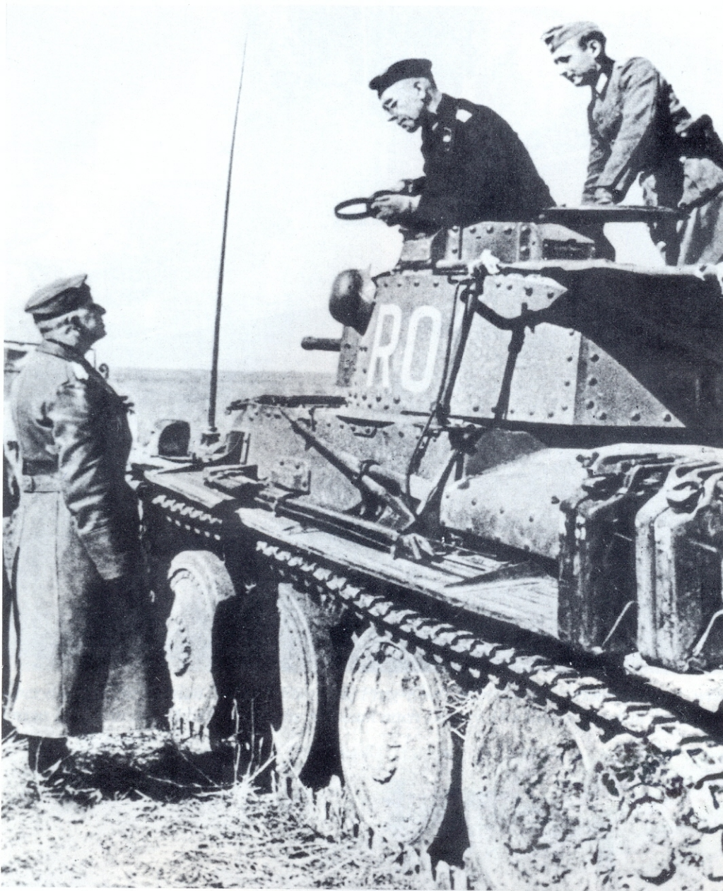
Innerhalb der mit dem Panzerkampfwagen 38(t) ausgestatteten Verbände wurden Panzerbefehlswagen 38(t) eingesetzt. Sie verfügten über die Funkgerätesätze Fu 5 und Fu 8. Äußerlich erkannte man sie an der Rahmenantenne und dem fehlenden Bug-Maschinengewehr.
