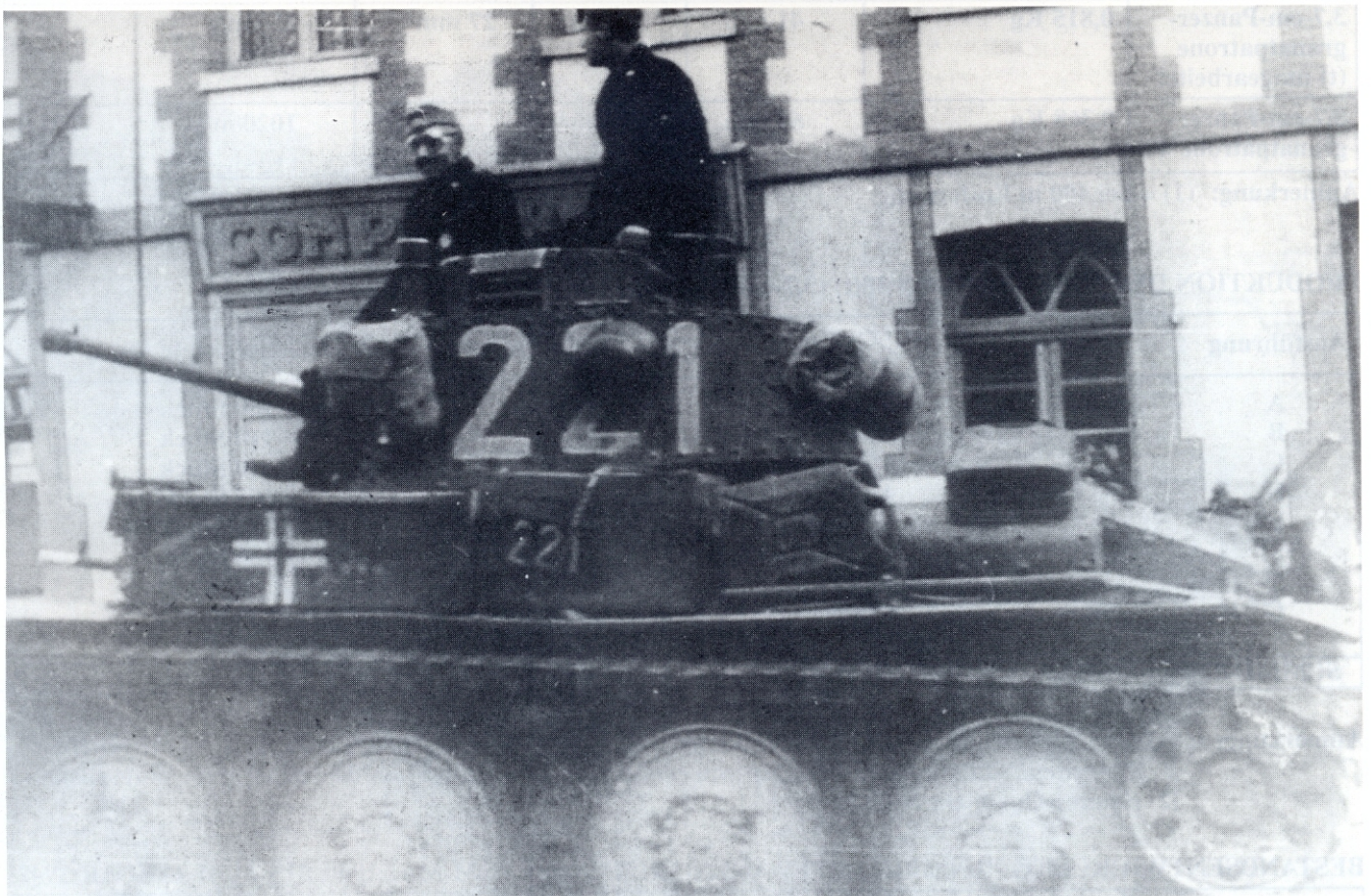
Die Panzerung des Panzerkampfwagen 38(t) (3,7-cm) hatte sich in Frankreich als zu schwach erwiesen. Bei den Fahrzeugen, die ab Herbst 1940 zur Auslieferung kamen, ist sie deshalb verstärkt worden.
