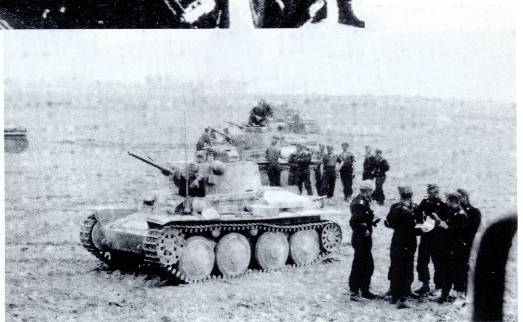
Beachte die Stabantenne für das Funkgerät Fu 5 auf der linken Seite der Panzerwanne. Der Funkgerätesatz bestand aus einem UKW-Empfänger e, einem 10-Watt-Sender c, den Umformern und der 2-m langen Stabantenne.
