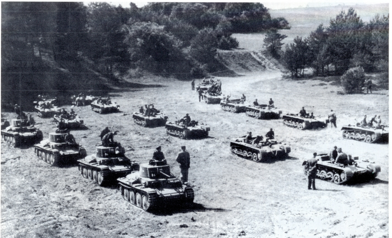
Fahrschulpanzer 38(t) mit Drehturm aber ausgebauter Bewaffnung an der N.S.K.K.-Motorschule in Wriezen. Aufnahme vom Frühjahr 1944. Im Hintergrund Fahrschulpanzer I.
