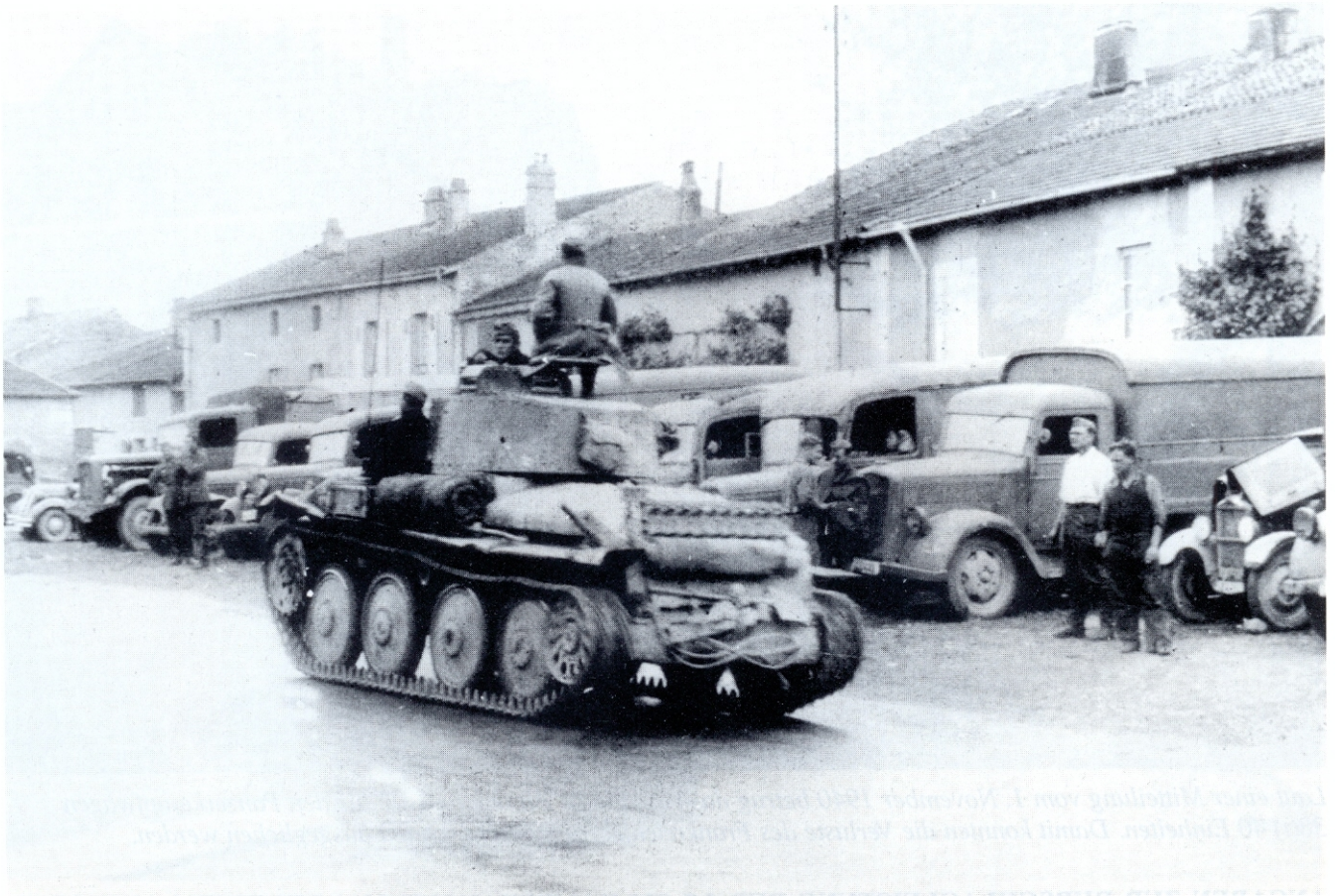
Der 128 PS starke 6-Zylinder-Praga-Motor des Panzerkampfwagen 38(t) verbrauchte für 100 auf der Straße gefahrene Kilometer 92 Liter Vergaserkraftstoff. Der Tankinhalt erlaubte einen Fahrbereich von maximal 250 Km.
