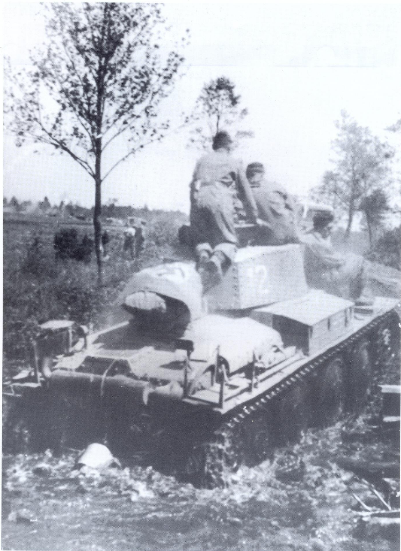
Panzerkampfwagen 38 (t) (3,7-cm), Ende Juni 1941, wenige Tage nach dem Beginn der Operation "Barbarossa". Beachte die großen, seitlich angebrachten Staukästen und die Halterungen für 20-Liter-Benzinkanister auf den Kettenabdeckungen.
