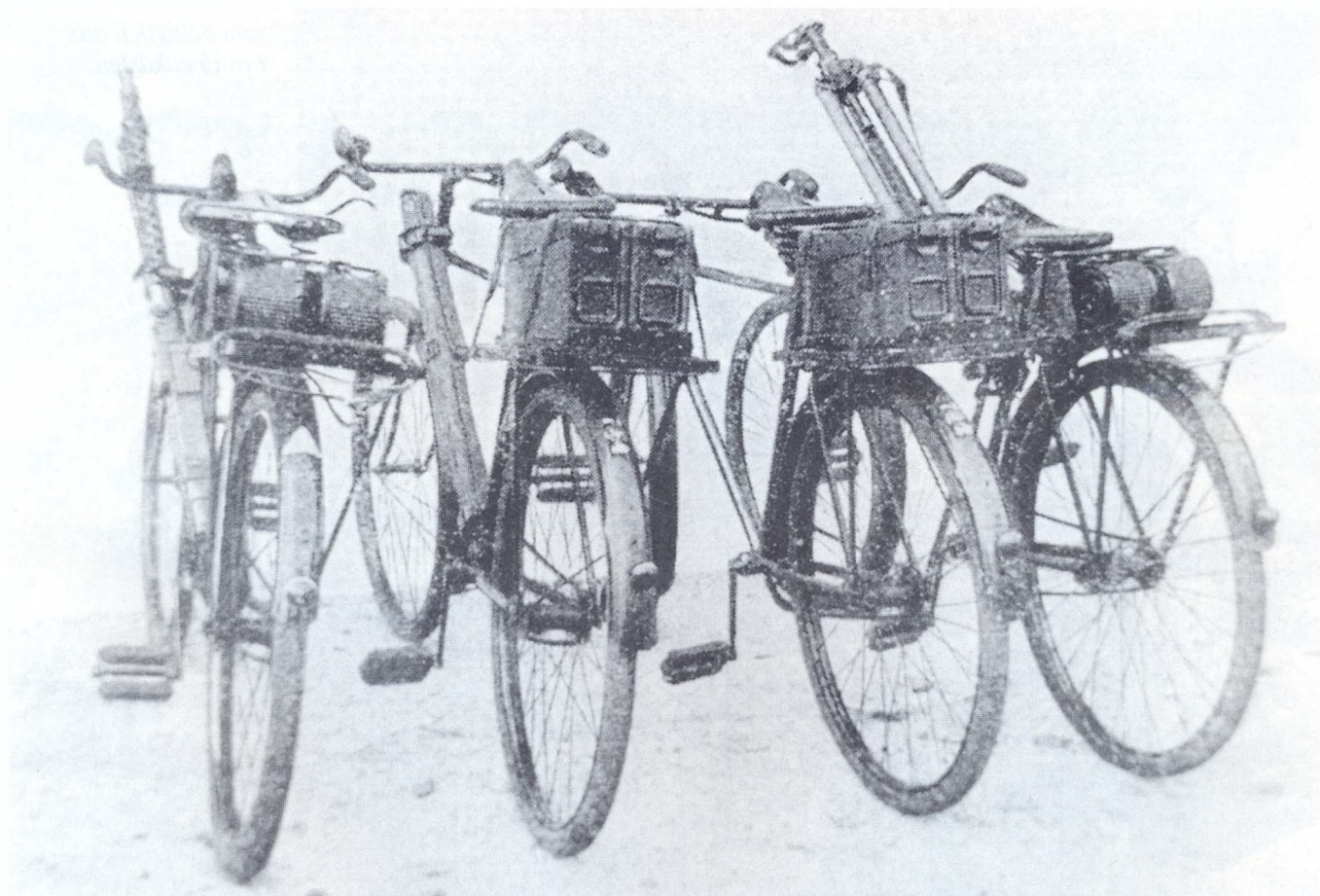
„Mitführung des MG 34 bei den Radfaherschwadronen.“ v.l.n.r. Schütze 1: MG 34 und Trommelträger mit 2 Gurttrommeln 34 (2x 75 Schuß) Schütze 2: Laufschütze 34 mit Vorratslauf und 2 Patronenkästen 34 (2x 300 Schuß) Schütze 3: Tragegurt für MG und 2 Patronenkästen 34 (2x300 Schuß) Schütze 4: Dreibein 34 und Trommelträger mit 2 Gurttrommeln 34 (2x75 Schuß) = 1500 Schuß
