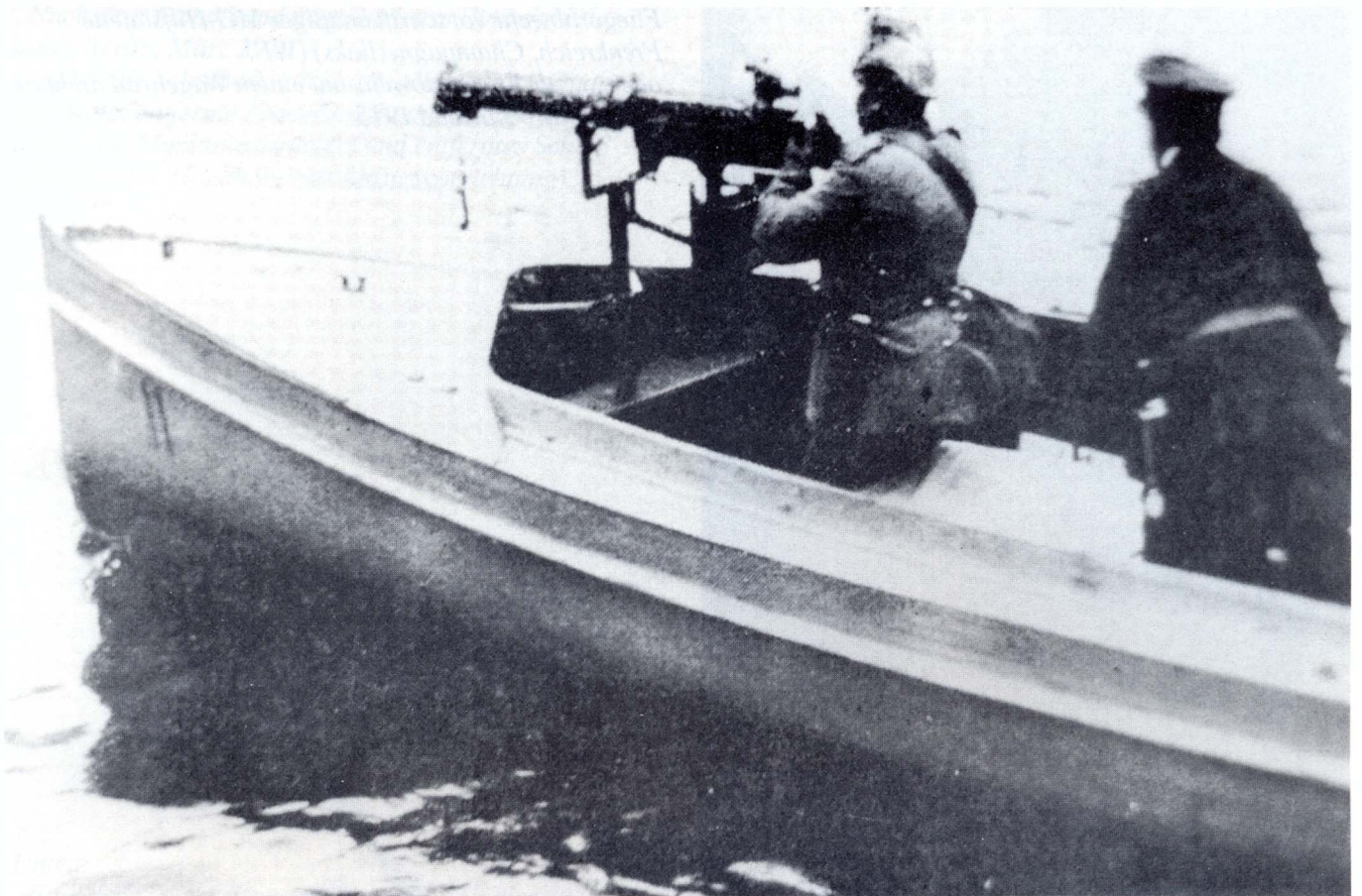
„Ein mit einem Maschinengewehr ausgerüstetes deutsches Motorboot beim Aufklärungsdienst“ Flandern 1914 Beachte Lafettenkonstruktion sowie MG 08 mit Zielfernrohr 12
