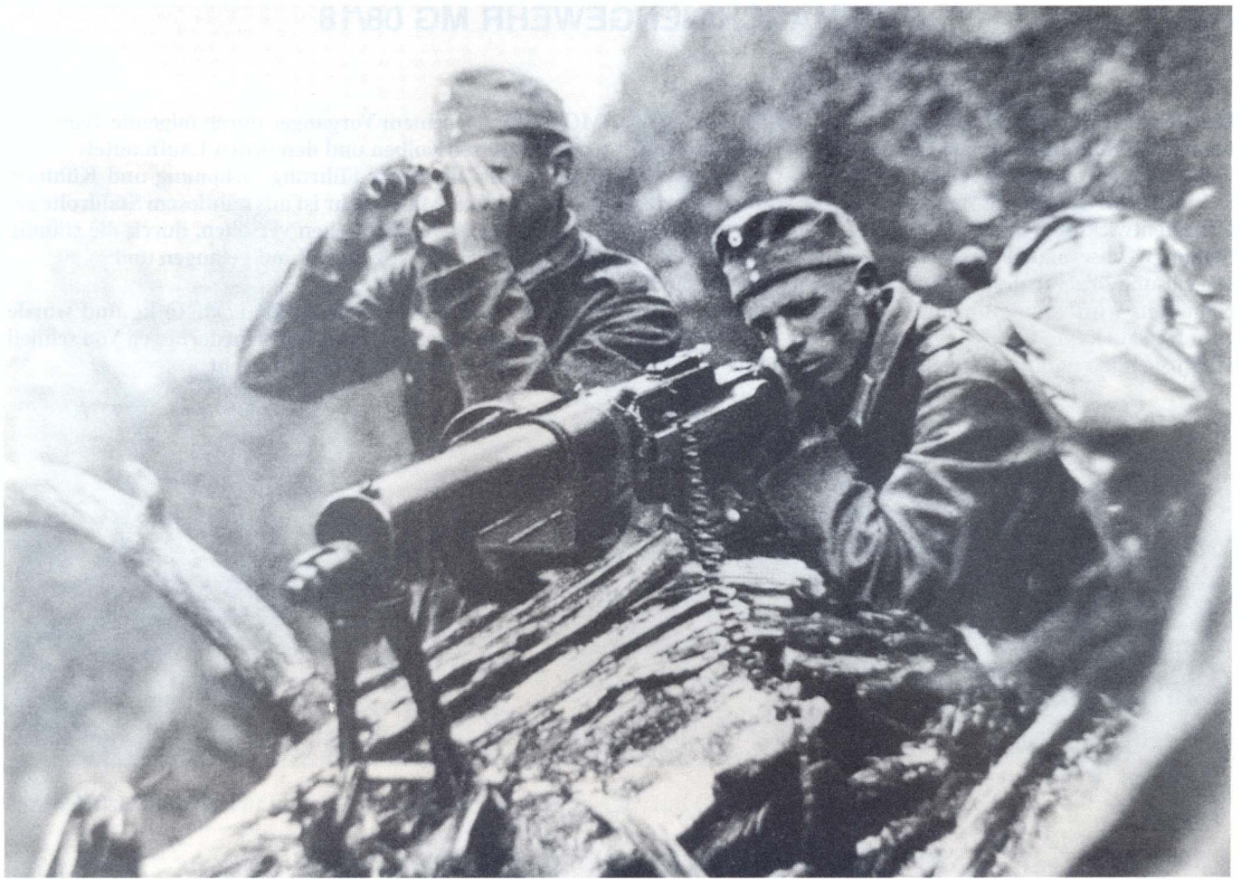
„MG-Nest am Steilhang“ 1937 Beachte Rückstoßverstärker n./A., Gabelstütze und Gurttrommel (Patronenkasten 16)
