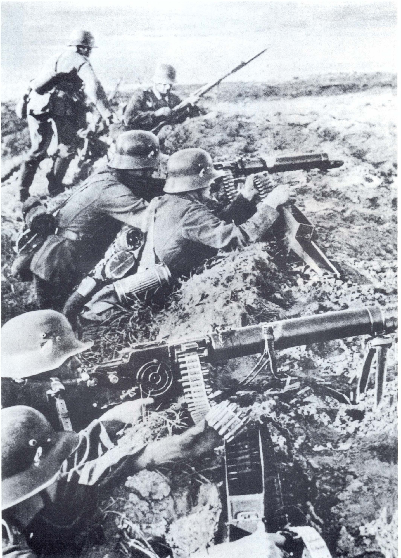
„Am alten I.M.G.“ „Schützenfeuer“, MG 08/15 in Schützenkette, Schulschießen aus Patronenkasten, 1937 Beachte Gabelstütze in Vorder- und Mittelunterstützung, Dampfablaßschlauch, Befestigung Kreiskorn
