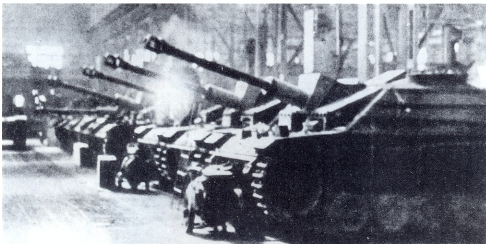
Sturmgeschützfertigung in der Altmärkischen Kettenwerk GmbH in Berlin-Tegel(Alkett). Im Dezember 1944 übernahm das Heereswaffenamt 452 gepanzerte Selbstfahrlafetten für Sturmgeschütz 7,5-cm-Kanone, Ausführung G, wovon 361 von Alkett kamen.
