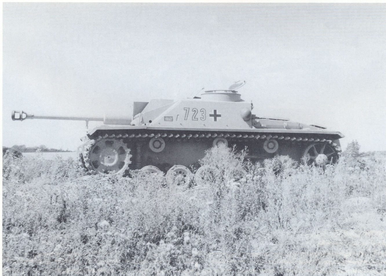
Dieses heute in den USA befindliche Sturmgeschütz stammt ebenfalls aus den Beständen der finnischen Armee. Beachte das Fehlen des Geschossabweisers an der Kommandantenkuppel.
