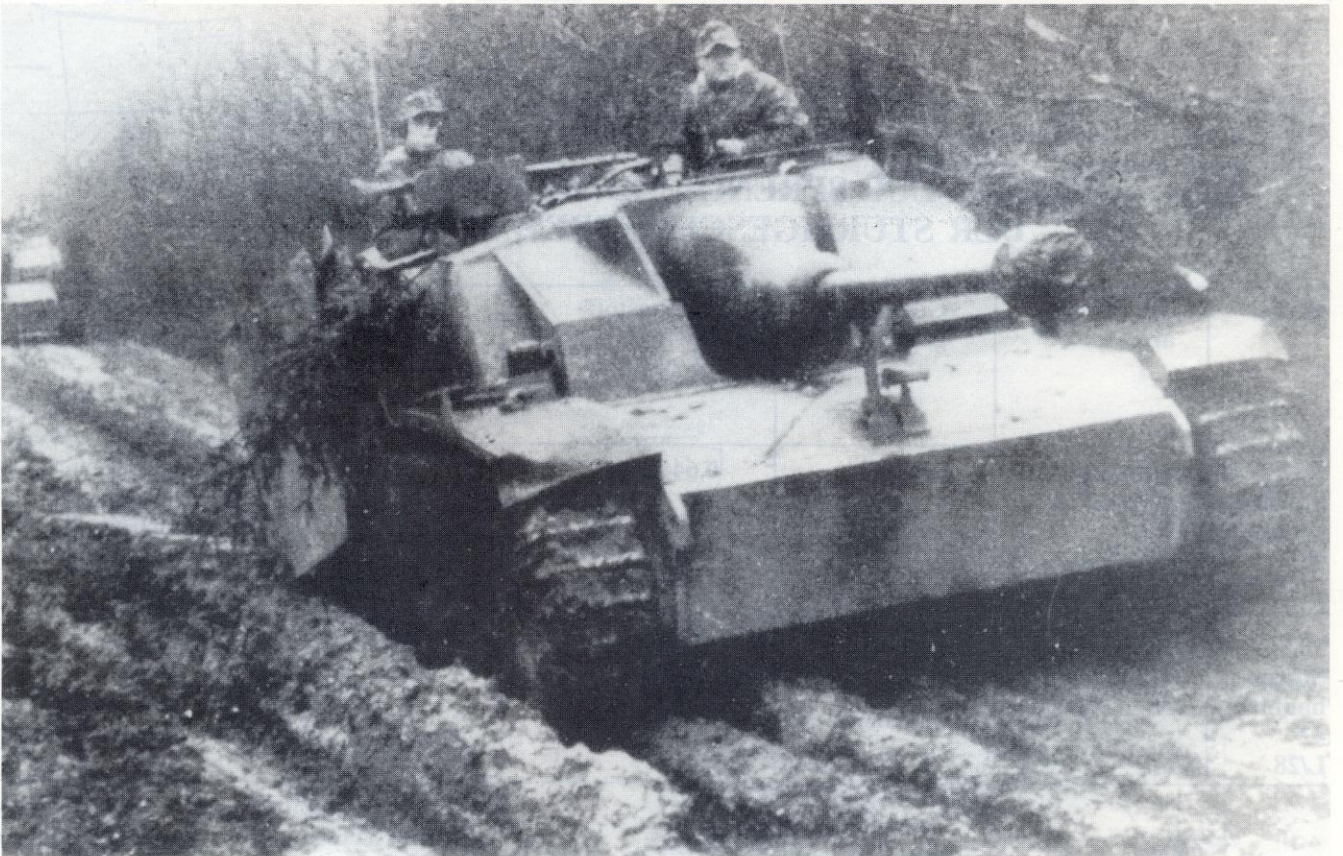
Dieses Sturmgeschütz III der G-Ausführung wurde Anfang 1945 an der Westfront fotografiert. Es ist mit dem Rundumfeuer-Maschinengewehr versehen, das erstmals im April 1944 in Sturmgeschütze eingebaut worden war.
