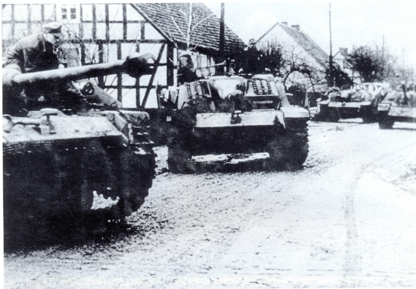
Sturmgeschütze und Jagdpanzer während der Kämpfe an der Oderfront im März 1945. Bei dem Fahrzeug auf der linken Seite ist die seitlich weggeklappte Rohrstütze gut zu erkennen. Das Sturmgeschütz in der Mitte hat ein Rundumfeuer-Maschinengewehr.
