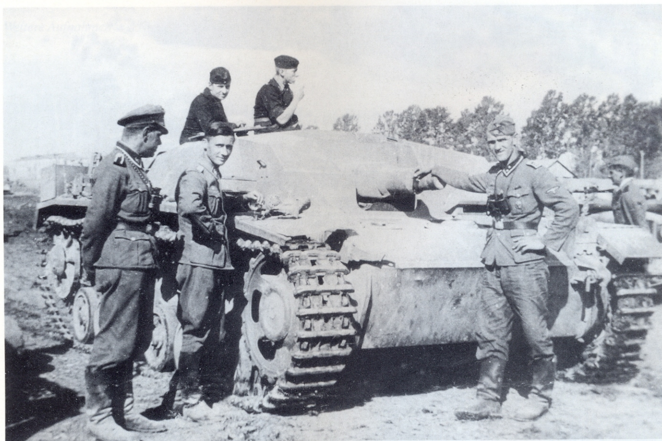
Die Stammdivisionen der SS-Verfügungstruppe erhielten schon 1940/41 eigene Sturmgeschütz Batterien, die später zu Abteilungen ausgebaut wurden. Im Bild eine gepanzerte Selbstfahrlafette für Sturmgeschütz 7,5-cm-Kanone, Ausführung B bei der SS-Division (mot) "Das Reich".
