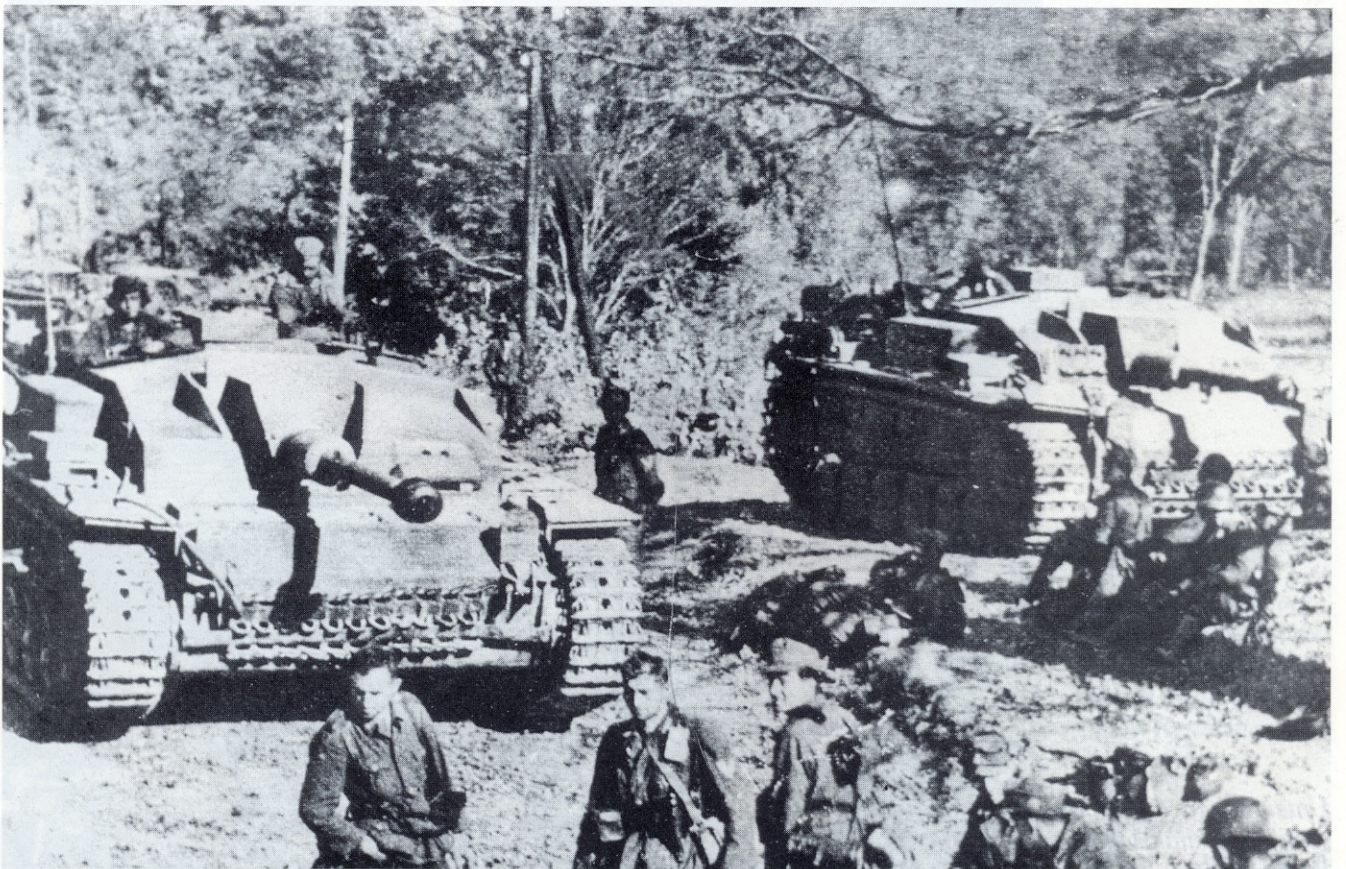
Sturmgeschütze der Ausführung F/8 im Bereitstellungsraum. Zwischen September und Dezember 1942 waren 250 Stück hergestellt worden. Die Unterschiede zum vorgehenden Modell waren gering.
