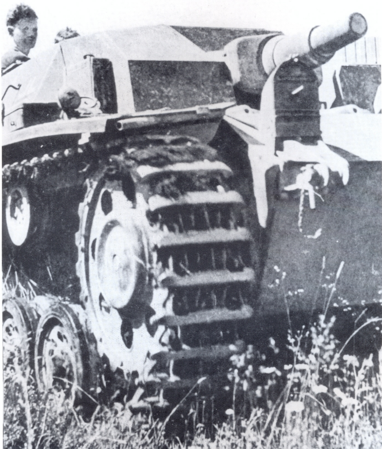
Gut zu erkennen, das Sturmgeschütz 7,5-cm-Kanone mit einer Rohrlänge von 1766,5 mm (=L/24). Die gepanzerte Selbstfahrlafette für Sturmgeschütz 7,5-cm-Kanone der B-Ausführung hat das ältere, gelochte Antriebsrad und die 360 mm breite Gleiskette.
