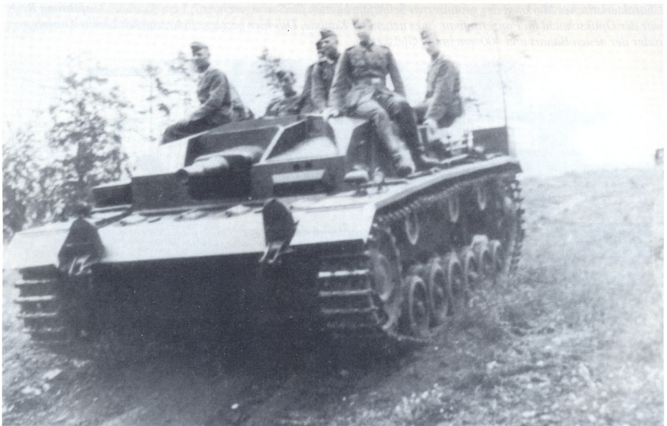
Fahrausbildung mit der gepanzerten Selbstfahrlafette für Sturmgeschütz 7,5-cm-Kanone, Ausführung B. Ab Juni 1940 waren 250 Stück hergestellt worden. Die Aufnahme entstand vermutlich bei der Sturmgeschützabteilung 184 oder 185.
