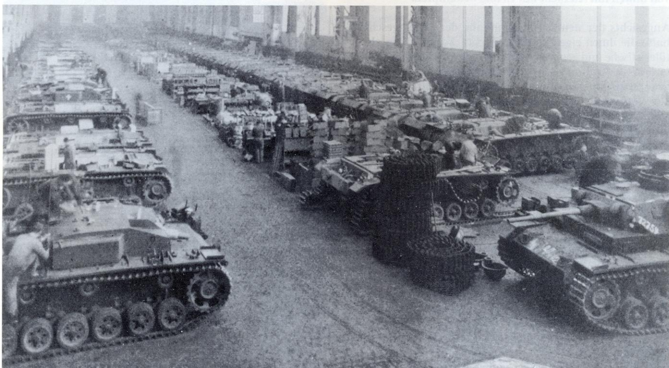
Bilder von der Panzer- und Sturmgeschützfertigung vom Mai 1941 (Bild oben) und vom Herbst des Jahres (Bild unten). Ab September war mit der Fertigung der gepanzerten Selbstfahrlafette für Sturmgeschütz 7,5-cm-Kanone, Ausführung E begonnen worden. Zu den charakteristischen Merkmalen gehörte, daß nun auch auf der rechten Aufbauseite ein gepanzerter Ausbau zu finden war.
