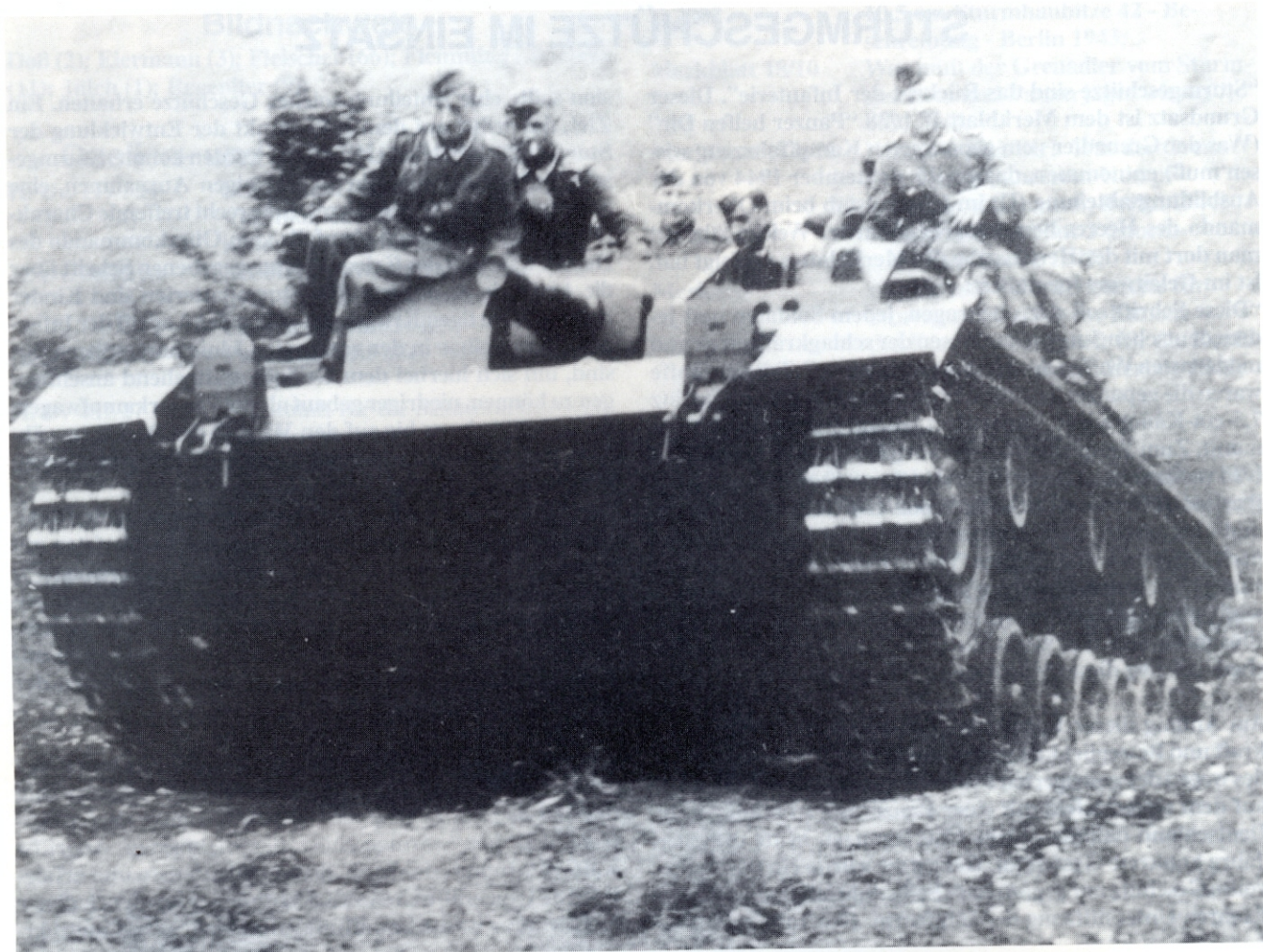
Charakteristisches Merkmal der gepanzerten Selbstfahrlafetten für Sturmgeschütz 7,5-cm-Kanone, Ausführung B war der Optischschacht im Panzeraufbau, links neben der Kanone. Das hier gezeigte Fahrzeug hat bereits Antriebsräder der neuen Bauart und 400 mm breite Gleisketten.
