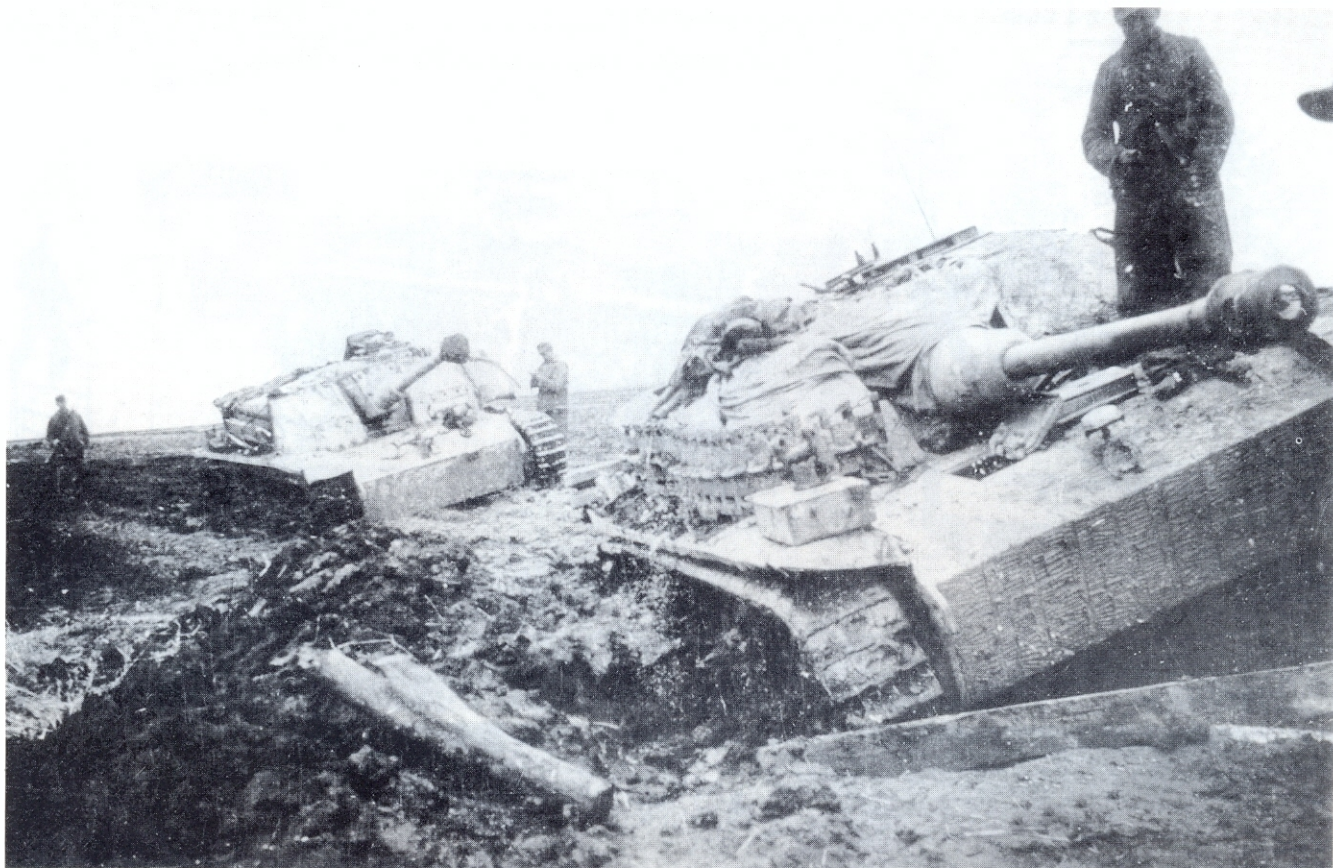
Sturmgeschütze der 3. Batterie/Sturmgeschützabteilung 276 während der Kämpfe im Februar 1944. Das vordere Fahrzeug zeigt die gegossene Rohrwiegenpanzerung und den ab September 1943 gebräuchlichen "Zimmerit"-Schutzanstrich. Bei dem dahinter befindlichen Sturmgeschütz fehlt dieser Anstrich. Außerdem hat es die kantige, geschweißte und verschraubte Rohrwiegenpanzerung. Beachte die seitliche weggeklappte Rohrstütze.
