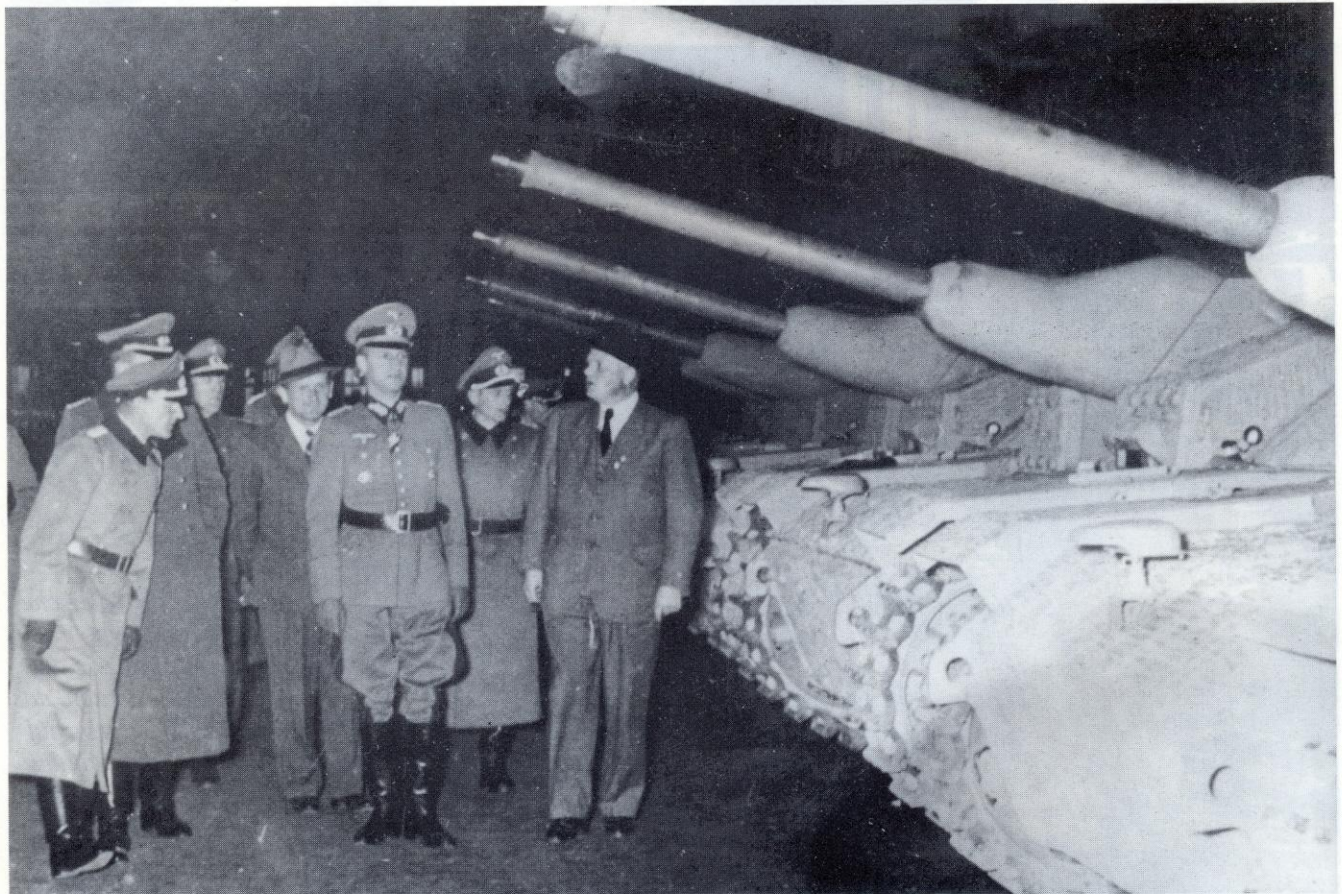
Ab November 1943 wurde ein Teil der Sturmgeschütze mit der gegossenen Rohrwiegenpanzerung, der sogenannten "Saukopfblende" ausgeliefert. Bei den hier gezeigten, zur Auslieferung bereitgestellten Fahrzeugen fehlen noch die Mündungsbremsen.
