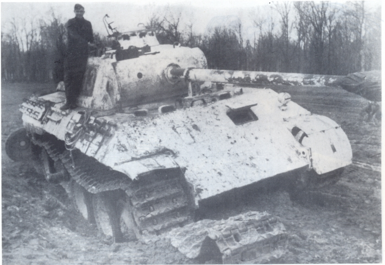
Ein durch Laufwerksschaden liegengebliebener "Panther" D (Fertigungszeit August/September 1943). Die letzten Fahrzeuge der D-Ausführung wurden schon mit der neuen Kommandantenkuppel und dem Fliegerbeschussgerät 41 für das Maschinengewehr 34 als Flugabwehrwaffe ausgerüstet.
