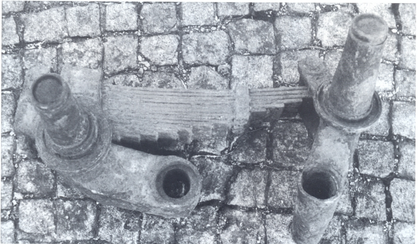
Panzer-IV-Laufrolle, beschriftet mit "470/90-359 mwu" (mwu = Deutsche Dunlop Gummi-Compagnie AG, Hanau/Main).
