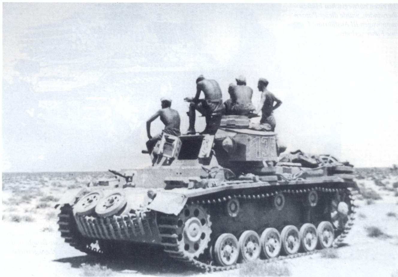
Nachdem der Einbau der 5-cm-Kampfwagenkanone L/42 in den Panzer III begonnen hatte, wurden die Fahrzeuge als G-Ausführung bezeichnet. Gleichzeitig wurde eine neue Kommandantenkuppel aufgebaut. Fahrgestellmäßig änderte sich zunächst nichts. Nach wie vor wurden die 360 mm breiten Ketten mit den gelochten Antriebs- und den Scheiben-Leiträdern verwendet. Panzer III G (Tp) in Nordafrika.
