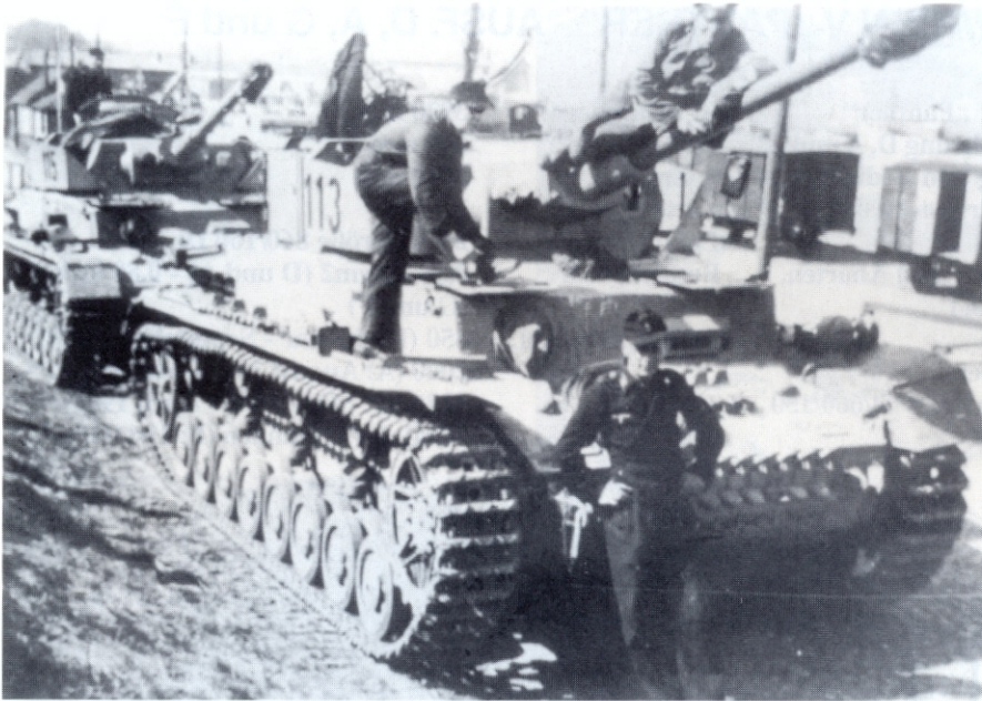
Ab Juni 1944 wurde der Panzerkampfwagen IV (7,5 cm L/48) Ausführung J (Sd.Kfz. 161/2) hergestellt. Aus Gründen der Gummieinsparung verzichtete man darauf, die Stützrollen mit einer Bandage zu versehen. Fahrzeug einer 1944 in Dänemark eingesetzten Ausbildungseinheit.
