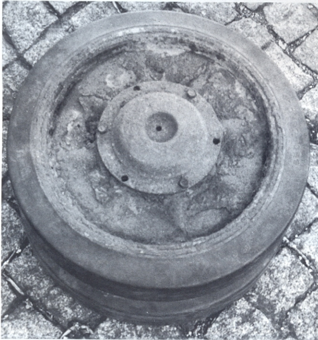
Panzer-IV-Laufrolle, beschriftet mit "470/90-359 mwu" (mwu = Deutsche Dunlop Gummi-Compagnie AG, Hanau/Main).
