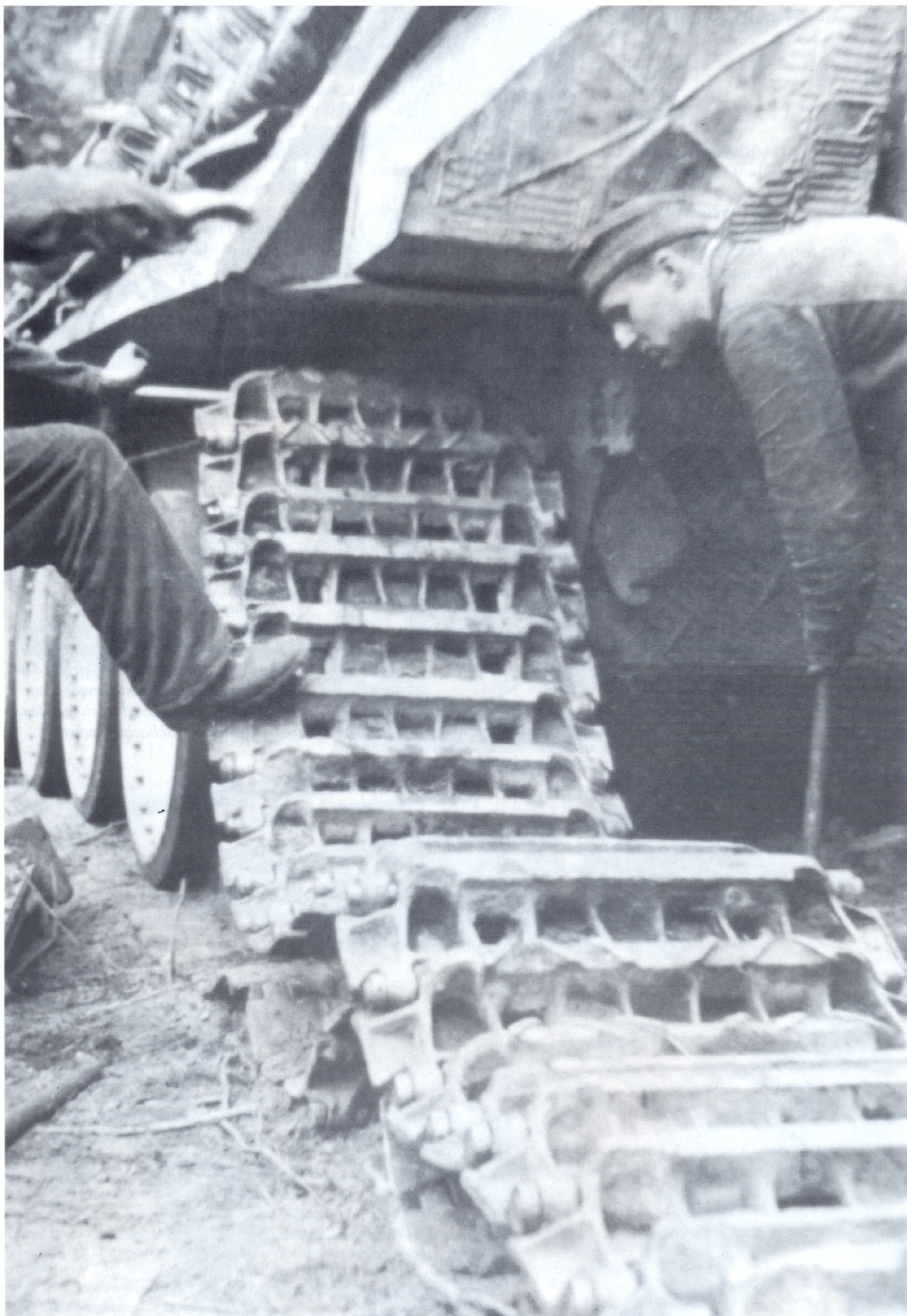
Kettenaufziehen im Gelände bei einem Panzerkampfwagen V "Panther" Ausführung G (Sd.Kfz. 171).
