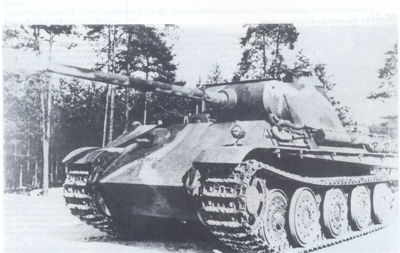
Ab der Fgst.-Nr. 121.052 des "Panther" G der Fa. Daimler-Benz AG, Berlin Marienfelde wurde entsprechend der Forderung des HWA/WaPrüf 6/III v. Febr. 43 nach weitestgehender Angleichung der Produktion des "Panther" und des "Tigers" das von den Deutschen Eisenwerken AG, Duisburg entwickelte "Einheits-Laufwerk" verwendet.
