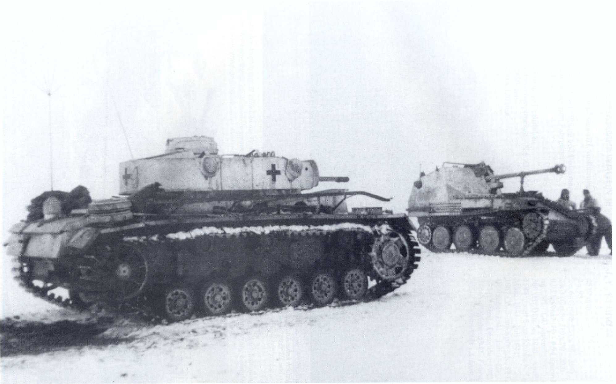
Um besonders im Winter und in den Schlammperioden auf den grundlosen Fahrbahnen Rußland beweglich zu bleiben, wurde die sogenannte breitere "Ostkette" eingeführt. Hier bei einem Panzerbefehlswagen, Ausführung K.
