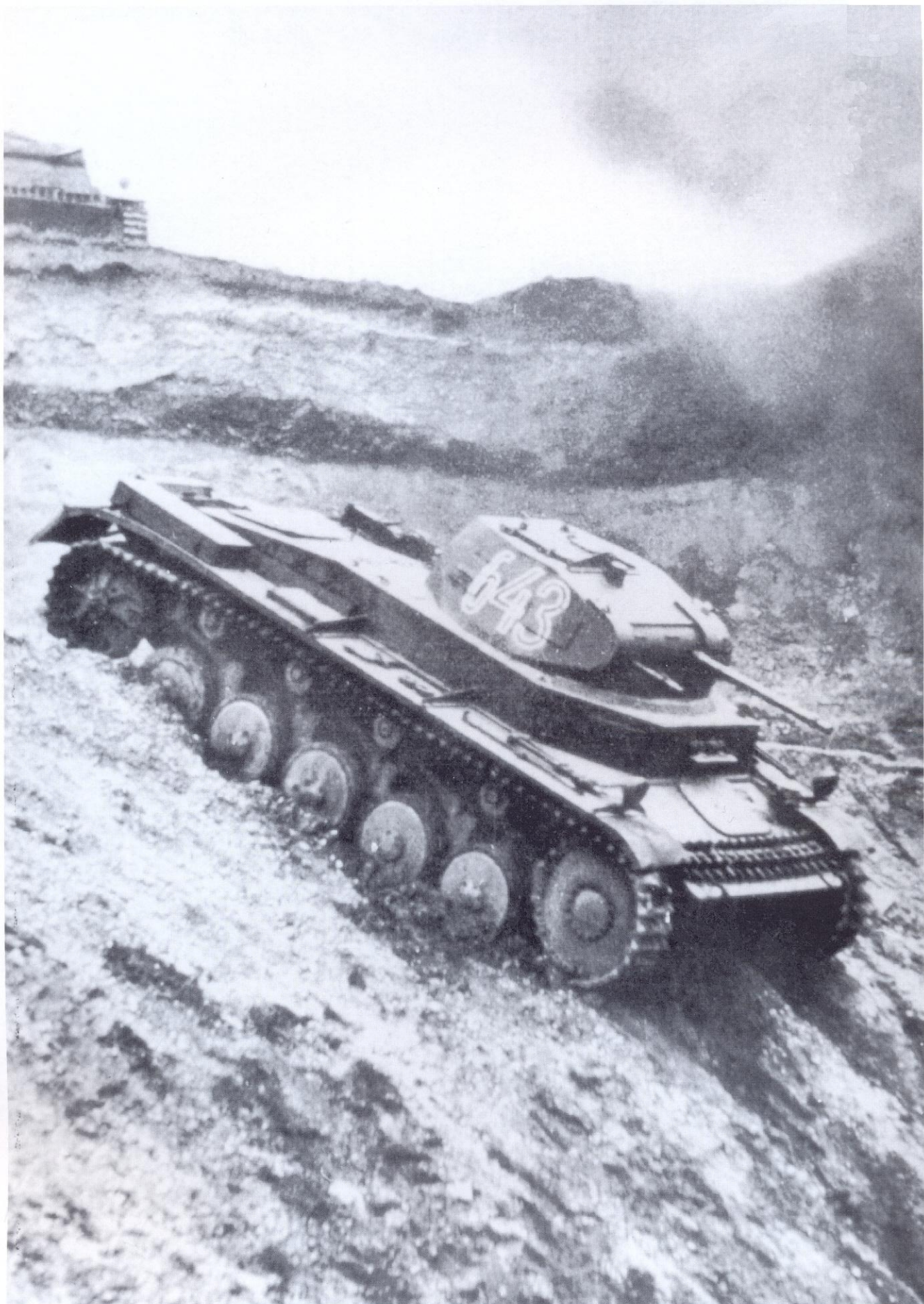
Für das Fahrwerk des Panzerkampfwagen II (2 cm) verwendete die Maschinenfabrik Augsburg-Nürnberg ab 1937 an jeder Wannenseite fünf an Viertelfedern aufgehängte Laufrollen. Panzer II Ausführung A beim Hinabfahren eines Steilhanges während einer Wehrmachtsübung.
