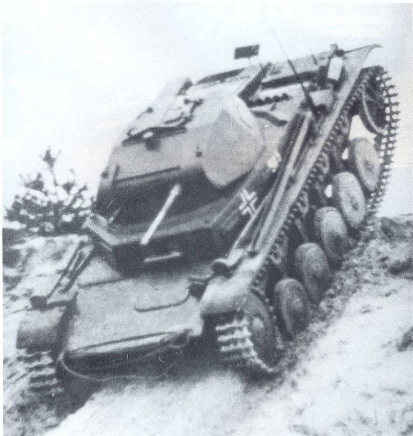
Beim Panzerkampfwagen II 125 (2 cm) Ausführung c (Sd.Kfz. 121) wurde schließlich von der gemeinsamen Aufhängung der Laufrollen abgegangen und jede einzeln an Viertelfedern aufgehängt.
