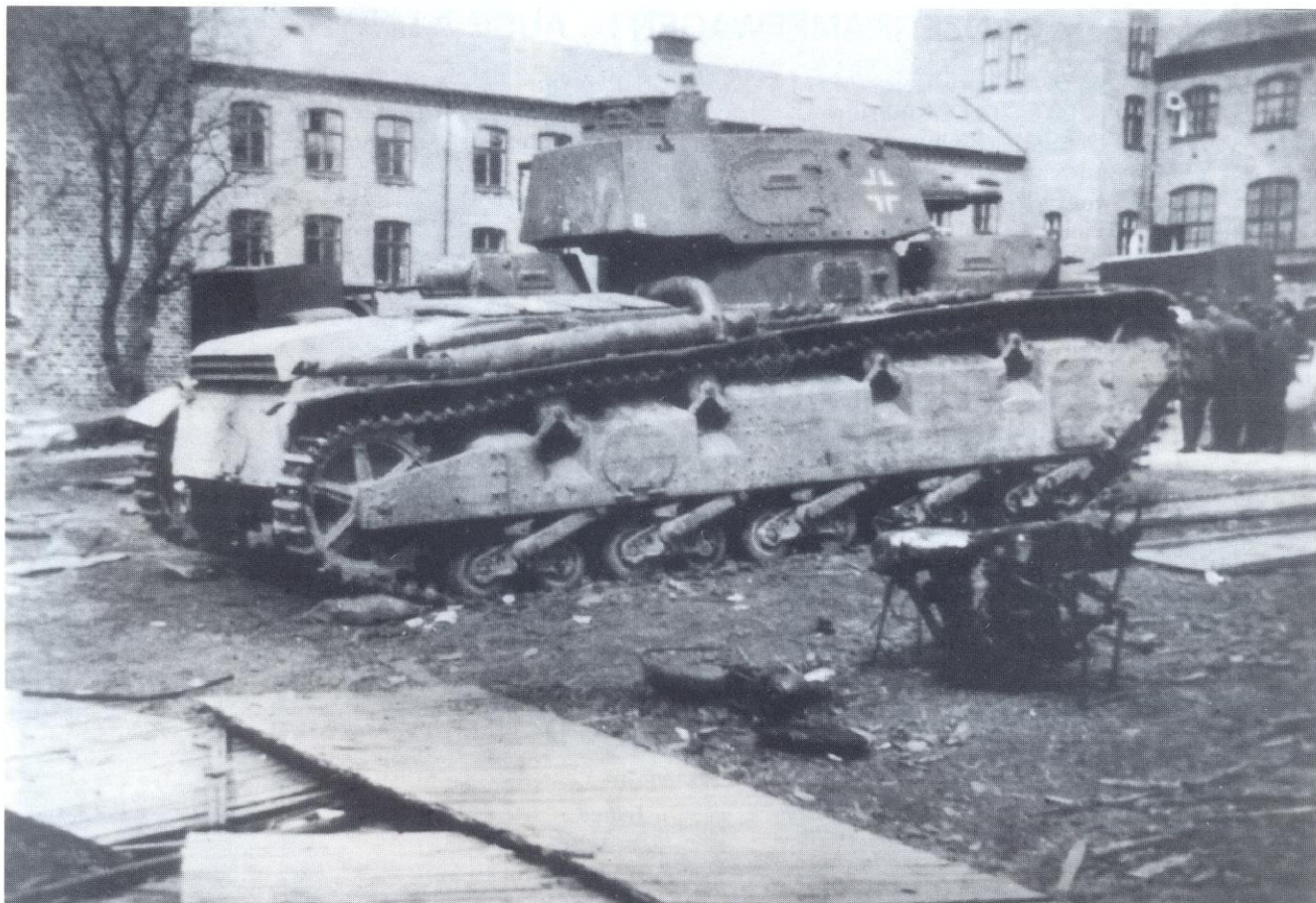
Von 1934 bis 1936 wurden fünf "Neubaufahrzeuge" gebaut, zwei in Flußeisen und drei in Panzerstahl. Drei davon wurden bei der Besetzung Norwegens zum Einsatz gebracht.
