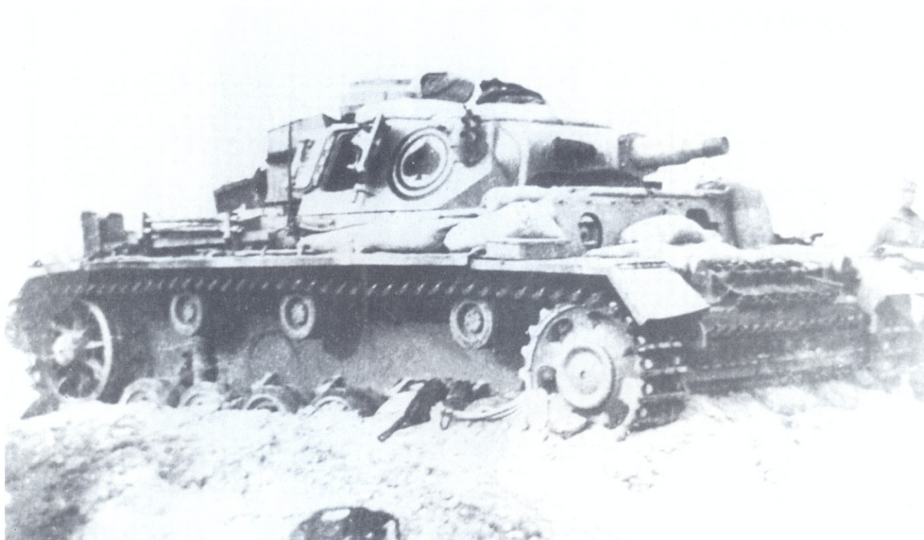
Den Abschluß der Panzer-III-Produktion bildete die Ausführung N mit 7,5-cm-Kampfwagenkanone 37 L/24. Die letzten Fahrzeuge wurden im August 1943 ausgeliefert. Danach wurde das Fahrgestell dieser Panzer nur noch zur Fertigung von Selbstfahrlafetten verwendet. Die Ketten, die Antriebs- und die Leiträder wurden keiner wesentlichen Erneuerung unterzogen.
