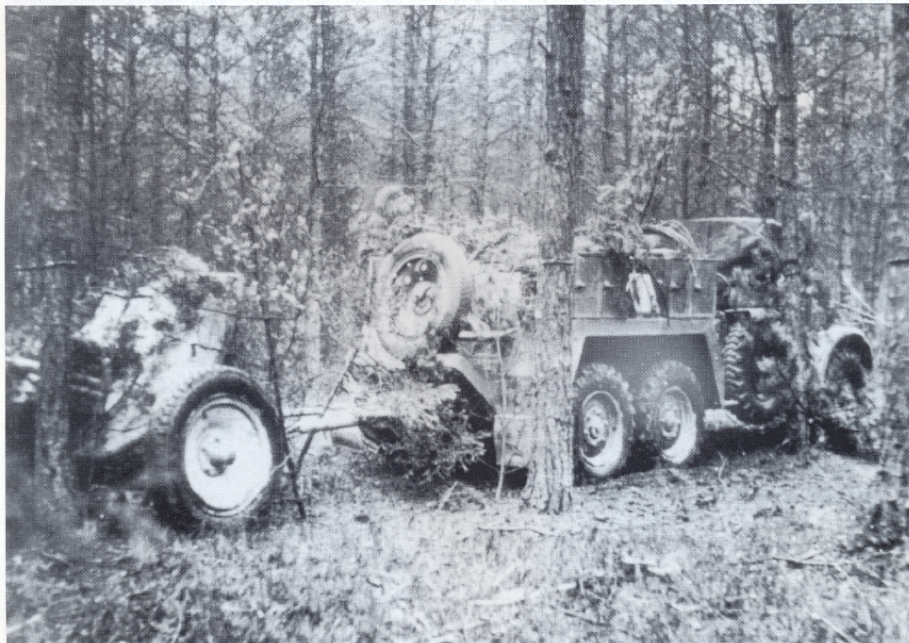
In den Panzerjägerabteilungen der Divisionen sind als Zugmittel für die 3,7-cm-Panzerabwehrkanonen Protzkraftwagen (Kfz.69) zum Einsatz gekommen. Das Fahrzeug trug den Fahrer, die fünfköpfige Bedienung, den Ergänzungskasten sowie 180 Panzer- und 36 Sprenggranatpatronen. Im Bild (oben) ein leichter geländegängiger Lastkraftwagen 1 to (6x4) Krupp L 2 H 143 mit Geschütz bei der Panzerjägerabteilung 90 (10. Panzerdivision) in Frankreich 1940.
