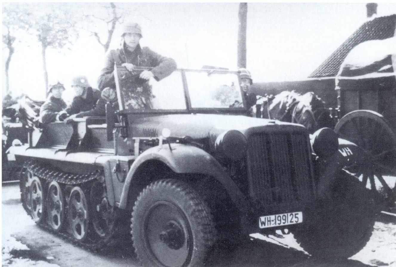
Ein Zugkraftwagen 1 t Demag D 7 (Sd. Kfz.10) einer Panzerjägerabteilung in Polen, im September 1939. Mit diesem Zugmittel konnten die Panzerjäger wesentlich besser mit den Panzern und motorisierten Schützen zusammenwirken.
