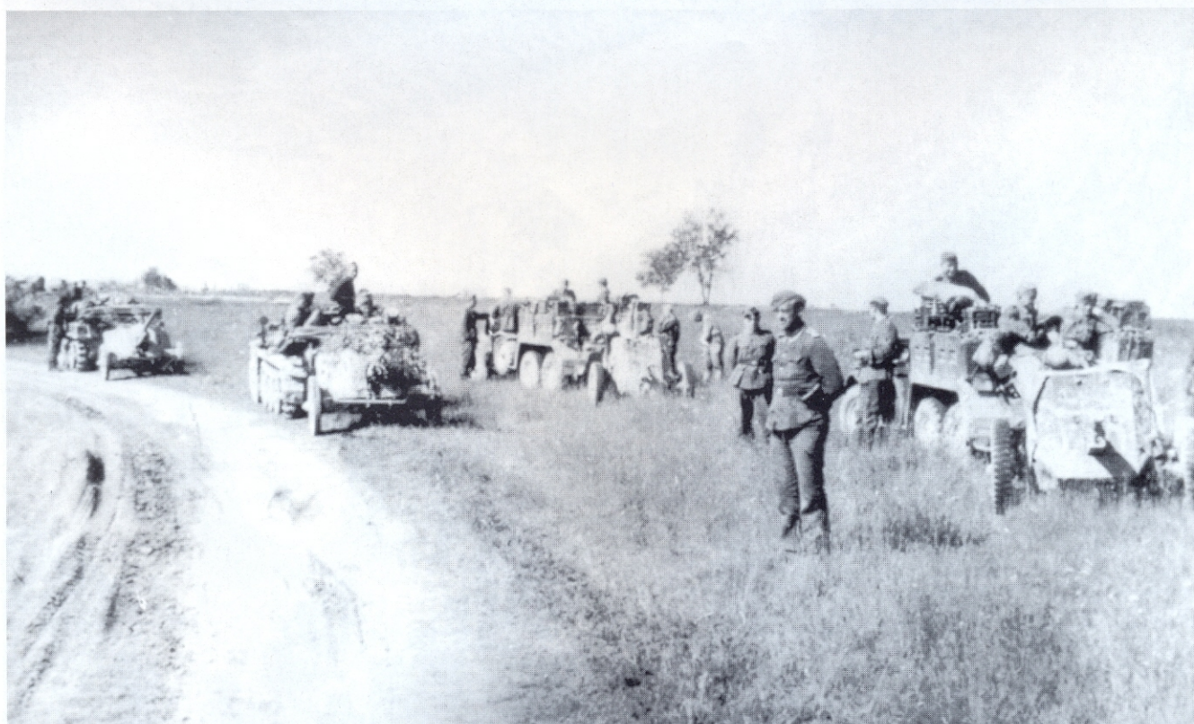
Eine Aufnahme von der Ostfront, Juli 1941. Sie zeigt Teile einer Panzerjägerkompanie mit gemischter Ausstattung während einer kurzen Rast. Links Zugkraftwagen 1 t Demag D 7 (Sd. Kfz.10) mit der 5-cm-Panzerjägerkanone 38, rechts einen leichten Zug mit 3,7-cm-Panzerjägerkanonen hinter Protzkraftwagen (Kfz. 69), allgemein "Krupp-Protze" genannt.
