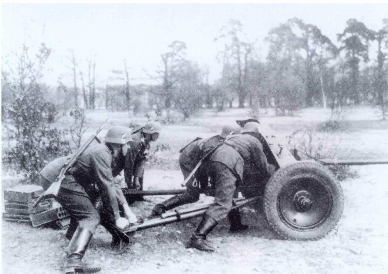
Die Fortbewegung des 450 kg schweren Panzerabwehrgeschützes durch seine Bedienung bereitete im Gelände kaum Probleme. Beim Schießen aus dem kurzen Halt mußten die Holme der Spreizlafette fest auf den Boden gedrückt werden.
