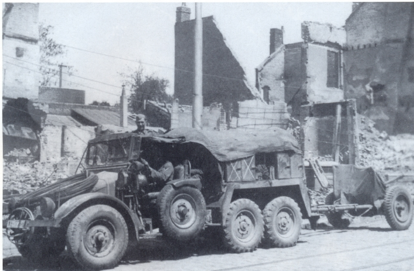
In den Panzerjägerabteilungen der Divisionen sind als Zugmittel für die 3,7-cm-Panzerabwehrkanonen Protzkraftwagen (Kfz.69) zum Einsatz gekommen. Das Fahrzeug trug den Fahrer, die fünfköpfige Bedienung, den Ergänzungskasten sowie 180 Panzer- und 36 Sprenggranatpatronen. Im Bild (oben) ein leichter geländegängiger Lastkraftwagen 1 to (6x4) Krupp L 2 H 143 mit Geschütz bei der Panzerjägerabteilung 90 (10. Panzerdivision) in Frankreich 1940.
