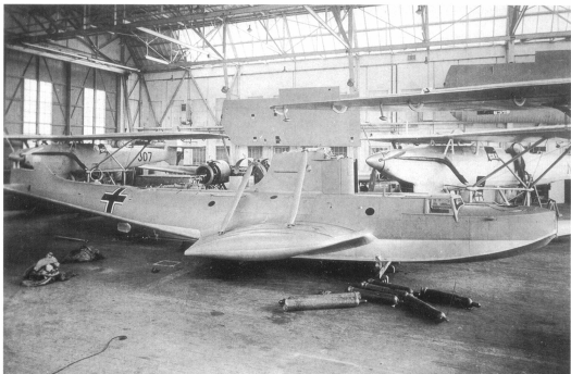
Eine von zwei Do 18 H, welche die Zelle der G-Ausführung aufwiesen. Im Hintergrund das Tragwerk der Do 24 V4 sowie zwei für den Export bestimmte Do 22.
