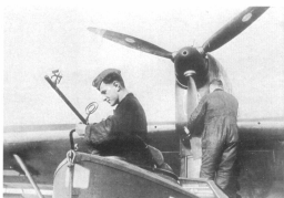
Ein Bordwart setzt ein MG 15 im Drehkranz des A-Stands eines Do 18-Flugbootes ein.
