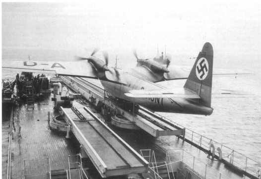
Die mit Vollast laufenden Motoren und die Kraft der Katapultanlage schleudern die Do 26 V1 in ihr Element.
