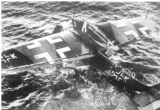
Wartung einer Do 18 D. Seitlich der Streben sind Aufhängungen für Abwurflasten zu erkennen.
