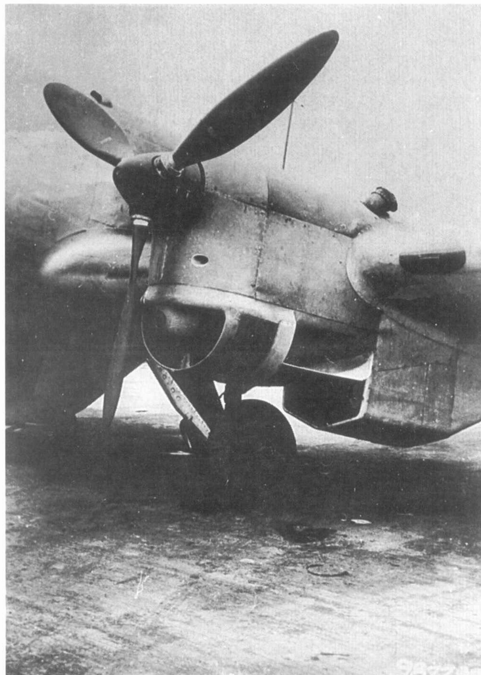
Unten: Für den Höheneinsatz war eine besonders große Kühlluft Eintrittsöffnung am Jumo 207 notwendig.
