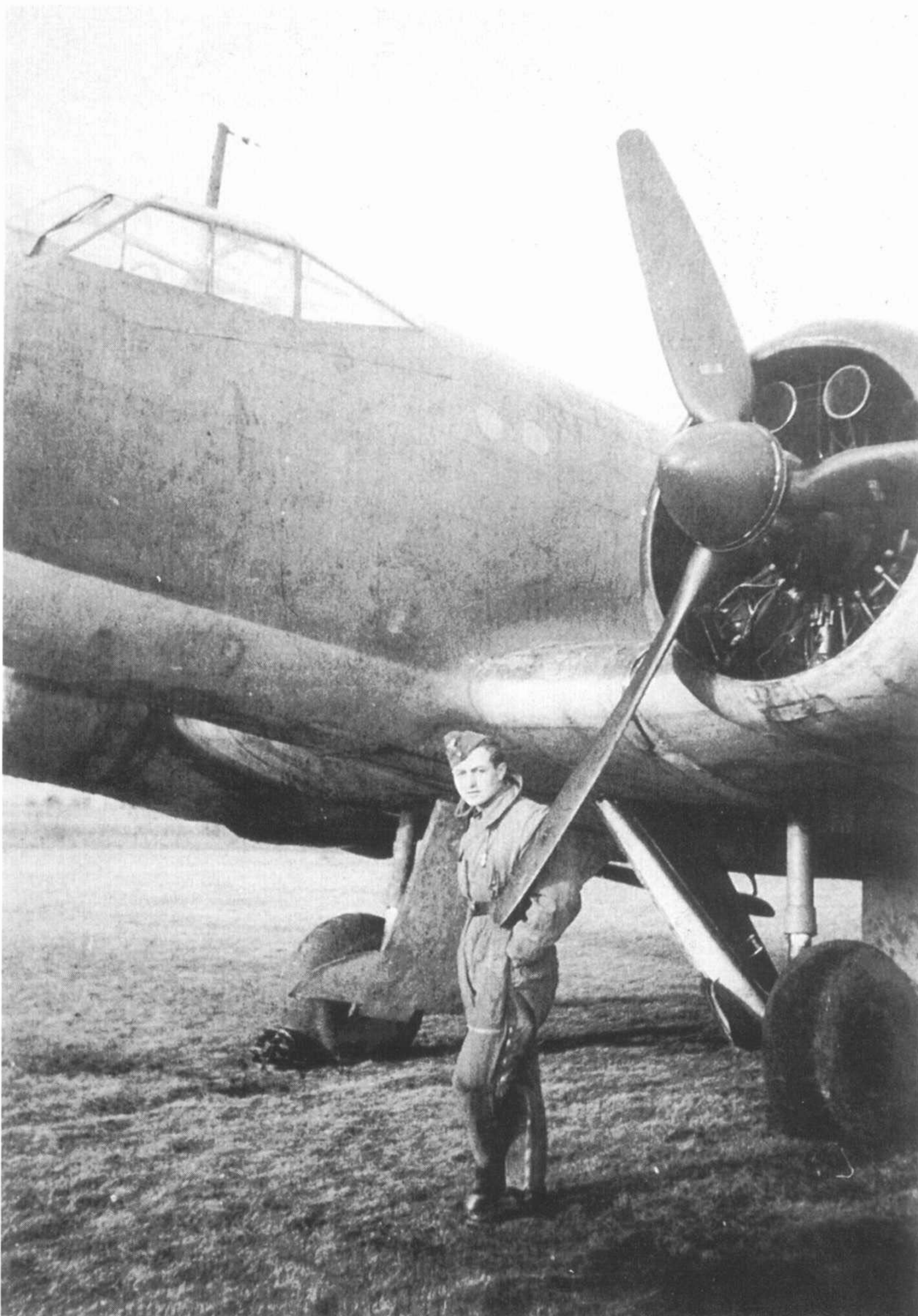
Links: Der Gefr. Haferland vor seiner Schulmaschine. Gut zu erkennen ist der massige BMW 132-Sternmotor.
