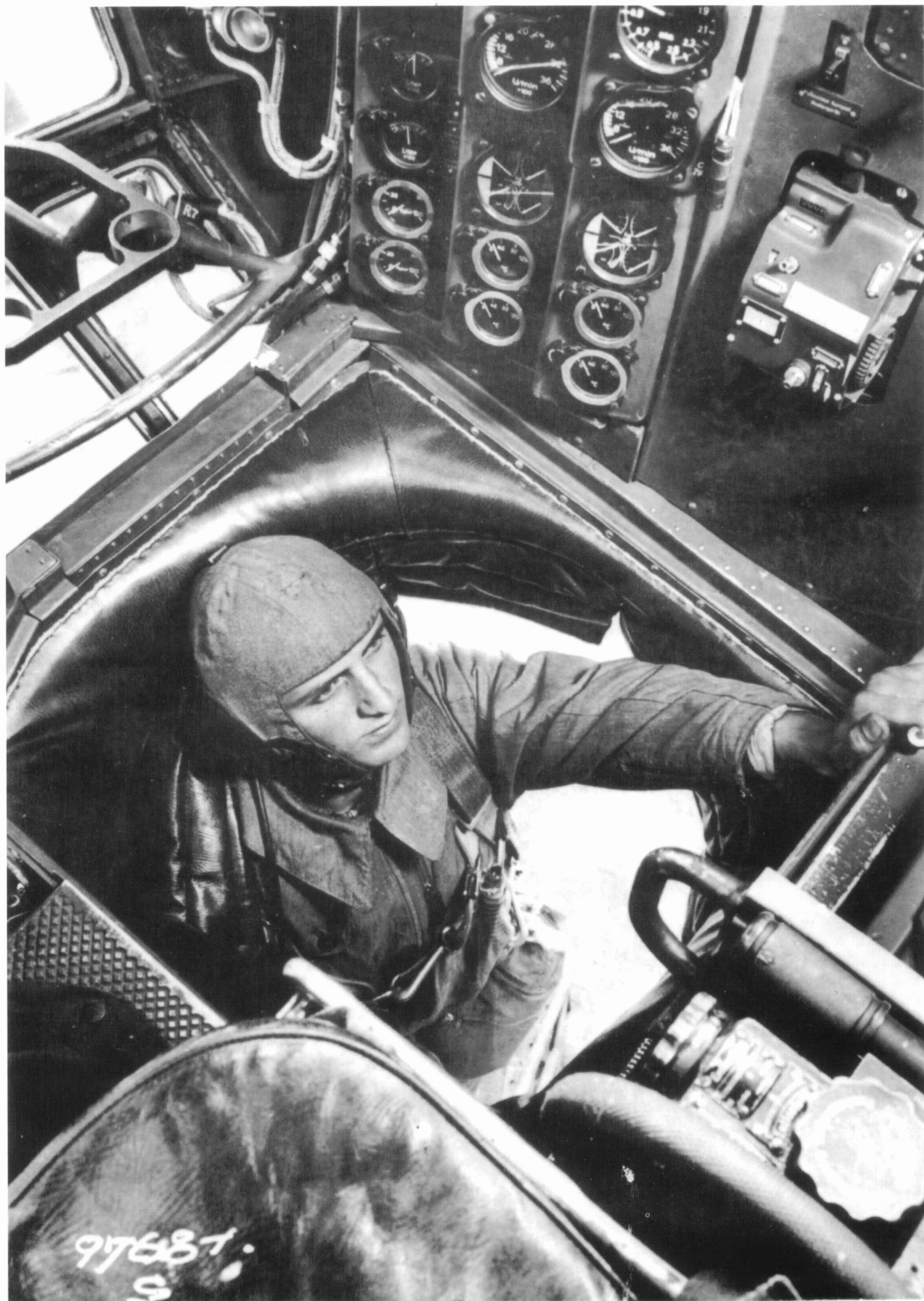
Einstieg in die Druckkabine der Ju 86 P-1
