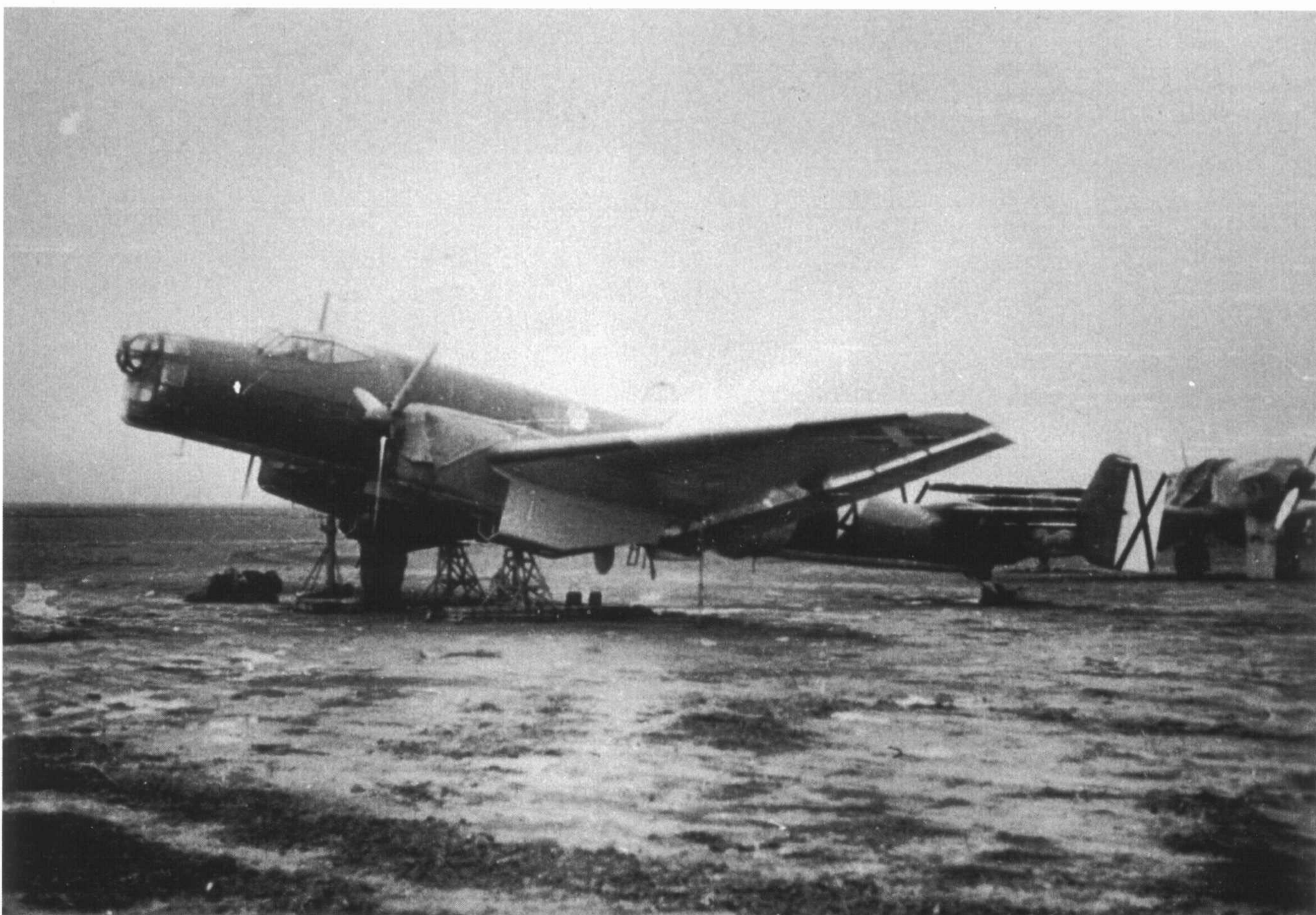
Unten: Dieser Fahrwerksschaden wird auf dem Flugplatz Leon behoben. Im Hintergrund eine He 70 der Legion Condor.
