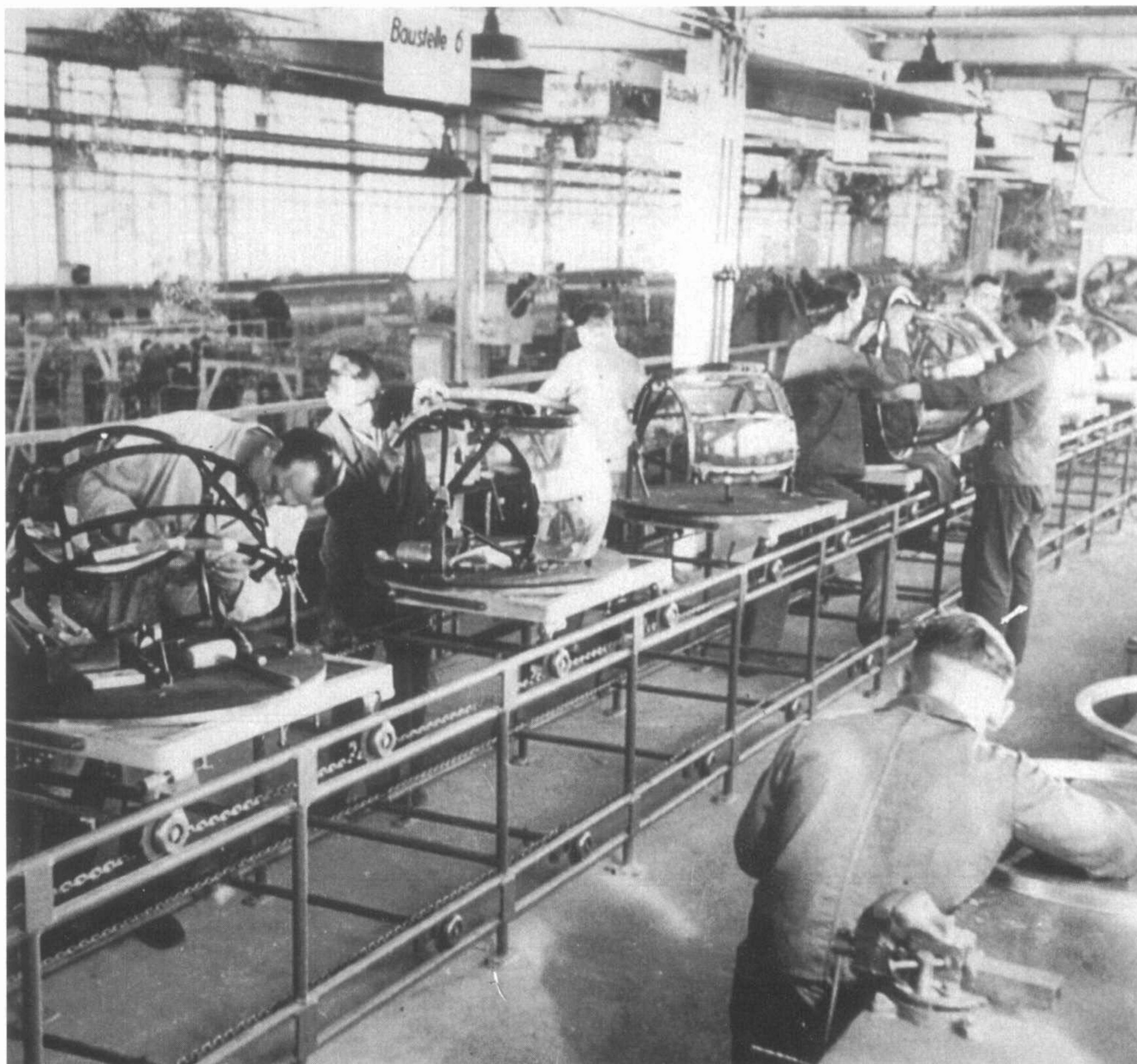
Links: Produktion der mit einem MG 15 zu bestückenden A-Stände für die Ju 86 A-1 und den nachfolgenden Versionen.
