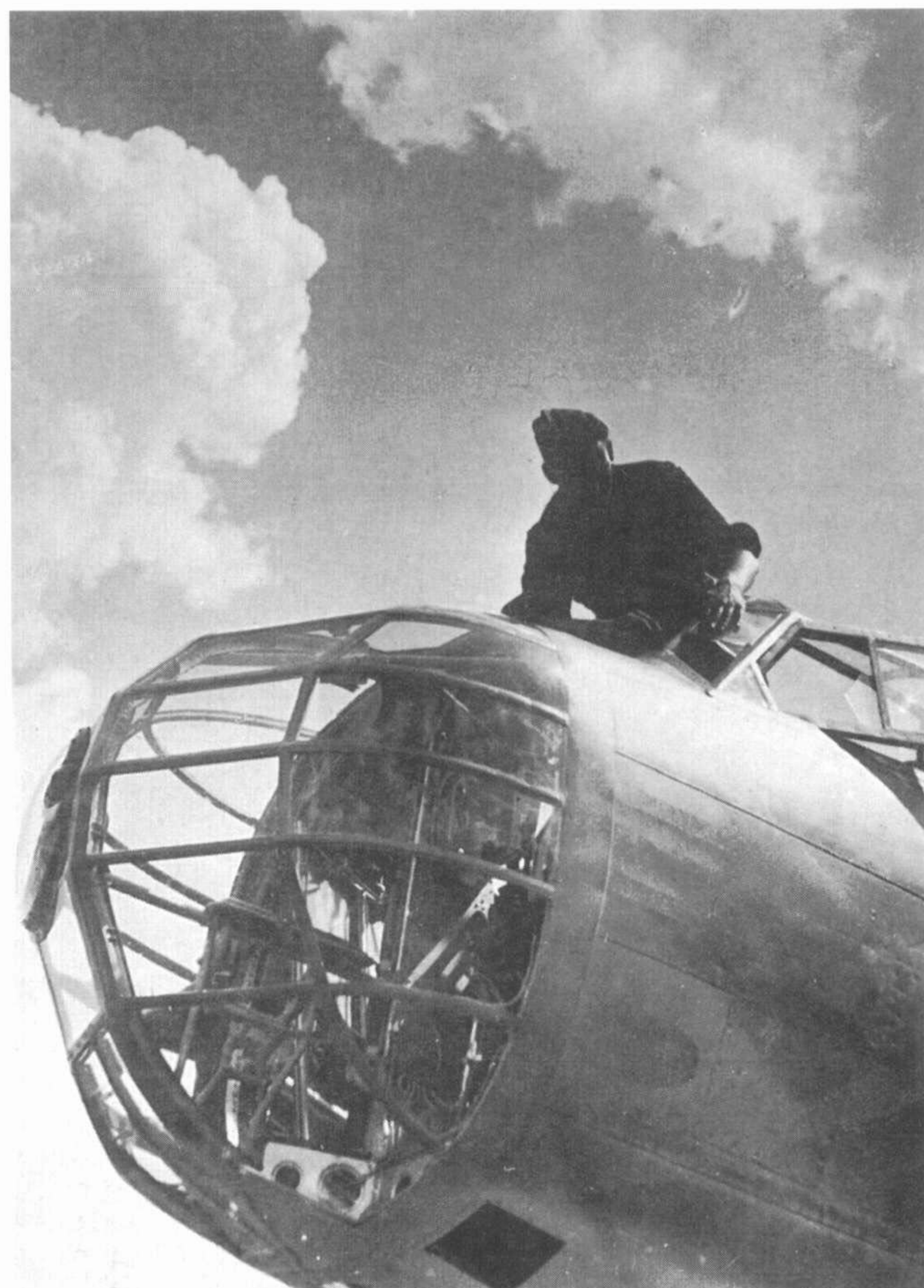
Unten: Kabinendetails bei der Ju 86 G-1. In der Linsenlafette konnte ein MG 15 eingebaut werden. Der Munitionsvorrat belief sich auf 600 Schuß.
