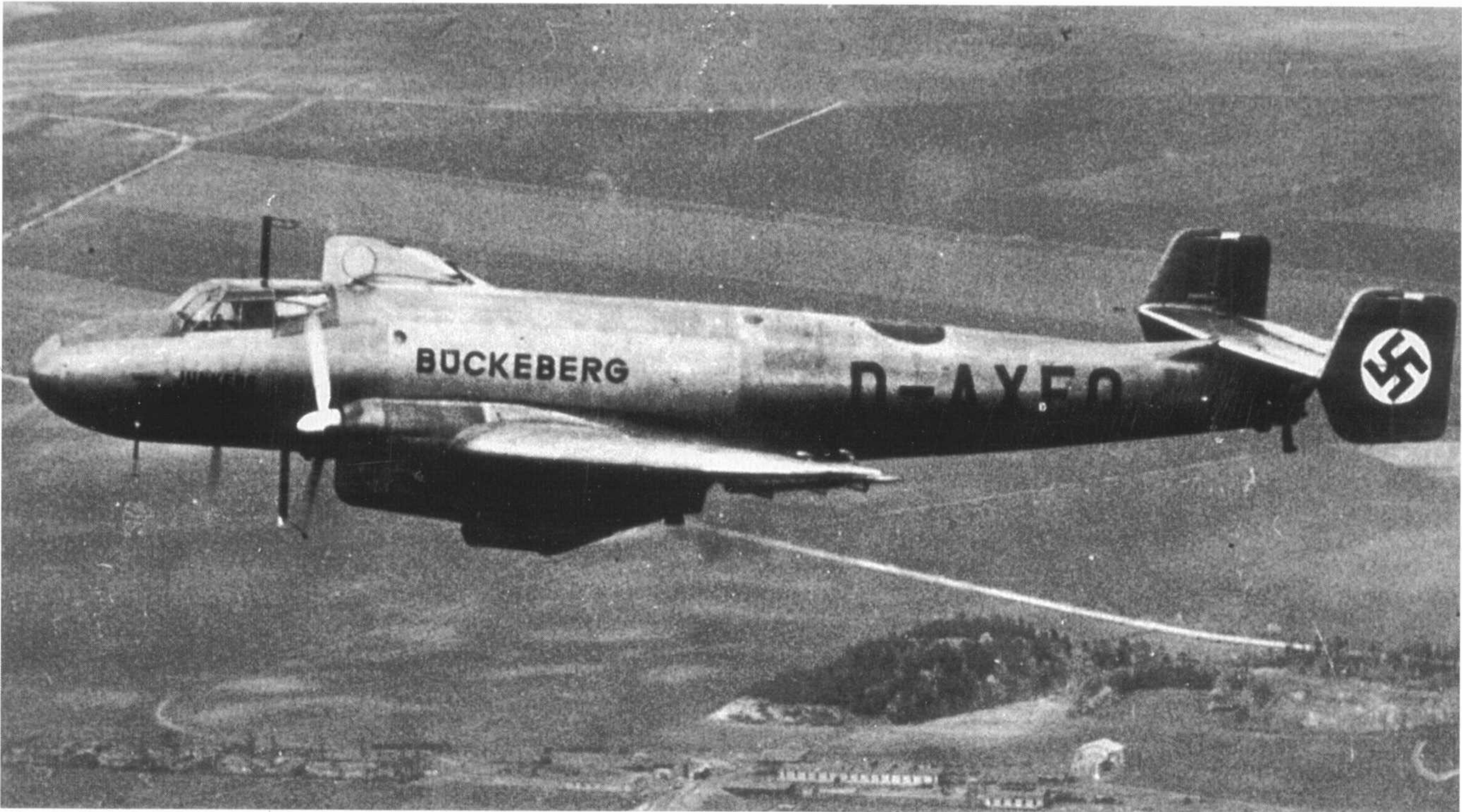
Der Triebwerkserprobung diente die Ju 86 B-01 (D-AXEQ).
