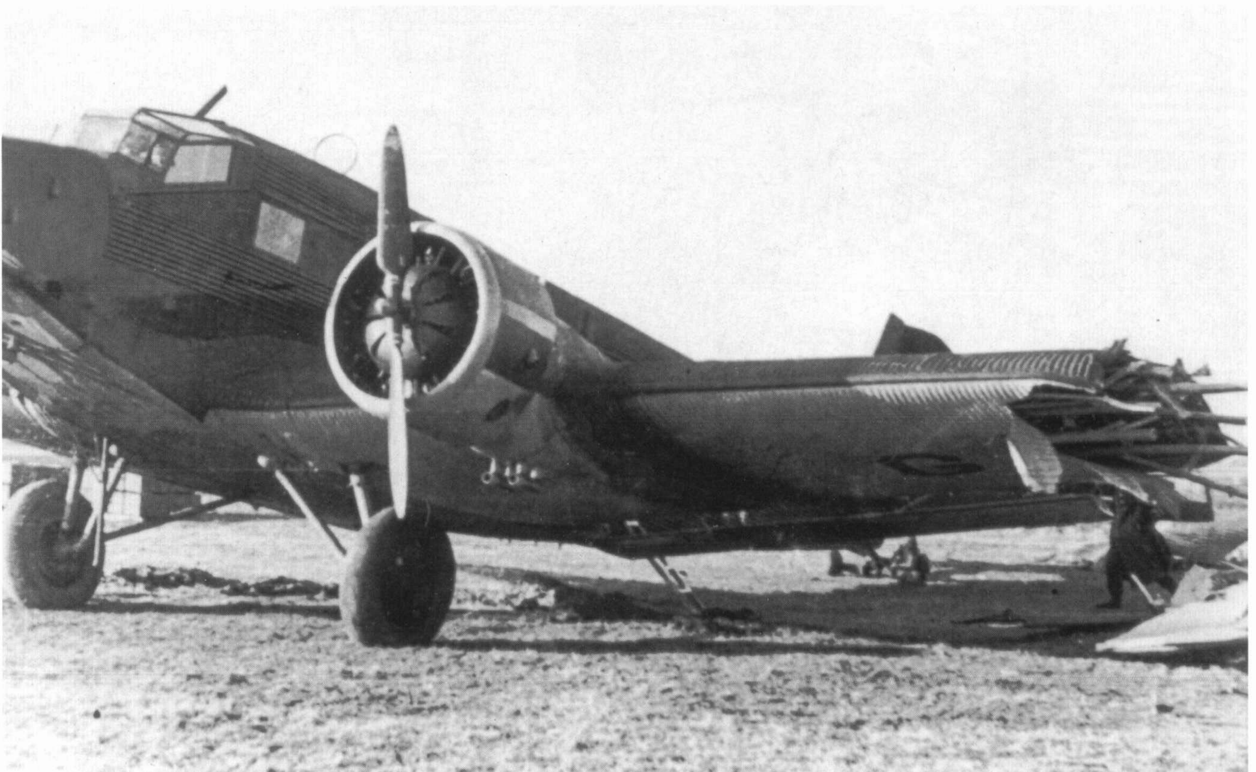
Bei der Flugzeugführerschule (FFS) C2 in Fürth entstand diese Aufnahme der DD+GH mit abgerissener Flächenspitze.
