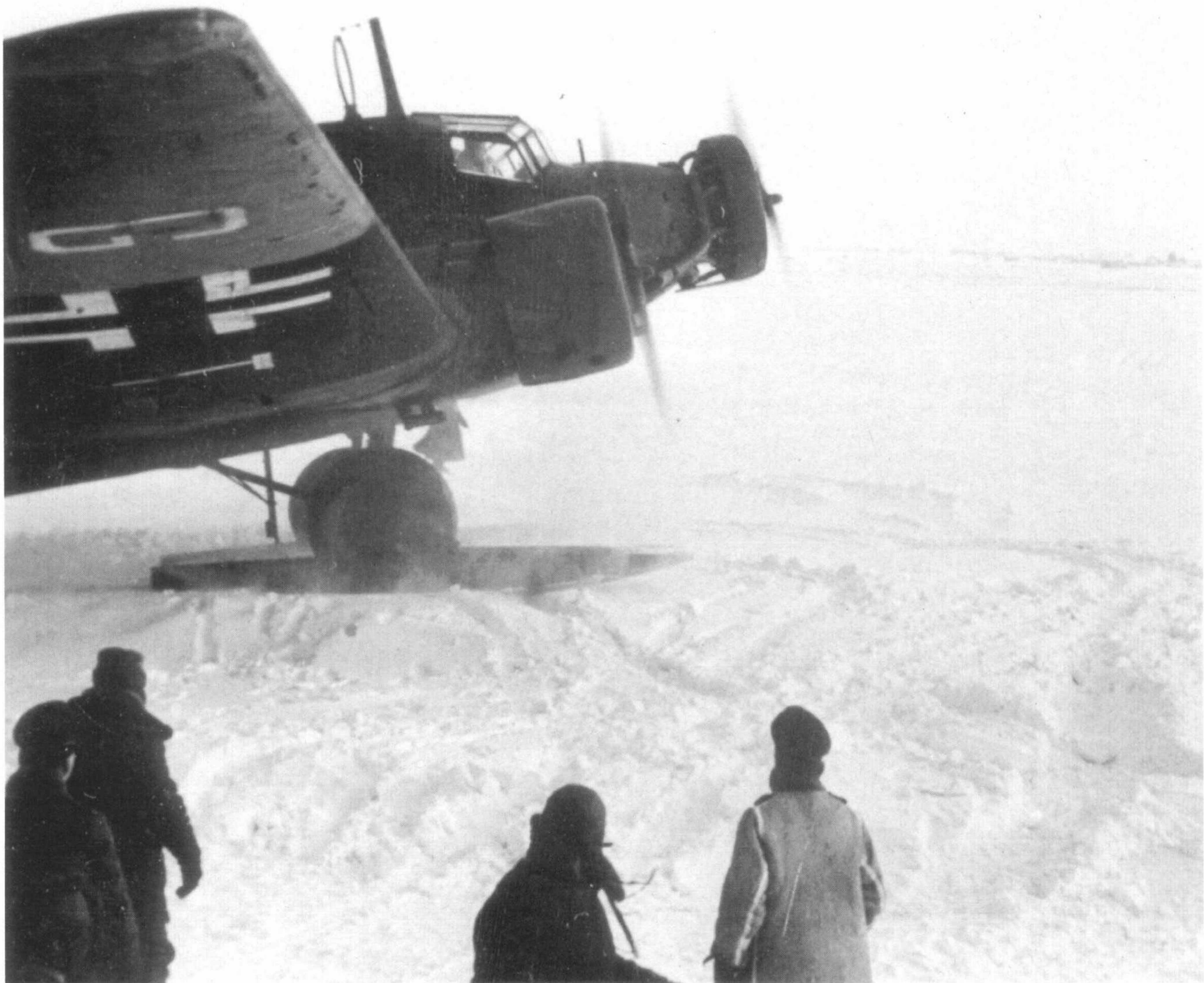
Ju 52/3m mit Schneekufen fanden nur geringe Verbreitung, da man wegen Start- und Landebahnen aus festgewalztem Schnee darauf verzichten konnte.
