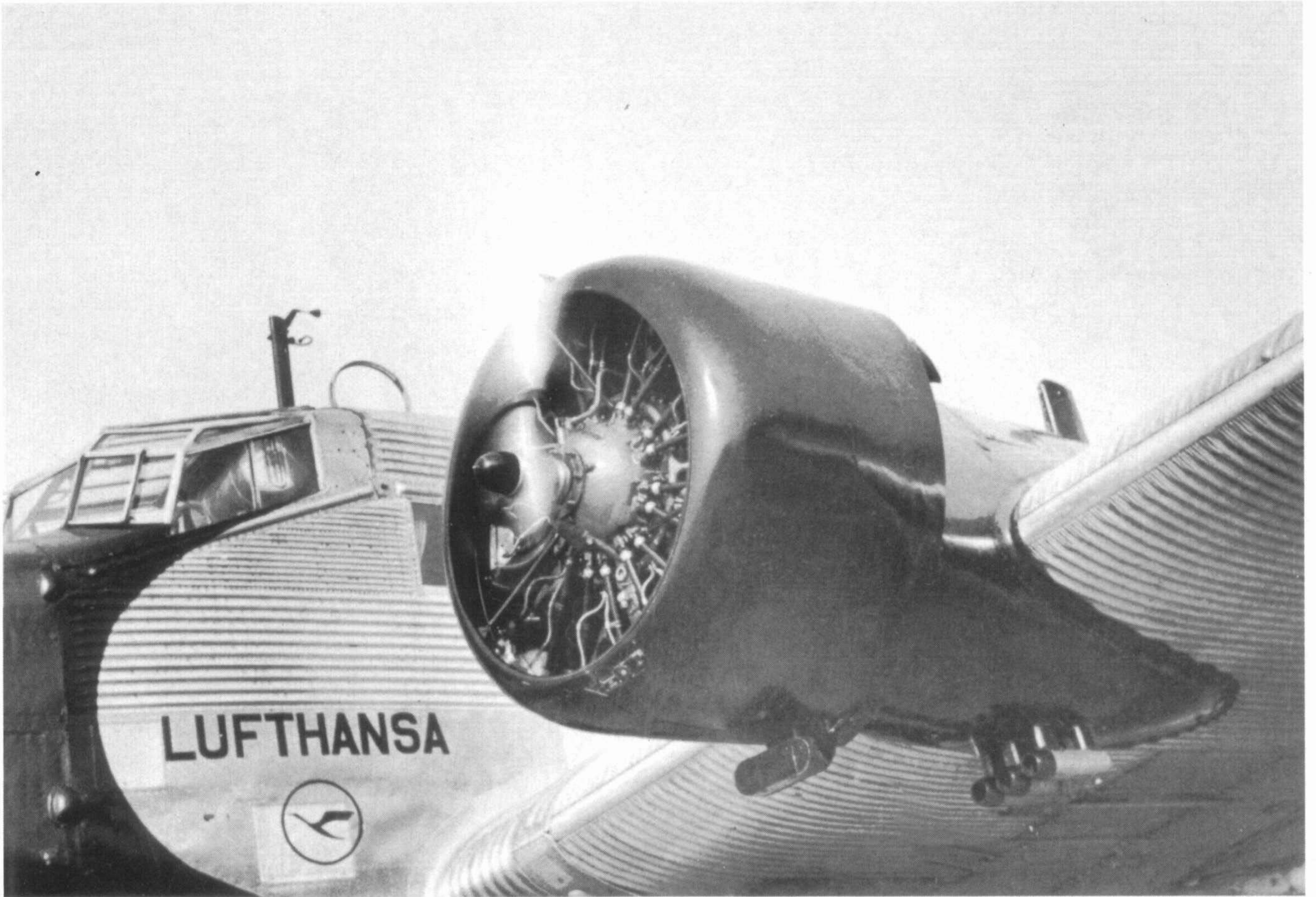
Nahaufnahme des betriebssicheren BMW 132A-Triebwerks, das eine Leistung von 440 kW (660 PS) aufwies.
