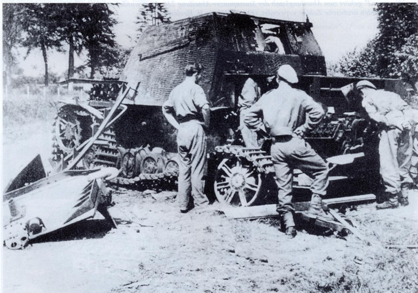
Bei den Kämpfen in der Normandie erhielt dieser Sturmpanzer 43 der mittleren Produktionsreihe einen Volltreffer. Die Wucht der explodierenden Bereitschaftsmunition im Innern hat das Fahrzeug zerrissen.
