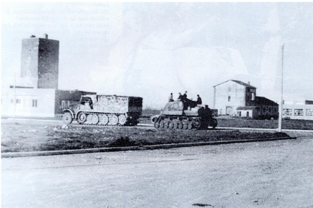
Ein großes Problem beim Sturmpanzer 43 war sein schwaches Vorgelege. Hier wird ein Schadpanzer mit ausgebautem Antrieb von einer 18 to. Zugmaschine abgeschleppt. (Foto KHM via H. Werz)
