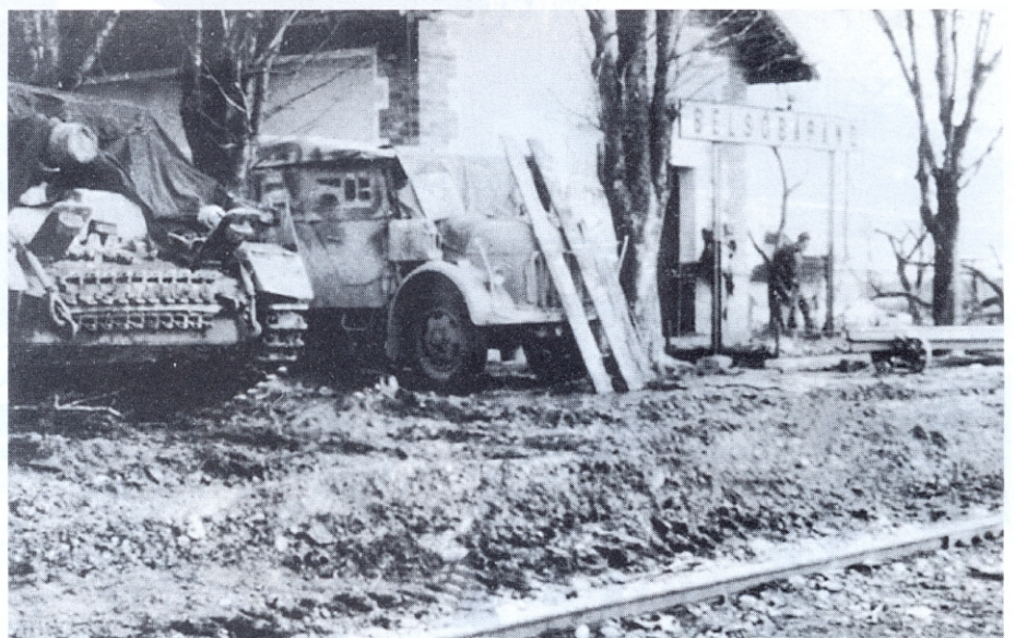
Rechts: Der Aufbau dieses SdKfz 166 ist mit der Schutzplane abgedeckt. Die Lenkbremsenwartungsluken sind geöffnet.
